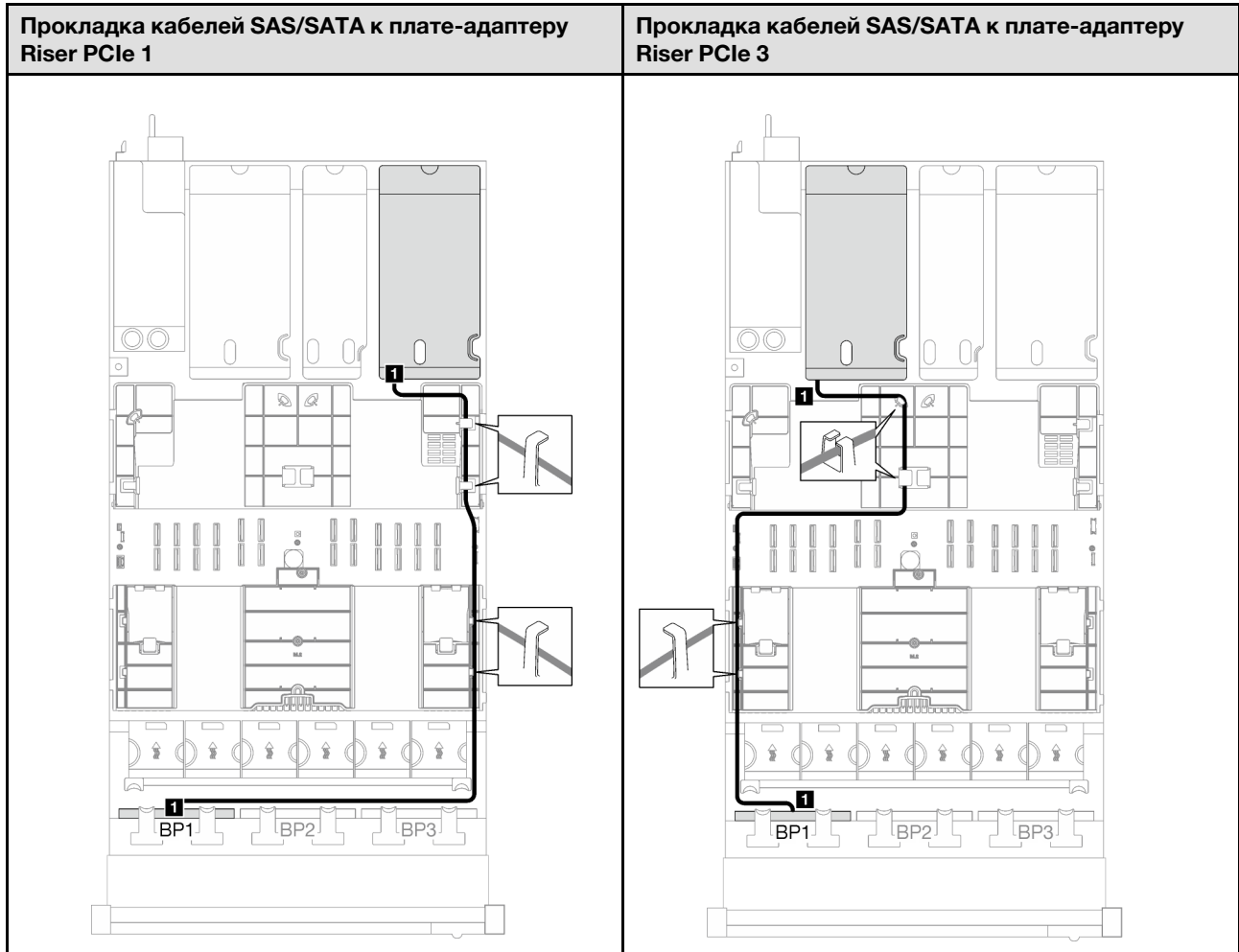
Табл. 23. Прокладка кабелей SAS/SATA
