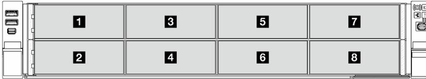
Abbildung 22. Nummerierung der E3.S-Rückwandplatine
