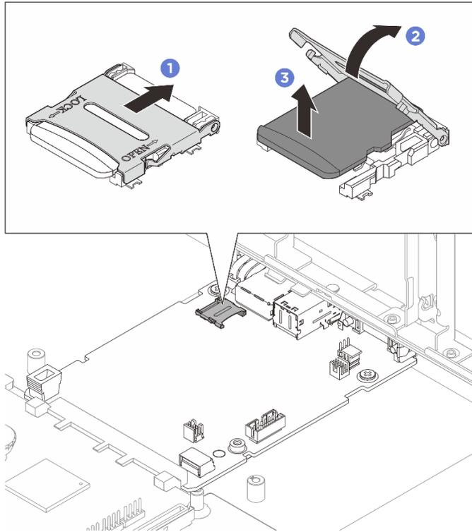
Figura 156. Extracción de la tarjeta microSD
