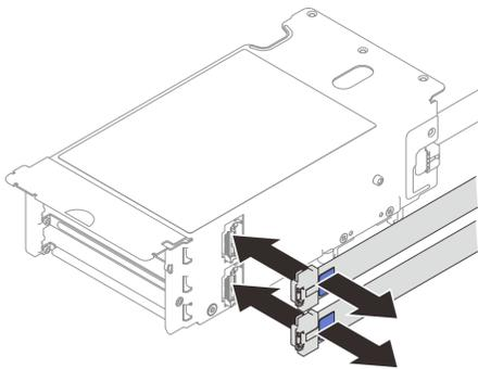
Figura 179. Conexión de cable
