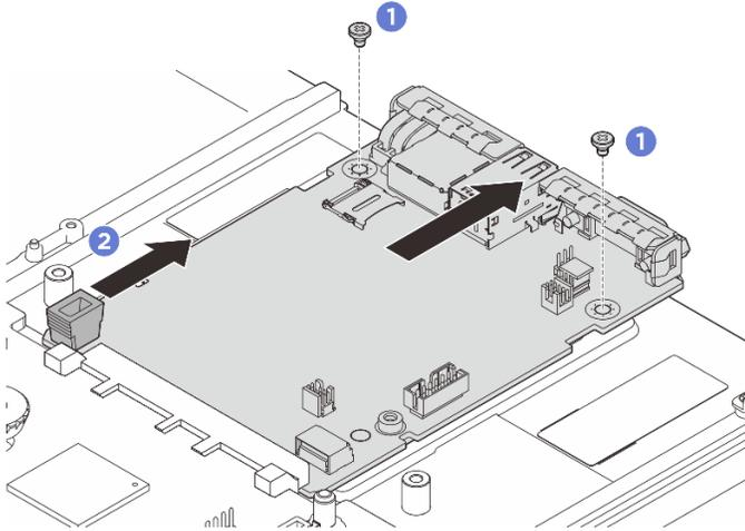
Figura 229. Extracción de la placa de E/S del sistema
