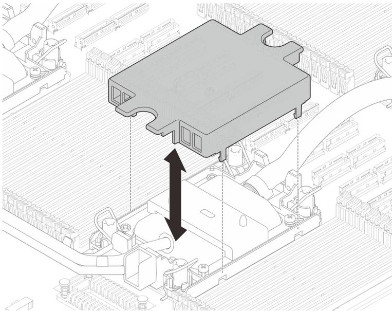
*Figura 93. Instalación de las cubiertas de placa de frío*
