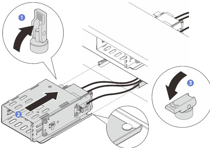
Figura 48. Instalación del compartimiento de E3.S 1T
