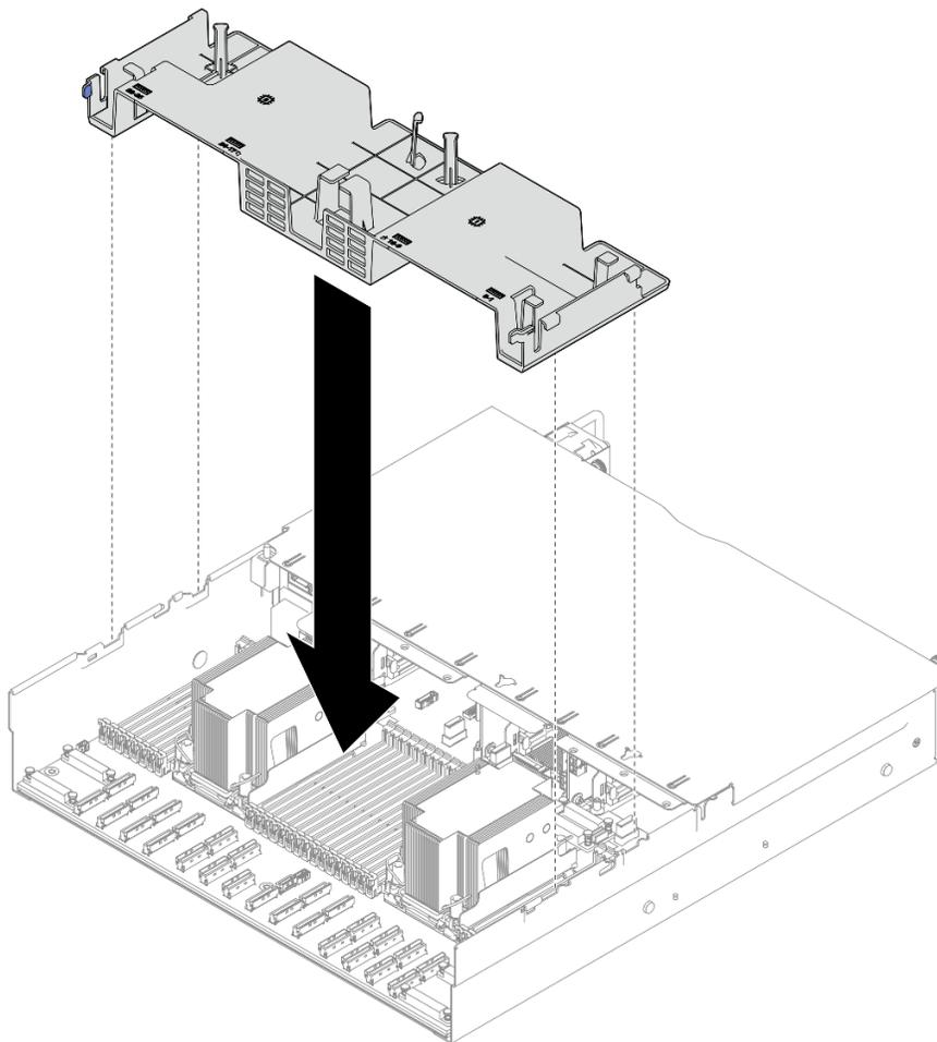
Figura 17. Instalación del deflector de aire posterior
