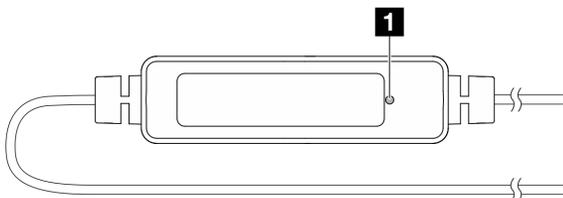
Figura 247. LED de detección de filtraciones
