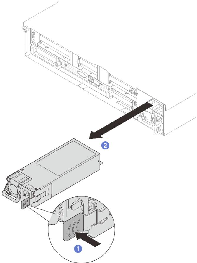
Figura 188. Extracción de la unidad de fuente de alimentación
