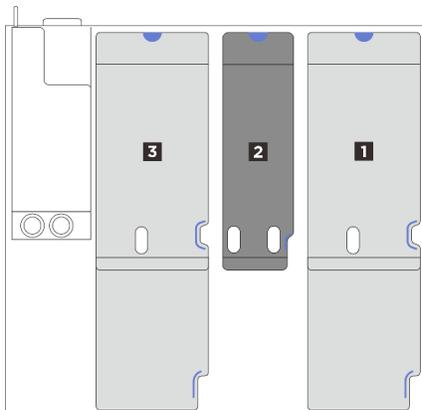
Figura 169. Modelos de servidor con tres tarjetas de expansión PCIe y amplidores de expansión
