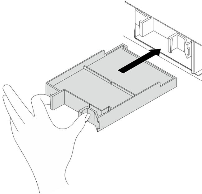
Figura 26. Instalación de un relleno de bahía de CMM
