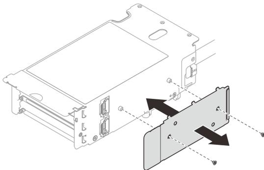
Figura 177. Extracción de la cubierta del cable
