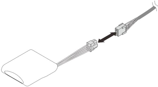
*Figura 53. Desconexión del cable del módulo de alimentación flash*
