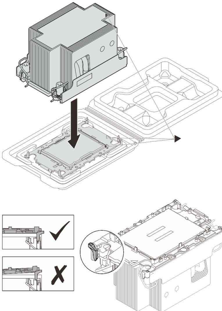
Figura 198. Ensamblaje del PHM con el procesador en la bandeja de envío
