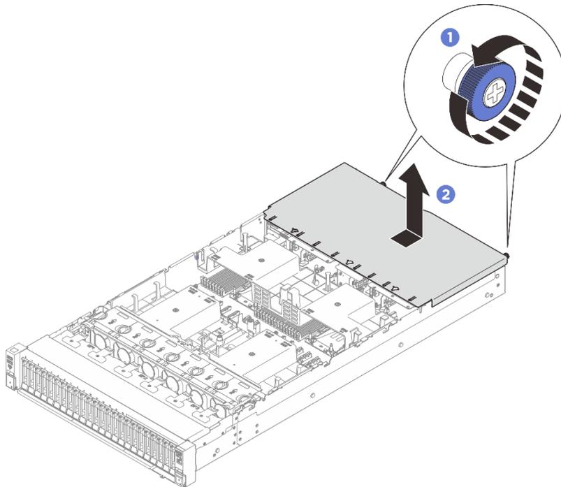
Figura 234. Extracción de la cubierta superior posterior
