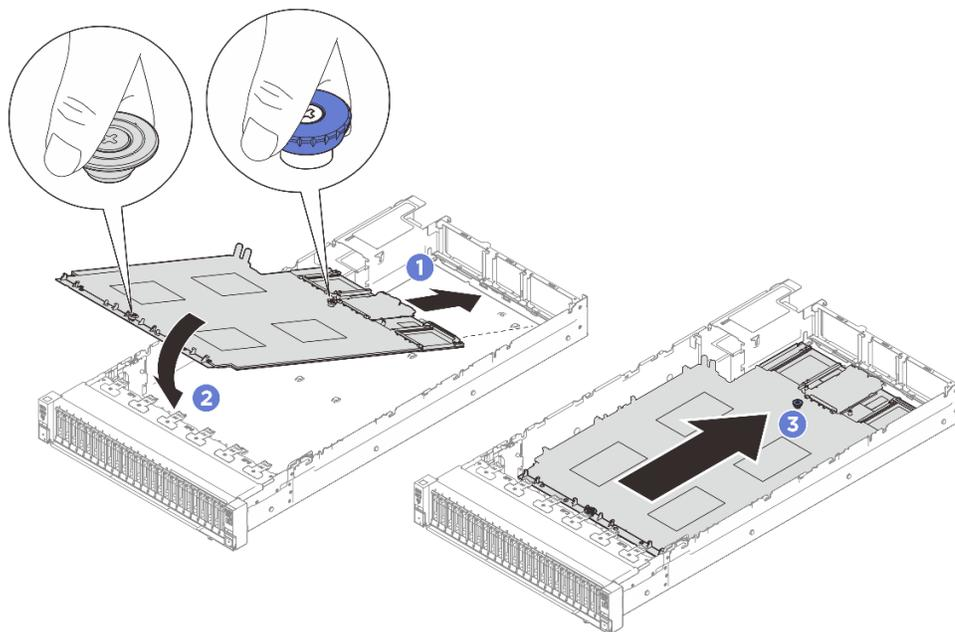
Figura 231. Instalación del conjunto de la placa del sistema
