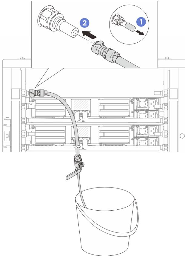
Figura 127. Instalación del kit de purga en el lado de suministro
