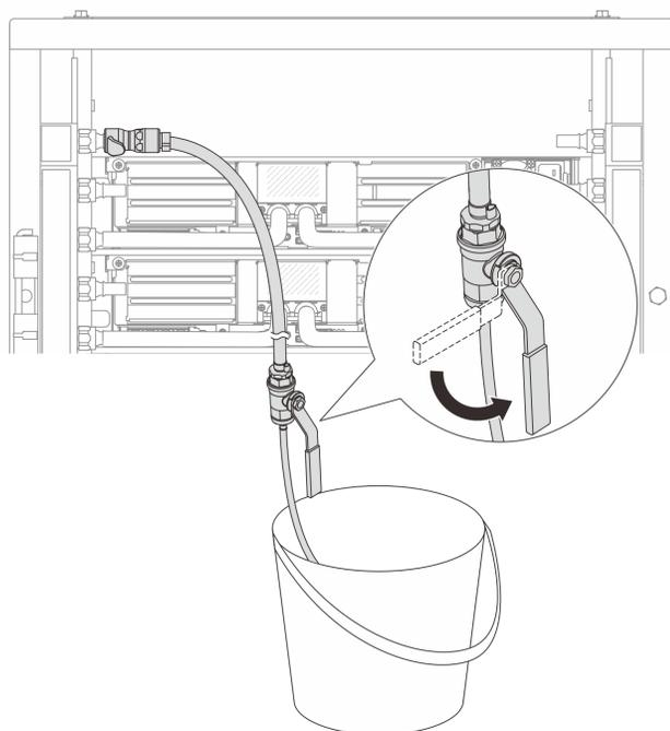
*Figura 146. Apertura de la válvula de purga del lado de suministro*
