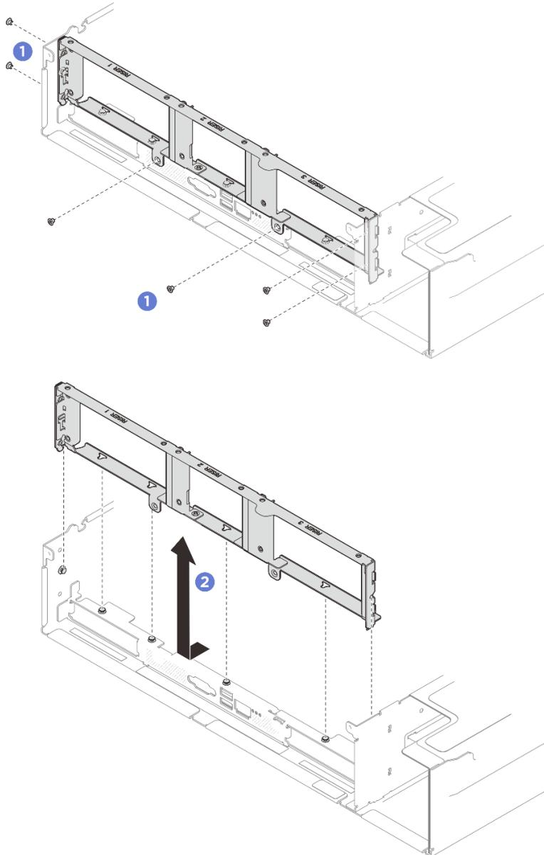
Figura 211. Extracción de la pared posterior
