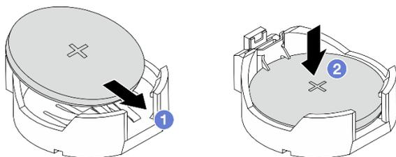
**Nota:** Antes de instalar la batería en el zócalo, asegúrese de que el lado positivo esté hacia arriba.
