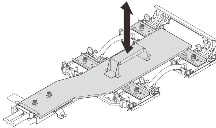
Figura 80. Instalación del transportador de la placa de frío
