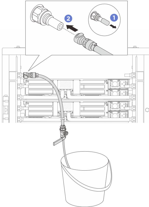
Figura 144. Instalación del kit de purga en el lado de suministro
