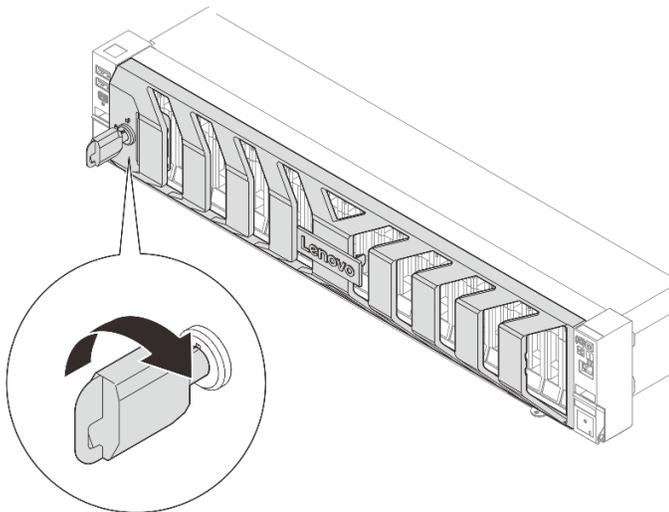
*Figura 213. Desbloqueo del marco biselado de seguridad*
