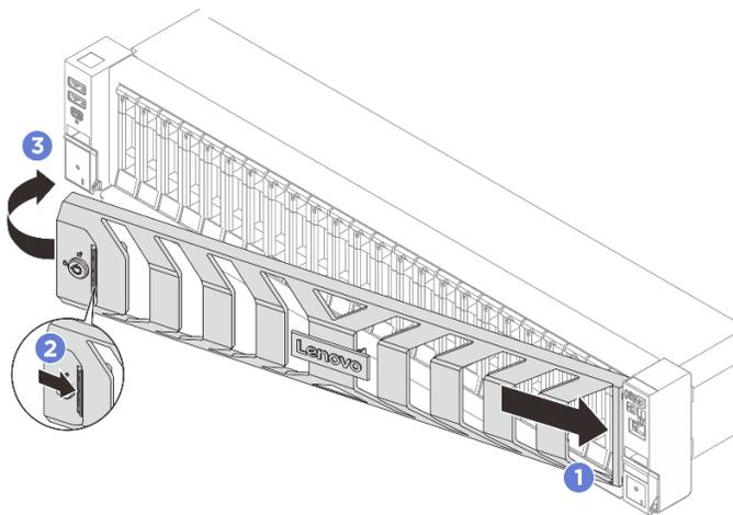
Figura 216. Instalación del marco biselado de seguridad
