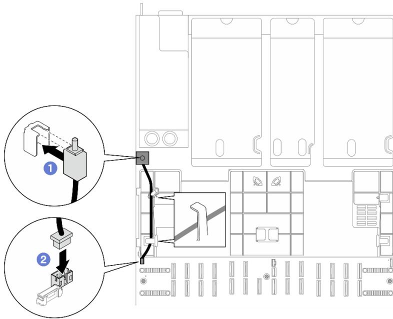
Figura 76. Instalación del conmutador de intrusión
