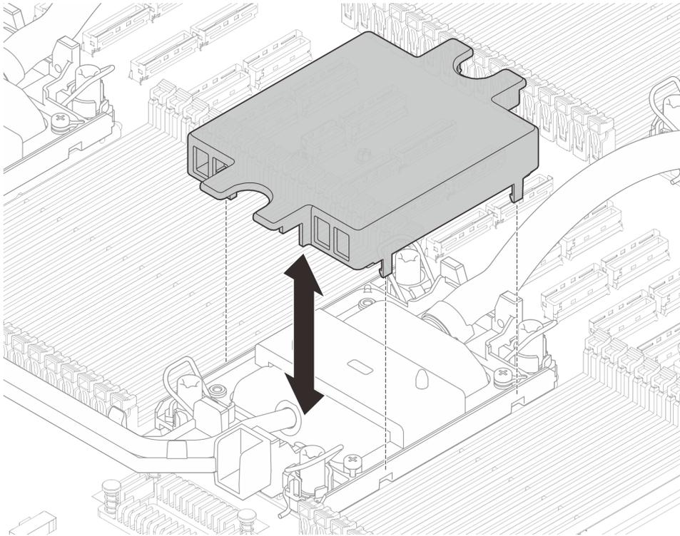
Figura 258. Extracción de la cubierta de la placa de frío
