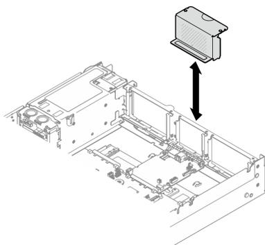
Figura 94. Instalación del relleno de expansión
