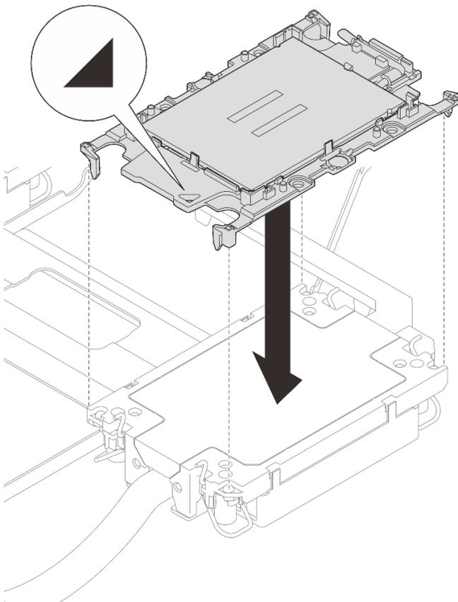
Figura 87. Instalación del procesador en la placa de frío
