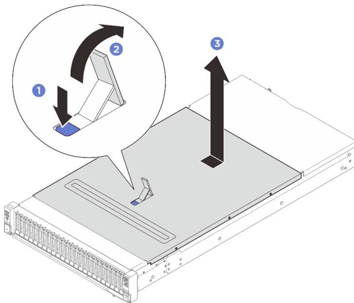
Figura 233. Extracción de la cubierta superior frontal
