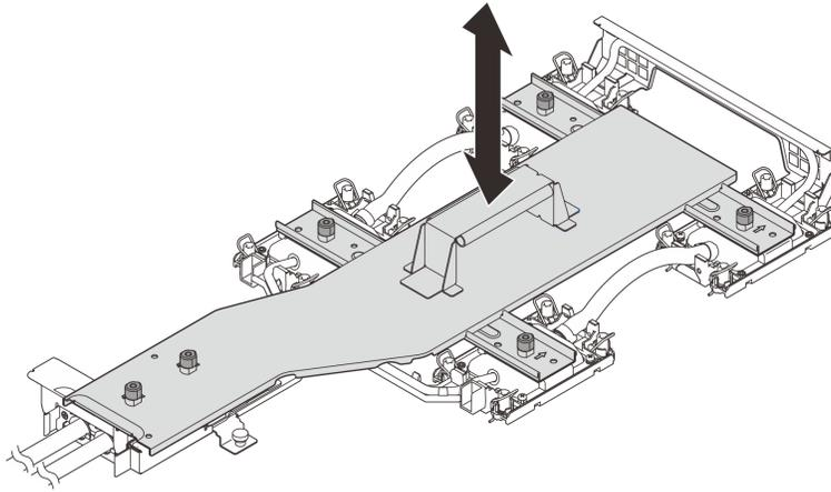
*Figura 92. Extracción del transportador de la placa de frío*
