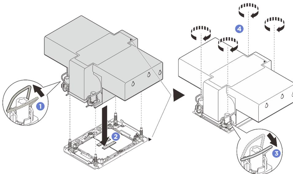
Figura 200. Instalación de PHM de rendimiento 2U
