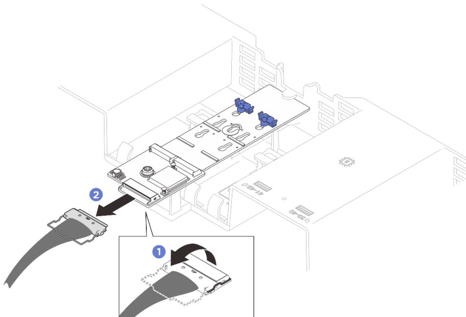
Figura 97. Desconexión de los cables del adaptador de arranque M.2
