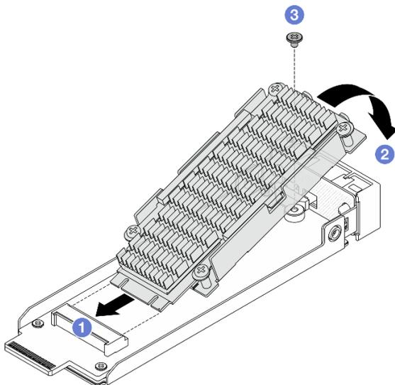
Figura 72. Instalación de la unidad M.2 con dissipador de calor
