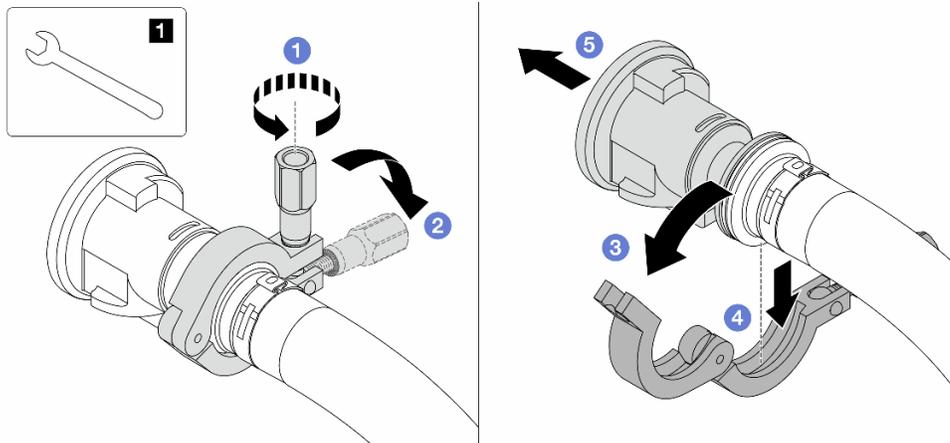
Figura 120. Separación de válvulas de bola
