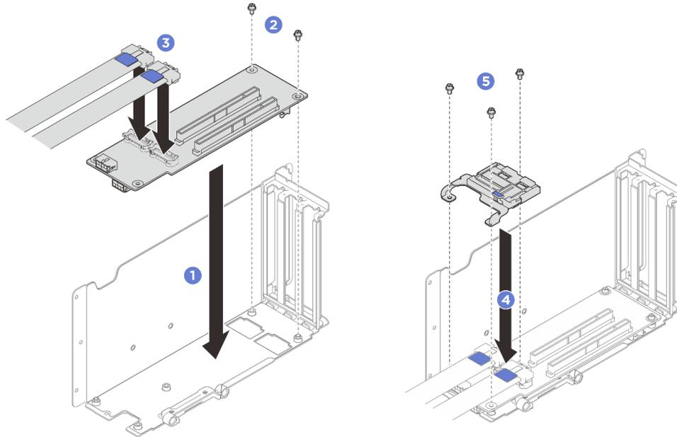
Figura 178. Instalación de la tarjeta de expansión PCIe
