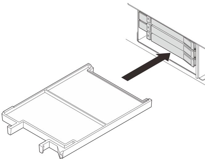
Figura 42. Instalación de un relleno de bahía
