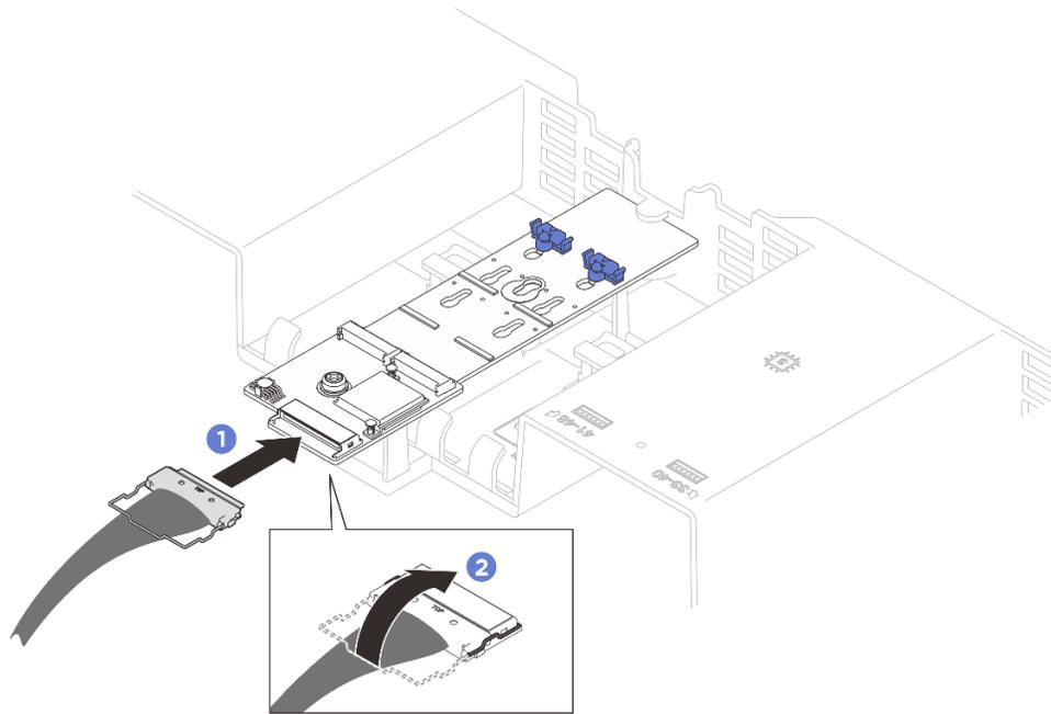
Figura 100. Conexión de los cables del adaptador de arranque M.2
