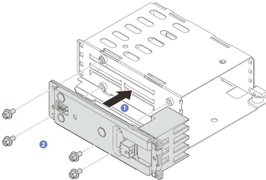
Figura 47. Instalación del conjunto de placa posterior
