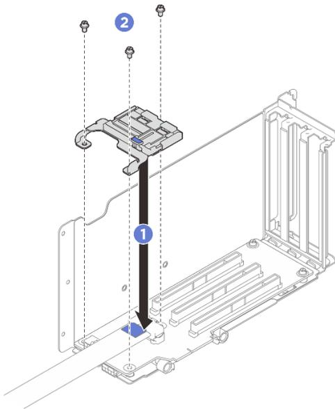
Figura 182. Instalación del elemento de sujeción de PCIe
