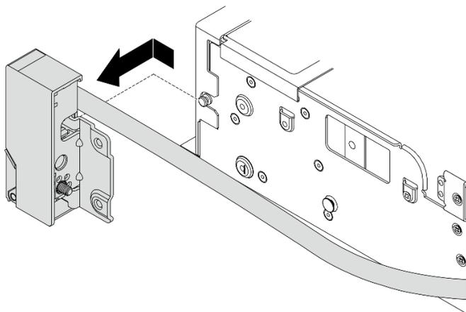
Figura 203. Extracción del pestillo del bastidor
