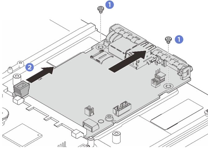
Figura 225. Extracción de la placa de E/S del sistema
