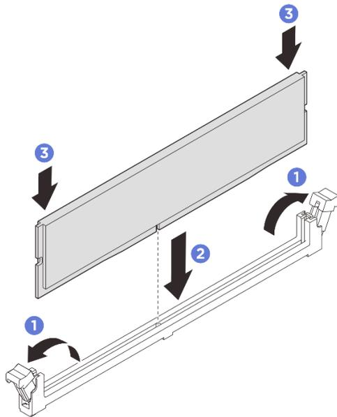
Figura 155. Instalación de un módulo de memoria
