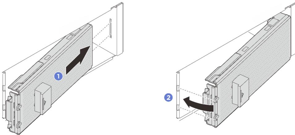
Figura 32. Instalación del marco biselado de E3.S
