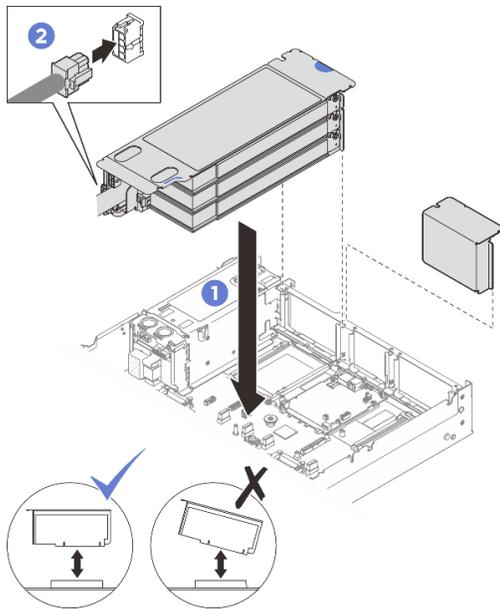
Figura 171. Instalación de la expansión PCIe de LP (con conector de alimentación)
