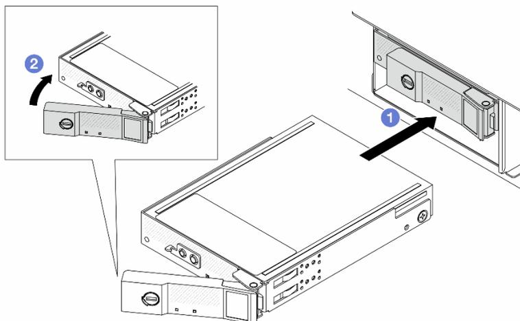
Figura 29. Instalación de un CMM E3.S
