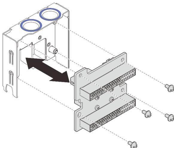
Figura 186. Desensamblaje de la placa de distribución de alimentación
