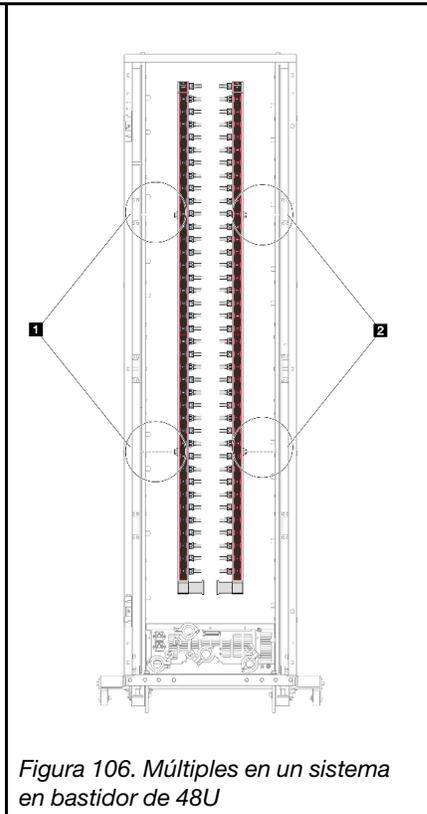
Figura 106. Múltiples en un sistema en bastidor de 48U
