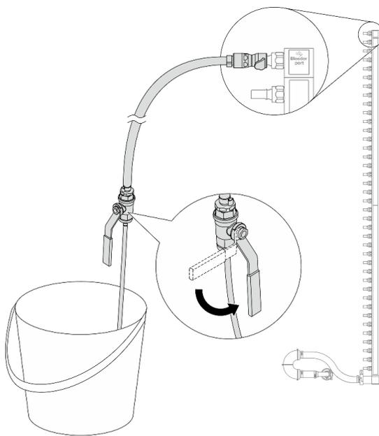
Figura 117. Apertura de la válvula de purga
