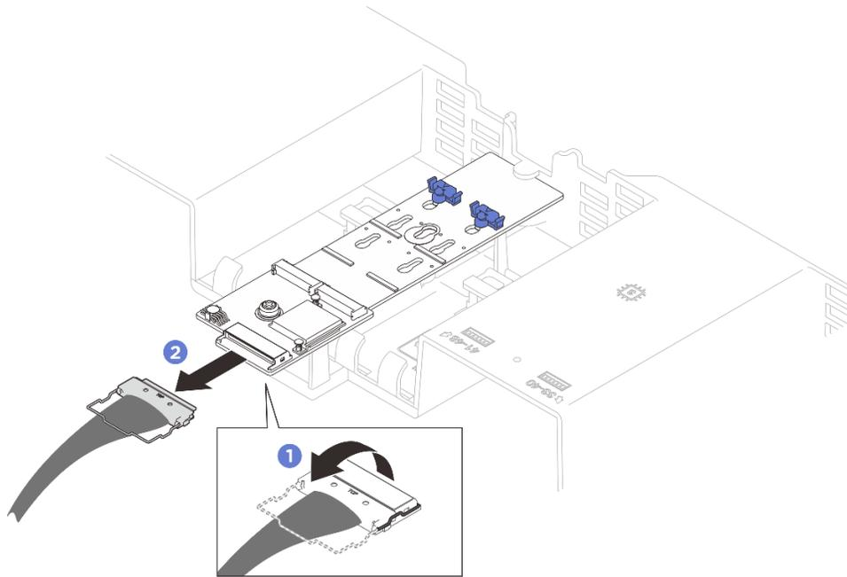
Figura 15. Desconexión de los cables del adaptador de arranque M.2
