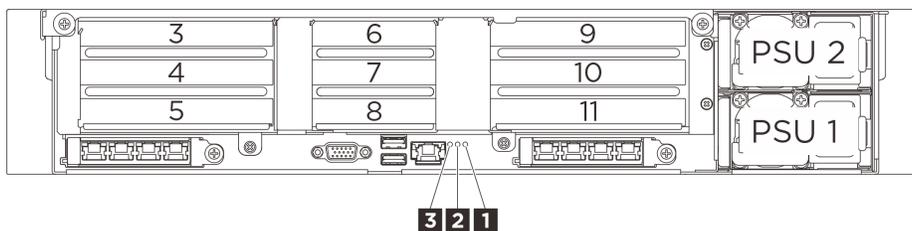
Figura 253. LED del sistema posterior
