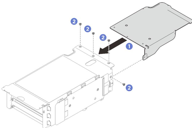
Figura 184. Instalación del amplificador de expansión PCIe
