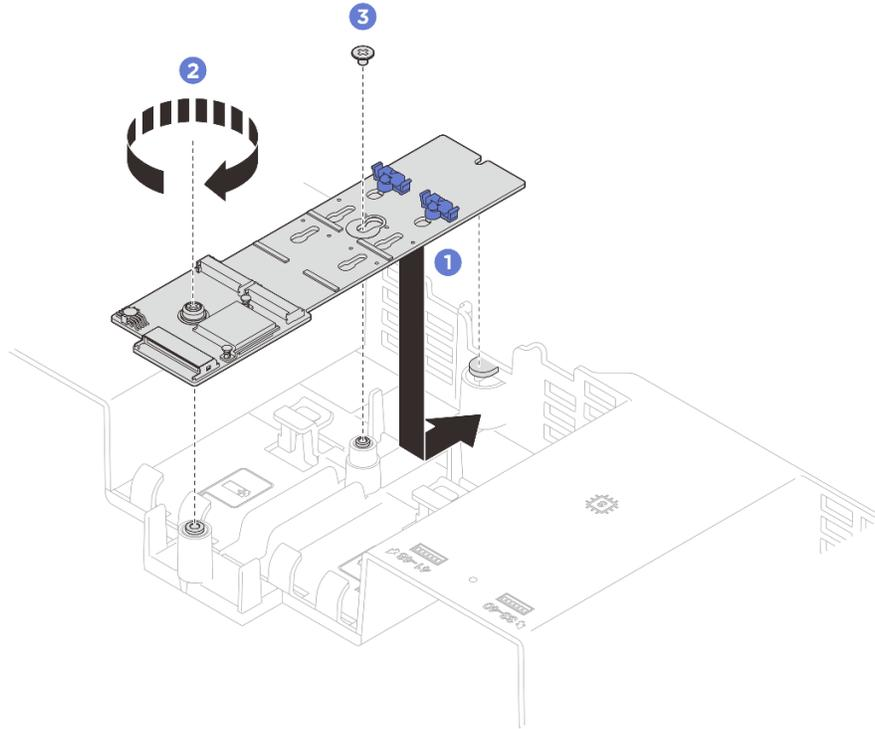
Figura 99. Instalación del adaptador de arranque M.2
