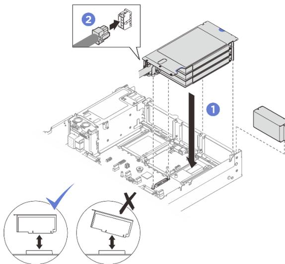
Figura 172. Instalación de expansión PCIe de FHHL
