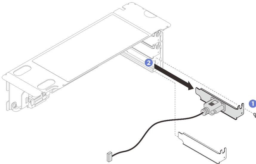
Figura 218. Extracción del módulo de puerto serie
