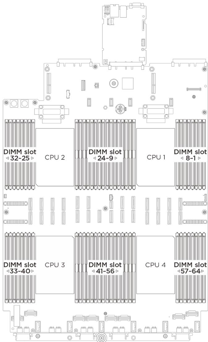
Figura 154. Diseño de los módulos de memoria y el procesador
