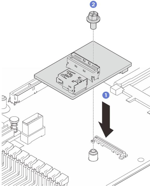
Figura 239. Instalación de la placa de E/S USB
