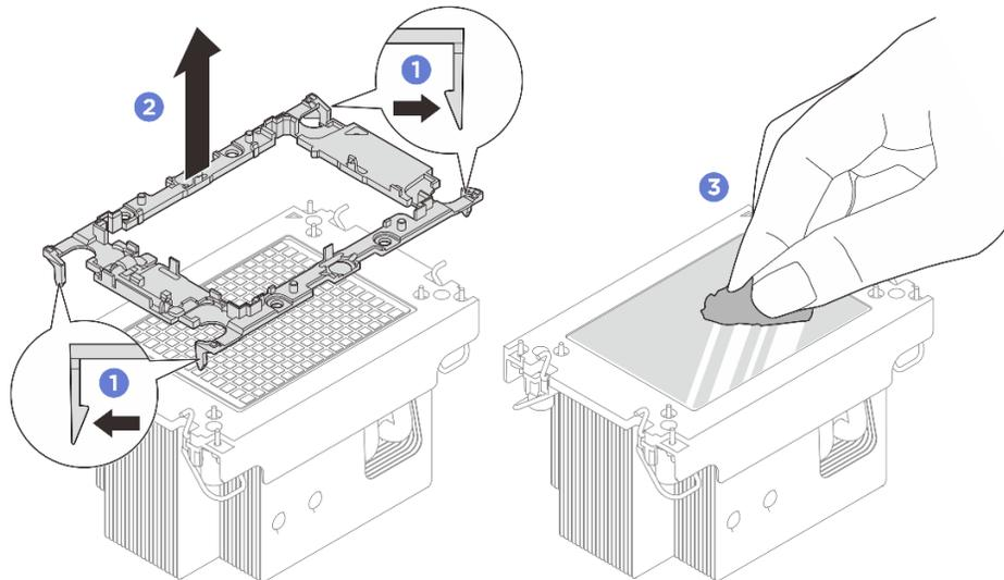
Figura 194. Separación de un transportador de procesador del disipador de calor
