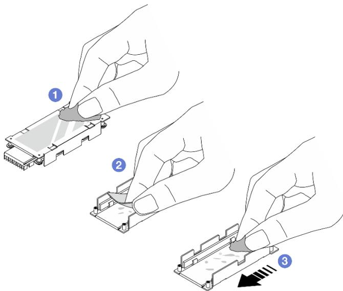
Figura 68. Limpieza del disipador de calor y de la placa inferior
