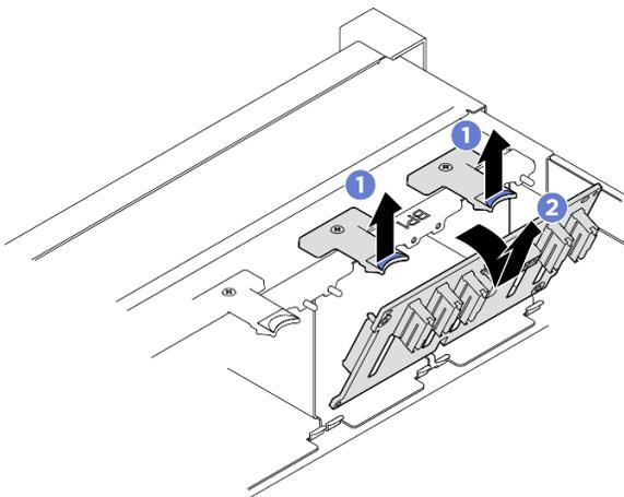
Figura 5. Extracción de la placa posterior de la unidad de 2,5 pulgadas
