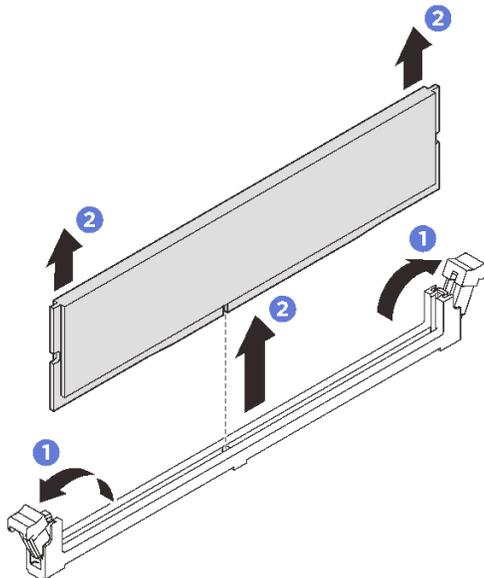
Figura 153. Extracción del módulo de memoria
