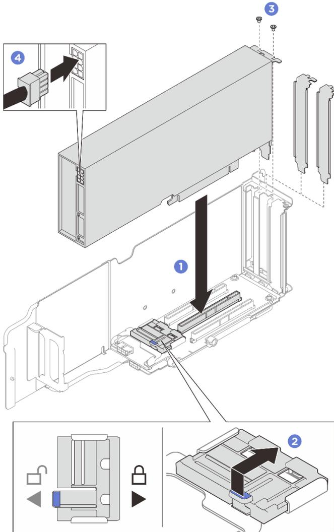
Figura 61. Instalación de un adaptador de GPU de ancho doble
