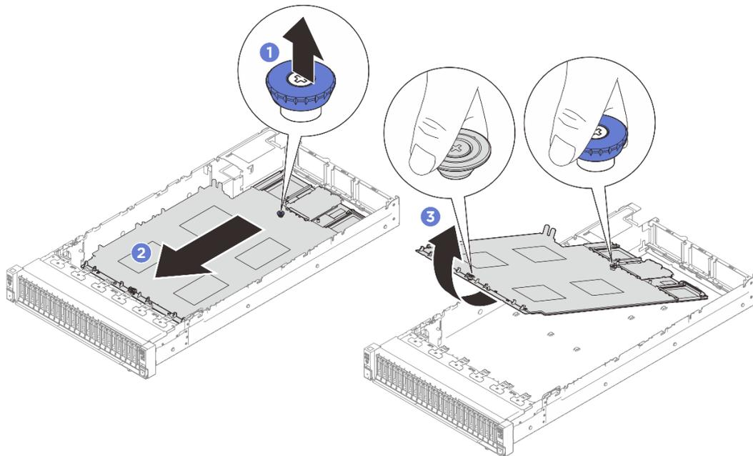
*Figura 228. Extracción del conjunto de la placa del sistema*
