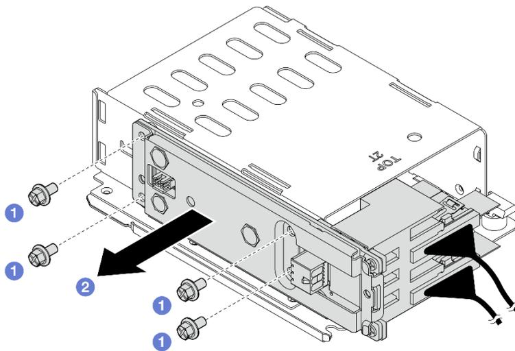
Figura 34. Extracción de la placa posterior
