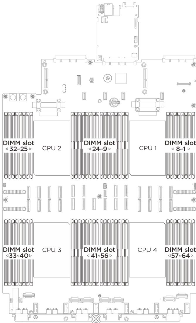
Figura 152. Diseño de los módulos de memoria y el procesador
