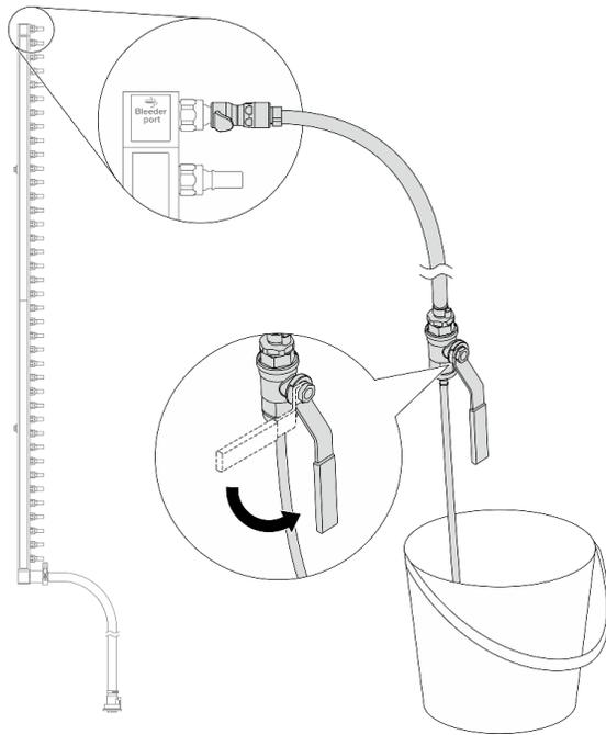
*Figura 137. Apertura de la válvula de purga*
