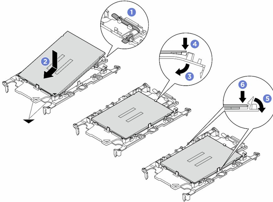
Figura 85. Instalación del transportador del procesador
