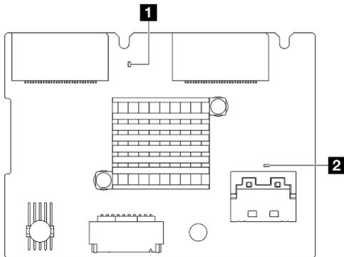
Figura 252. LED del adaptador de arranque M.2 posterior
