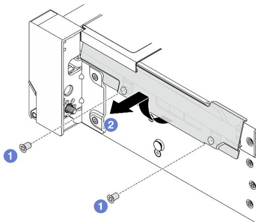
Figura 201. Extracción del soporte de cable
