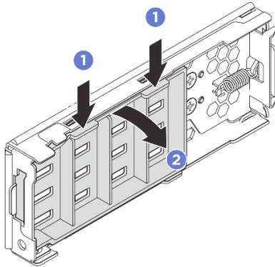
Figura 31. Extracción de la placa interior
