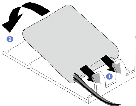
Figura 56. Instalación del módulo de alimentación flash
