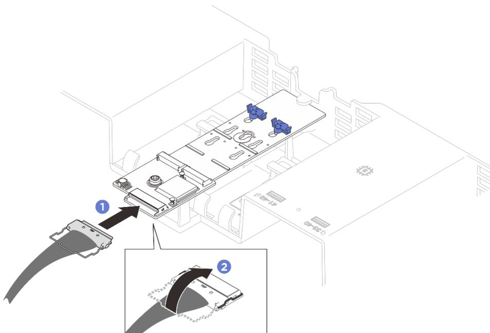
Figura 18. Conexión de los cables del adaptador de arranque M.2
