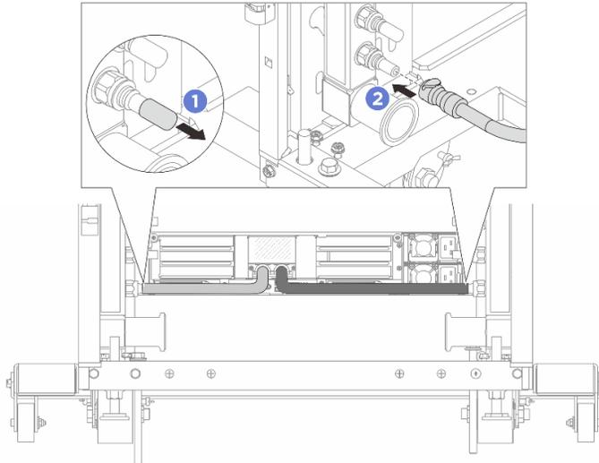
*Figura 142. Instalación del conector rápido*
