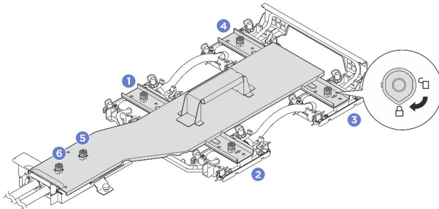
Figura 81. Fijación del transportador de la placa de frío
