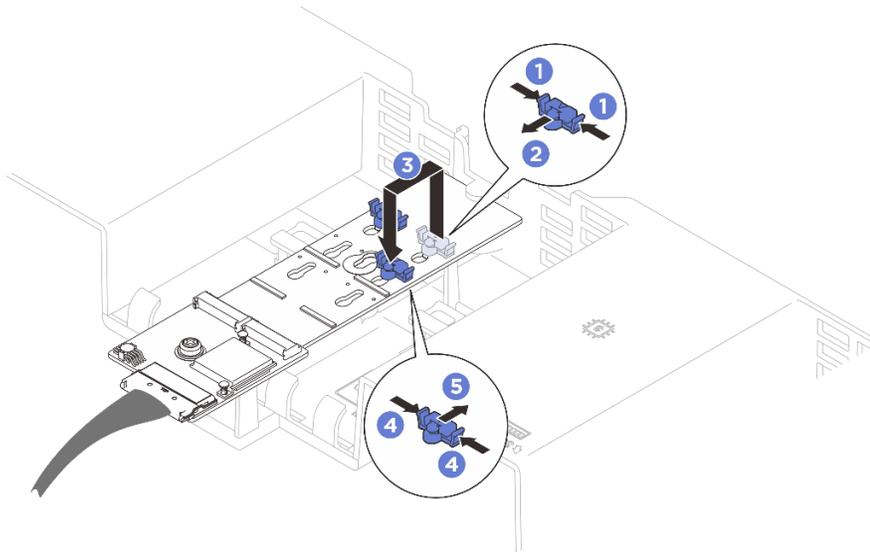
Figura 101. Ajuste del elemento de sujeción del adaptador de arranque M.2
