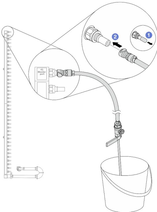
*Figura 114. Instalación del kit de purga en el lado de suministro*
