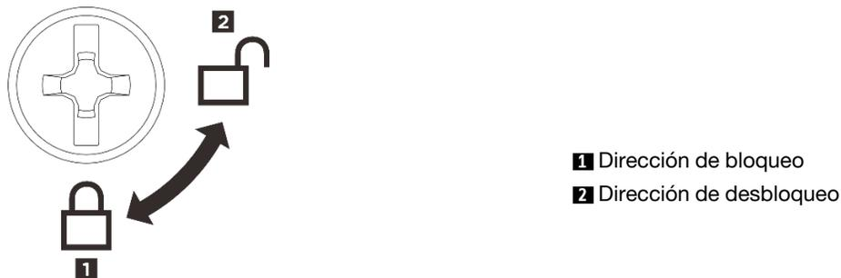
Figura 232. Dirección de bloqueo/desbloqueo de la cubierta superior frontal
