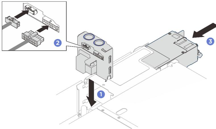
Figura 187. Instalación de la placa de distribución de alimentación
