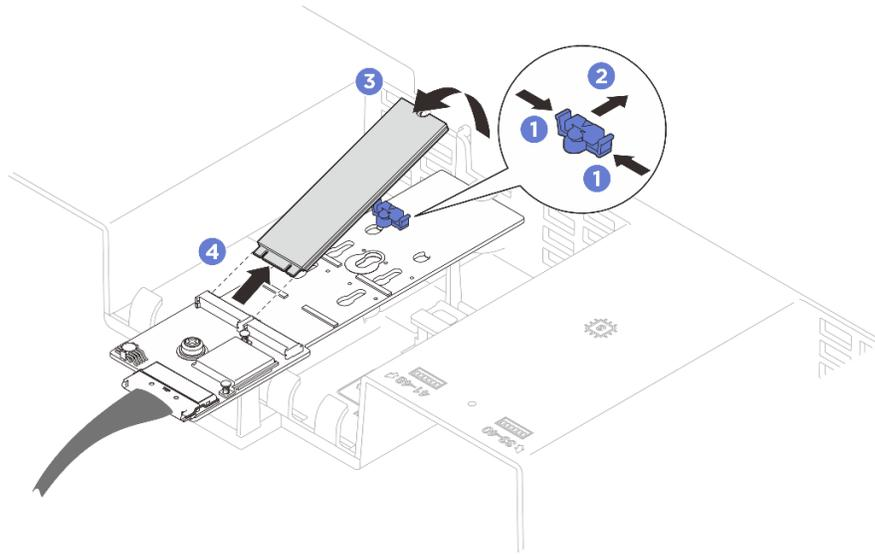
Figura 96. Extracción de la unidad M.2
