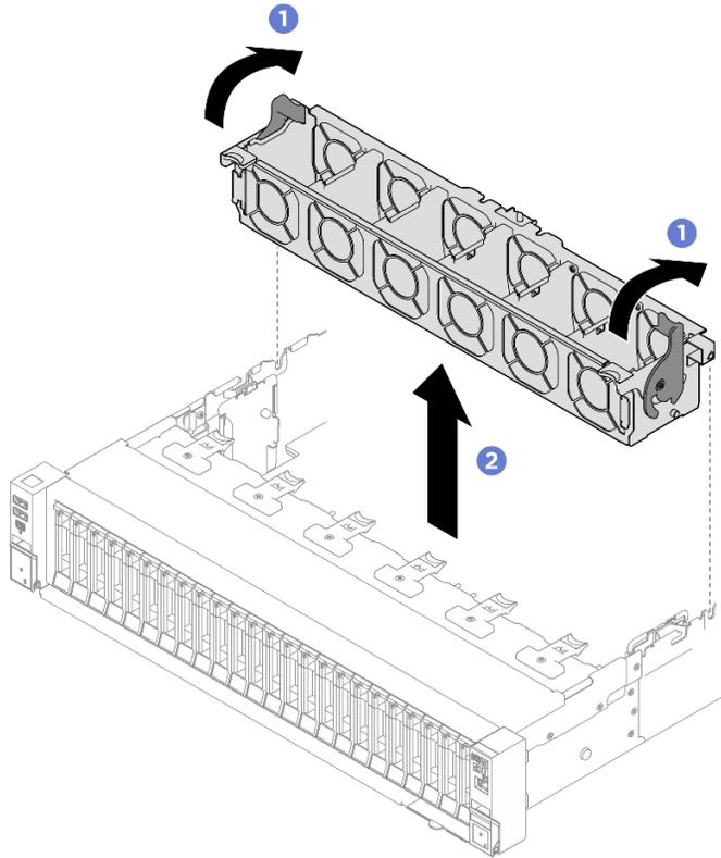
Figura 50. Extracción de la caja del ventilador
