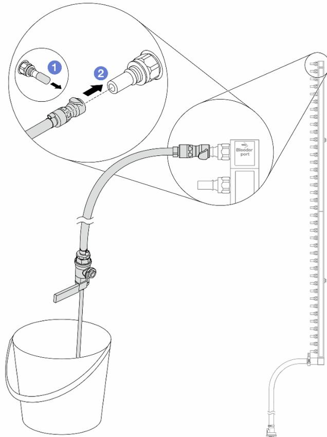
Figura 138. Instalación del kit de purga en el lado de retorno
