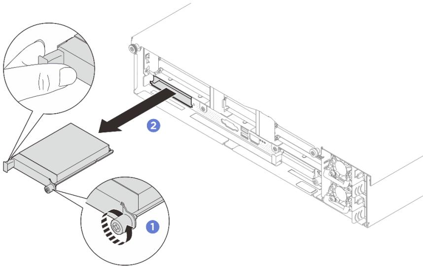
Figura 158. Extracción del módulo de OCP
