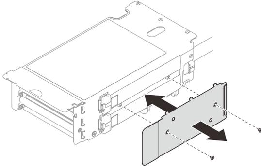
Figura 180. Instalación de la cubierta de cable
