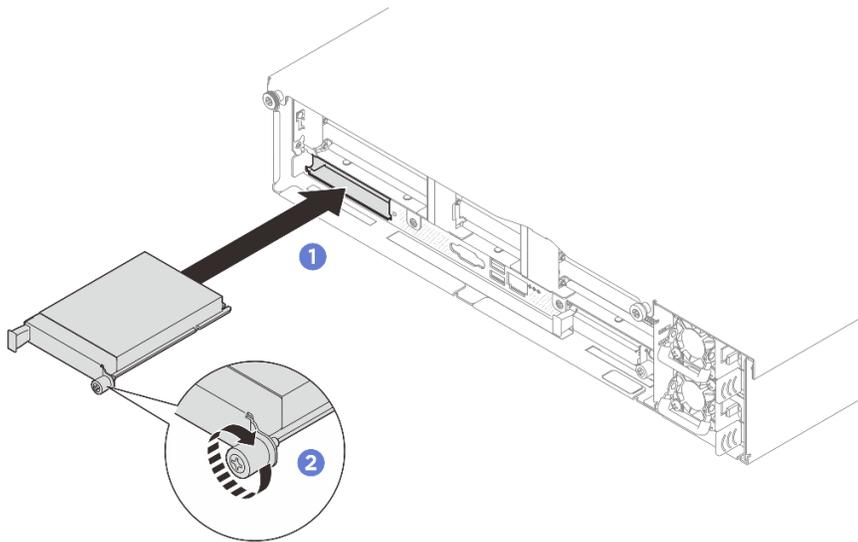
Figura 159. Instalación del módulo de OCP
