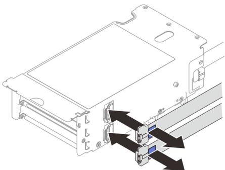
Figura 175. Desconexión de cable
