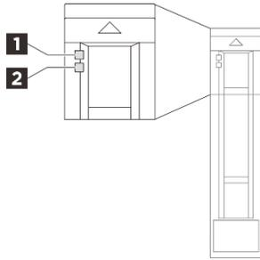
Figura 243. LED de la unidad de 2,5 pulgadas
