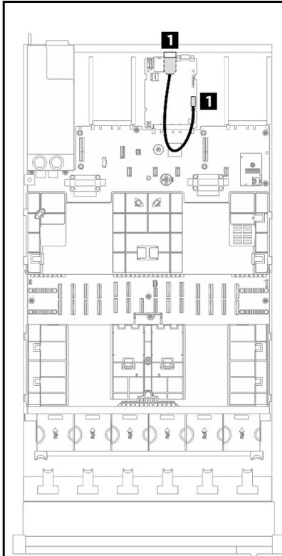
Figura 221. Disposición de los cables del módulo de puerto de serie para el modelo de servidor con tres tarjetas de expansión PCIe
