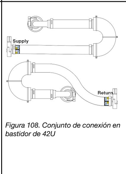
Figura 108. Conjunto de conexión en bastidor de 42U
