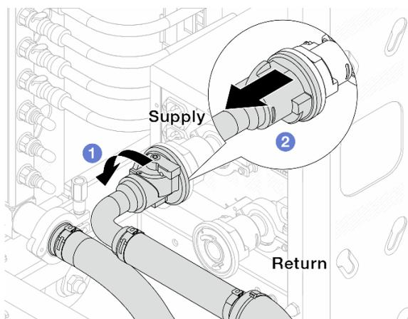
Figura 112. Extracción del conjunto de conexión
