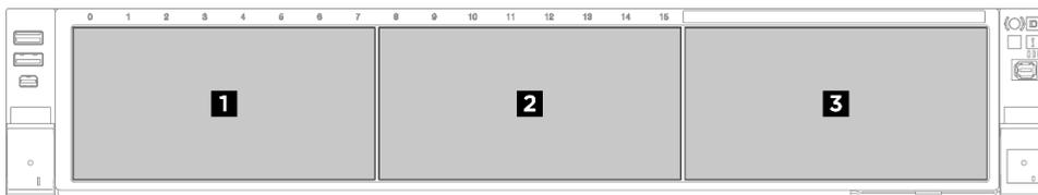
Figura 2. Numeración de la placa posterior de unidad de 2,5 pulgadas
