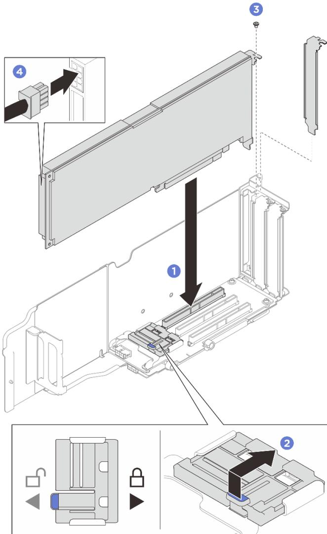
Figura 60. Instalación de un adaptador de GPU de ancho único
