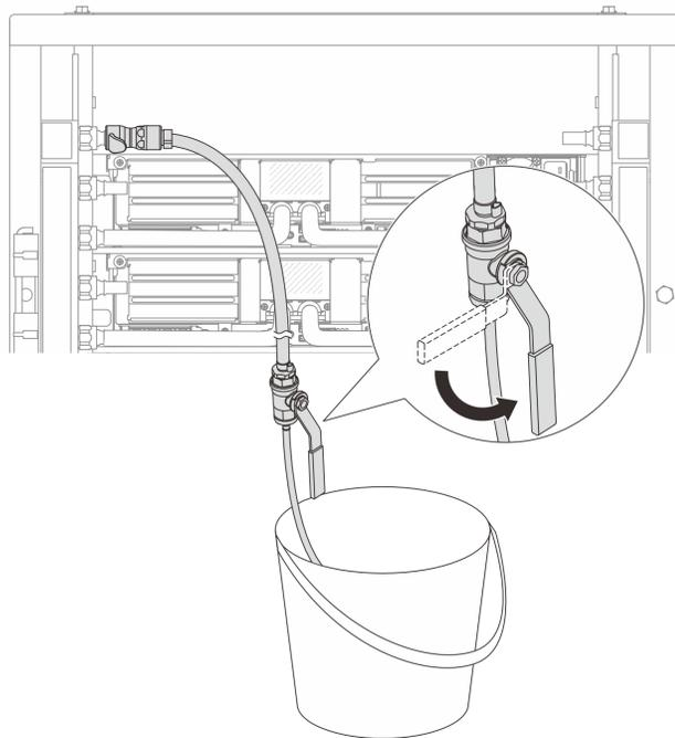
Figura 132. Apertura de la válvula de purga del lado de suministro
