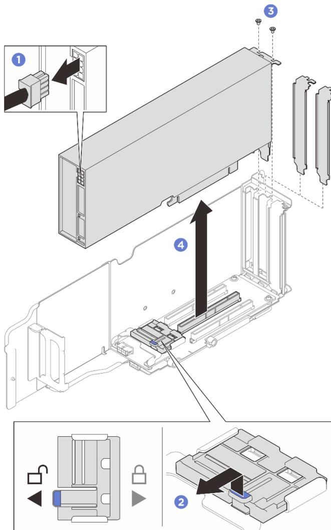
Figura 59. Extracción un adaptador de GPU de ancho doble
