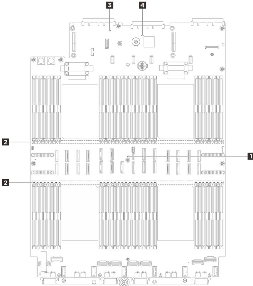
Figura 254. LED de la placa del procesador
