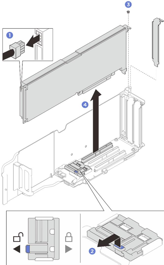
Figura 58. Extracción un adaptador de GPU de ancho único
