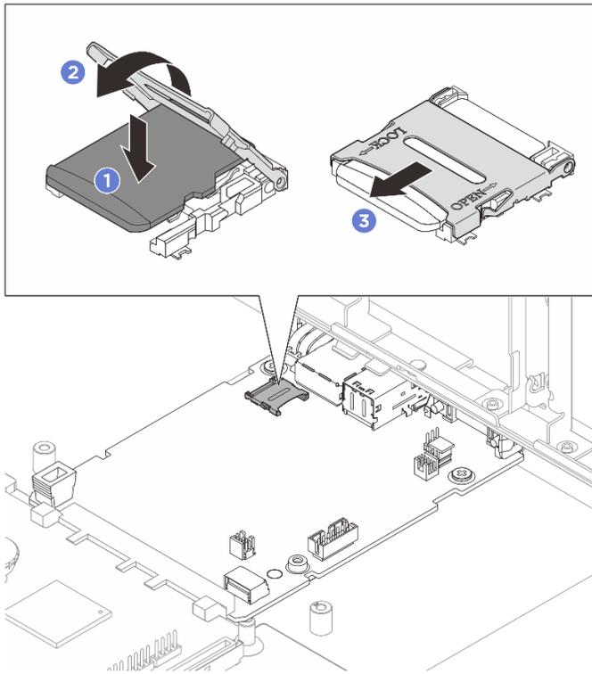
Figura 157. Tarjeta microSD, instalación
