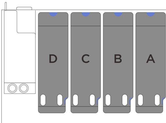
Figura 170. Modelos de servidor con cuatro tarjetas de expansión PCIe
