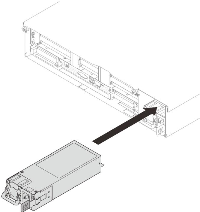
*Figura 189. Instalación de la unidad de fuente de alimentación*
