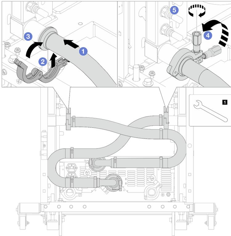
Figura 122. Instalación de conjunto de conexión
