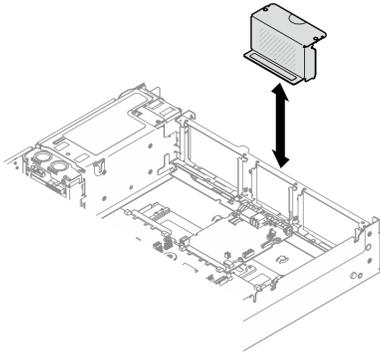
*Figura 78. Extracción del relleno de expansión*
