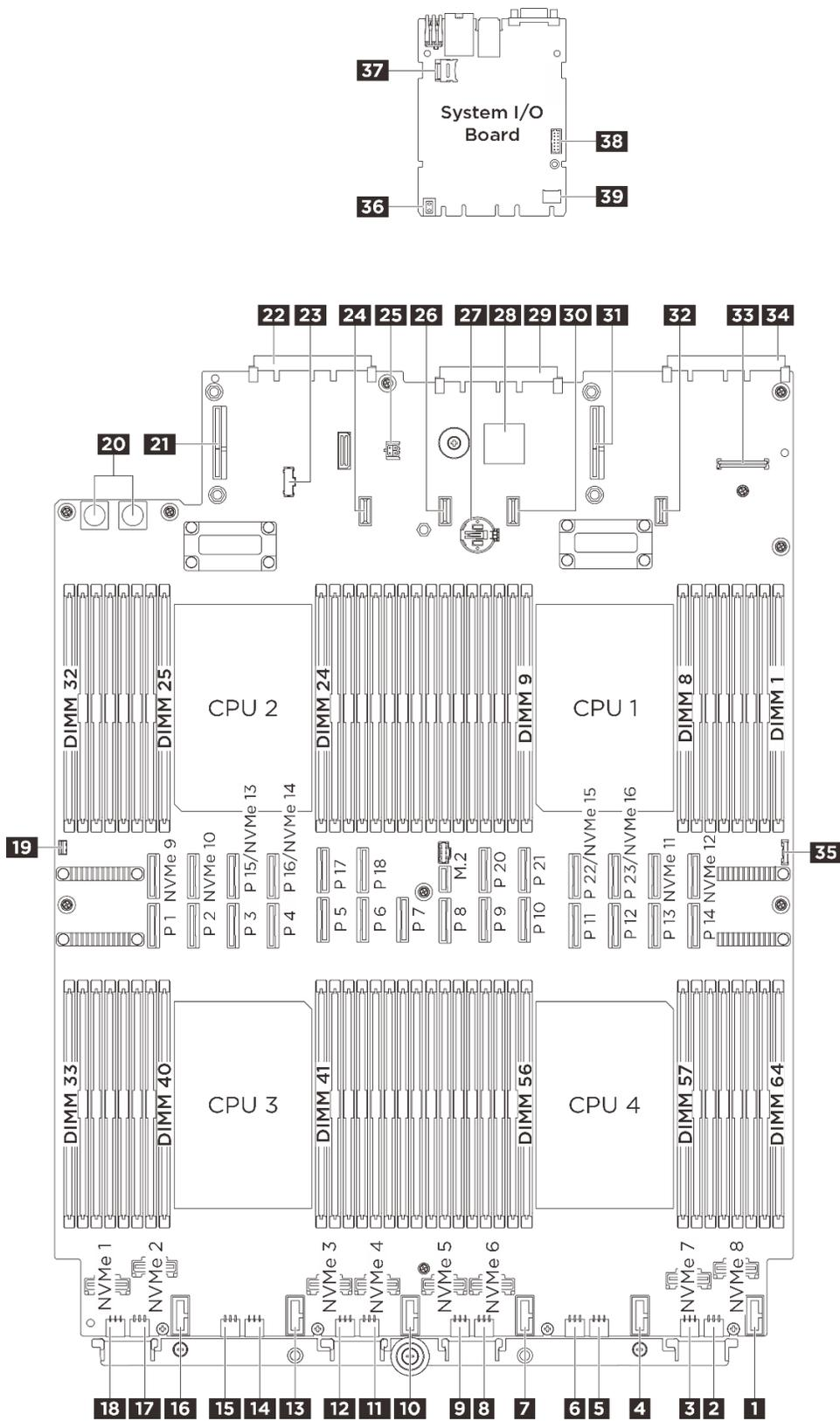
Figura 242. Conectores del conjunto de la placa del sistema
