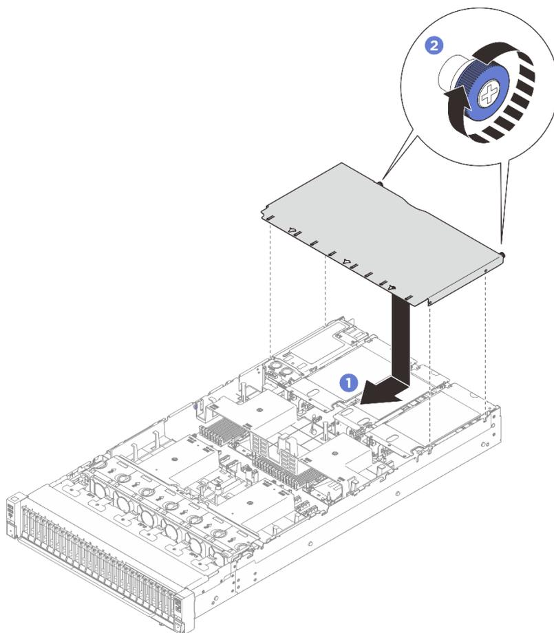
Figura 235. Instalación de la cubierta superior posterior
