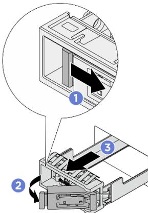
Figura 73. Extracción de una bandeja de unidad M.2
