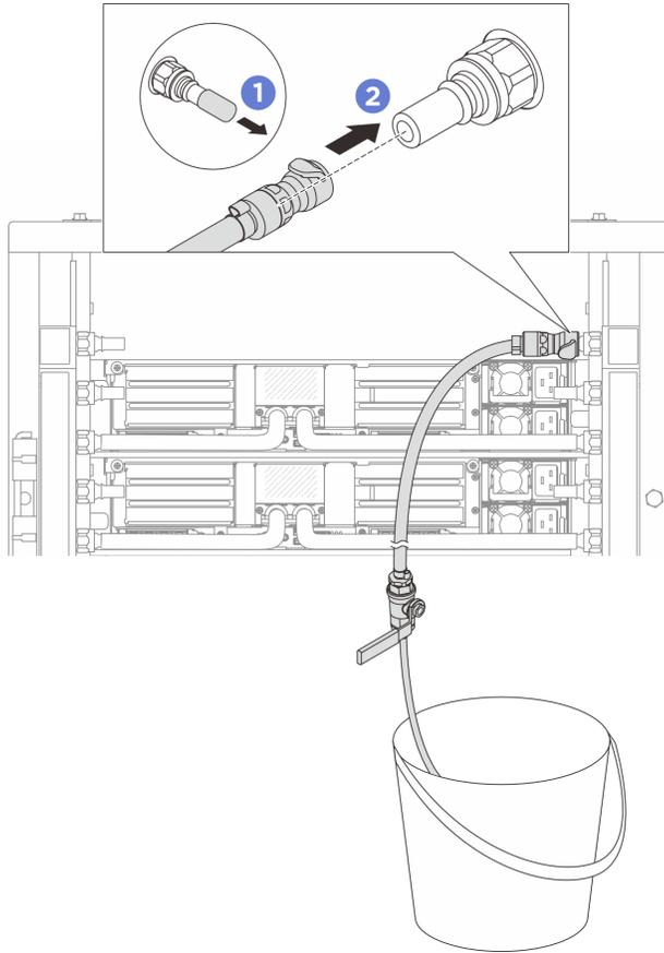
Figura 147. Instalación del kit de purga en el lado de retorno
