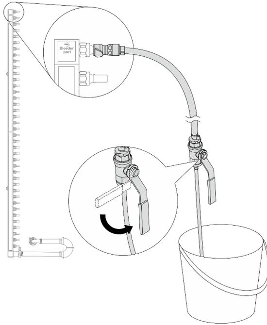
Figura 115. Apertura de la válvula de purga
