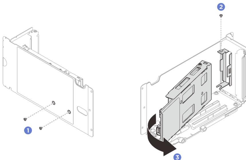
Figura 207. Extracción del compartimiento de la unidad M.2
