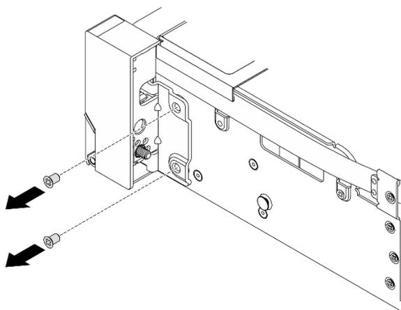
Figura 202. Extracción de los tornillos
