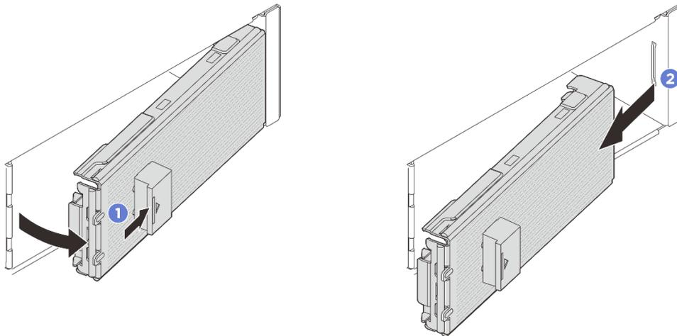
Figura 27. Extracción del marco biselado de E3.S
