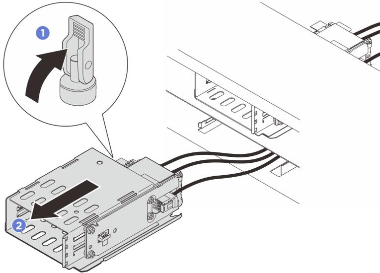
Figura 45. Extracción del compartimiento de E3.S 1T
