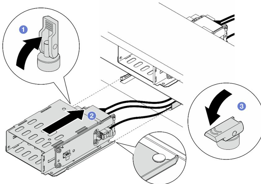
Figura 36. Instalación del compartimento de E3.S 2T
