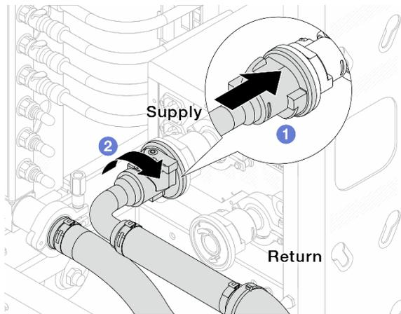
Figura 123. Conexión de válvulas de bola
