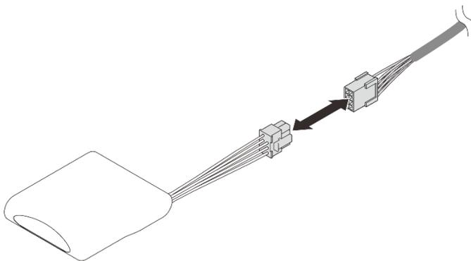
Figura 8. Desconexión del cable del módulo de alimentación flash
