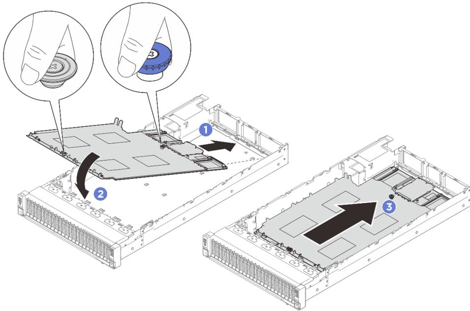
Figura 227. Instalación del conjunto de la placa del sistema
