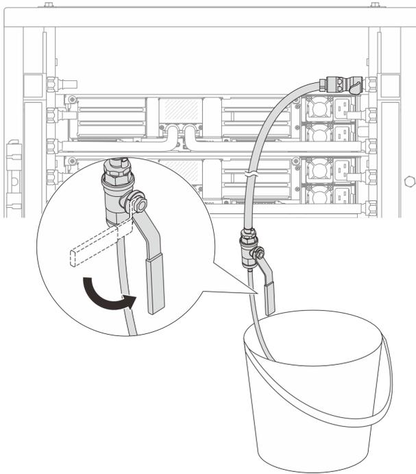
*Figura 131. Apertura de la válvula de purga del lado de retorno*
