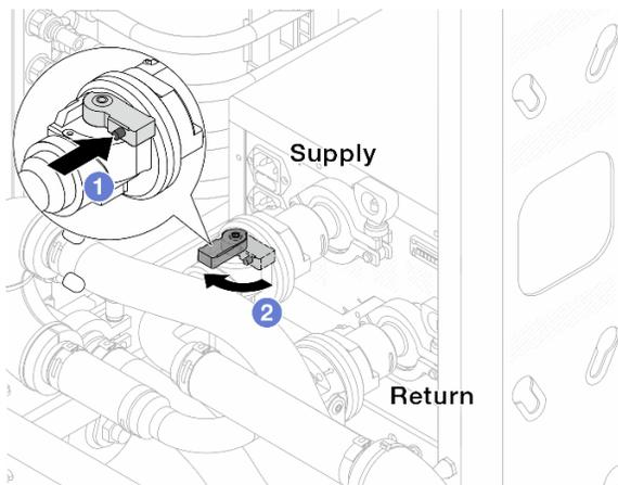
Figura 128. Apertura de las válvulas de bola
