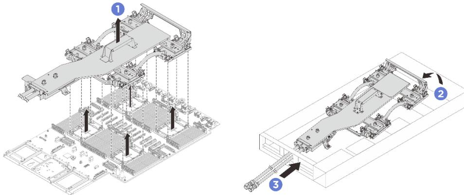
Figura 84. Extracción del conjunto de la placa de frío
