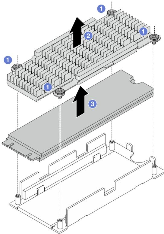
Figura 67. Separación de la unidad M.2 y el disipador de calor
