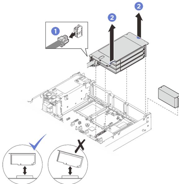
Figura 164. Extracción de una expansión PCIe de FHHL
