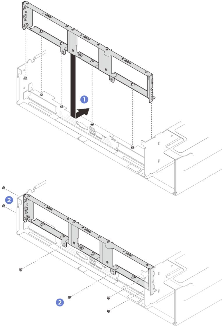
Figura 212. Instalación del muro posterior
