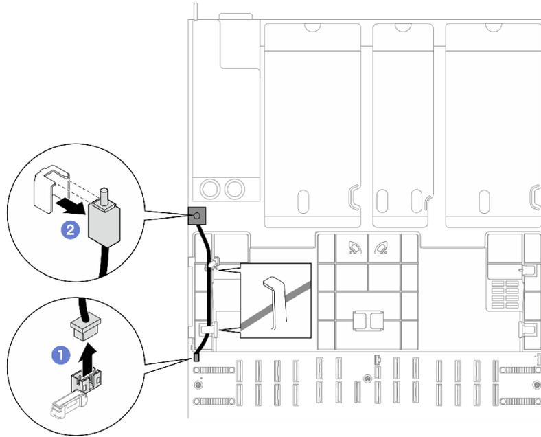
Figura 75. Extracción del conmutador de intrusión
