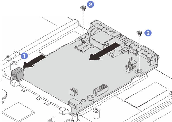
Figura 226. Instalación de la placa de E/S del sistema
