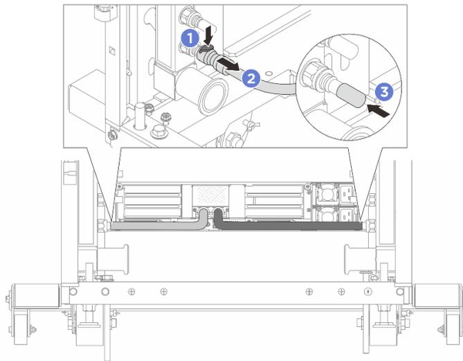
Figura 111. Extracción de los conectores rápidos
