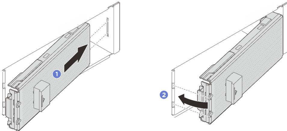
Figura 44. Instalación del marco biselado de E3.S
