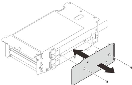
*Figura 174. Extracción de la cubierta del cable*
