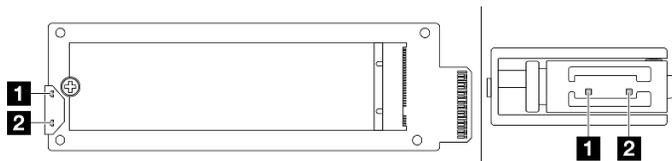
Figura 251. LED de la tarjeta de interposición M.2 posterior
