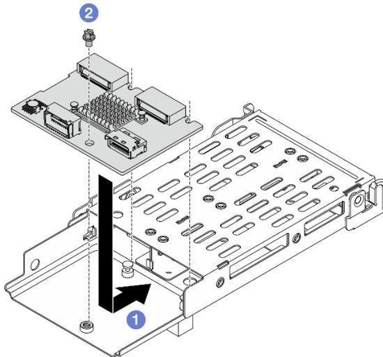
Figura 209. Instalación del adaptador de arranque M.2
