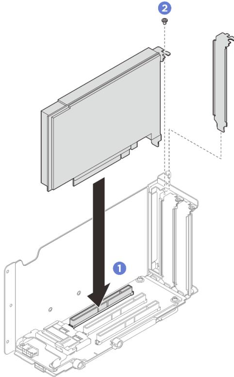
Figura 167. Instalación de adaptador PCIe
