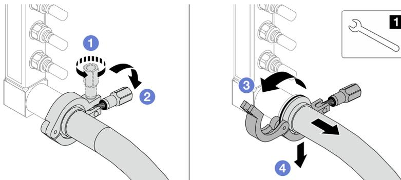
Figura 140. Separación del múltiple del kit de manguera
