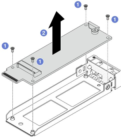
Figura 66. Extracción del intercalador M.2
