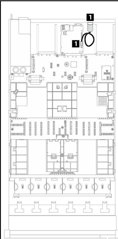
Figura 222. Disposición de los cables del módulo de puerto de serie para el modelo de servidor con cuatro tarjetas de expansión PCIe
