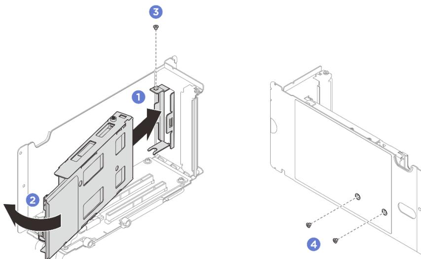
Figura 210. Instalación del compartimiento de la unidad M.2
