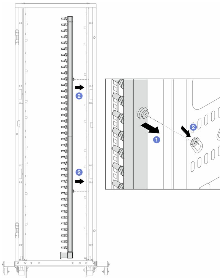
Figura 141. Instalación del múltiple
