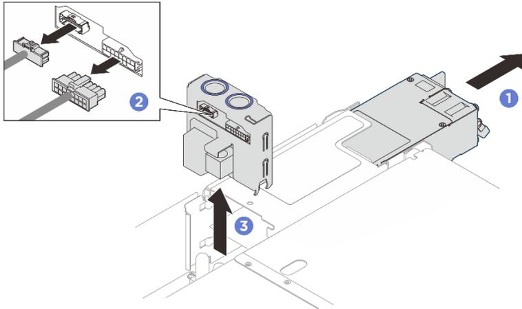
Figura 185. Extracción de la placa de distribución de alimentación
