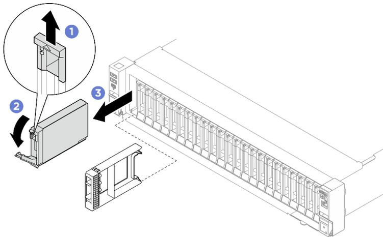
Figura 4. Extracción de la unidad de intercambio en caliente de 2,5 pulgadas
