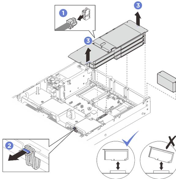
Figura 165. Extracción de una expansión PCIe de FHFL
