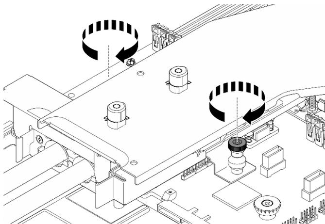
Figura 89. Instalación del conjunto de la placa de frío
