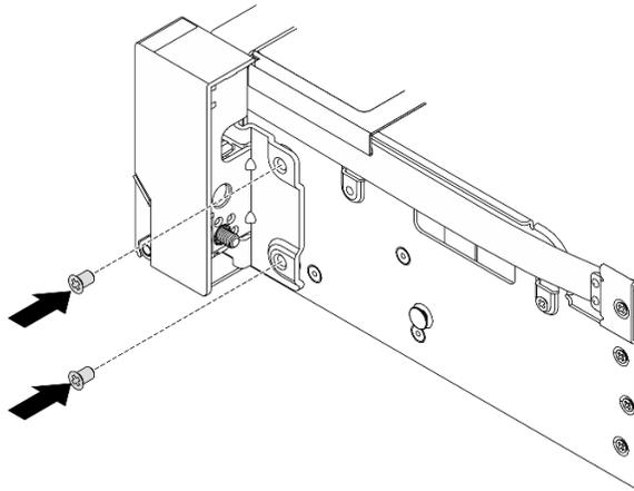
*Figura 205. Instalación de los tornillos*
