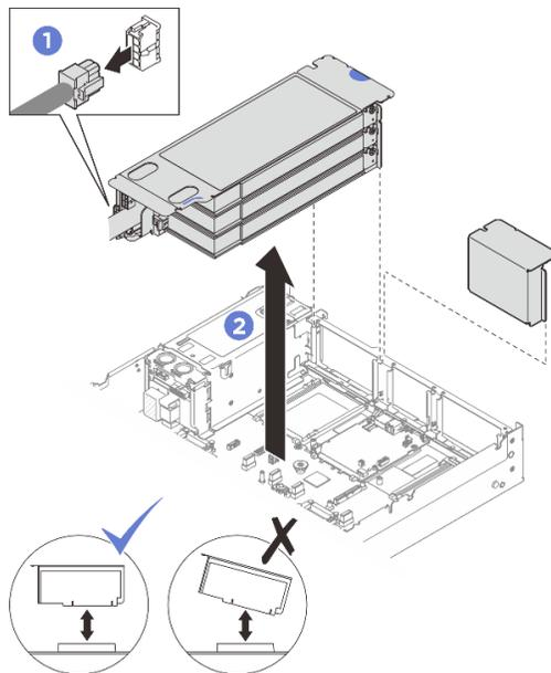
Figura 163. Extracción de la expansión PCIe de LP (con conector de alimentación)
