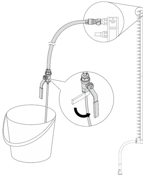
Figura 139. Apertura de la válvula de purga
