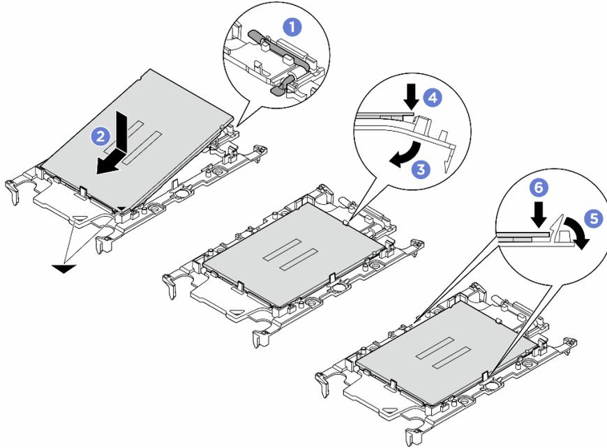
Figura 196. Instalación del transportador del procesador
