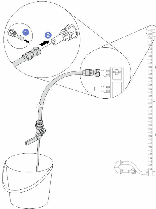
Figura 116. Instalación del kit de purga en el lado de retorno
