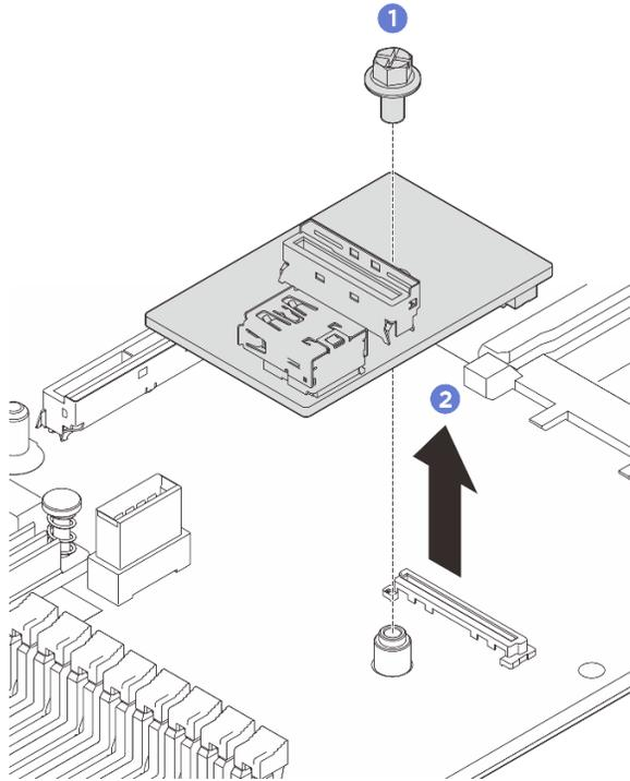
Figura 238. Extracción de la placa de E/S USB
