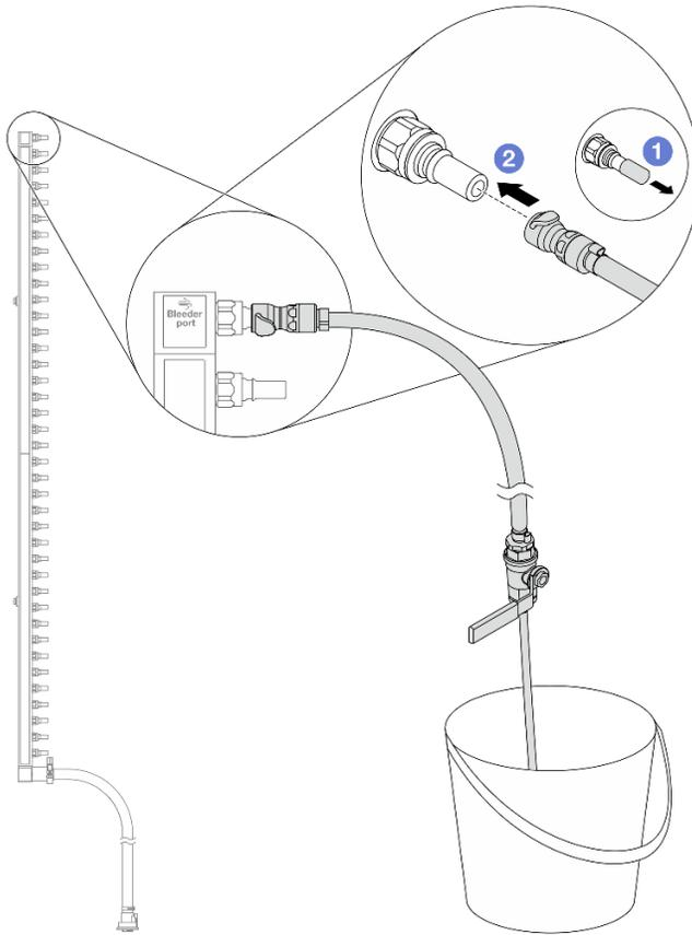
Figura 136. Instalación del kit de purga en el lado de suministro
