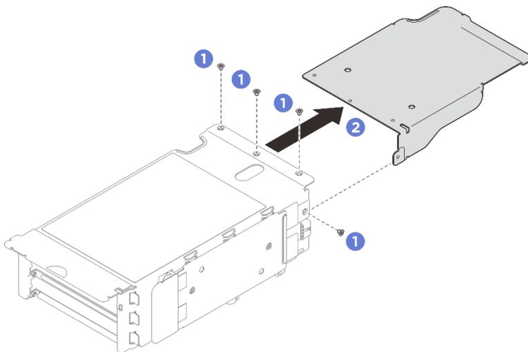
Figura 183. Extracción del amplificador de expansión PCIe
