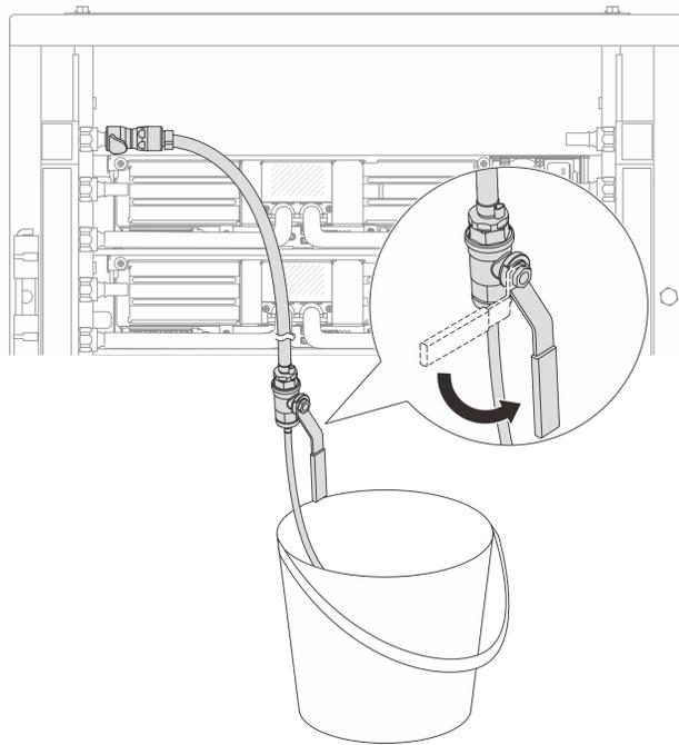
Figura 150. Apertura de la válvula de purga del lado de suministro
