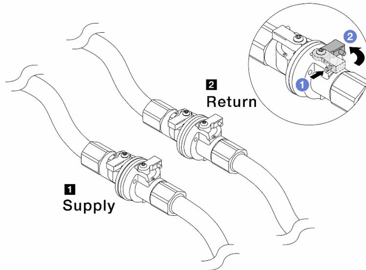
Figura 133. Cierre de las válvulas de bola
