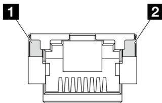
Figura 256. LED en el Puerto de gestión del sistema XCC (10/100/1000 Mbps RJ-45)
