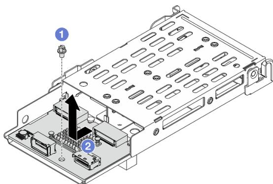
Figura 208. Extracción del adaptador de arranque M.2
