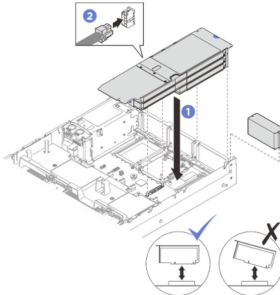
Figura 173. Instalación de expansión PCIe de FHFL
