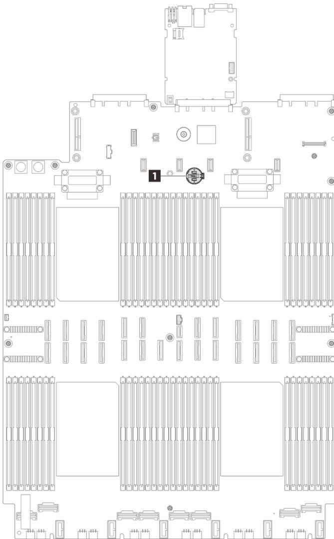
Figura 20. Ubicación de batería CMOS
