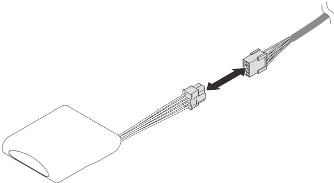
Figura 13. Conexión del cable al módulo de alimentación flash
