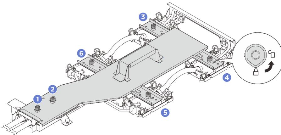
Figura 91. Soltar el transportador de la placa de frío
