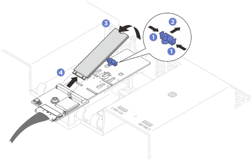
Figura 103. Instalación de la unidad M.2
