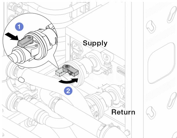
Figura 110. Cierre de las válvulas de bola
