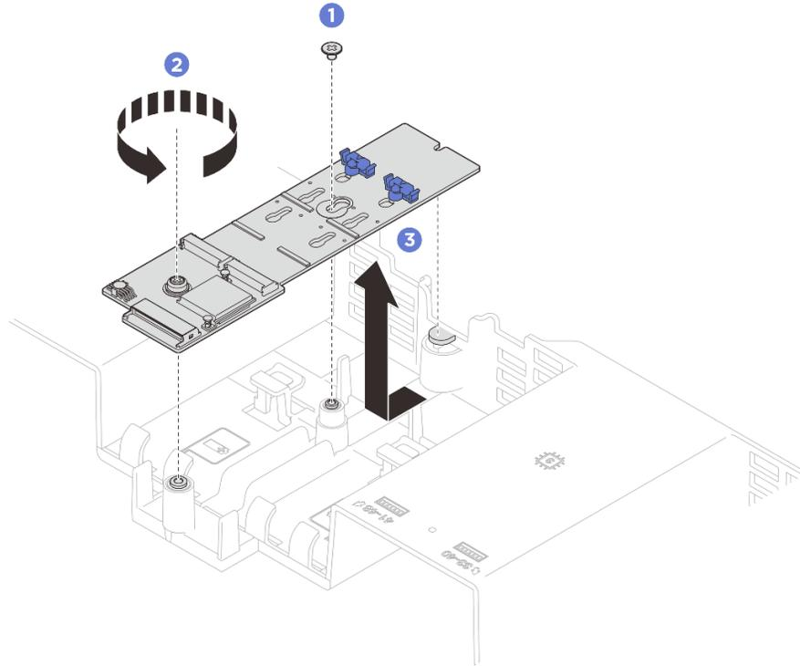
Figura 98. Extracción del adaptador de arranque M.2
