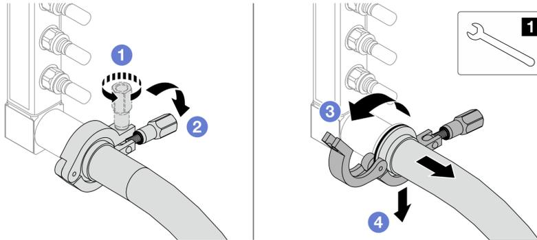
Figura 118. Separación del múltiple del juego de conexión
