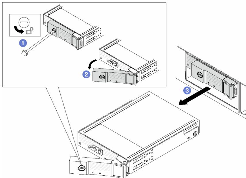
Figura 25. Extracción del CMM
