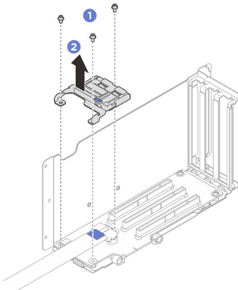
Figura 181. Extracción del elemento de sujeción de PCIe
