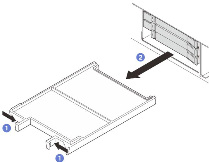
Figura 40. Extracción de un relleno de bahía
