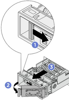
Figura 63. Extracción de un conjunto de unidad M.2 de intercambio en caliente
