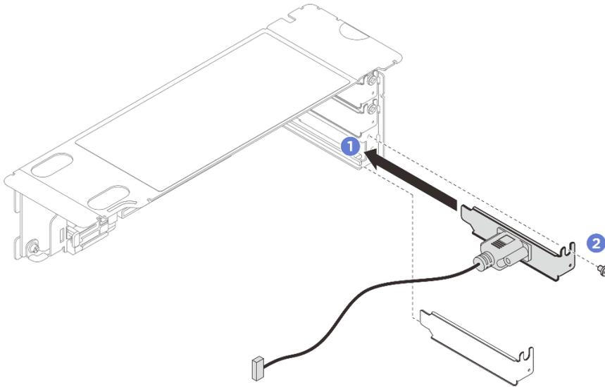
Figura 219. Instalación de módulo de puerto serie
