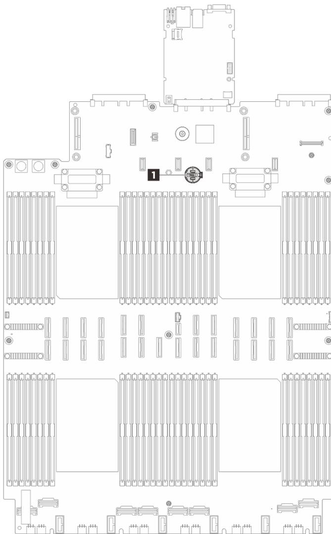
Figura 22. Ubicación del zócalo de la batería CMOS
