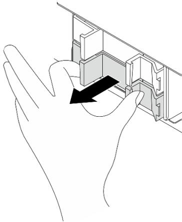
Figura 28. Extracción de un relleno de bahía
