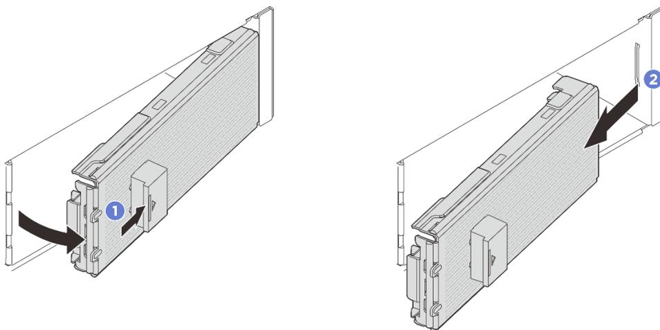
Figura 39. Extracción del marco biselado de E3.S
