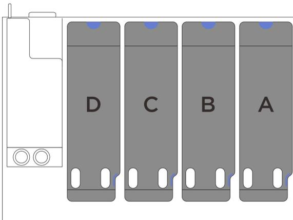
**A**, **B** y **C** Expansión PCIe de LP (sin conector de alimentación)
