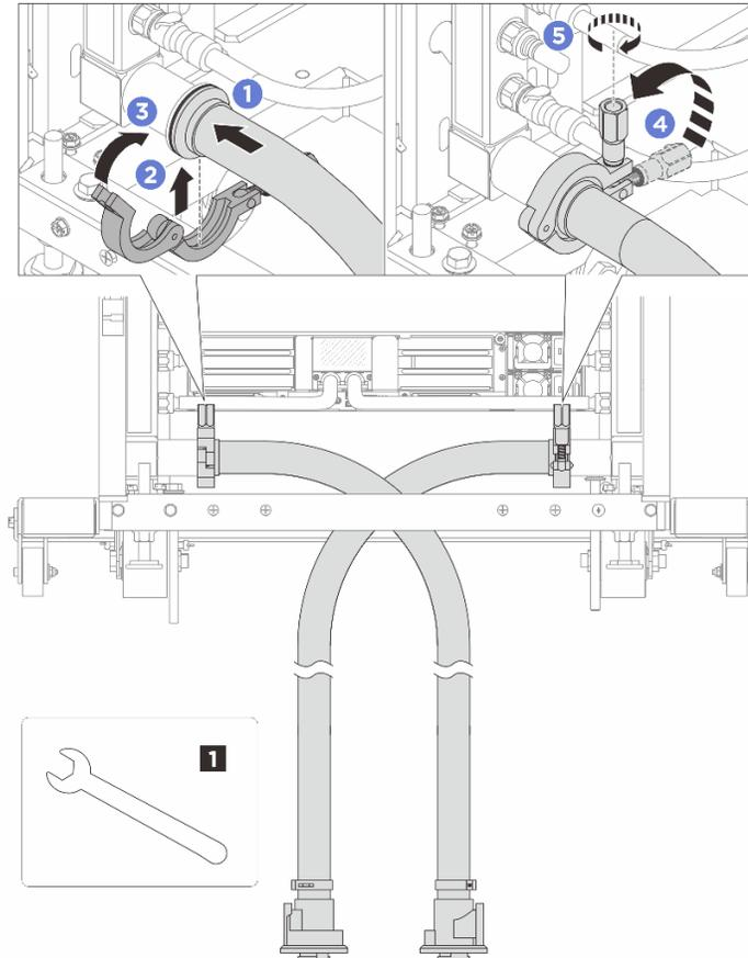
Figura 143. Instalación del kit de manguera
