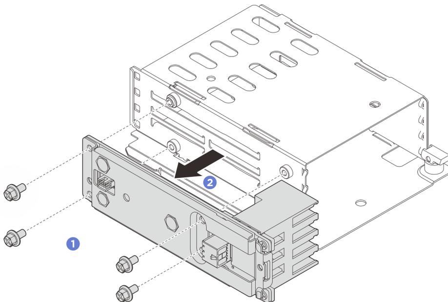
Figura 46. Extracción del conjunto de la placa posterior
