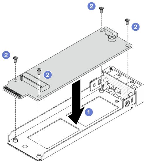
Figura 71. Instalación del intercalador M.2
