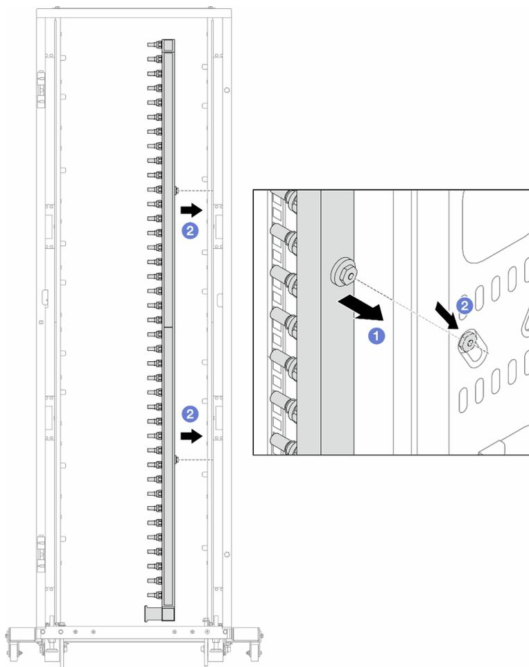
Figura 119. Instalación del múltiple
