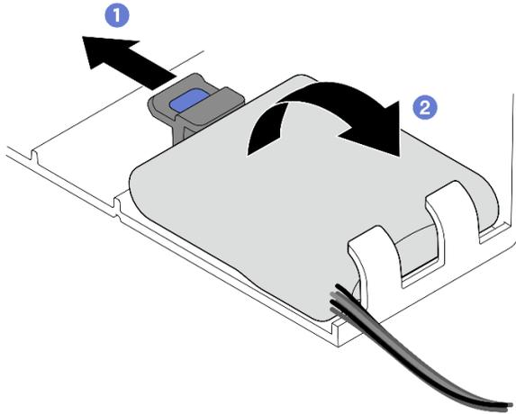
Figura 54. Extracción del módulo de alimentación flash
