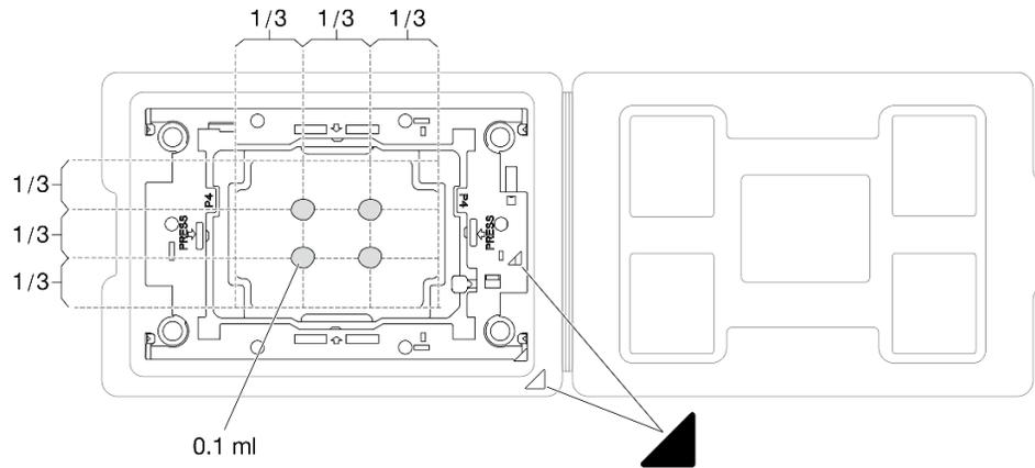
Figura 86. Aplicación de grasa térmica con el procesador en la bandeja de envío
