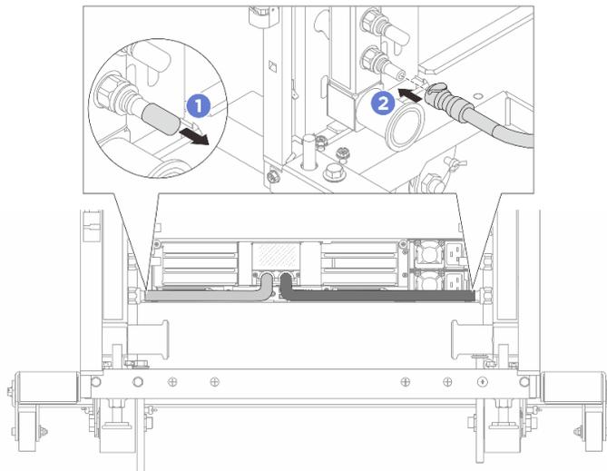
Figura 126. Instalación del conector rápido
