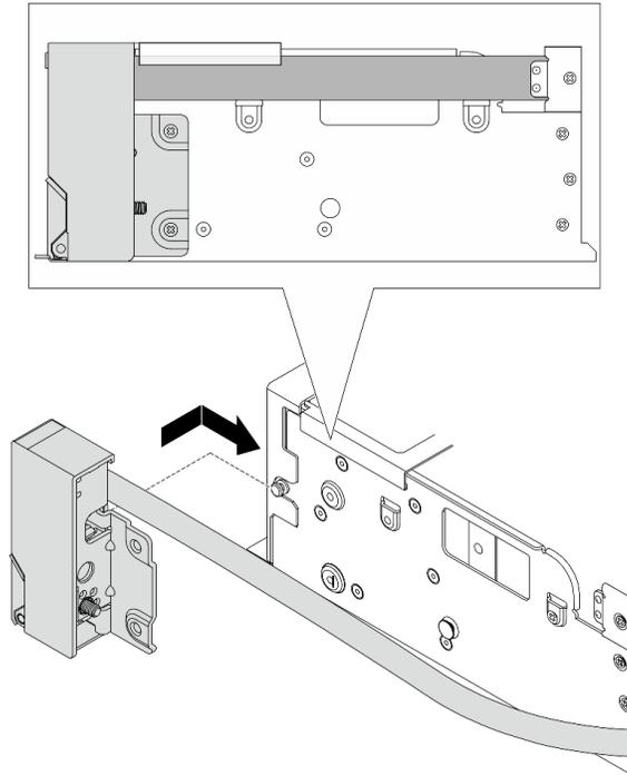
*Figura 204. Instalación del pestillo del bastidor*
