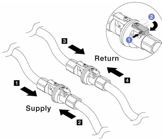
Figura 151. Apertura de las válvulas de bola
