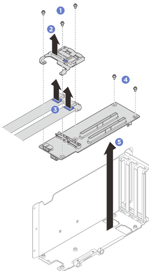
Figura 176. Extracción de tarjeta de expansión PCIe
