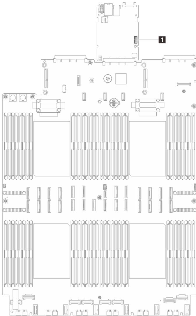
*Figura 220. Ubicación del conector del puerto serie*
