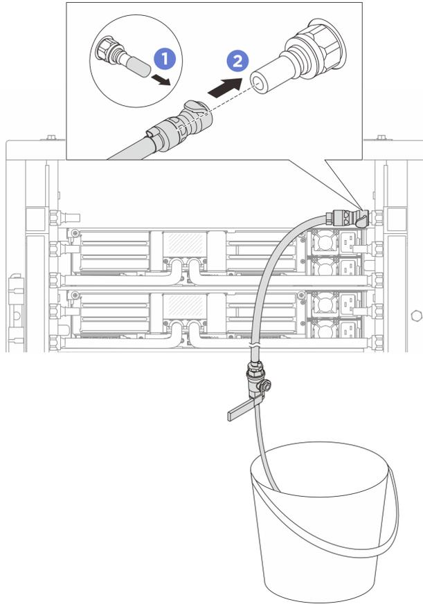
Figura 130. Instalación del kit de purga en el lado de retorno
