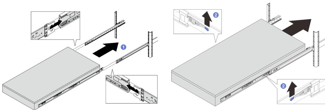
1 Alinee ambos extremos posteriores de los rieles interiores con las aberturas en los rieles intermedios y asegúrese de que los dos pares de rieles coincidan correctamente. Luego, deslice con cuidado el servidor hacia el bastidor, hasta que los rieles encajen en su lugar.
