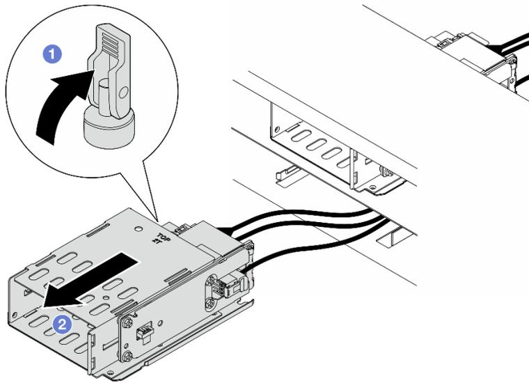
Figura 33. Extracción del compartimiento de E3.S 2T
