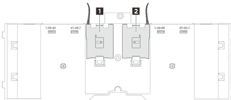
Figura 55. Ubicación de la ranura del módulo de alimentación flash
