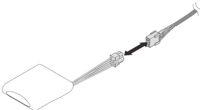
Figura 57. Conexión del cable al módulo de alimentación flash
