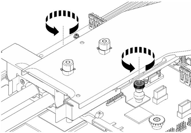
Figura 83. Extracción del conjunto de la placa de frío
