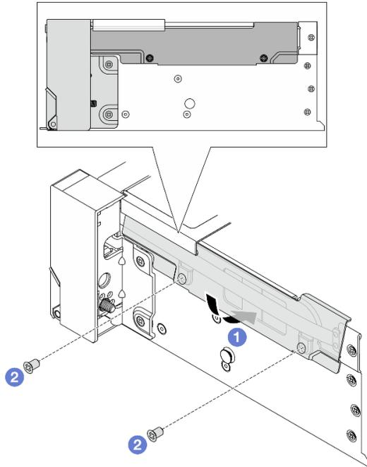
Figura 206. Instalación del soporte de cable
