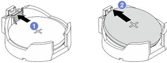
Figura 21. Extracción de la batería CMOS
