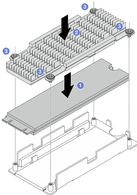
Figura 70. Montaje del dissipador de calor y la unidad M.2
