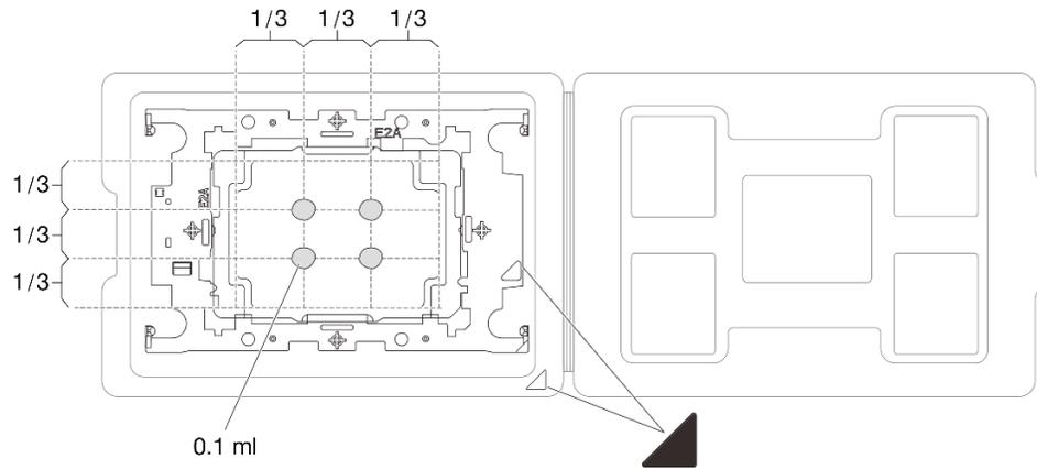
Figura 197. Aplicación de grasa térmica con el procesador en la bandeja de envío
