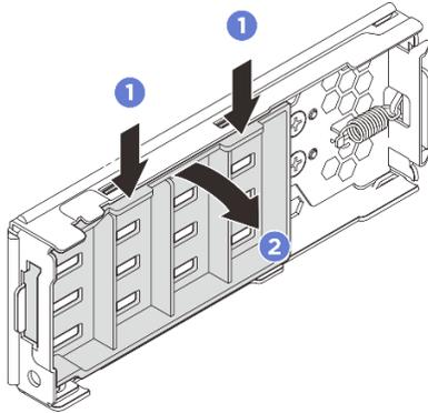
Figura 43. Extracción de la placa interior
