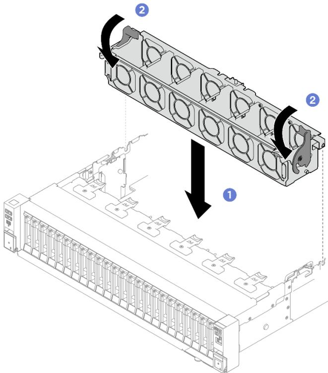
Figura 51. Instalación de la caja del ventilador
