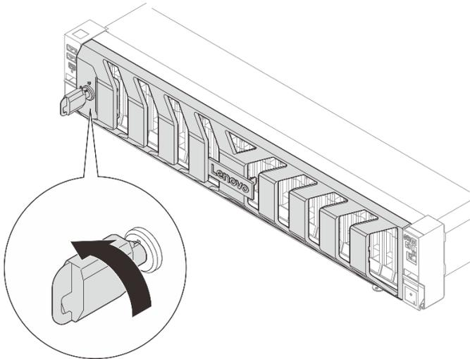
Figura 217. Bloqueo del marco biselado de seguridad
