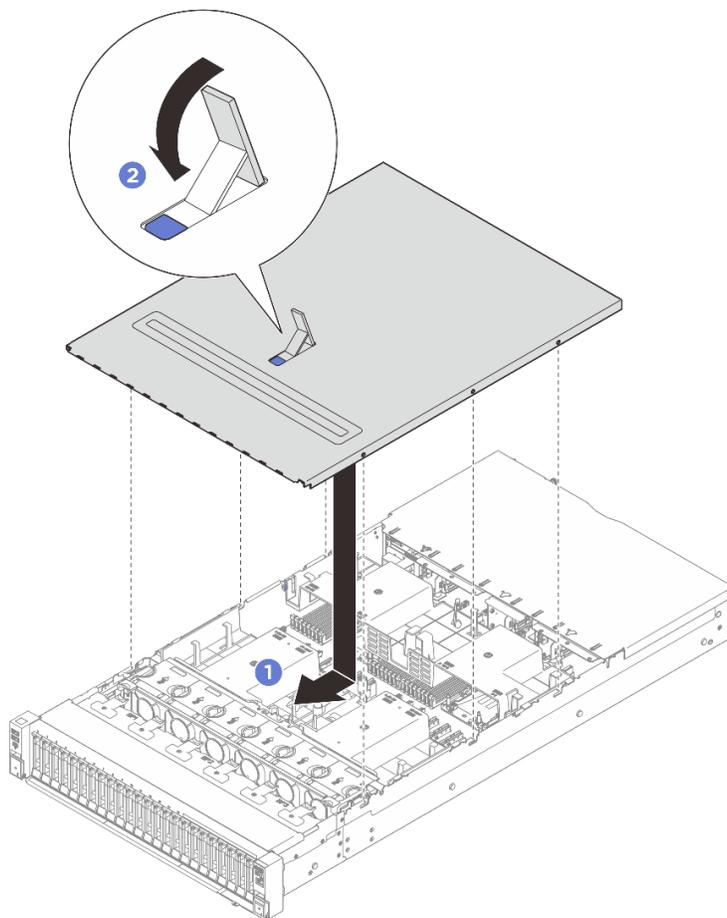
Figura 236. Instalación de la cubierta superior frontal
