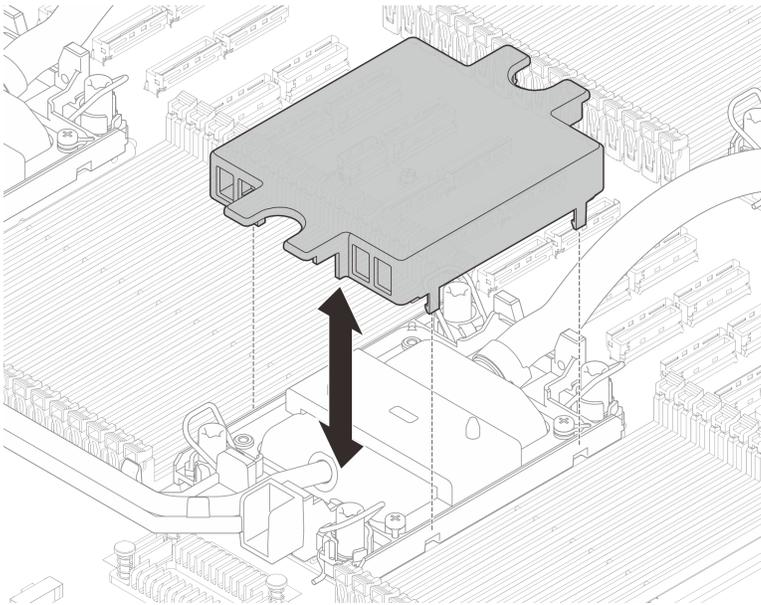
*Figura 79. Extracción de las cubiertas de la placa de frío*
