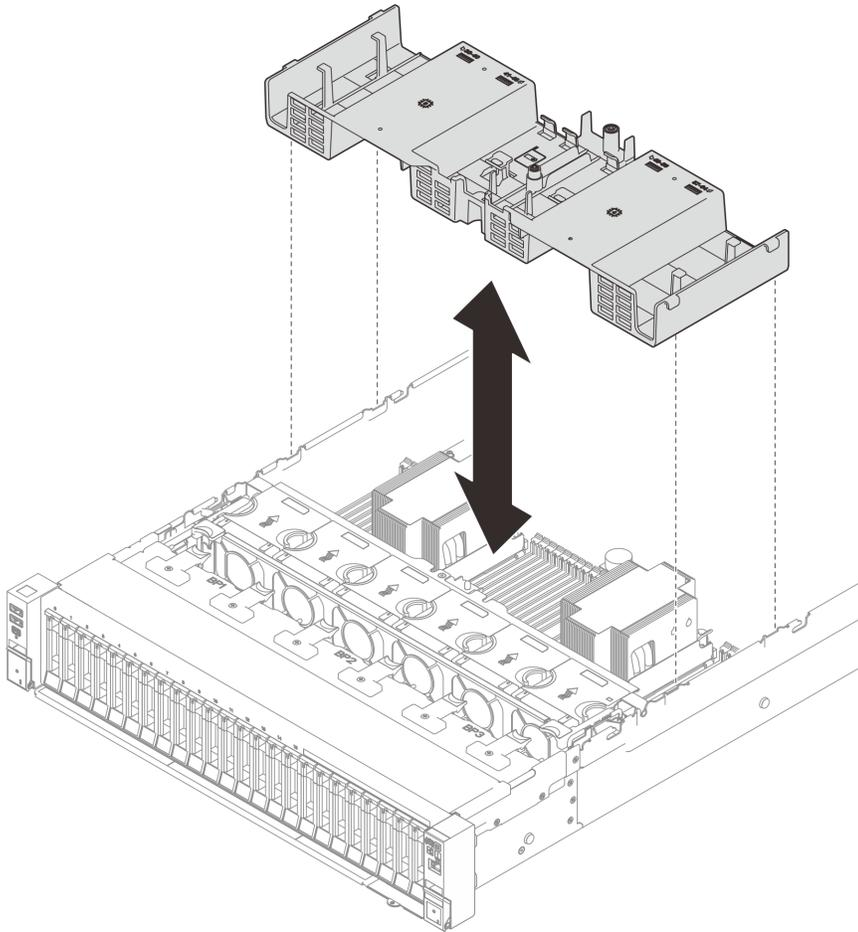
Figura 10. Extracción del deflector de aire frontal
