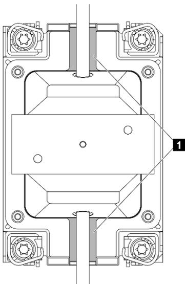
Figura 257. Áreas propensas a filtraciones
