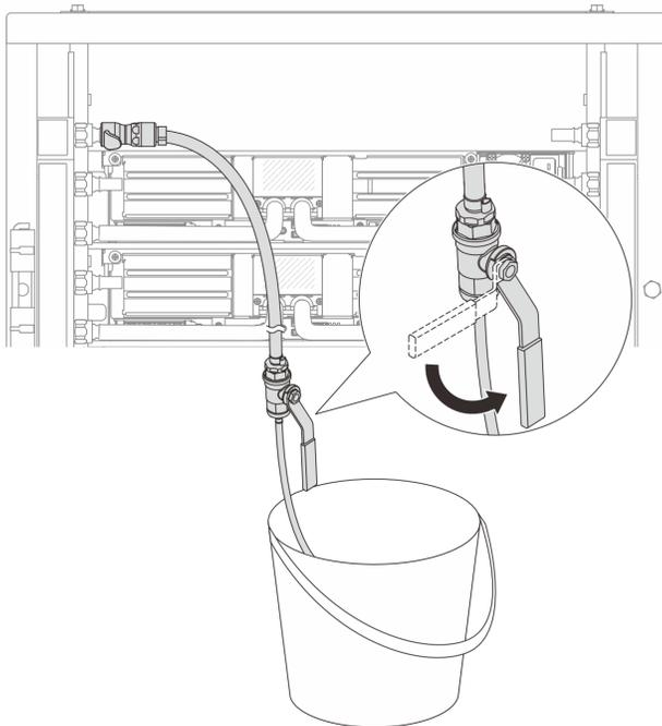
*Figura 129. Apertura de la válvula de purga del lado de suministro*
