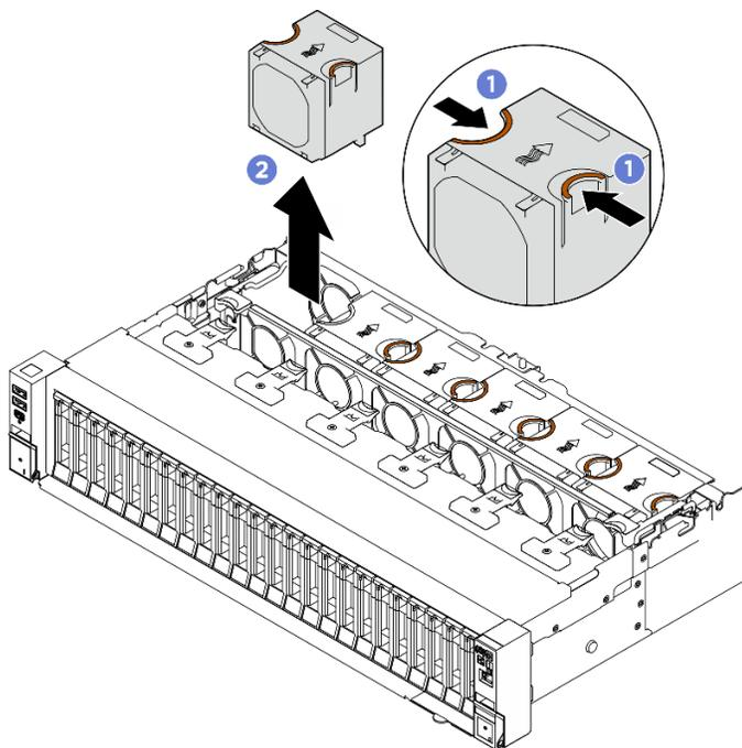
Figura 49. Extracción del ventilador
