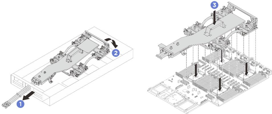
Figura 88. Instalación del conjunto de la placa de frío
