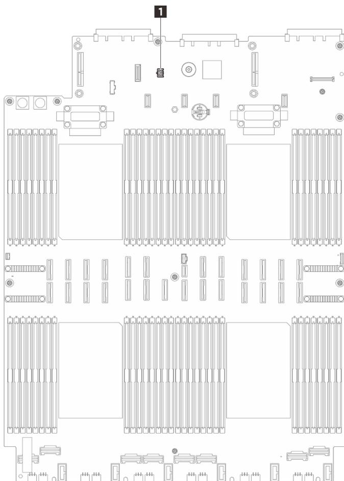
Figura 95. Conexión del módulo de sensor de detección de filtraciones
