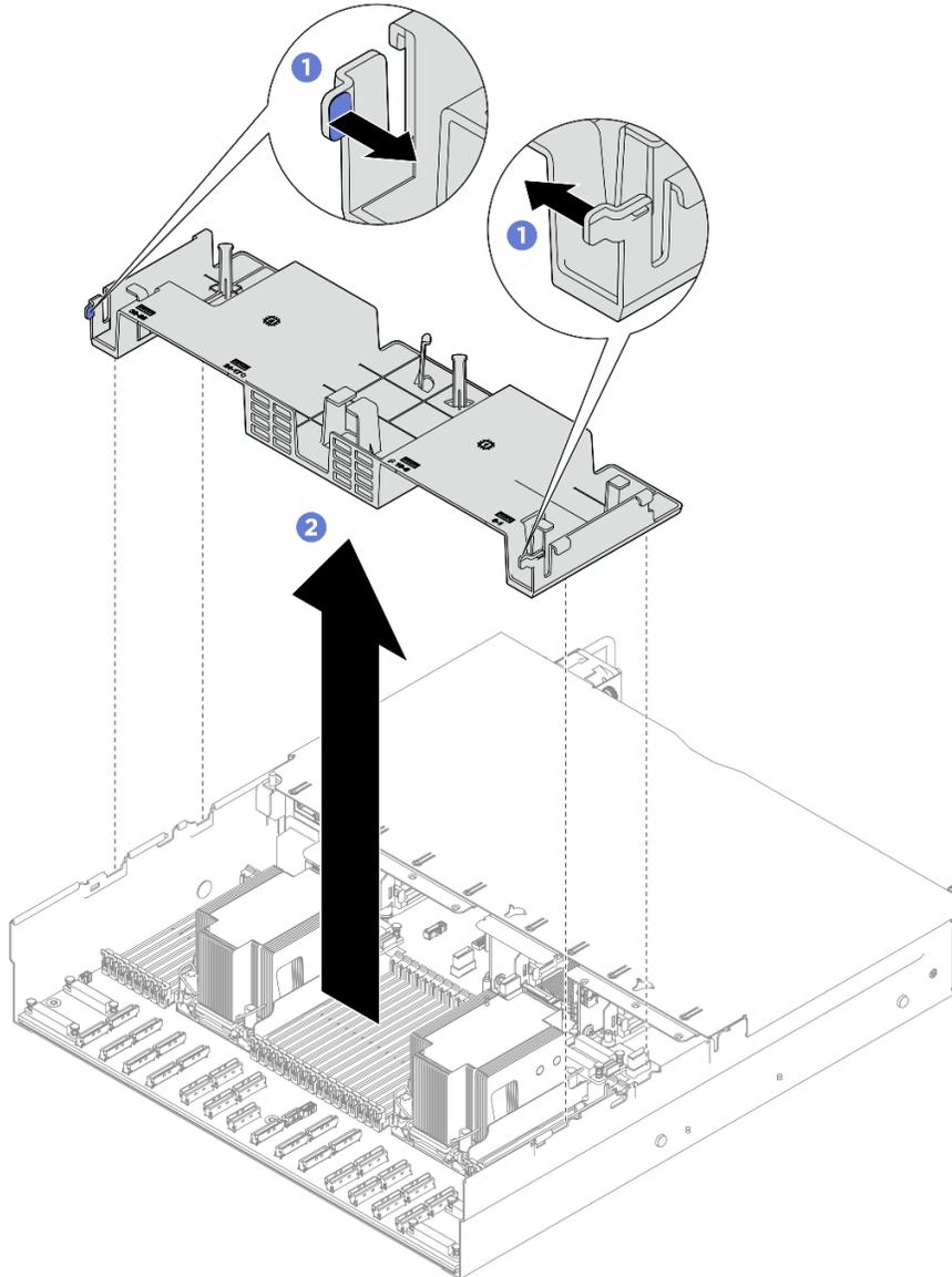
Figura 16. Extracción del deflector de aire posterior
