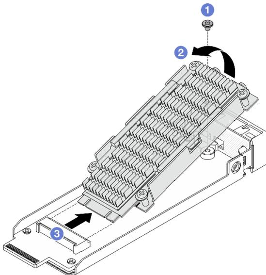
Figura 65. Quite la unidad M.2 con disipador de calor
