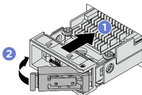
Figura 74. Instalación de un conjunto de la unidad M.2
