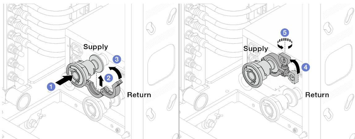
Figura 121. Instalación de válvulas de bola
