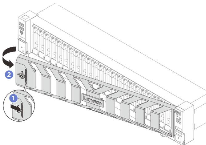
Figura 214. Extracción del marco biselado de seguridad
