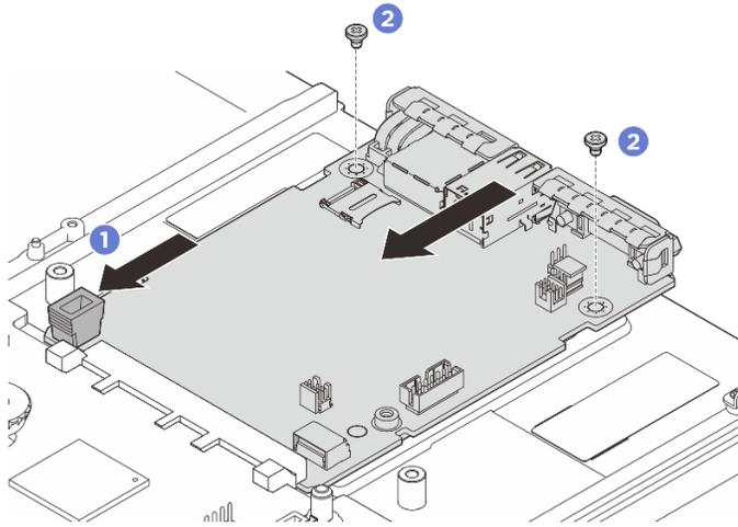
Figura 230. Instalación de la placa de E/S del sistema
