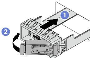
Figura 64. Instalación de una bandeja de unidad M.2
