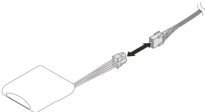
Figura 19. Conexión del cable al módulo de alimentación flash
