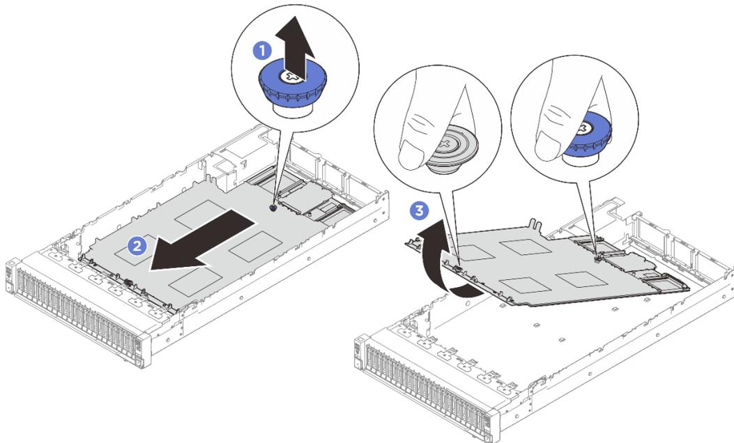
Figura 224. Extracción del conjunto de la placa del sistema
