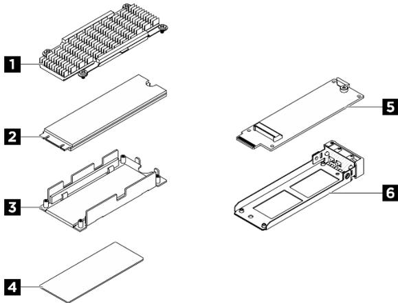
Figura 62. Partes de un conjunto de unidad M.2 de intercambio en caliente
