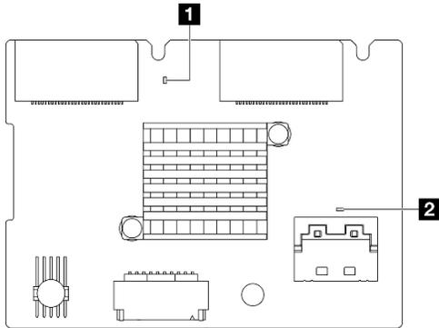
Figura 25. LED del adaptador de arranque M.2 posterior
