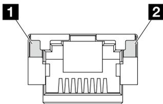
Figura 29. LED en el Puerto de gestión del sistema XCC (10/100/1000 Mbps RJ-45)
