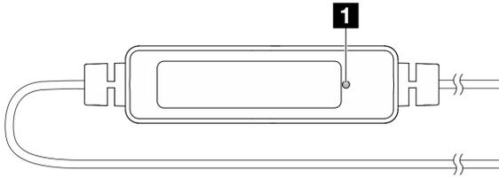
Figura 20. LED de detección de filtraciones
