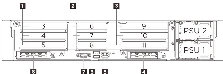
Figura 5. Vista posterior del modelo de servidor con dos expansiones PCIe
