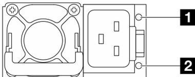
Figura 21. LED de una unidad de fuente de alimentación CRPS Premium (CFFv5)
