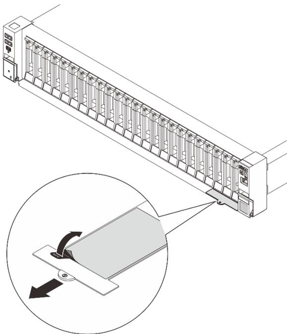
Figura 32. Etiqueta de acceso de red de Lenovo XClarity Controller en la pestaña de información extraíble
