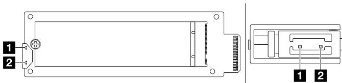
Figura 24. LED de la tarjeta de interposición M.2 posterior
