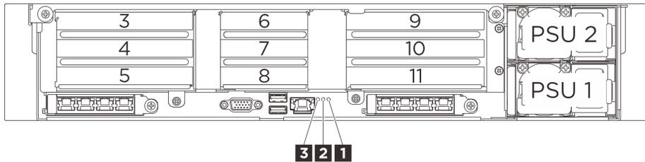
Figura 26. LED del sistema posterior
