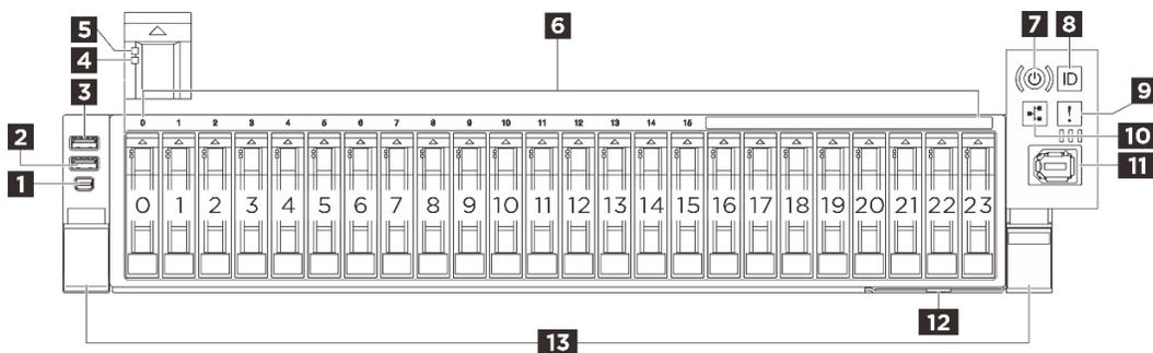
Figura 2. Vista frontal del modelo de servidor con bahías de 2,5 pulgadas
