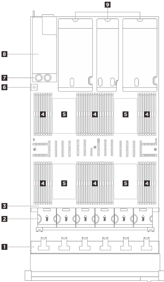
Figura 11. Vista superior del modelo de servidor con dos expansiones PCIe
