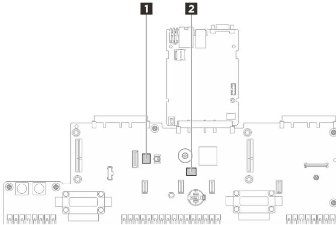
Figura 15. Conmutadores del conjunto de la placa del sistema
