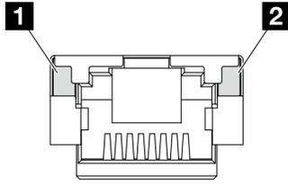
Figure 29. Voyants du Port de gestion du système XCC (10/100/1 000 Mb/s RJ-45)
