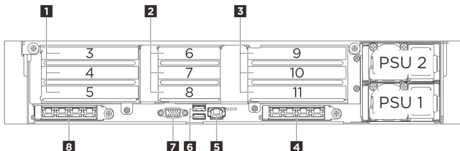
Figure 5. Vue arrière du modèle de serveur équipé de trois cartes mezzanines PCIe
