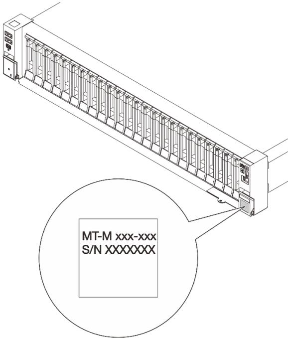
Figure 31. Emplacement de l'étiquette d'identification
