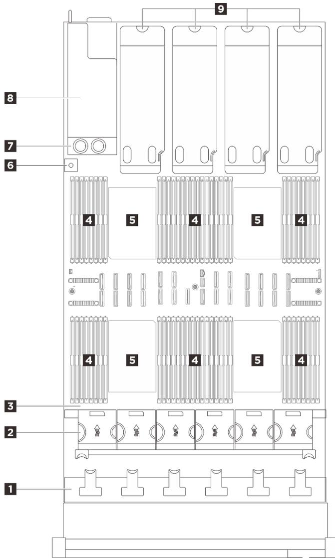
Figure 12. Vue supérieure du modèle de serveur équipé de quatre cartes mezzanines PCIe
