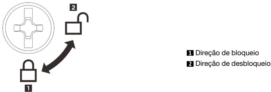
Figura 251. Direção de bloqueio/desbloqueio da tampa superior frontal
