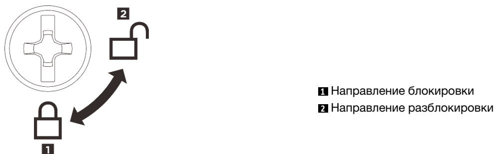
Рис. 232. Направление блокировки/разблокировки переднего верхнего кожуха
