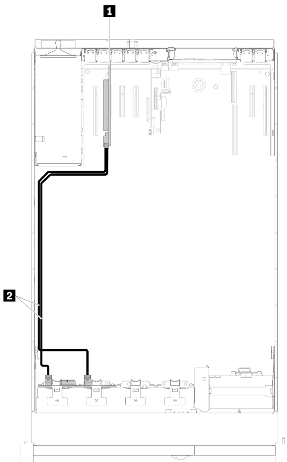
Figure 26. Cheminement des câbles, Fond de panier 8 baies
