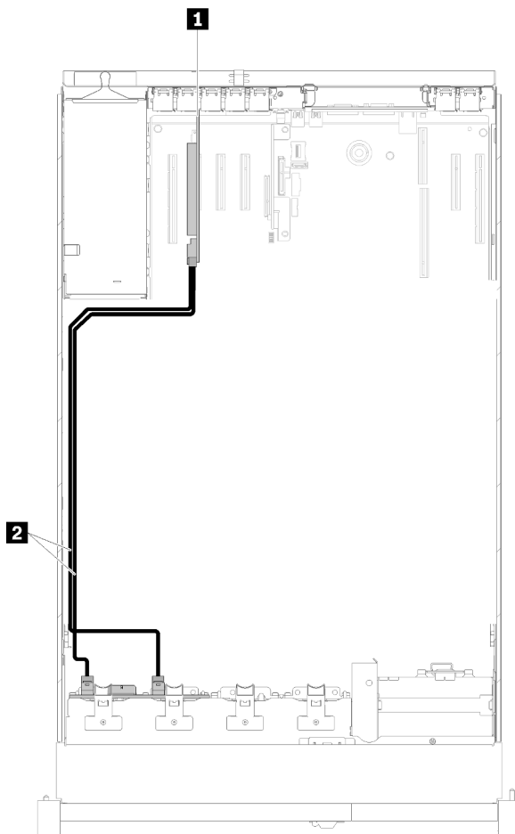
Figura 28. Roteamento de cabos, Painel traseiro de 8 compartimentos
