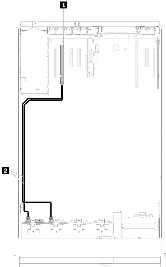
Рис. 26. Прокладка кабелей, Объединительная панель с 8 отсеками
