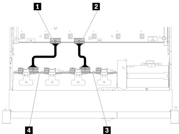
图 27. 主板上电源线接口的位置
