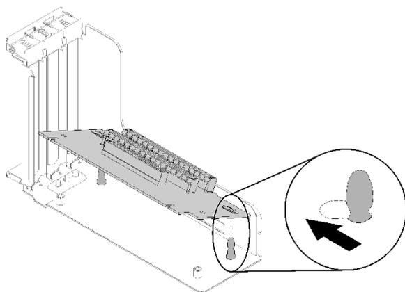
图 93. 拆卸 PCIe 转接卡组合件
