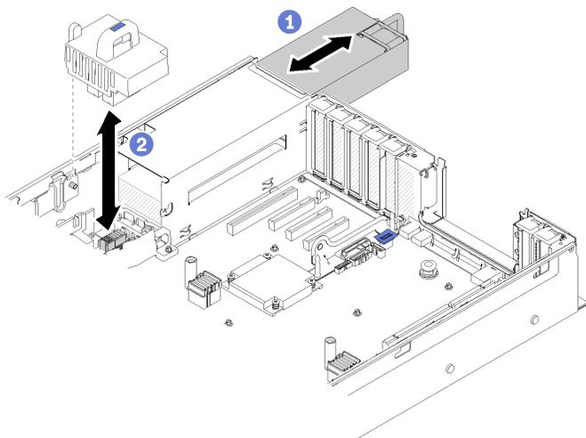
图 126. 安装电源插转卡
