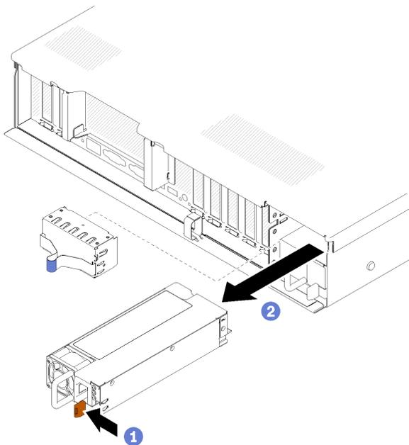
图 103. 卸下电源模块单元
