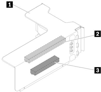
图 19. x8/x16ML2 PCIe FH 转接卡组合件
