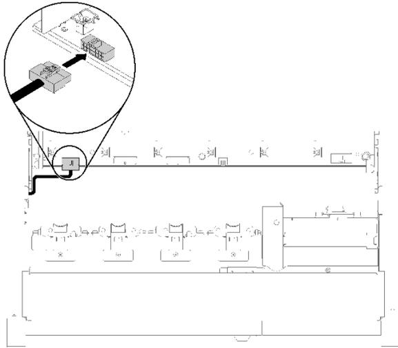
图 61. 安装正面 VGA 组合件
