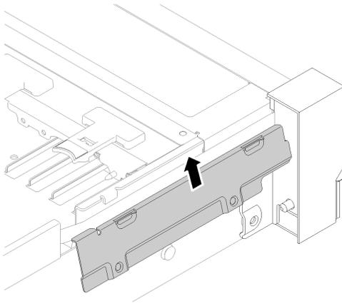
图 55. 卸下正面 VGA 组合件
