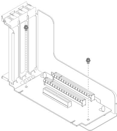
图 92. 拆卸 PCIe 转接卡组合件
