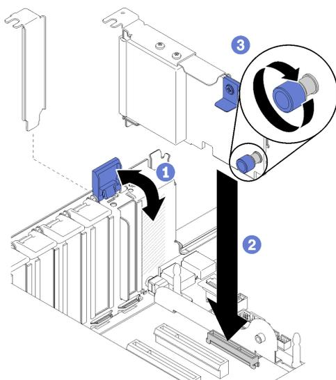
图 65. 安装 LOM 适配器
