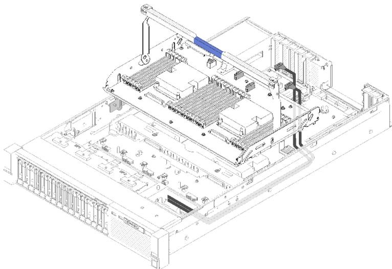
图 26. 将 NVMe 线缆连接到处理器和内存扩展托盘
