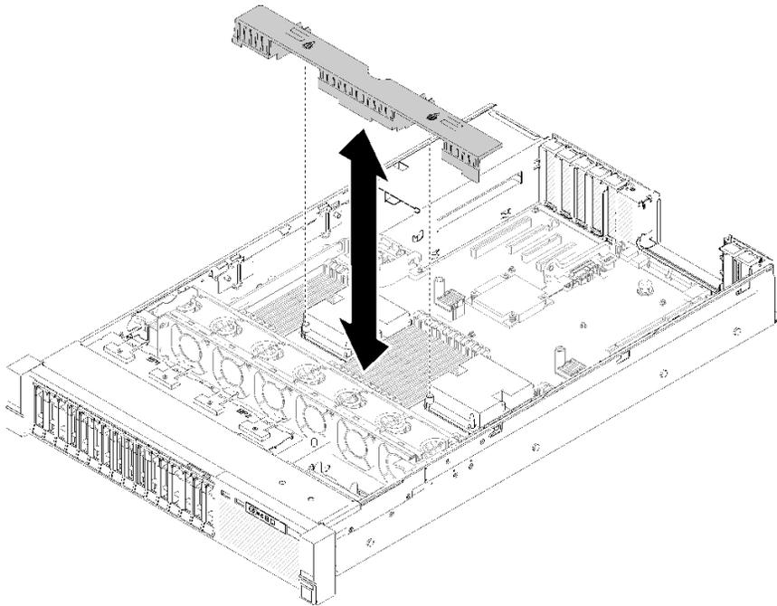
图 117. 安装扩展托盘导风罩
