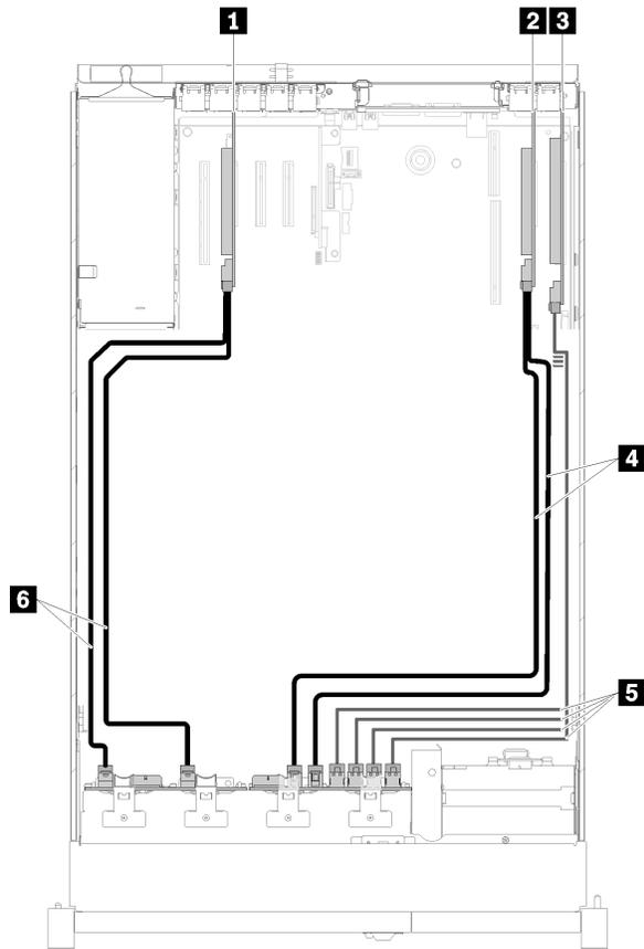
图 34. 线缆布放, 8 插槽背板 + AnyBay 背板
