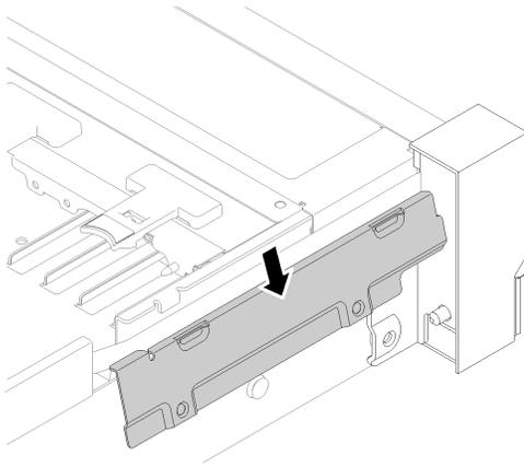
图 59. 安装正面 VGA 组合件
