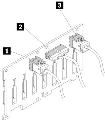
图 20. 2.5 英寸 SATA/SAS 8 插槽背板套件
