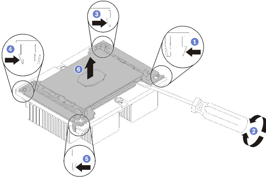
图 108. 将散热器与处理器分离
