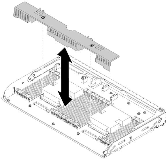
图 119. 安装扩展托盘导风罩
