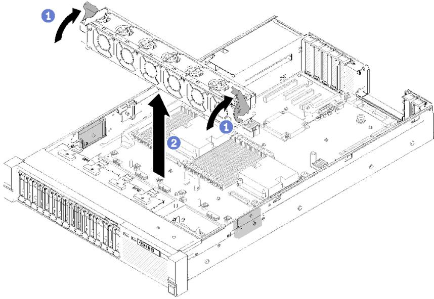
图 49. 卸下风扇架组合件
