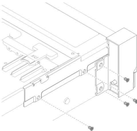
图 60. 安装正面 VGA 组合件
