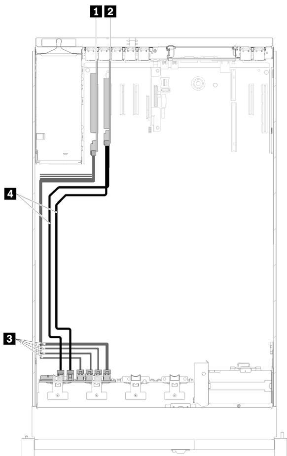
图 29. 线缆布放，装有两个处理器的 AnyBay 背板
