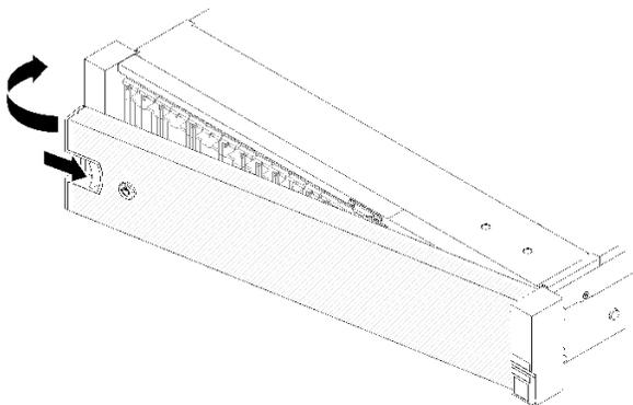
图 122. 安装安全挡板
