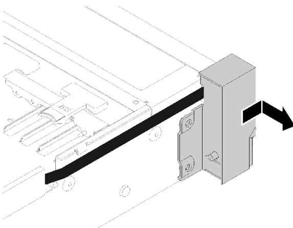
图 56. 卸下正面 VGA 组合件
