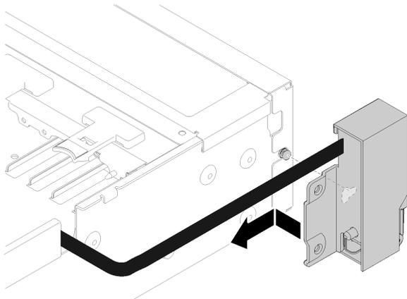
图 58. 安装正面 VGA 组合件
