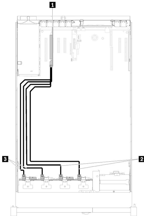
图 31. 线缆布放，8 插槽背板 + 8 插槽背板
