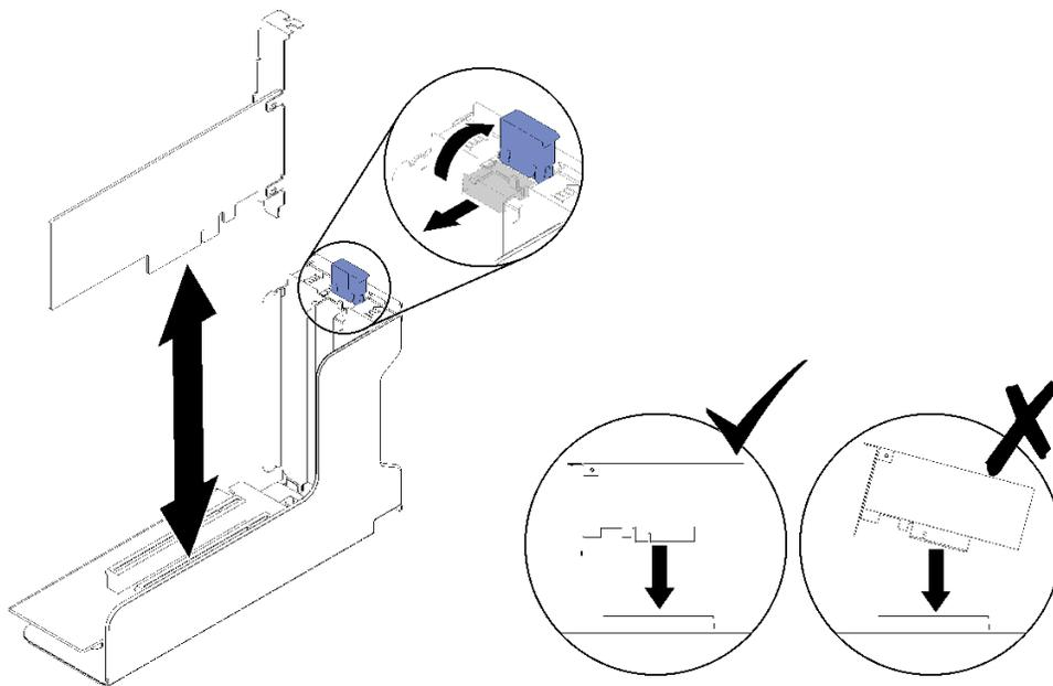
图 101. 将适配器安装至 PCIe 转接卡组合件
