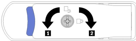
图 136. 顶盖滑锁上的锁
