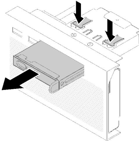
图 87. 卸下正面操作员面板
