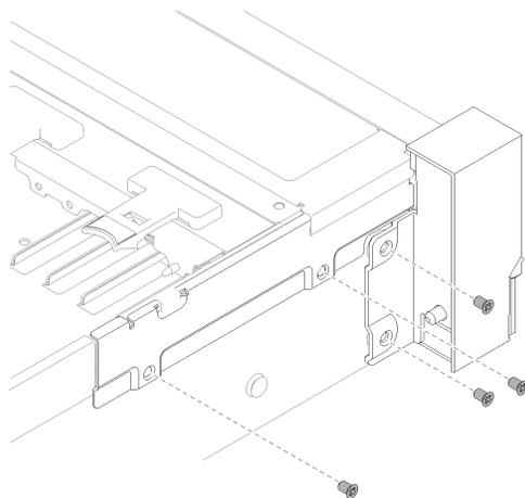
图 54. 卸下正面 VGA 组合件
