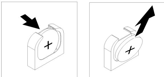
图 47. 卸下 CMOS 电池
