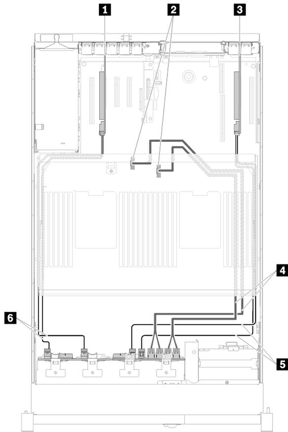
图 36. 线缆布放, 8 插槽背板 + AnyBay 背板
