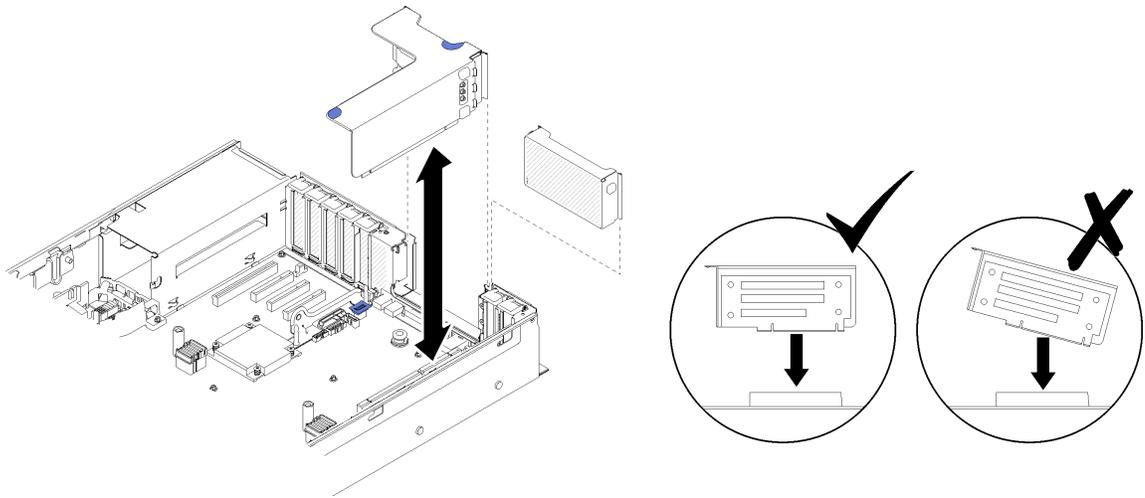
图 97. 安装PCIe 转接卡组合件
