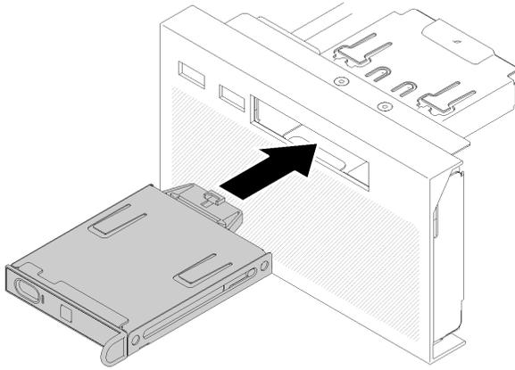
图 88. 安装正面操作员面板
