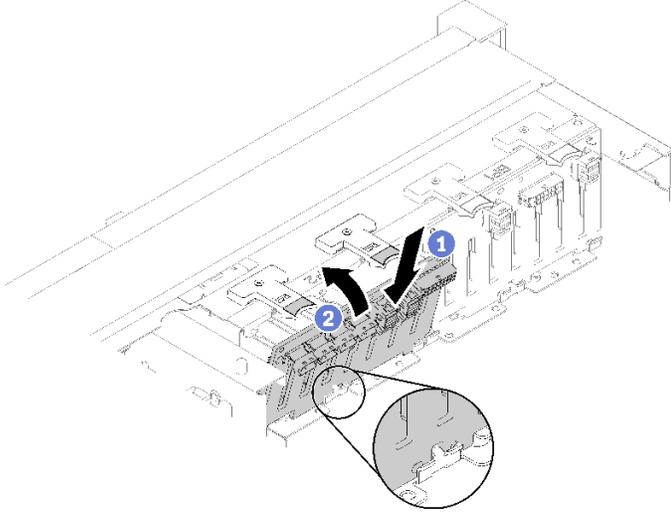
图 43. 安装硬盘背板
