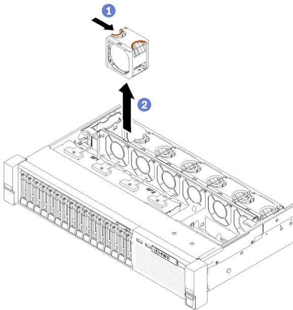
图 51. 卸下热插拔风扇
