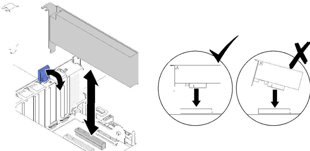
图 100. 主板的适配器安装
