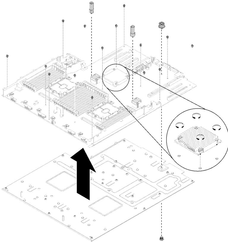
图 143. 拆卸主板
