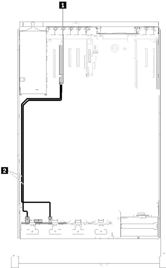
图 28. 线缆布放，8 插槽背板
