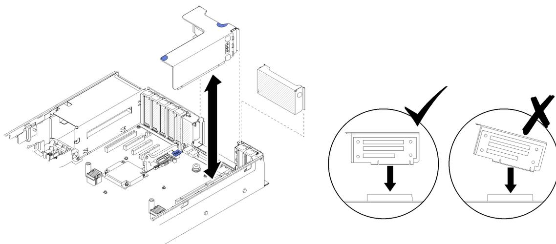
图 90. 卸下 PCIe 转接卡组合件
