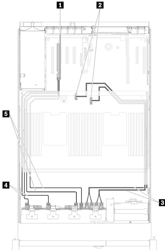
图 35. 线缆布放，8 插槽背板 + AnyBay 背板
