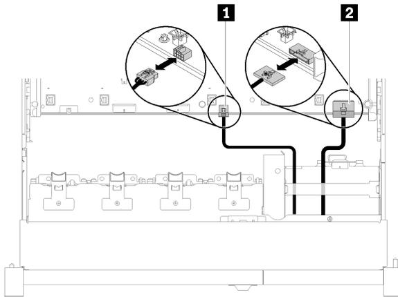
图 85. USB 2.0 线缆和正面操作员面板线缆
