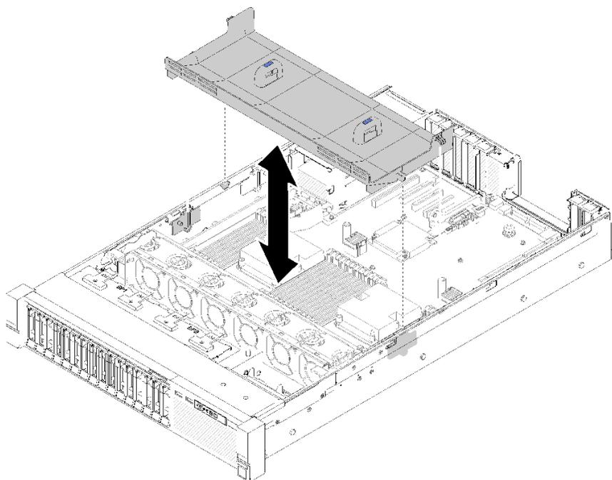
图 127. 安装主板导风罩
