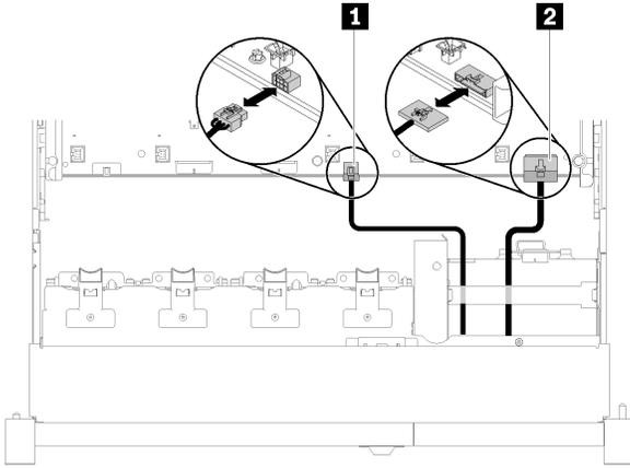
图 81. USB 2.0 线缆和正面操作员面板线缆
