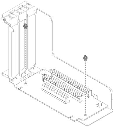
图 91. 卸下 PCIe 转接卡
