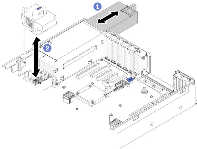
图 124. 卸下电源插转卡
