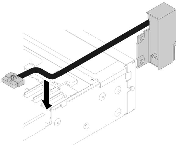
图 57. 安装正面 VGA 组合件
