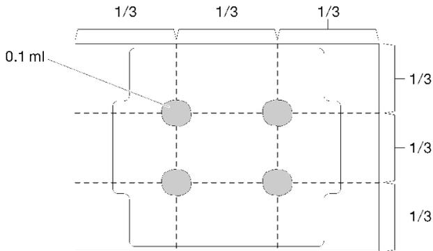
图 111. 导热油脂的正确形状
