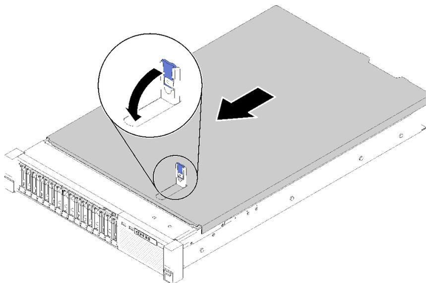
图 138. 安装顶盖
