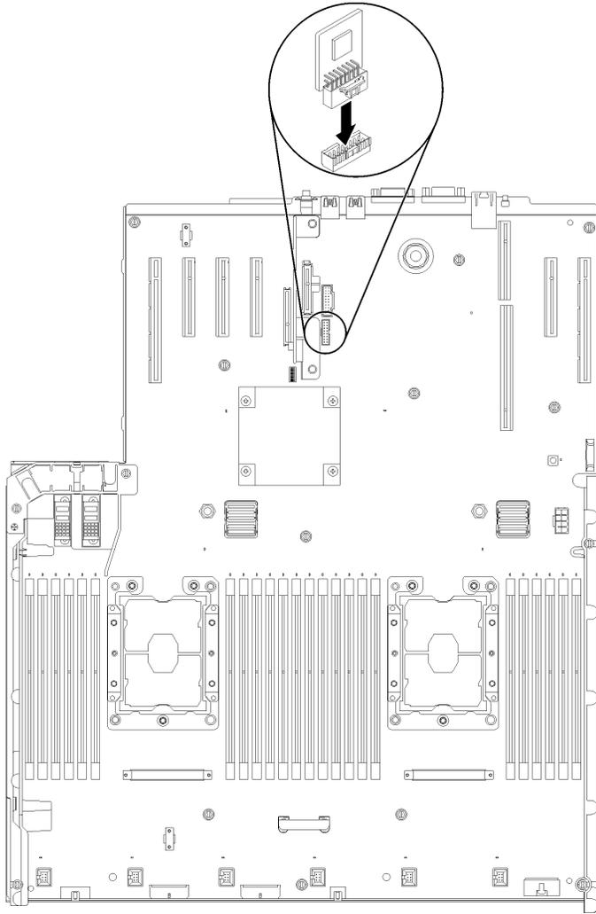
图 135. 安装 TCM/TPM 适配器
