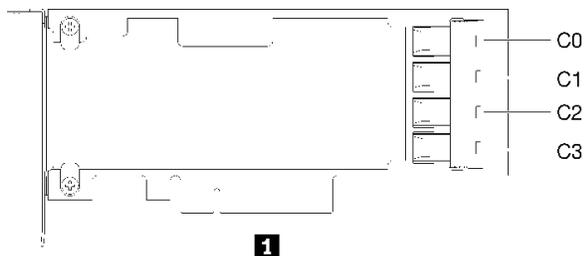
图 24. PCIe 交换卡上的接口
