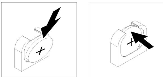
图 48. 安装 CMOS 电池
