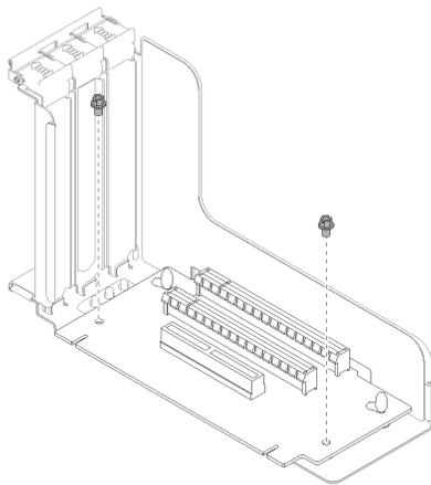
图 96. PCIe 转接卡组合件
