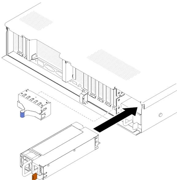
图 105. 安装电源模块单元
