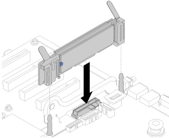
图 70. 安装 M.2 背板
