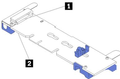
图 72. M.2 硬盘插槽
