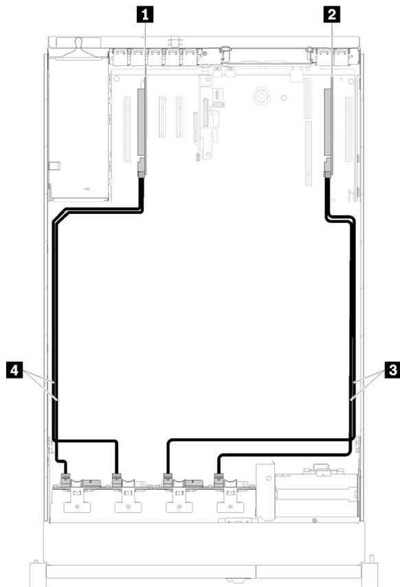
图 32. 线缆布放, 8 插槽背板 + 8 插槽背板
