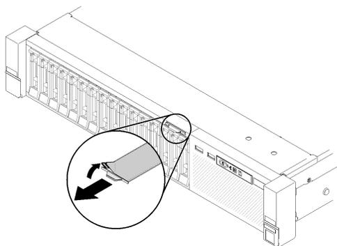
图 3. 抽取式信息卡上的 XClarity Controller 网络访问标签
