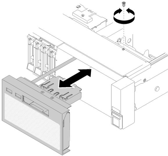
图 84. 安装操作员面板托盘组合件
