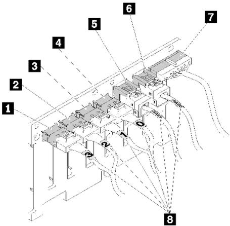
图 21. 2.5 英寸 AnyBay (SATA /SAS/NVMe) 8 插槽背板套件
