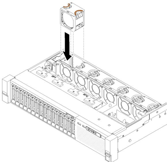
图 52. 安装热插拔风扇
