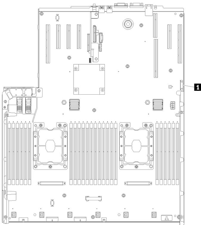
图 46. 主板上的 CMOS 电池位置
