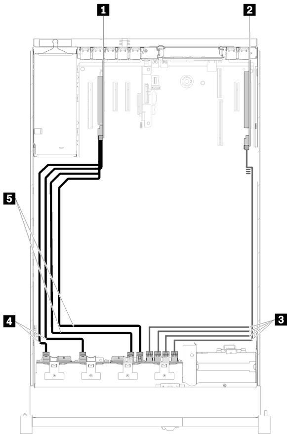
图 33. 线缆布放，8 插槽背板 + AnyBay 背板
