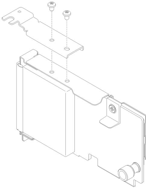
图 63. 拆卸 LOM 适配器
