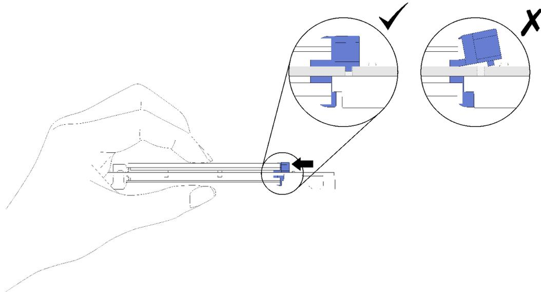
图 74. 安装 M.2 硬盘并用固定器固定到位
