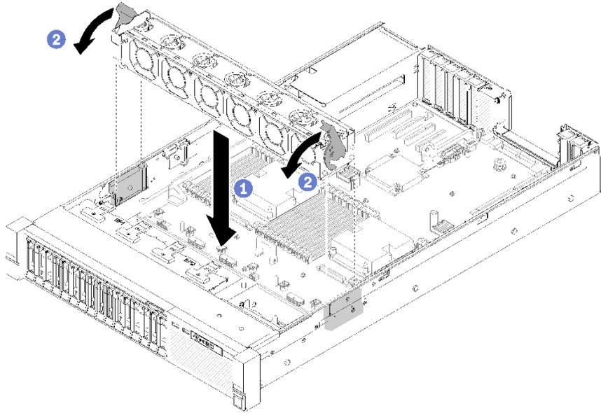
图 50. 安装风扇架组合件
