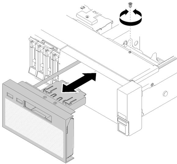
图 83. 卸下操作员面板托盘组合件
