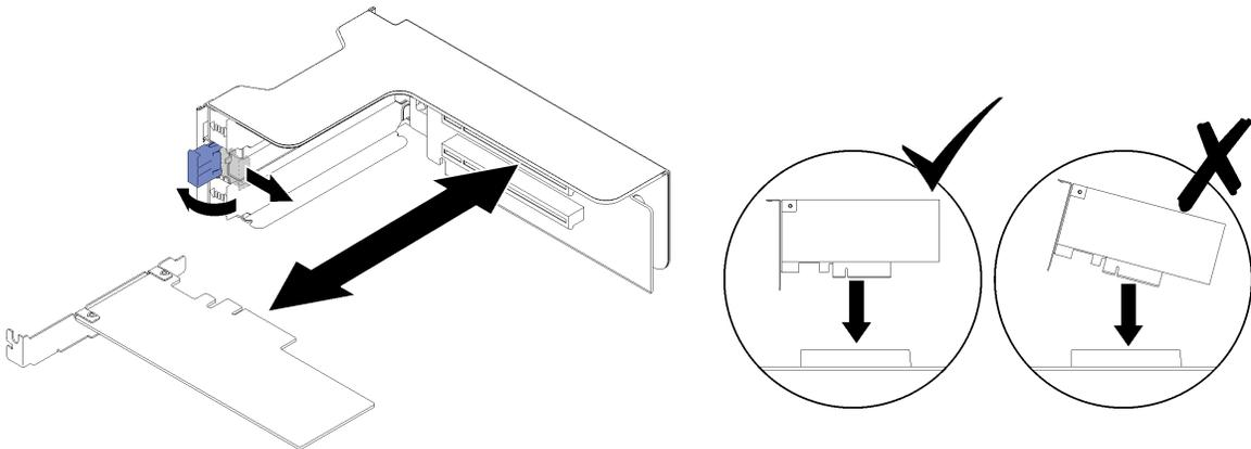
图 99. 从 PCIe 转接卡组合件卸下适配器
