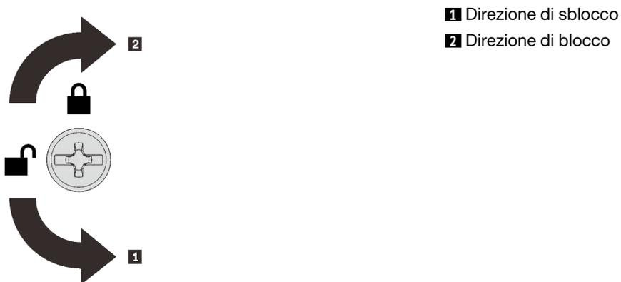
Figura 130. Direzione di blocco/sblocco del coperchio superiore
