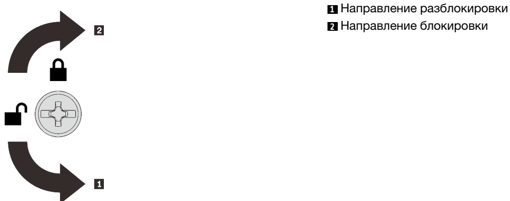
Рис. 127. Направление блокировки/разблокировки верхнего кожуха
