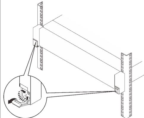
Öffnen Sie die Rack-Entriegelungshebel und ziehen Sie die unverlierbaren Schrauben mit einem Kreuzschlitzschraubendreher im Uhrzeigersinn an.
