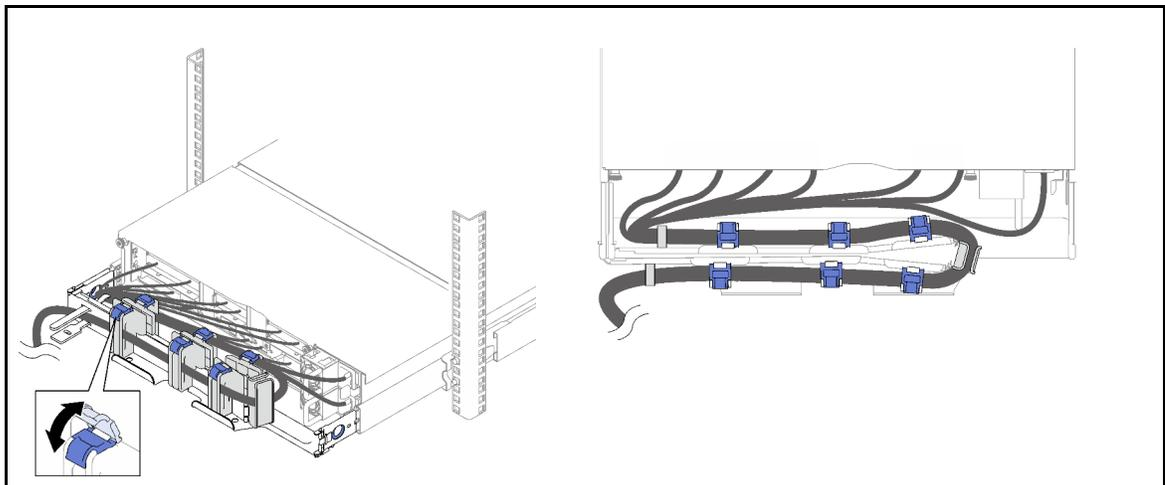
Schritt 2. Verwenden Sie die Kabelbinder, um die Kabel fest an der Vorder- und Rückseite des Kabelträgers zu befestigen.
