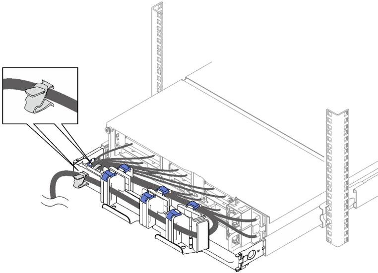
**Achtung:** Schieben Sie die Schiene vorsichtig vor und zurück, um sicherzustellen, dass die Kabel nicht geknickt werden, sich nicht verklemmen und nicht in den U-förmigen Bereich unter dem Server hängen.
