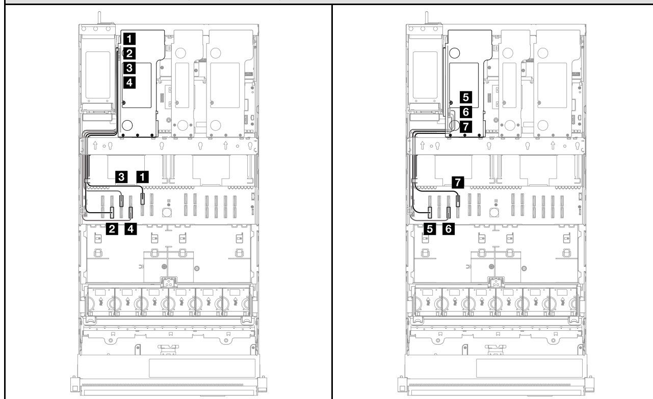
6 スロット Gen 5 FH ライザー (PCIe ライザー 3) のケーブル配線
