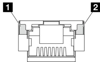
圖例 28. XCC 系統管理埠上的 LED
