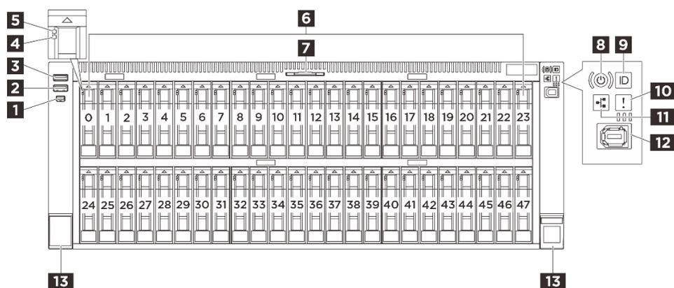
圖例 2. 配備 2.5 吋機槽之伺服器型號的正面圖
