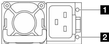
圖例 23. CRPS Premium 電源供應器上的 LED
