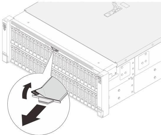
圖例 31. 拉出式資訊標籤上的 Lenovo XClarity Controller 網路存取標籤
