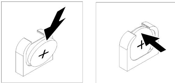
Figura 57. Instalación de Batería CMOS
