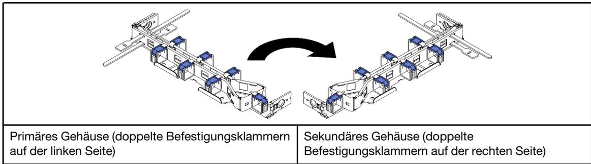
Schritt 2. Richten Sie die innere Befestigungsklammer an der inneren Lasche der Schiene aus. Schieben Sie diese dann, bis sie einrastet.
