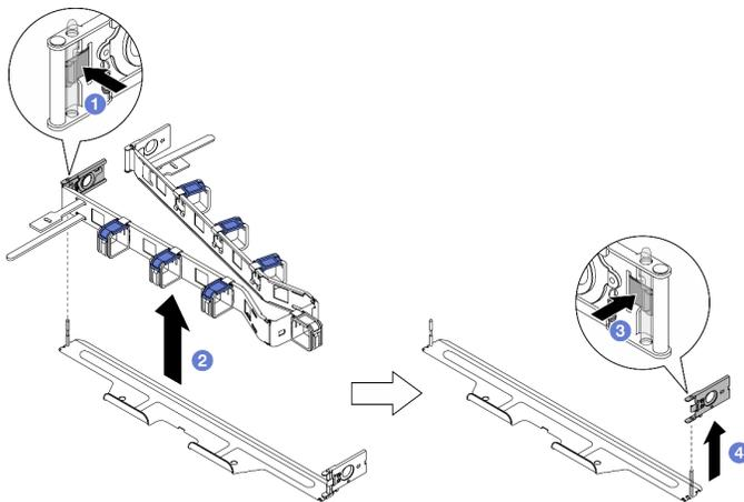
Schritt 5. Richten Sie die Bohrung der Befestigungsklammer am Scharnierstift aus. Drücken Sie anschließend auf die Befestigungsklammer, um sie einzusetzen.
