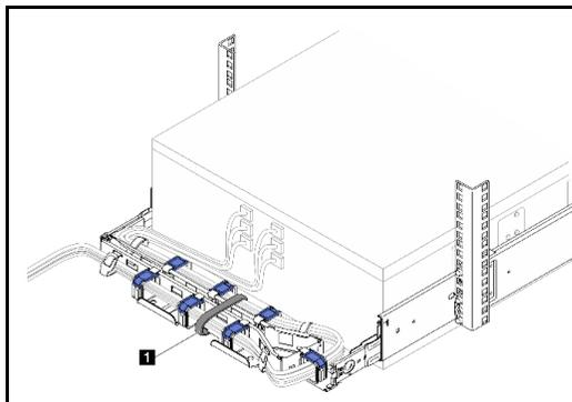
**Achtung:** Das lange Kabelhalteband sichert den CMA und die Kabel während des Transports. Lösen Sie das lange Kabelhalteband, bevor Sie den Server herausziehen, wenn der CMA mit einem Rack ausgeliefert wird.
