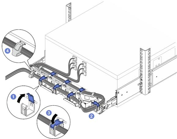
Schritt 1. Öffnen Sie die blauen Halteklammern an den sieben Kabelführungen.
