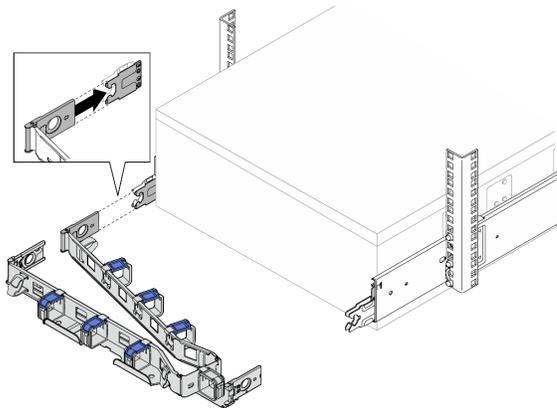
Schritt 3. Richten Sie die zwei äußeren Befestigungsklammern an den äußeren Laschen der Schiene aus. Schieben Sie diese dann, bis sie einrasten.
