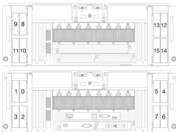
Figura 41. Numeración de la bahía de unidad de 2,5 pulgadas
