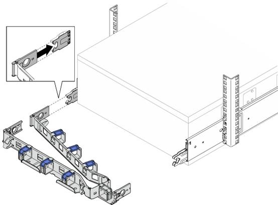
Paso 3. Alinee dos clips de montaje exteriores con las pestañas exteriores en los deslizamientos; empújelos hasta que encajen en su lugar.
