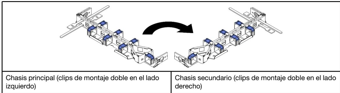
Paso 2. Alinee el clip de montaje interno con la pestaña interna en el deslizamiento y, a continuación, empújelo hasta que encaje en su lugar.
