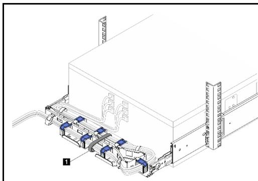
**Atención:** La cinta de sujeción de cables larga fija la CMA y los cables en su lugar durante el transporte. Afloje la cinta de sujeción de cables larga antes de tirar del servidor hacia fuera si la CMA se envía con un bastidor.
