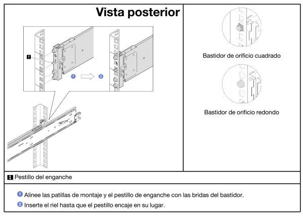
Paso 2. Instale las patillas de montaje frontales en el bastidor.
