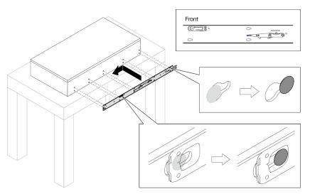
Paso 4. Inserte y apriete el tornillo M4 para fijar el riel interior, como se muestra.
