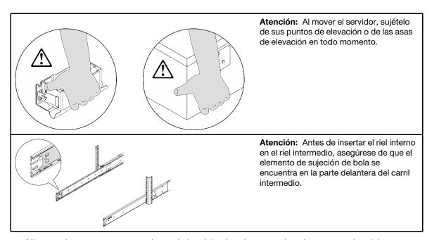
a. Alinee ambos extremos posteriores de los rieles interiores con las aberturas en los rieles intermedios y asegúrese de que los dos pares de rieles coincidan correctamente. Luego, deslice con cuidado el servidor hacia el bastidor, hasta que los rieles encajen en su lugar.
