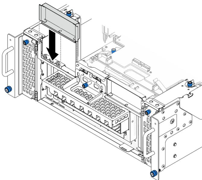
Figure 150. Installation de l'obturateur PCIe gauche
