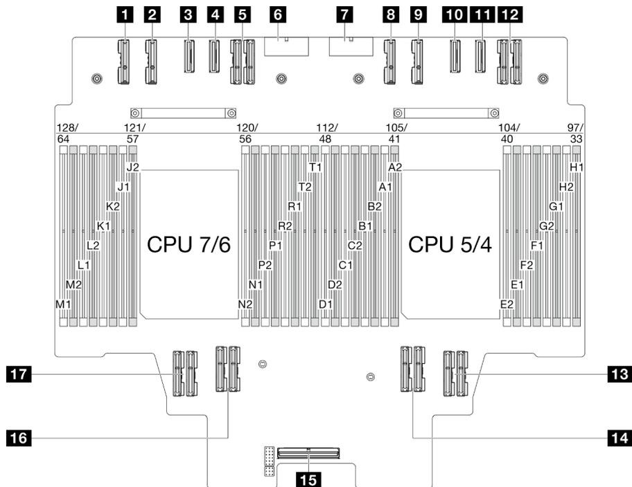
Figure 190. Connecteurs de la carte supérieure de processeur (BD CPU)
