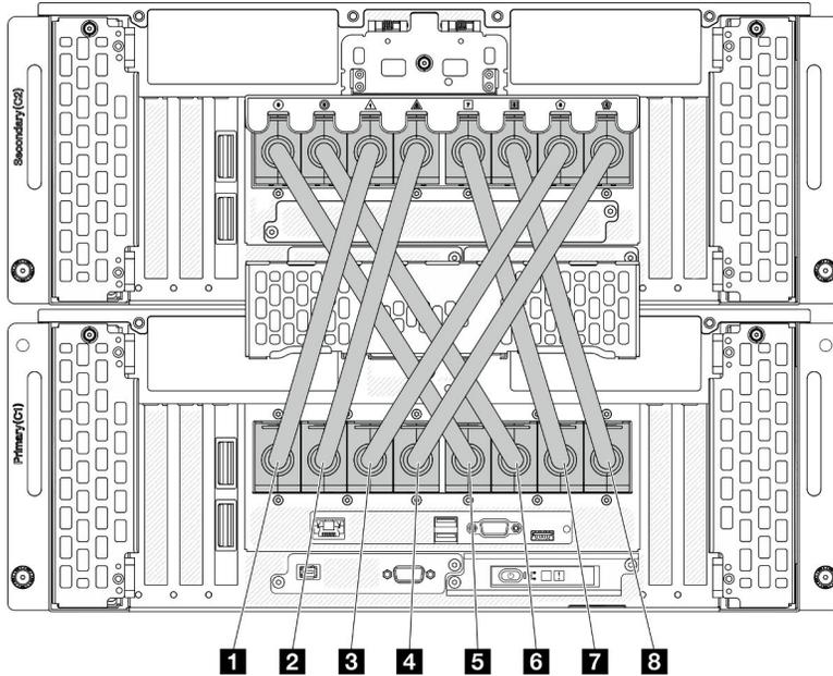
Figure 5. Débranchement des câbles UPI externes
