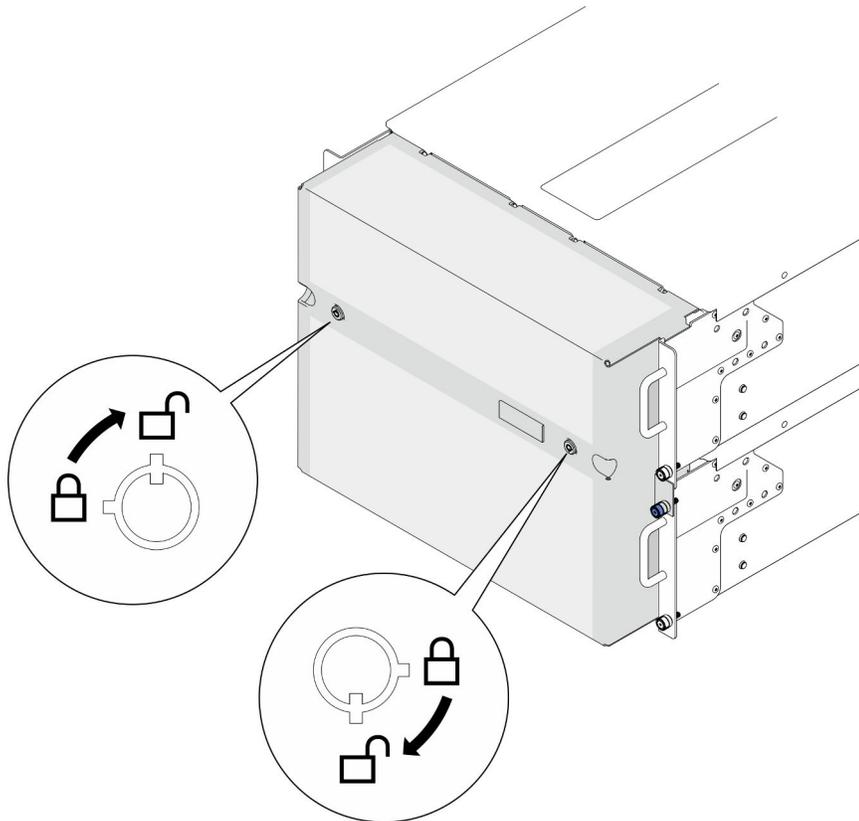
Figure 138. Déverrouillage du panneau de sécurité
