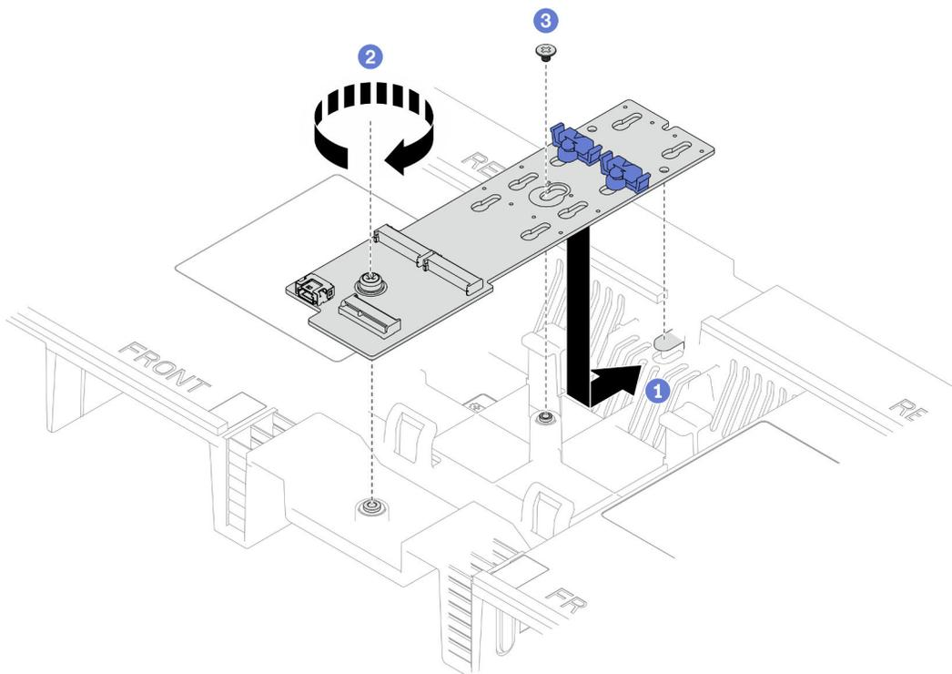
Figure 81. Installation de l'adaptateur d'amorçage M.2
