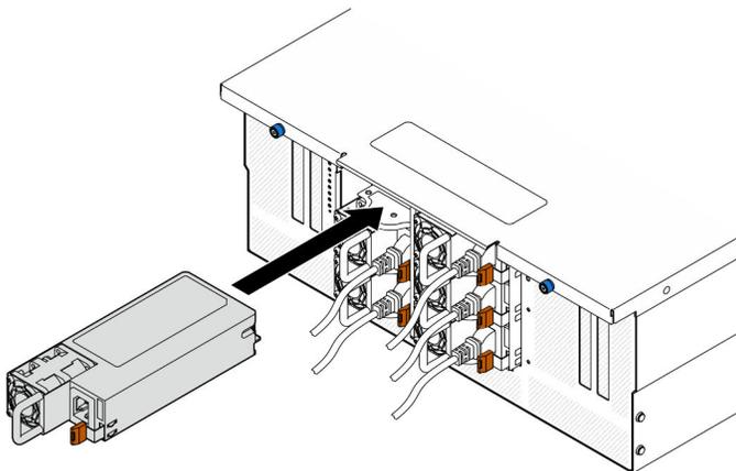
Figure 127. Installation d'un bloc d'alimentation
