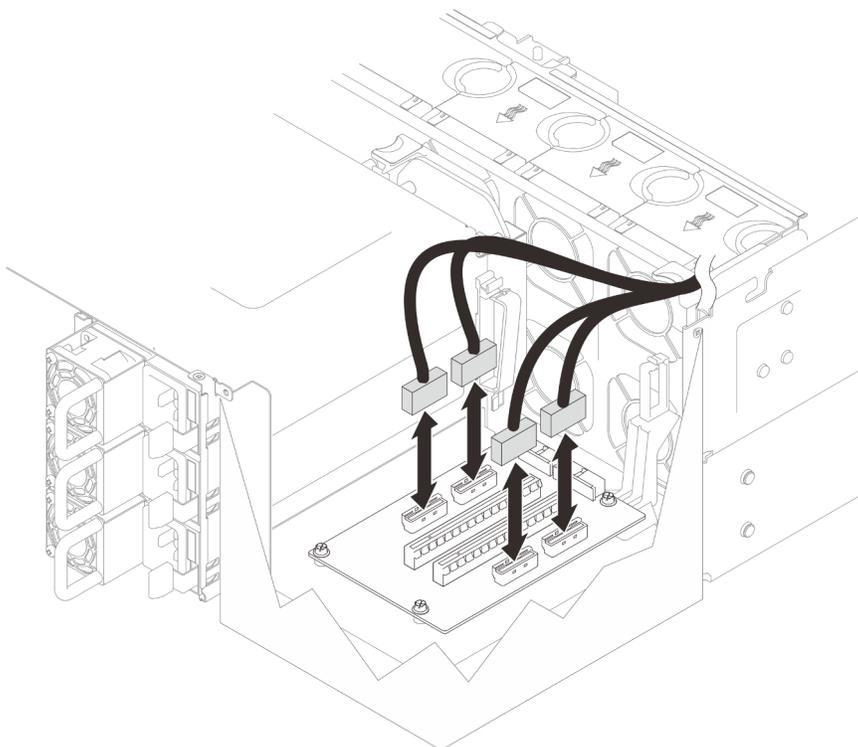
Figure 113. Branchement des câbles de la carte mezzanine PCIe
