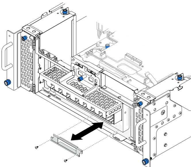
Figure 54. Retrait du support du panneau opérateur avant
