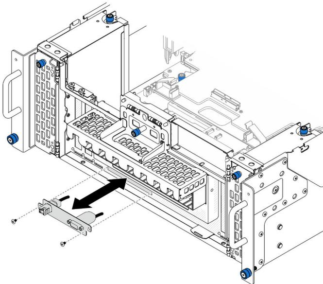
Figure 144. Installation de l'assemblage de port série
