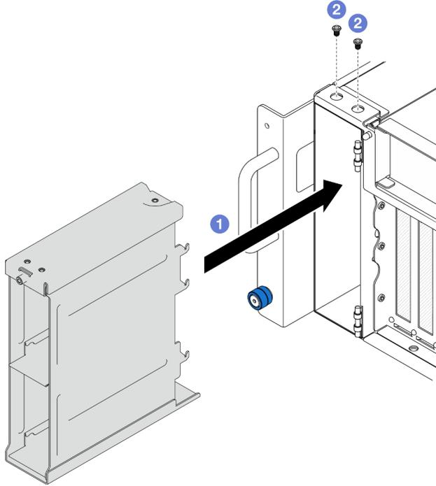
Figure 33. Installation d'un boîtier d'unités de disque dur de 2,5 pouces
