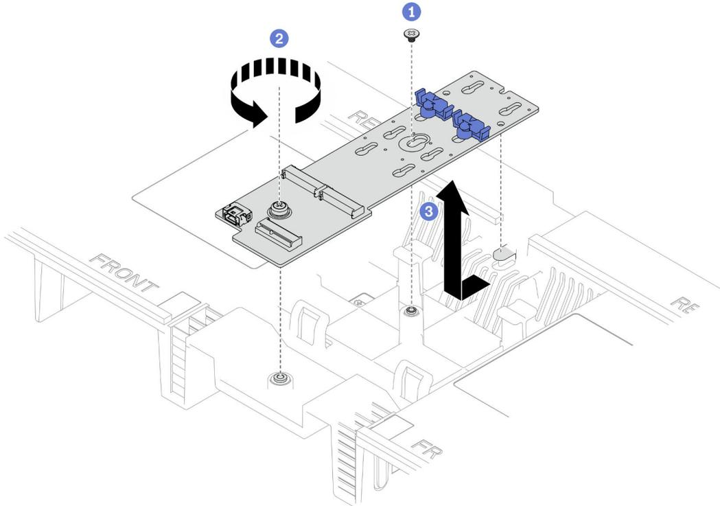
Figure 80. Retrait de l'adaptateur d'amorçage M.2
