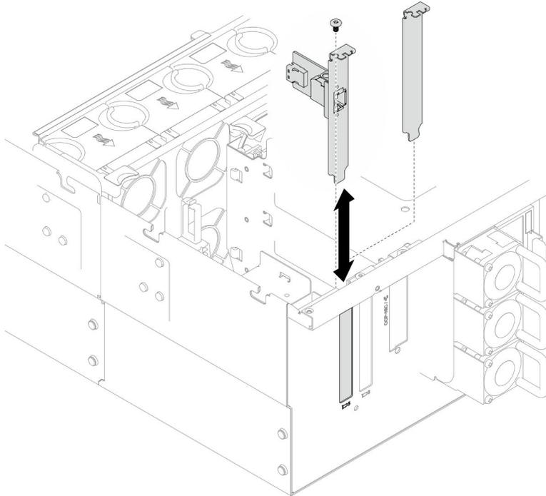
Figure 42. Installation de l'assemblage de port Ethernet
