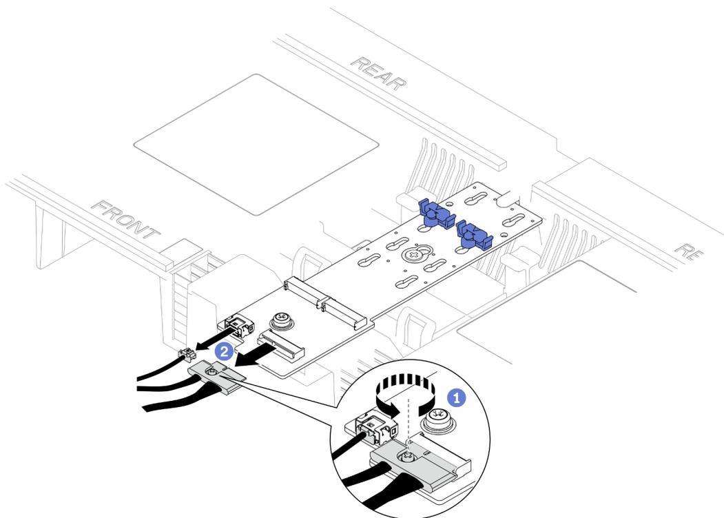
Figure 9. Débranchement du câble de l'adaptateur d'amorçage M.2
