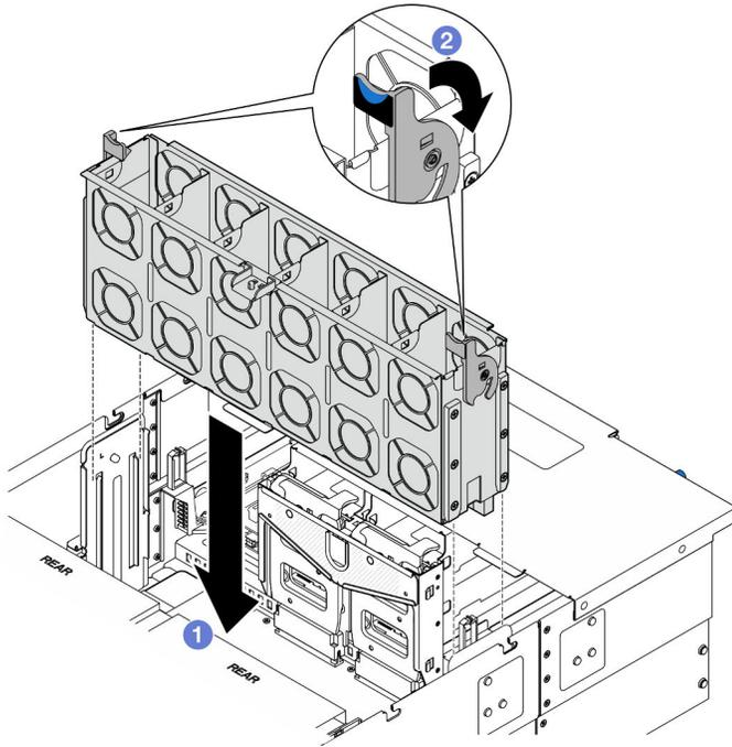
Figure 45. Installation du boîtier de ventilation
