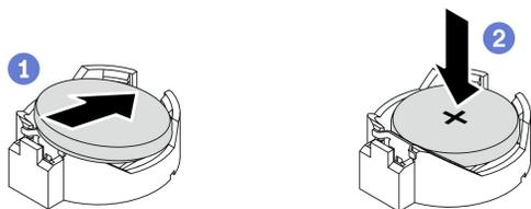
Figure 17. Installer la pile CMOS
