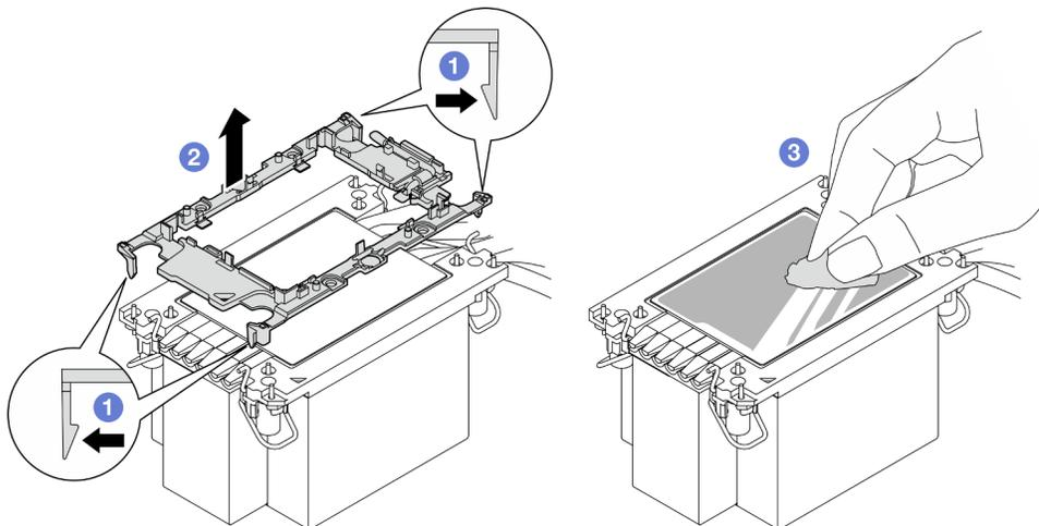
Figure 132. Dissociation d'un support de processeur du dissipateur thermique
