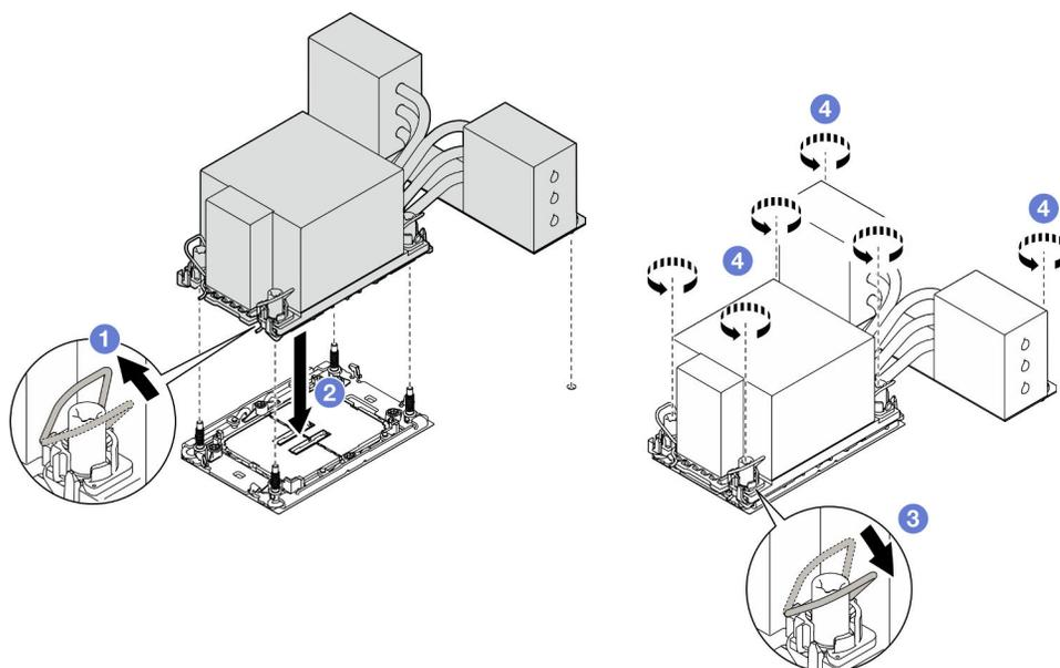
Figure 137. Installation d'un module de processeur-dissipateur thermique 3U
