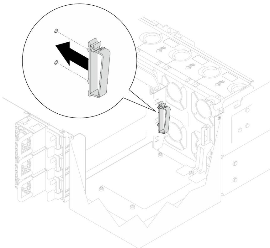
Figure 111. Installation du guide-câble
