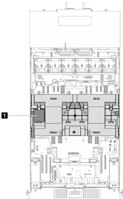
Figure 47. Emplacement du module d'alimentation flash
