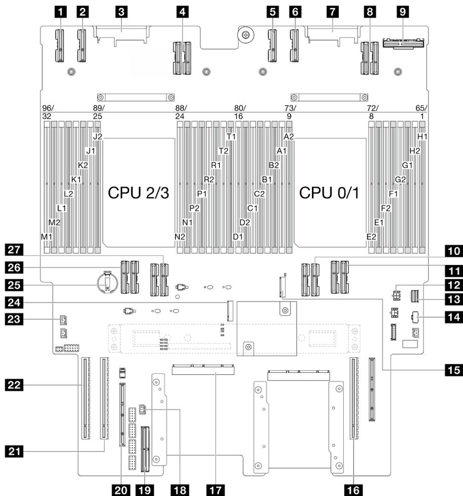
Figure 203. Connecteurs de la carte inférieure de processeur (MB)
