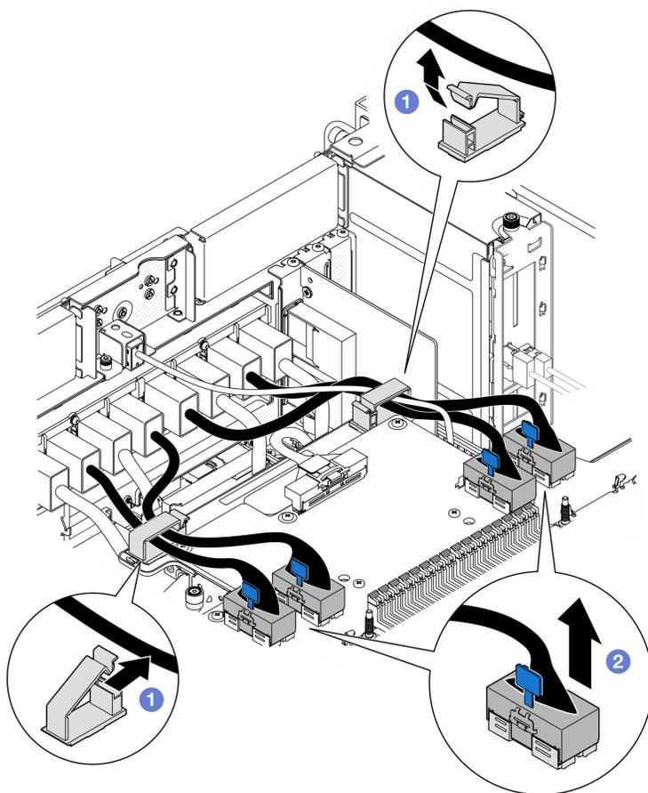
Figure 177. Débranchement des câbles de module UPI
