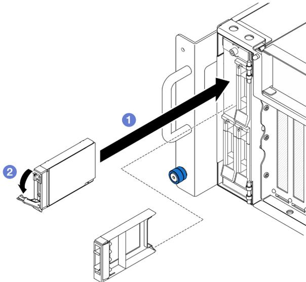
Figure 25. Installation d'une unité 2,5 pouces
