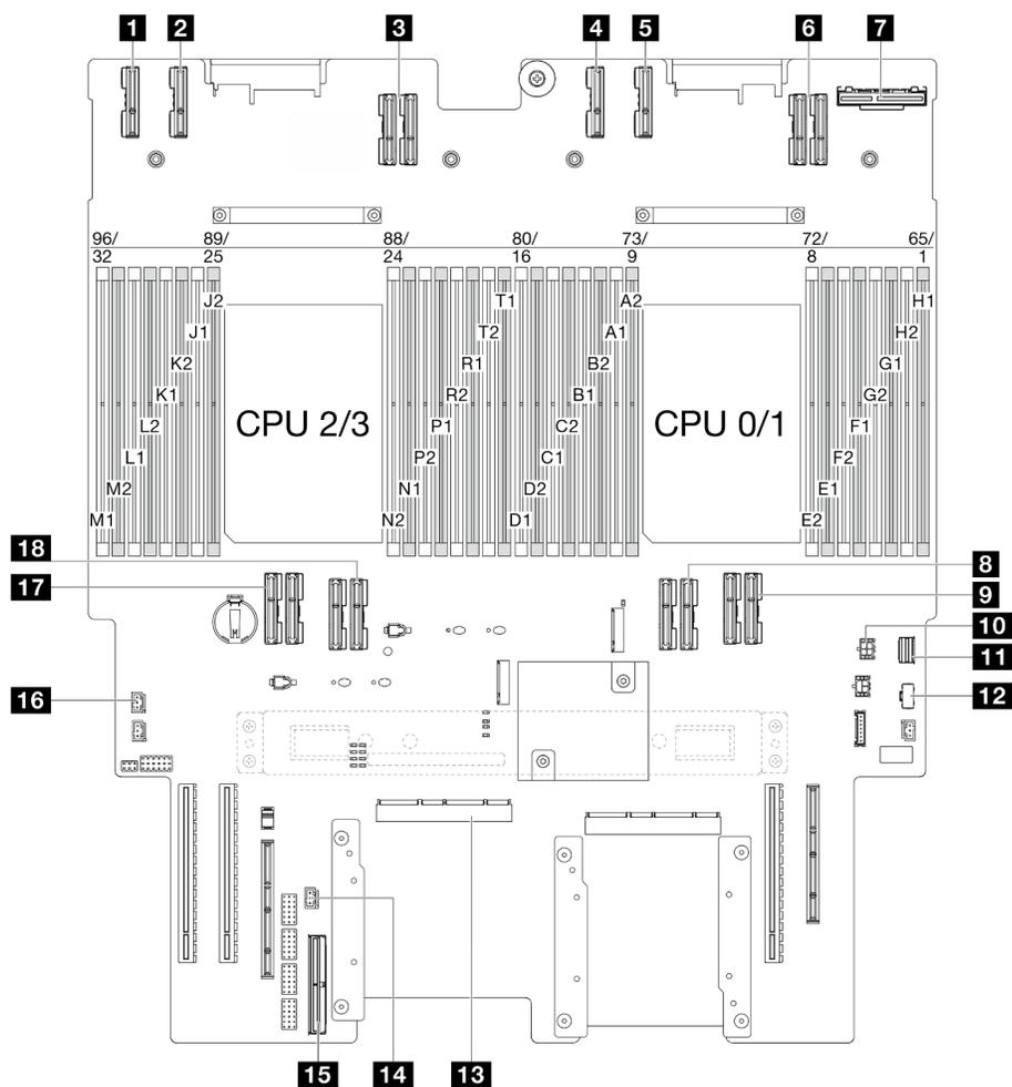
Figure 192. Connecteurs de la carte inférieure de processeur (MB)
