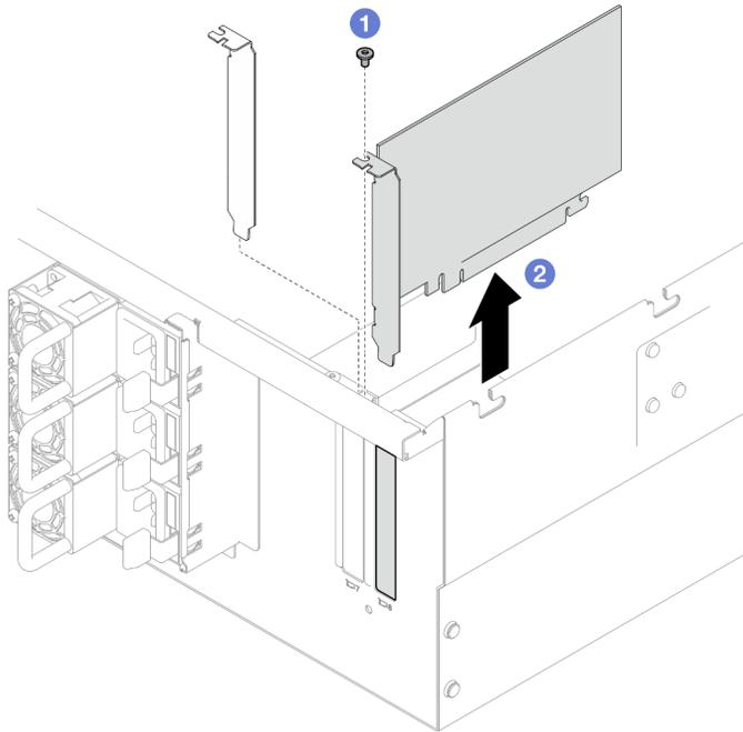
Figure 103. Retrait de l'adaptateur PCIe
