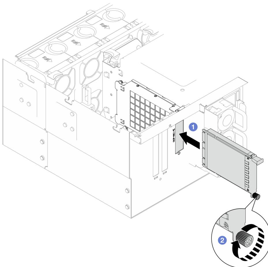
Figure 99. Installation du module OCP
