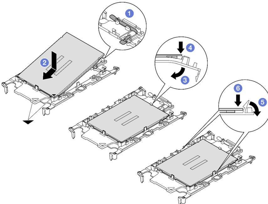
Figure 134. Installation d'un support de processeur
