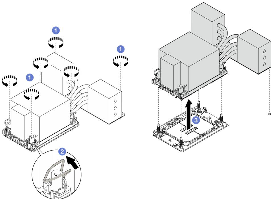
Figure 130. Retrait d'un module de processeur-dissipateur thermique 3U
