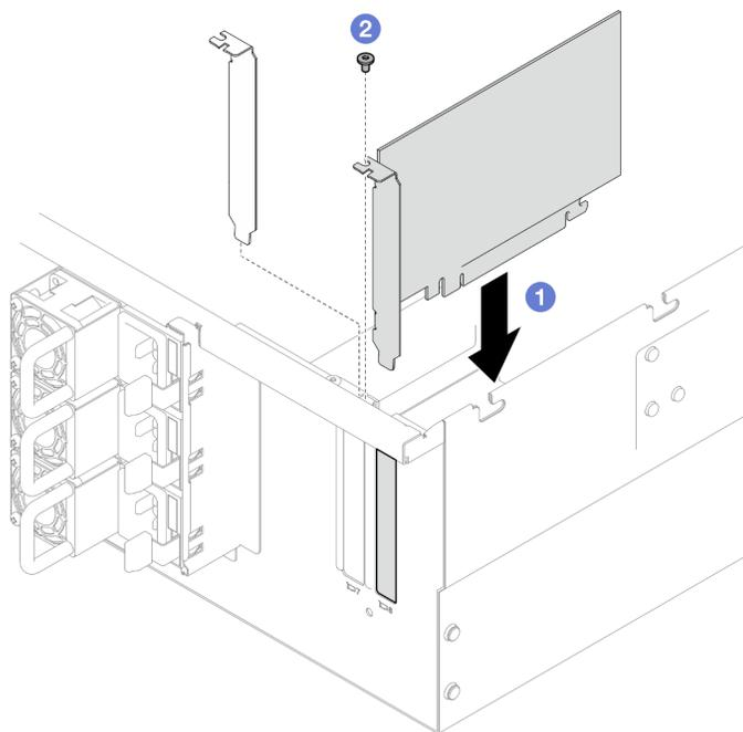
Figure 107. Installation de l'adaptateur PCIe
