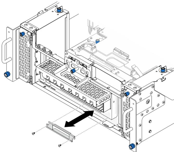
Figure 55. Installation du support de panneau opérateur avant
