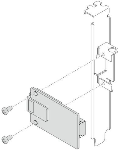
Figure 41. Installation de la carte de port Ethernet
