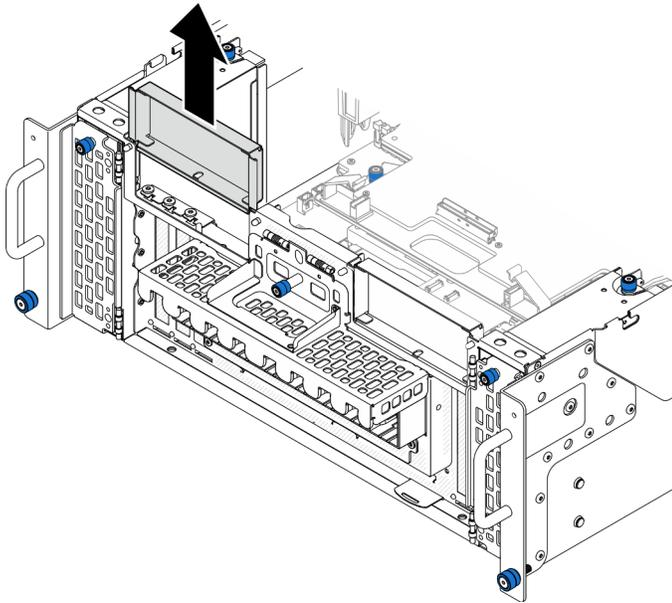
Figure 145. Retrait de l'obturateur PCIe gauche
