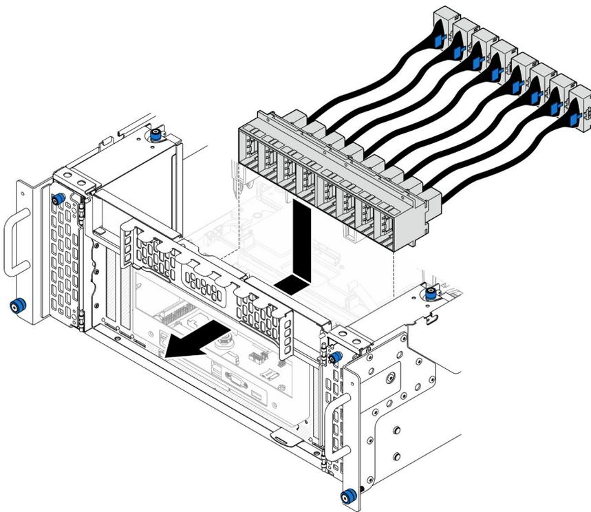
Figure 174. Installation du module UPI
