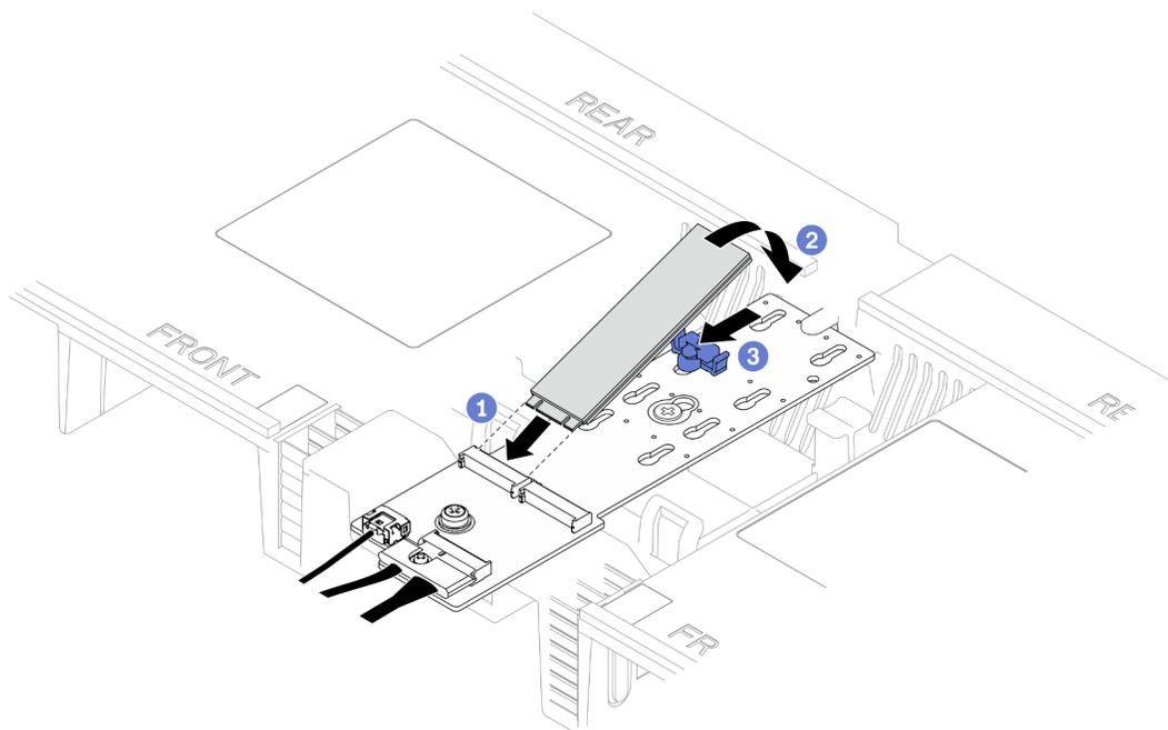
Figure 87. Installation d'une unité M.2
