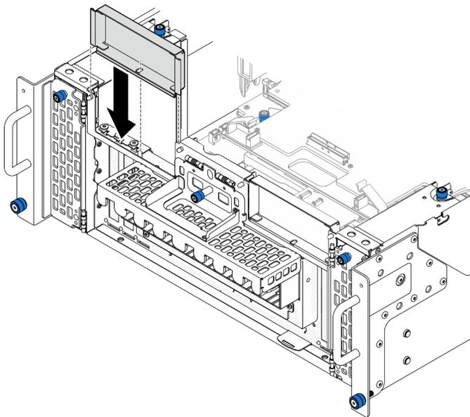
Figure 147. Installation de l'obturateur PCIe gauche
