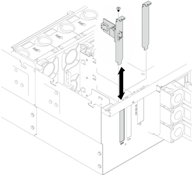
Figure 39. Retrait de l'assemblage de port Ethernet
