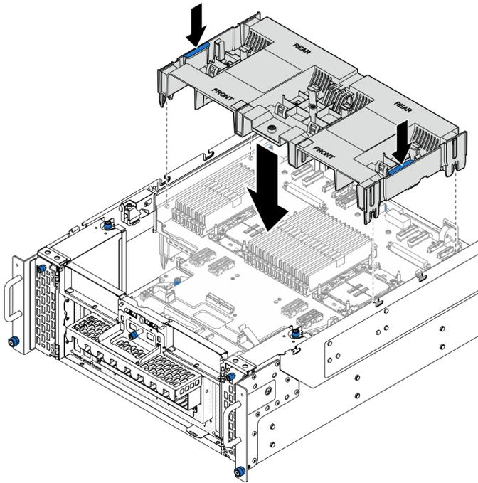
Figure 11. Installation de la grille d'aération de la carte supérieure du processeur (BD CPU)
