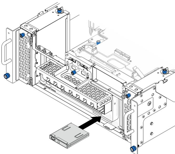
Figure 57. Installation du panneau opérateur avant
