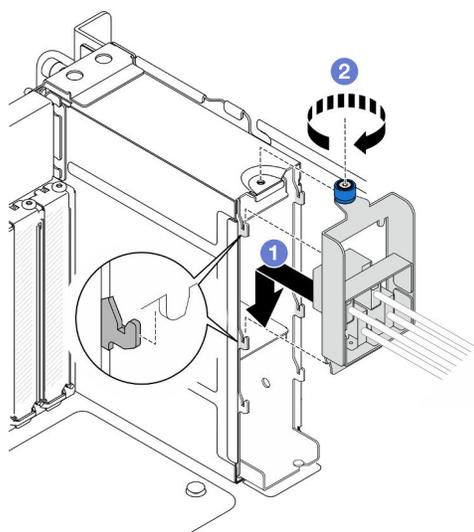
Figure 36. Installation de l'assemblage de câbles E3.S
