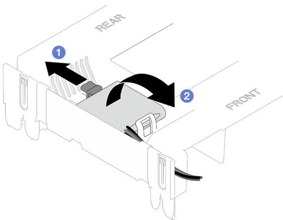
Figure 49. Retrait du module d'alimentation flash
