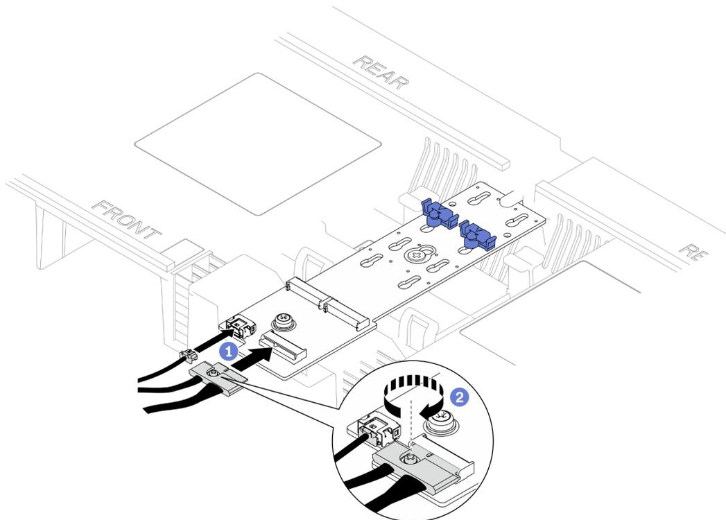
Figure 82. Branchement du câble à l'adaptateur d'amorçage M.2
