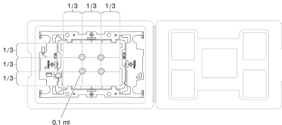
Figure 135. Application de pâte thermoconductrice avec processeur dans le plateau d'expédition
