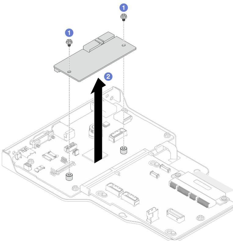
Figure 153. Retrait du module de microprogramme et de sécurité RoT
