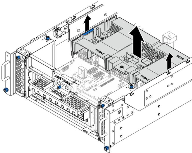
Figure 13. Retrait de la grille d'aération de la carte inférieure du processeur (MB)
