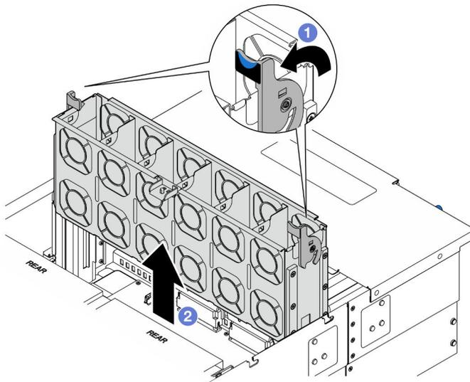
Figure 44. Retrait du boîtier de ventilation
