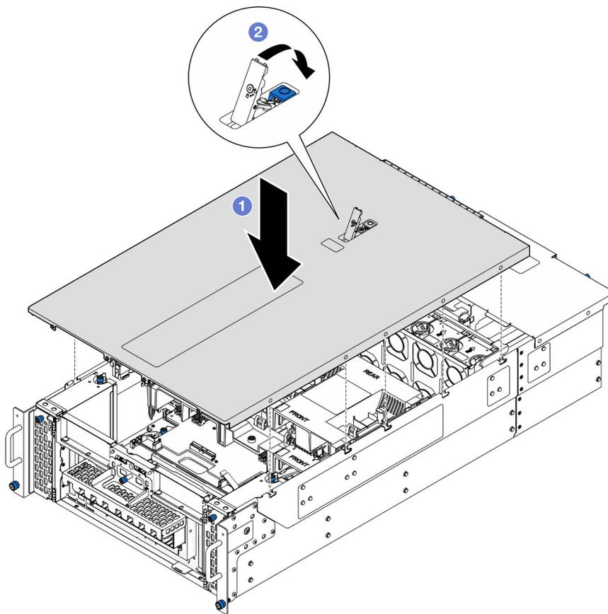
Figure 169. Installation du carter supérieur avant
