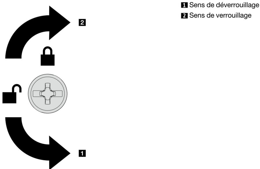
Figure 170. Sens de verrouillage/déverrouillage du carter supérieur avant
