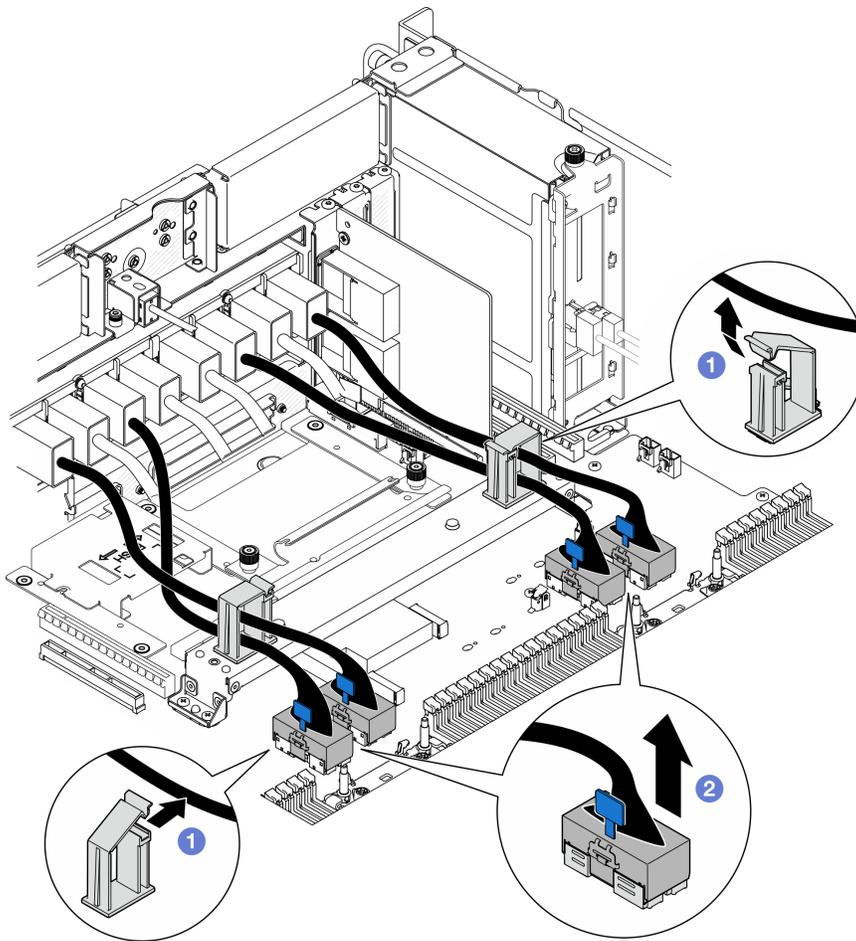
Figure 68. Débranchement des câbles de module UPI
