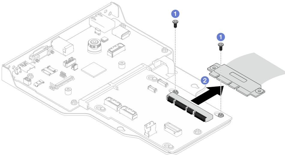
Figure 155. Débranchement du câble SCM
