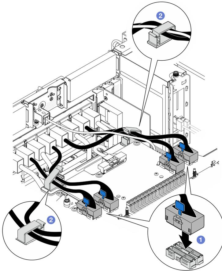
Figure 188. Branchement des câbles du module UPI
