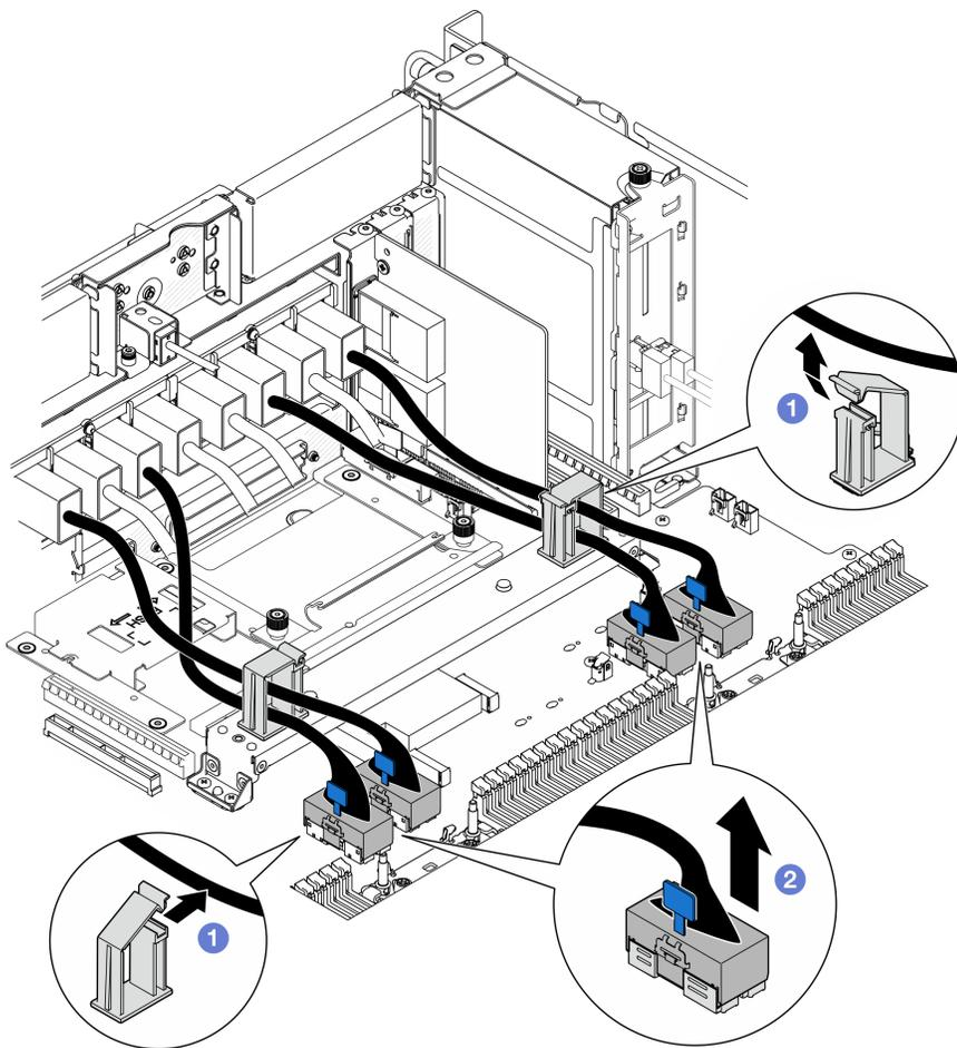
Figure 171. Débranchement des câbles de module UPI
