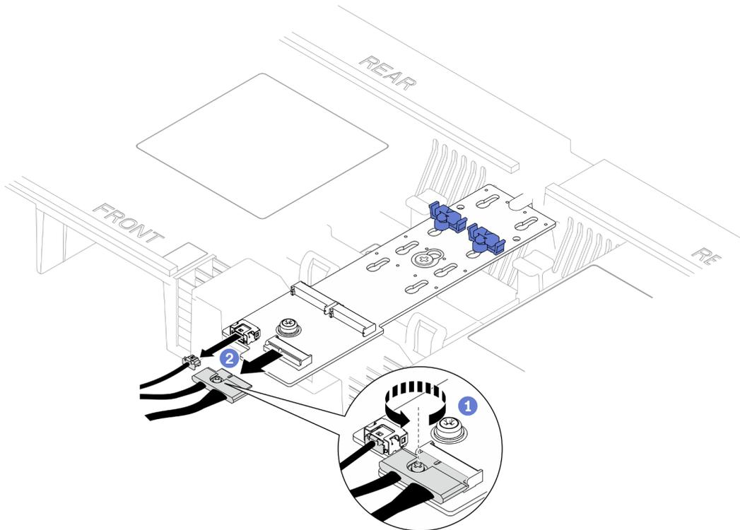
Figure 79. Débranchement du câble de l'adaptateur d'amorçage M.2
