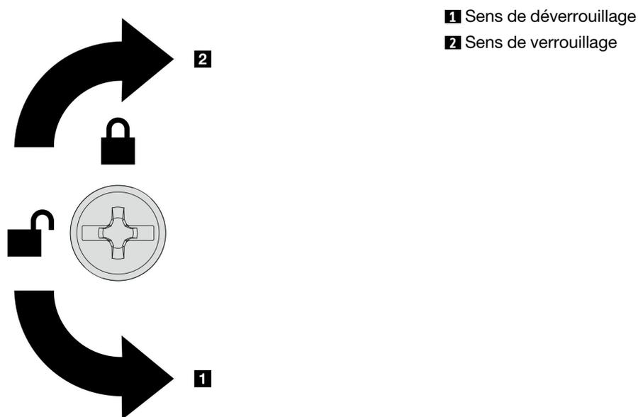
Figure 165. Sens de verrouillage/déverrouillage du carter supérieur avant
