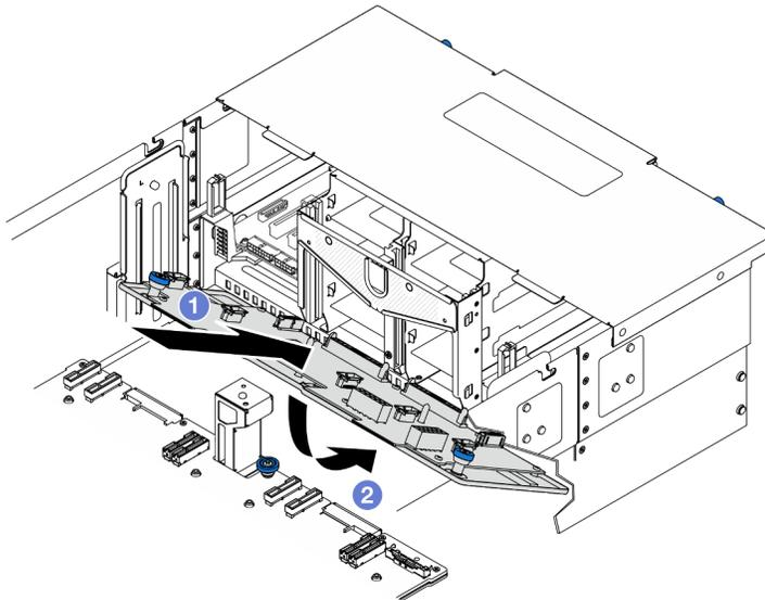
Figure 119. Installation du tableau de distribution
