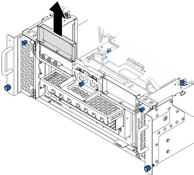
Figure 148. Retrait de l'obturateur PCIe gauche
