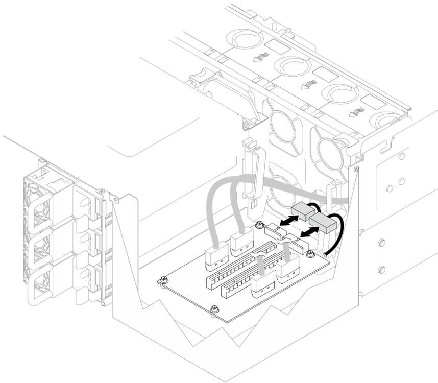
Figure 108. Débranchement des cordons d'alimentation
