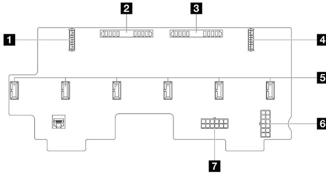
Figure 193. Connecteurs du tableau de distribution
