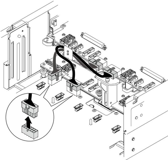
Figure 115. Débranchement des câbles du tableau de distribution
