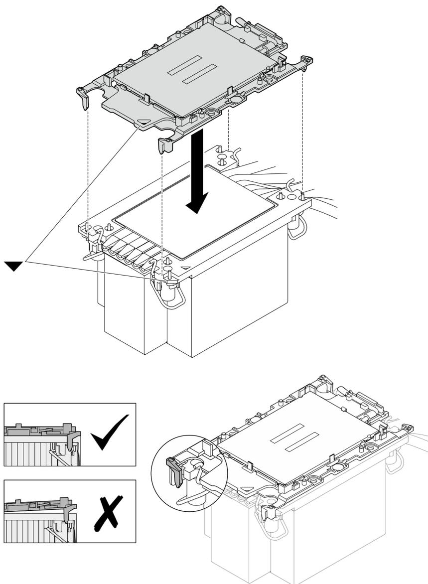
Figure 136. Assemblage du module de processeur-dissipateur thermique avec le processeur dans le plateau d'expédition
