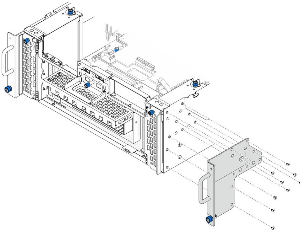
Figure 38. Installation de la bride EIA
