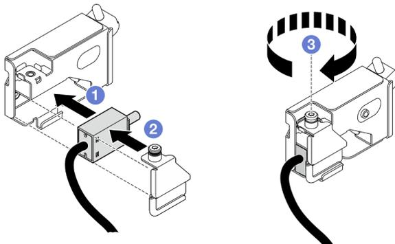
Figure 60. Installation du commutateur de détection d'intrusion du carter supérieur
