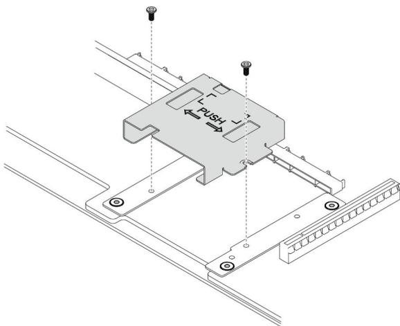
Figure 56. Installation du boîtier de panneau opérateur avant
