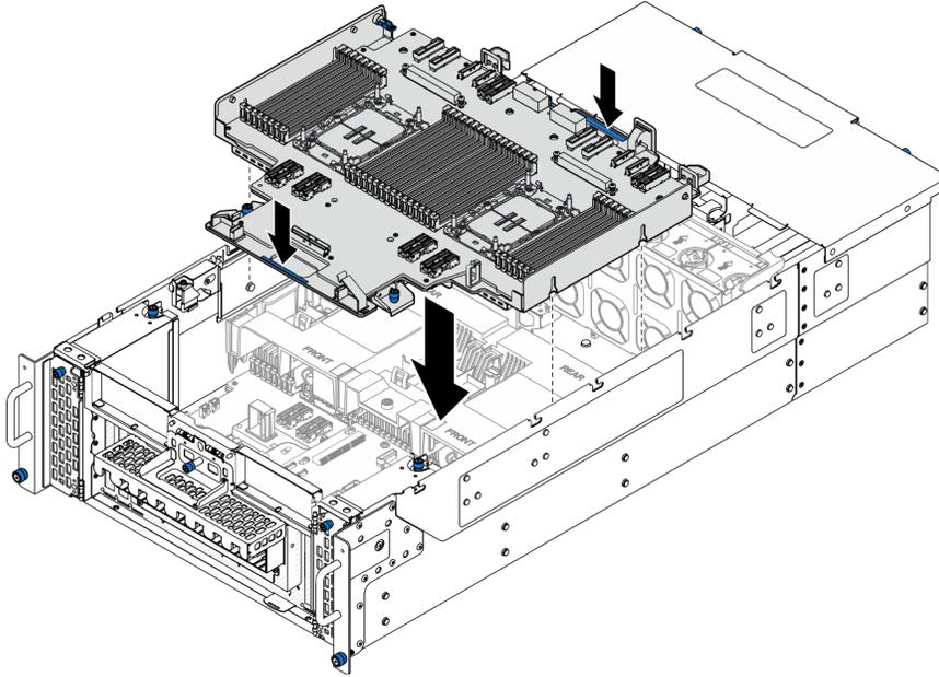
Figure 183. Installation de la carte supérieure du processeur (BD CPU)
