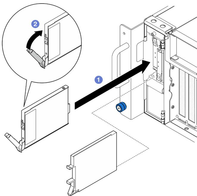
Figure 26. Installation d'une unité E3.S
