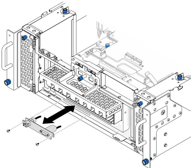
Figure 143. Retrait de l'assemblage de port série
