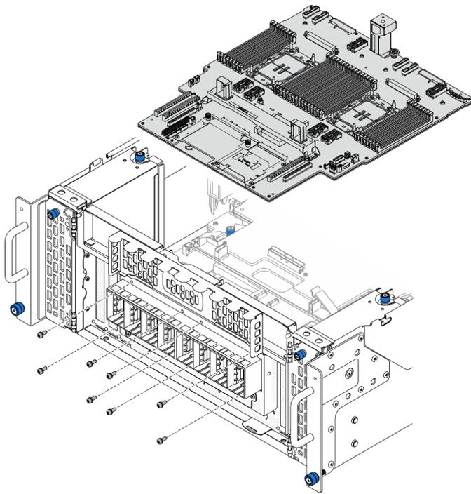
Figure 172. Retrait des vis du module UPI
