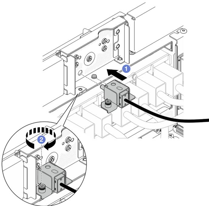
Figure 66. Installation du bloc du commutateur de détection d'intrusion avant
