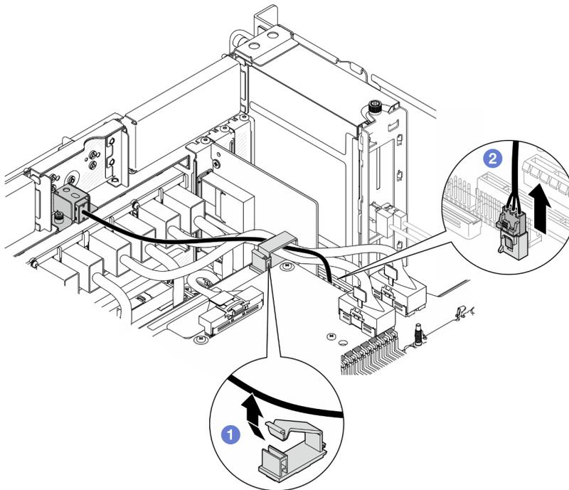
Figure 62. Débranchement du commutateur de détection d'intrusion
