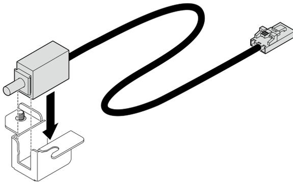
Figure 65. Installation du commutateur de détection d'intrusion
