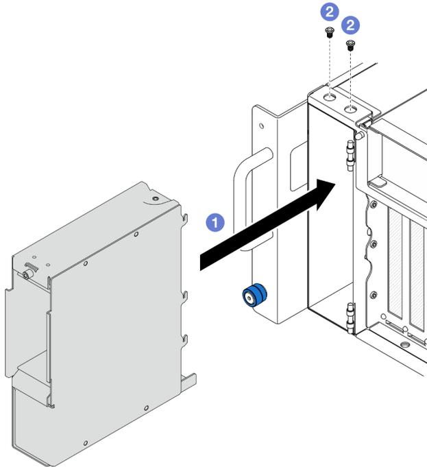
Figure 34. Installation d'un boîtier d'unités de disque dur E3.S
