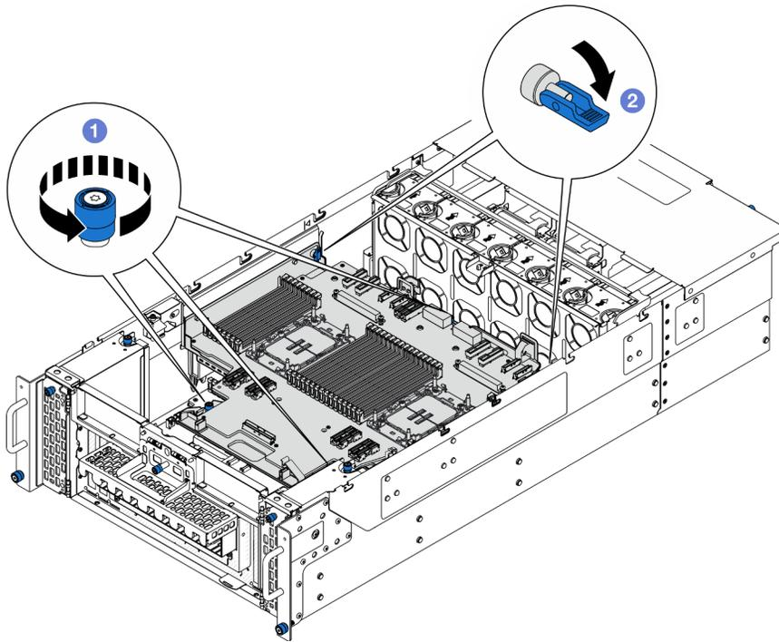
Figure 181. Dégagement de la carte supérieure de processeur (BD CPU)
