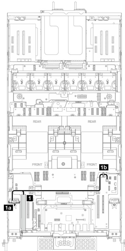
Figure 195. Cheminement des câbles d'un fond de panier d'unité 2,5 pouces
