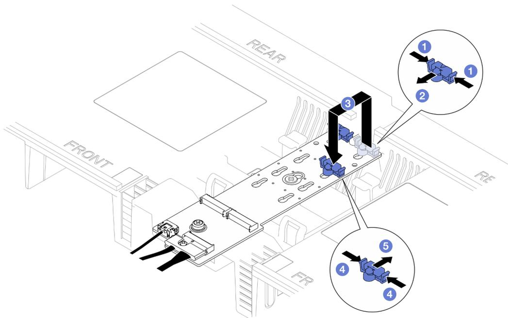
Figure 83. Ajustement du crochet de retenue M.2
