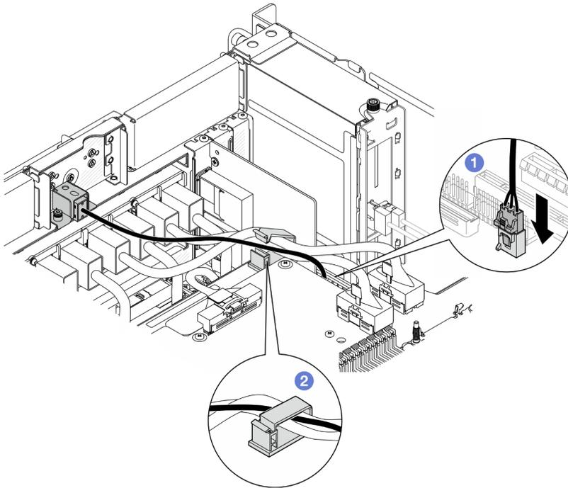
Figure 67. Branchement du commutateur de détection d'intrusion
