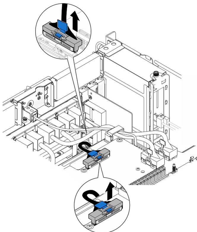
Figure 178. Débranchement du câble de bande latérale interne
