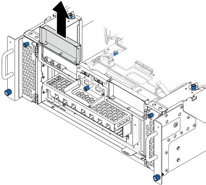
Figure 100. Retrait de l'obturateur PCIe gauche
