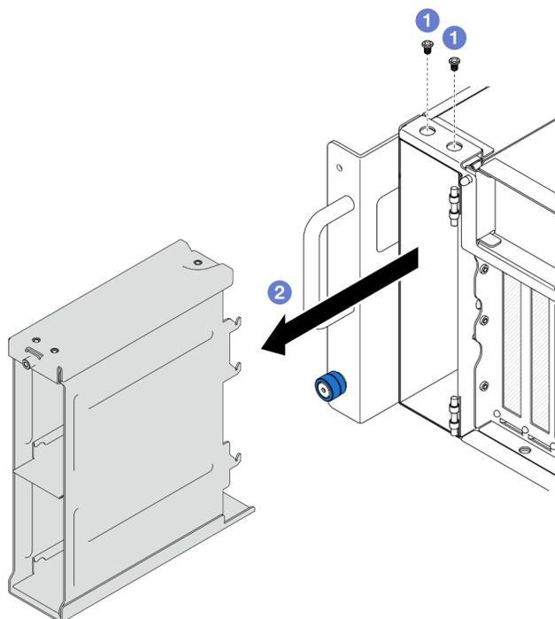
Figure 31. Retrait du boîtier d'unités de disque dur de 2,5 pouces
