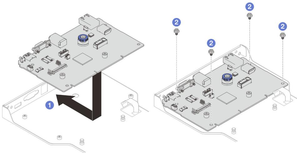
Figure 160. Installation de la carte d'E-S système sur le support
