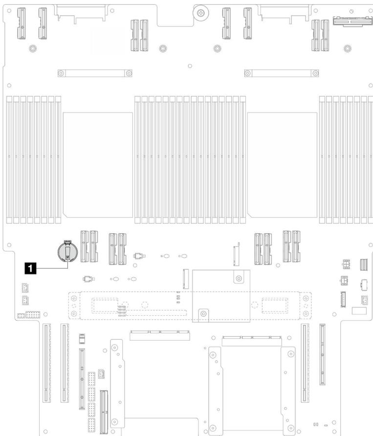
Figure 15. Emplacement de la pile CMOS
