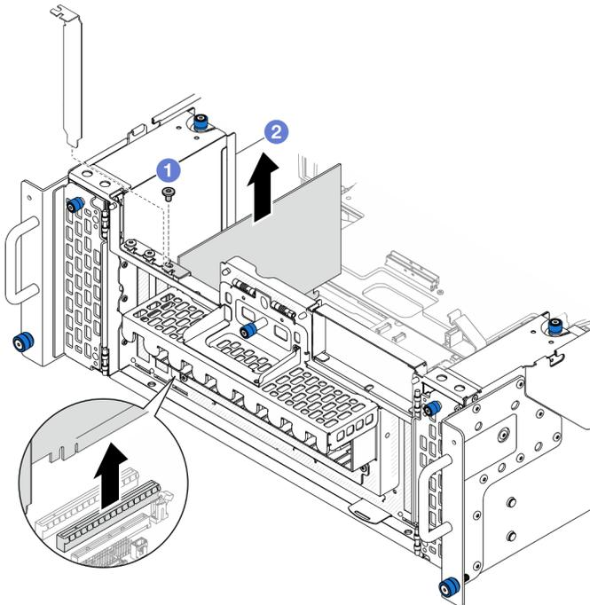
Figure 101. Retrait de l'adaptateur PCIe
