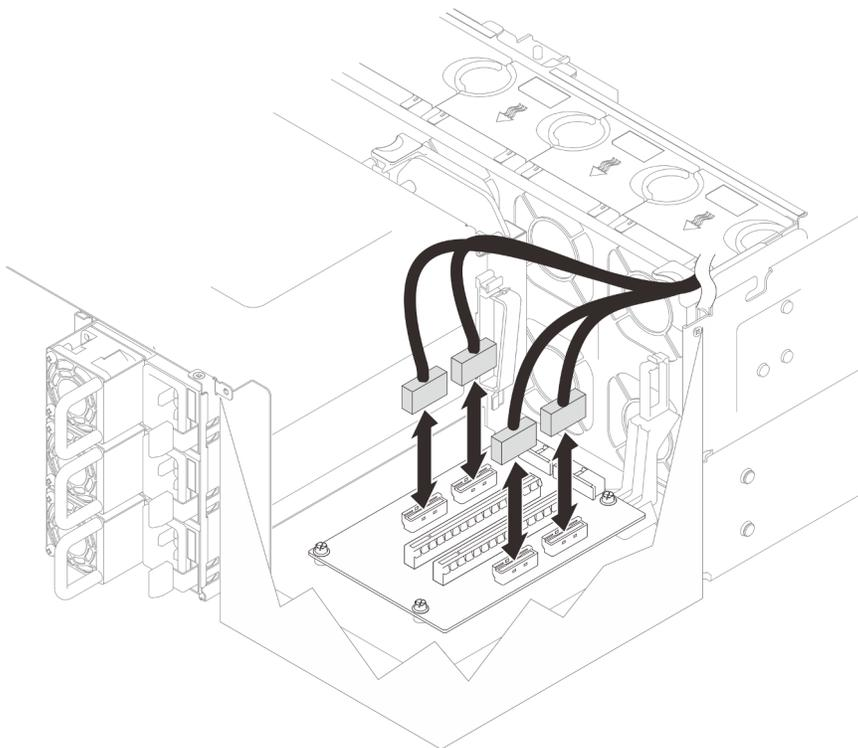
Figure 109. Débranchement des câbles de la carte mezzanine PCIe
