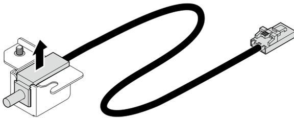
Figure 64. Retrait du commutateur de détection d'intrusion
