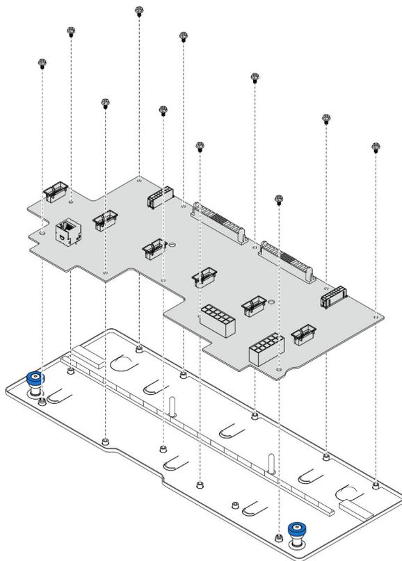
Figure 118. Démontage du tableau de distribution
