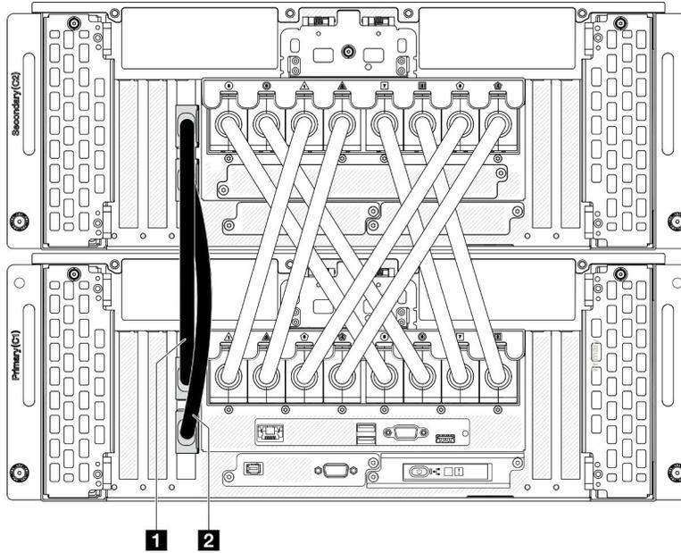
Figure 8. Branchement des câbles de bande latérale
