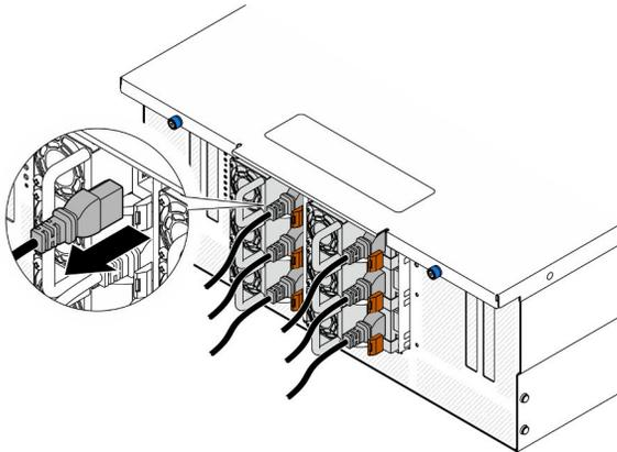
Figure 125. Débranchement du cordon d'alimentation
