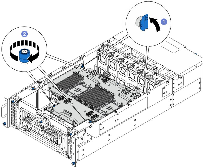
Figure 184. Fixation de la carte supérieure du processeur (BD CPU)
