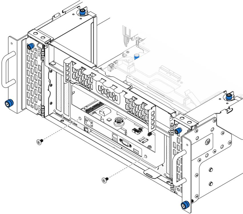
Figure 156. Desserrage du bloc de la carte d'E-S système et de la carte d'interposition
