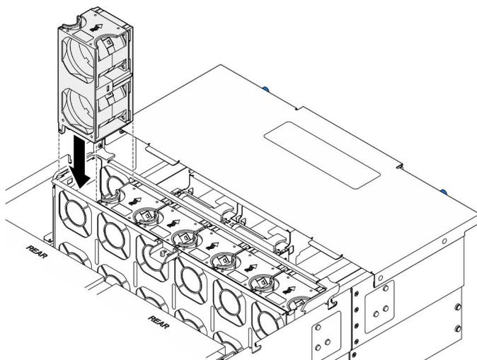
Figure 46. Installation d'un module ventilateur
