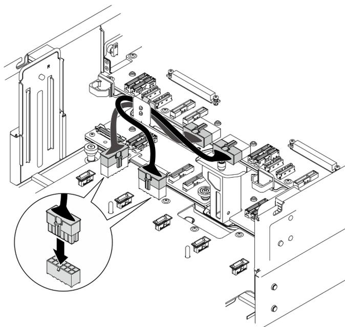
Figure 121. Branchement des câbles du tableau de distribution
