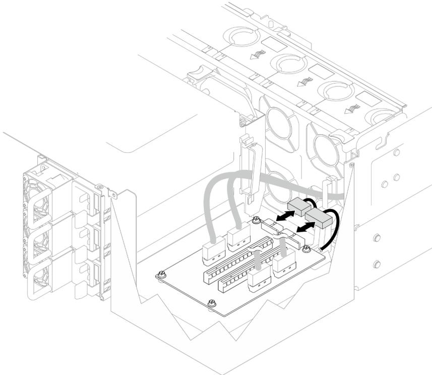
Figure 114. Connexion des cordons d'alimentation
