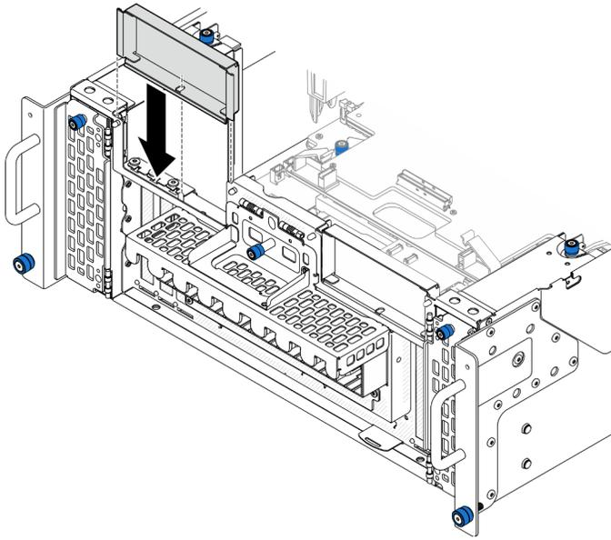
Figure 102. Installation de l'obturateur PCIe gauche
