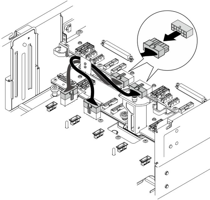
Figure 180. Débranchement des cordons d'alimentation de la carte supérieure de processeur (BD CPU)
