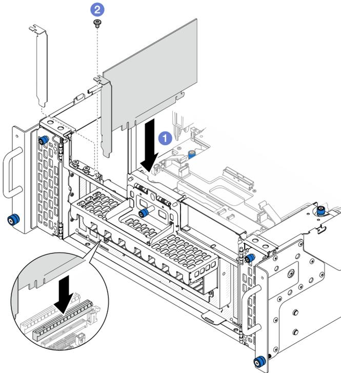
Figure 105. Installation de l'adaptateur PCIe
