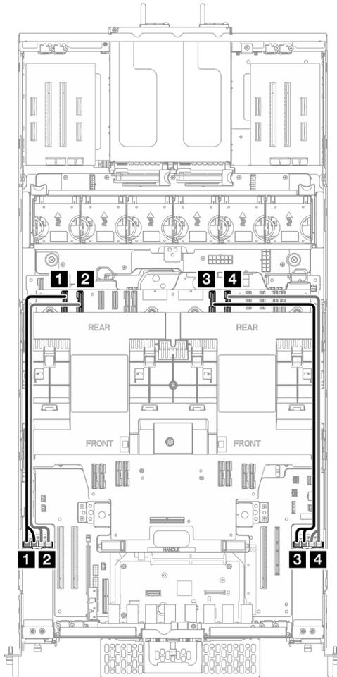
Figure 197. Cheminement des câbles de l'assemblage de câbles E3.S
