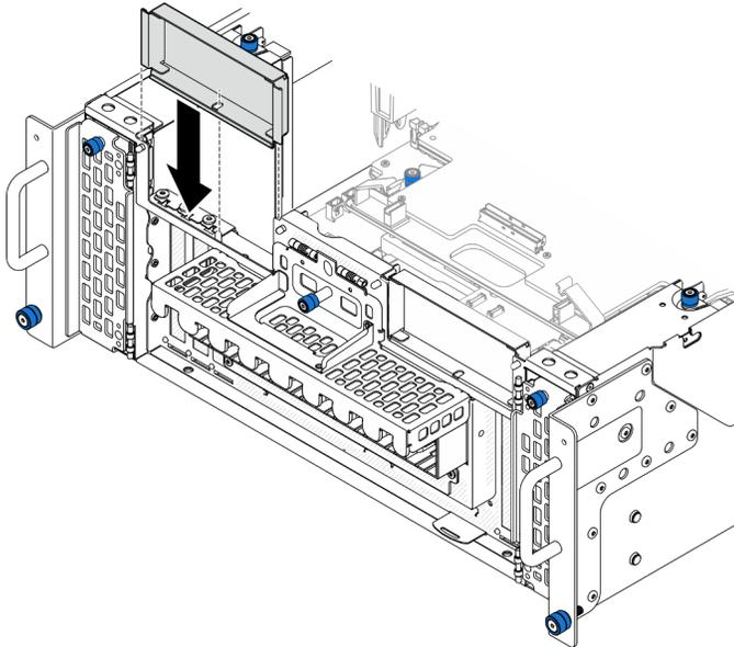
Figure 106. Installation de l'obturateur PCIe gauche
