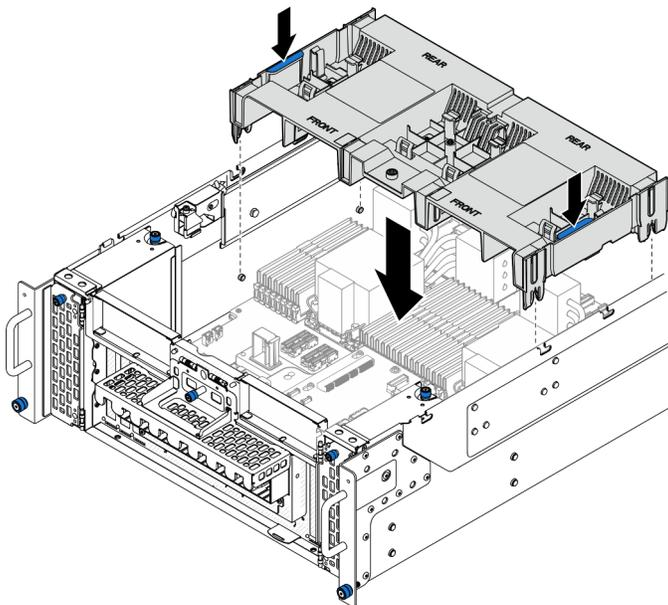
Figure 14. Installation de la grille d'aération de la carte inférieure du processeur (MB)
