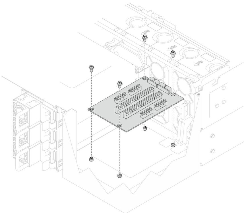
Figure 112. Installation d'une carte mezzanine PCIe
