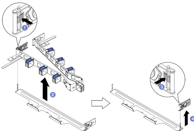
Etape 5. Alignez le trou de la patte de montage sur le gond, puis poussez la patte de montage pour l'insérer.
