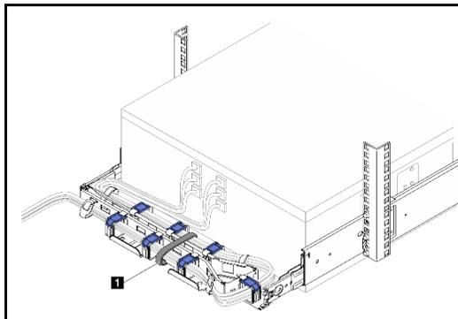
**Attention** : La longue attache de câble fixe le CMA et les câbles en place pendant le transport. Desserrez la longue attache de câble avant de retirer le serveur si le CMA est livré avec une armoire.
