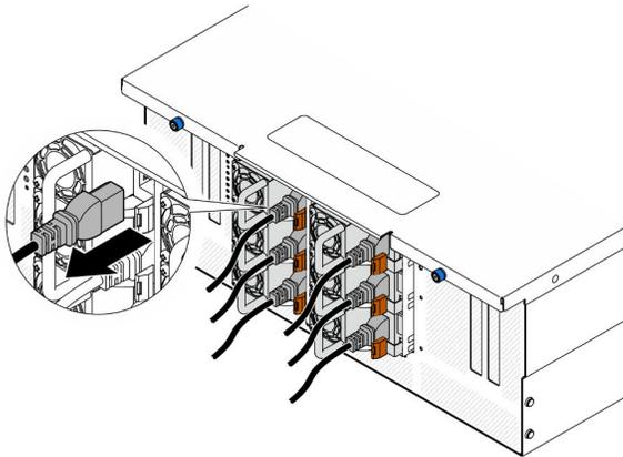
*Figura 125. Scollegamento del cavo di alimentazione*
