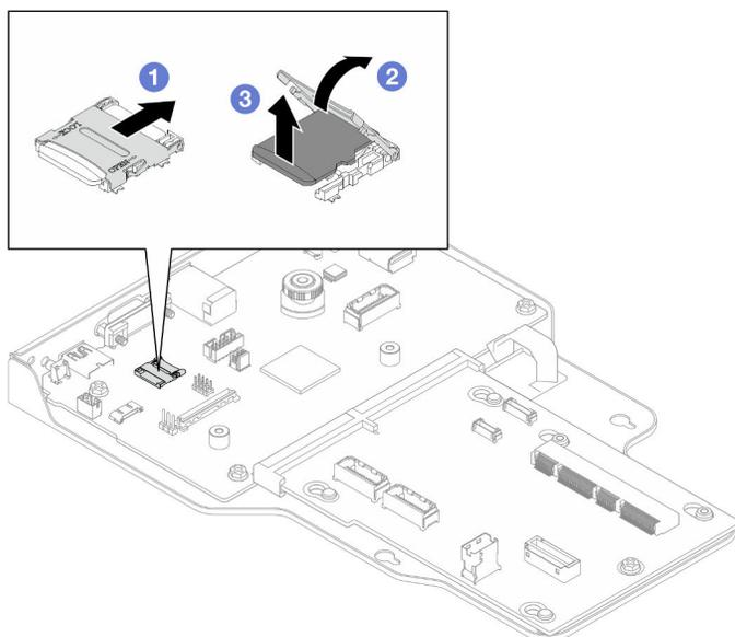
Figura 92. Rimozione della scheda MicroSD
