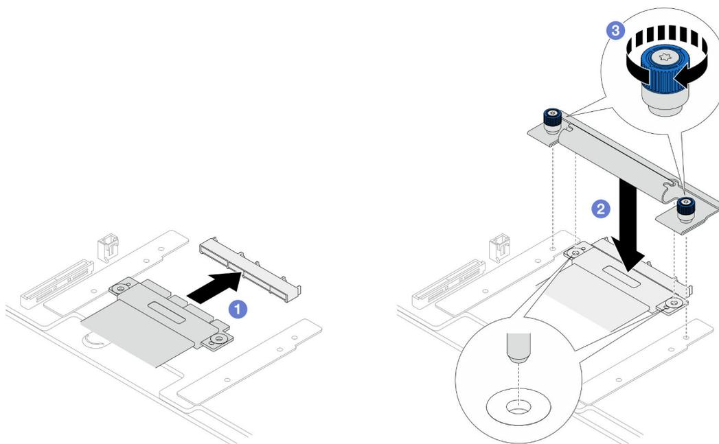
Figura 74. Collegamento del cavo SCM
