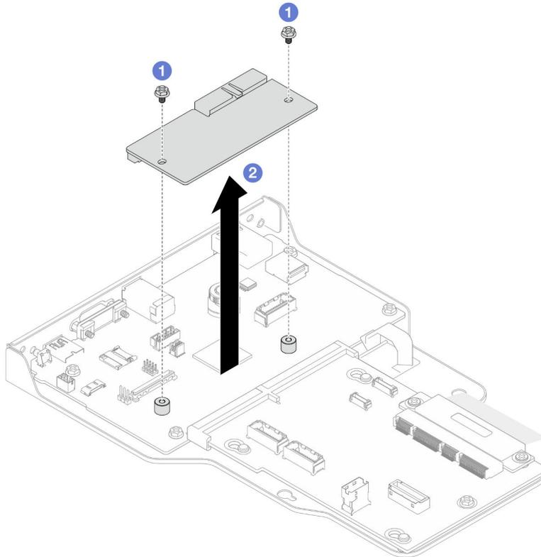
Figura 153. Rimozione del modulo firmware e sicurezza RoT
