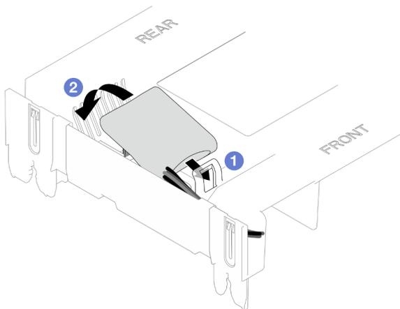
Figura 50. Installazione del modulo di alimentazione flash
