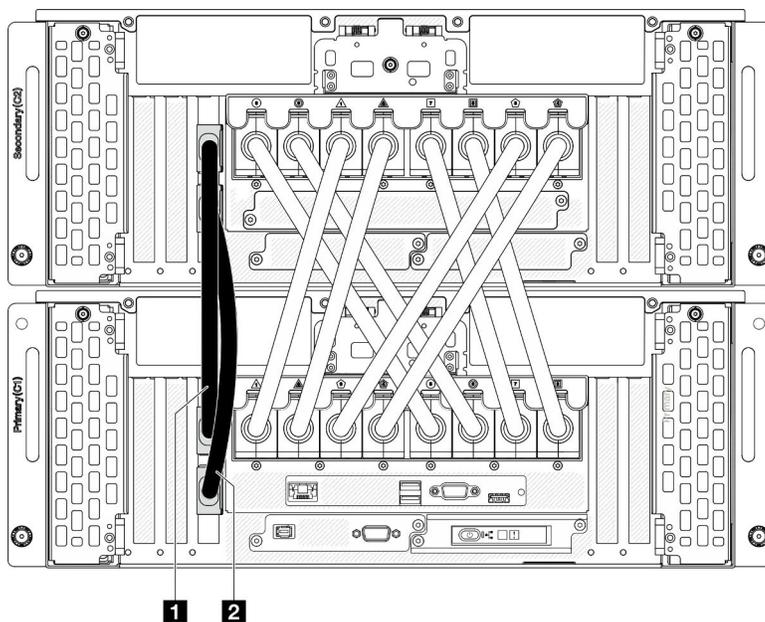
Figura 8. Collegamento dei cavi laterali
