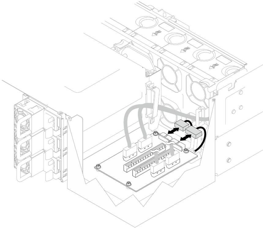
Figura 114. Collegamento dei cavi di alimentazione
