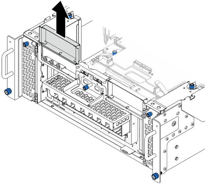
Figura 148. Rimozione dell'elemento di riempimento PCIe sinistro
