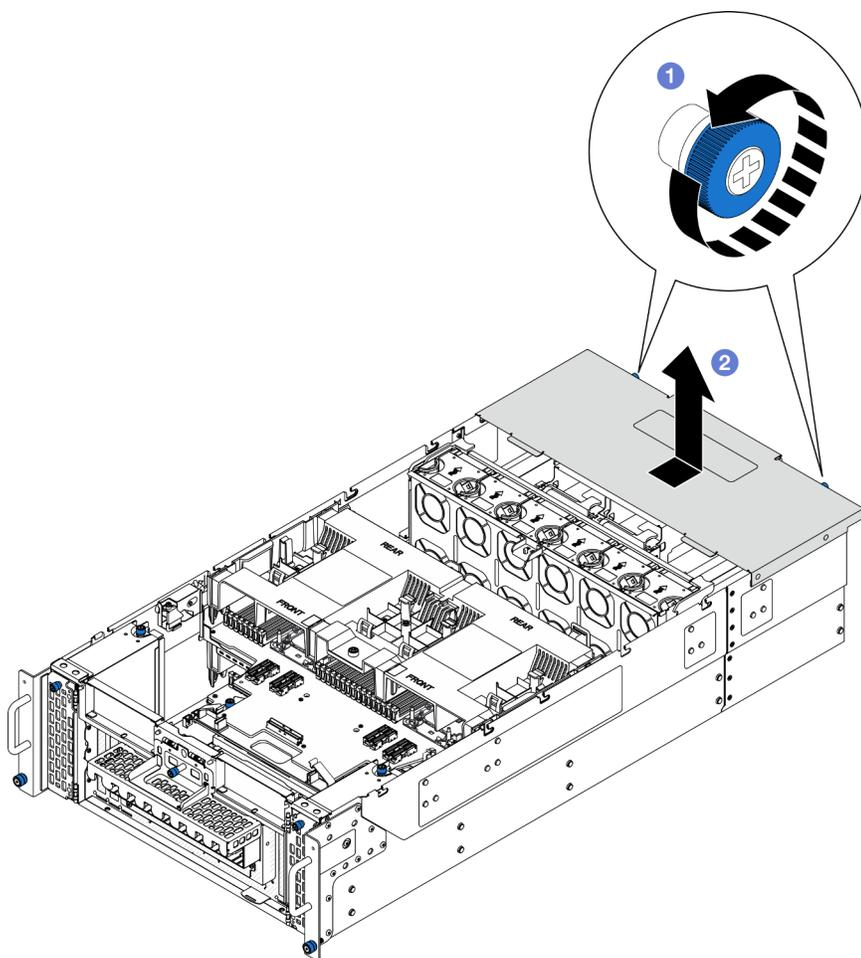
Figura 167. Rimozione del coperchio superiore posteriore
