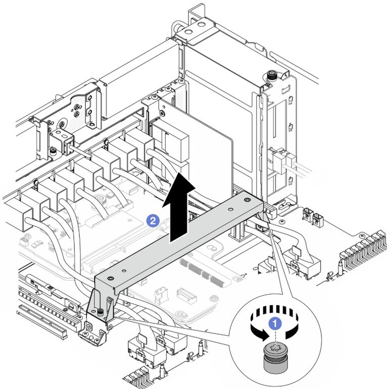
Figura 151. Rimozione della staffa di supporto
