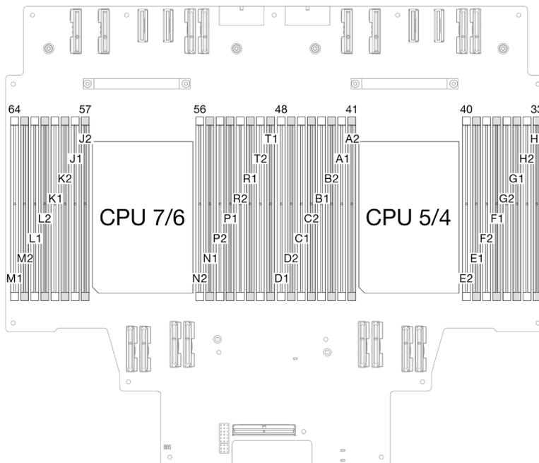
Figura 1. Layout dei moduli di memoria e dei processori (scheda del processore superiore (CPU BD))
