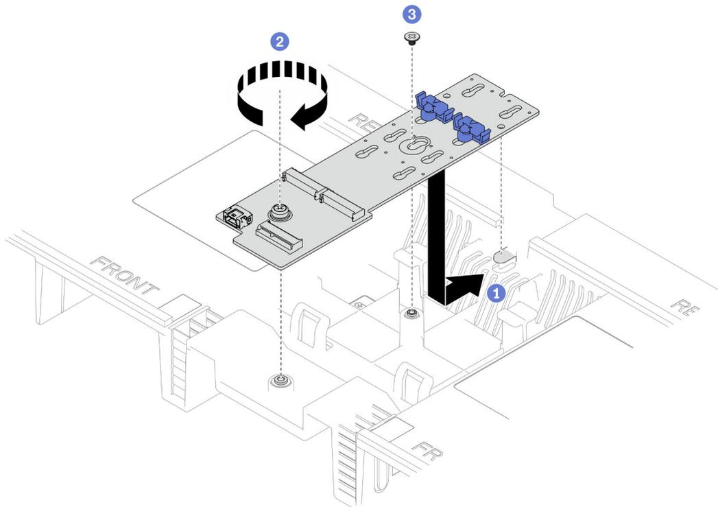
Figura 81. Installazione dell'adattatore di avvio M.2
