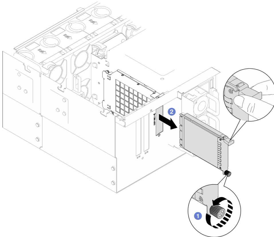
Figura 94. Rimozione del modulo OCP
