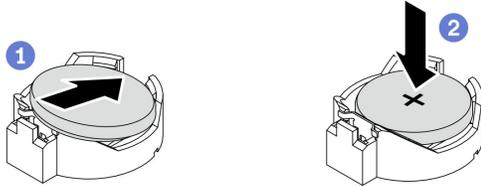
Figura 17. Installazione della batteria CMOS
