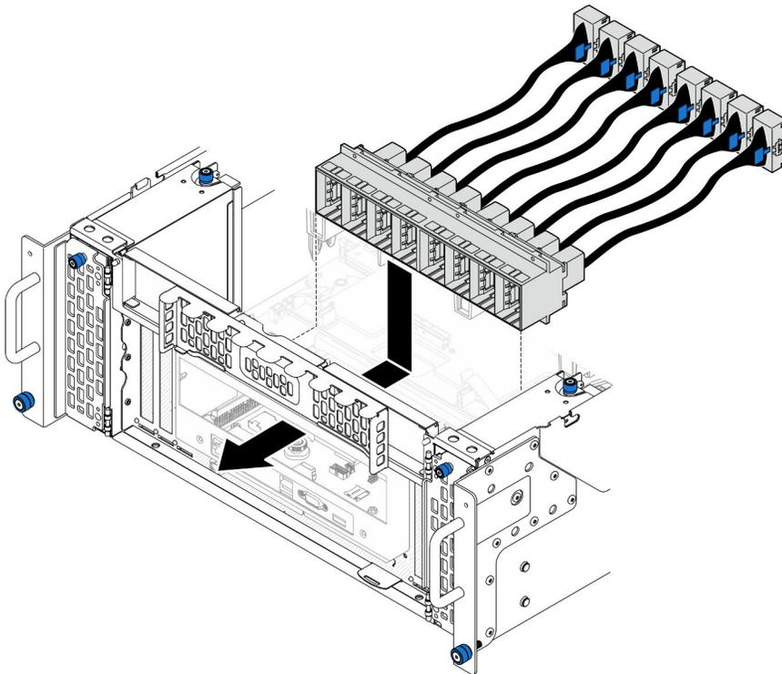
Figura 174. Installazione del modulo UPI
