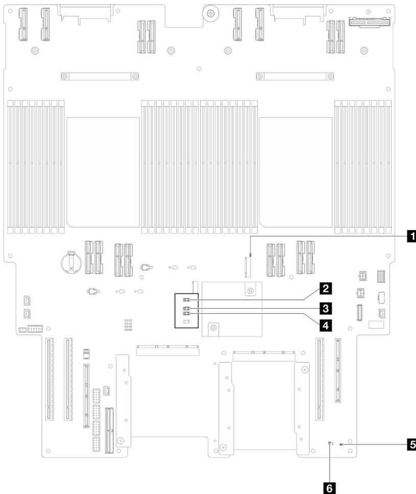
Figura 210. LED della scheda del processore inferiore (MB)
