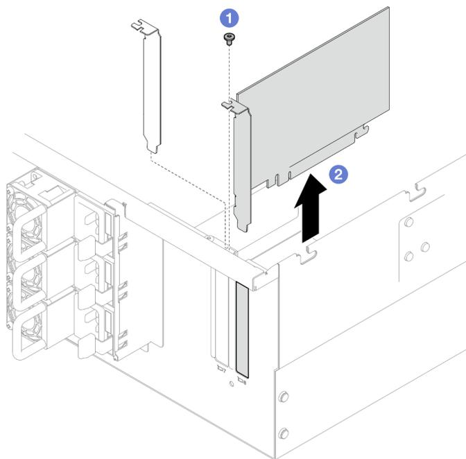
Figura 103. Rimozione dell'adattatore PCIe
