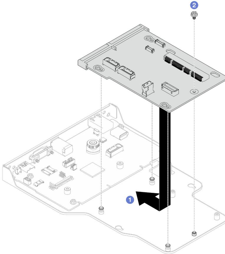
Figura 161. Installazione della scheda interposer
