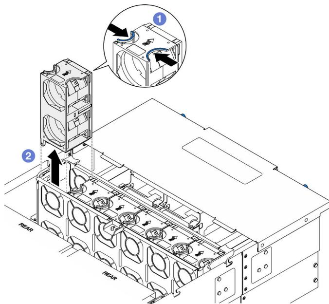
Figura 43. Rimozione del modulo della ventola
