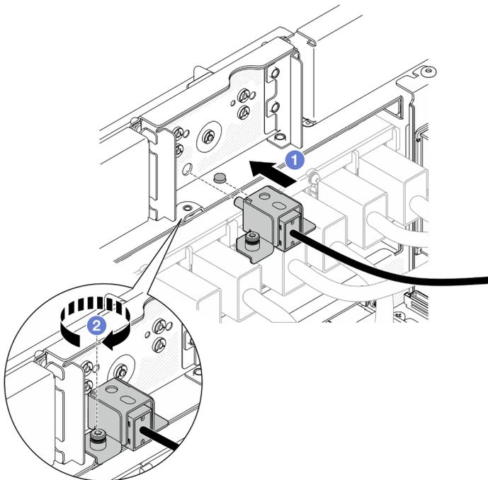
Figura 66. Installazione dell'assieme dello switch di intrusione anteriore
