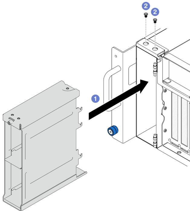
Figura 33. Installazione di un telaio unità da 2,5"
