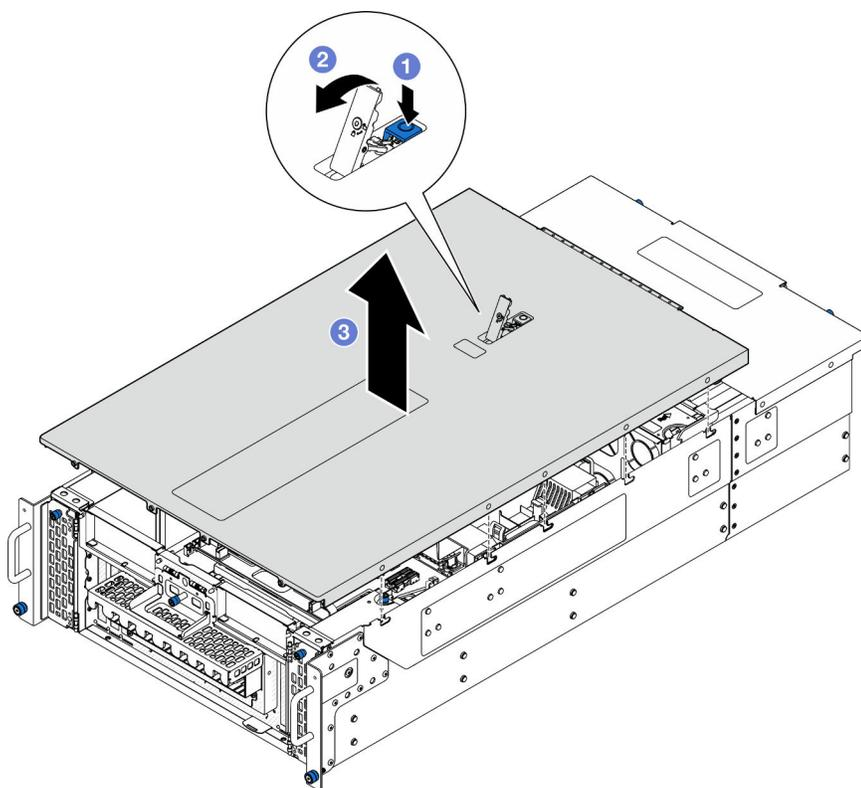
Figura 166. Rimozione del coperchio superiore anteriore
