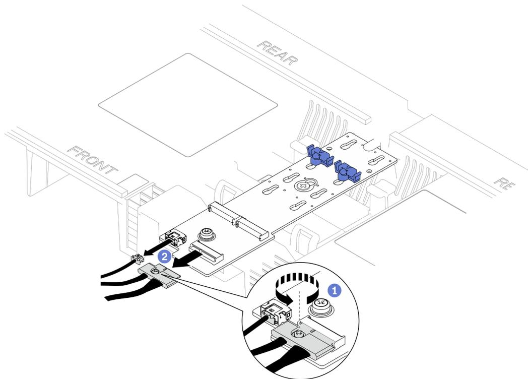
Figura 79. Scollegamento del cavo dall'adattatore di avvio M.2
