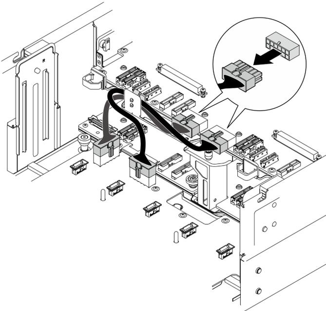
*Figura 180. Scollegamento dei cavi di alimentazione della scheda del processore superiore (CPU BD)*
