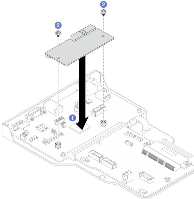
Figura 154. Installazione del modulo firmware e sicurezza RoT
