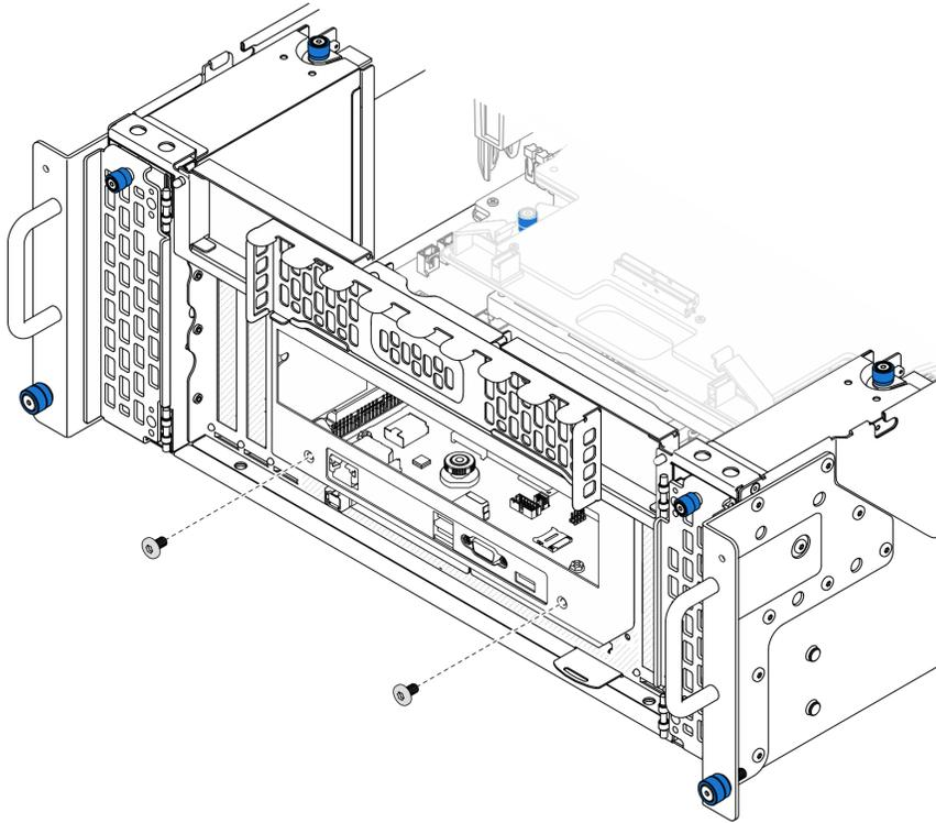
*Figura 156. Allentamento della scheda I/O di sistema e dell'assieme interposer*
