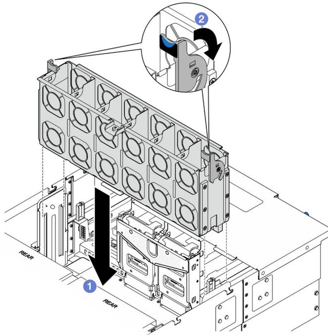
Figura 45. Installazione dell'alloggiamento della ventola
