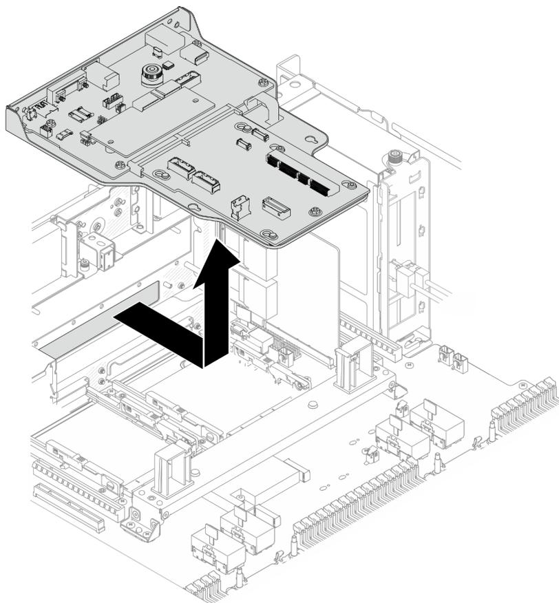
*Figura 157. Rimozione della scheda I/O di sistema e dell'assieme interposer*
