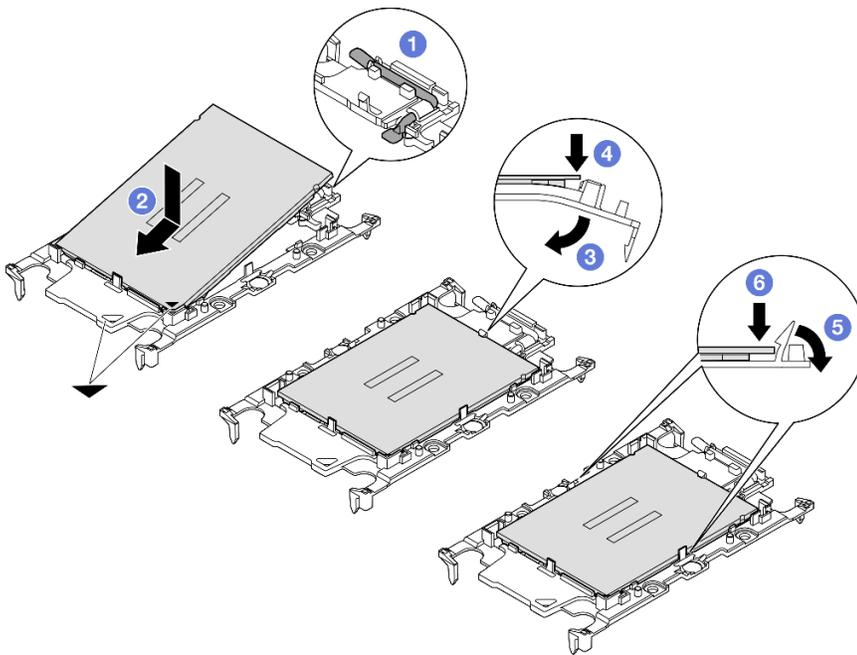
Figura 134. Installazione di una piastra del processore
