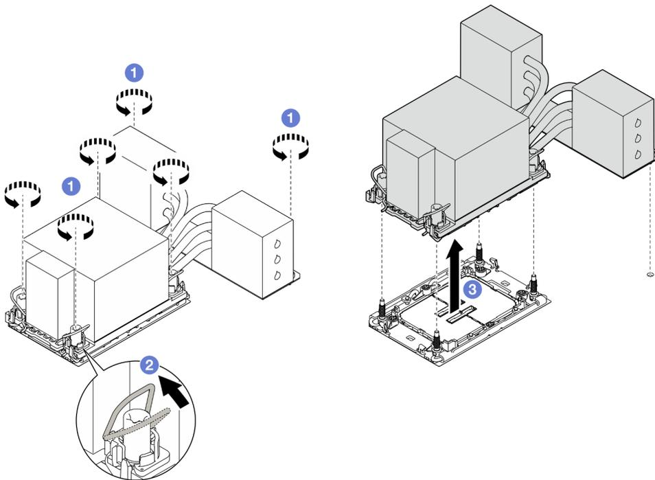
Figura 130. Rimozione di un PHM 3U
