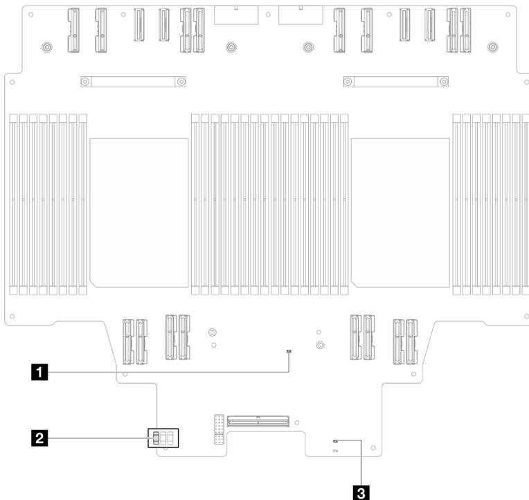
Figura 208. LED della scheda del processore superiore (CPU BD)
