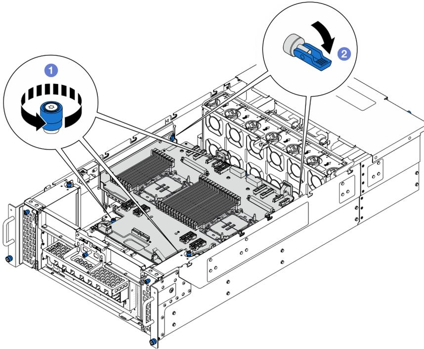
Figura 181. Sganciamento della scheda del processore superiore (CPU BD)
