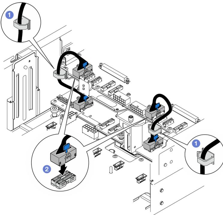
Figura 186. Collegamento dei cavi UPI interni
