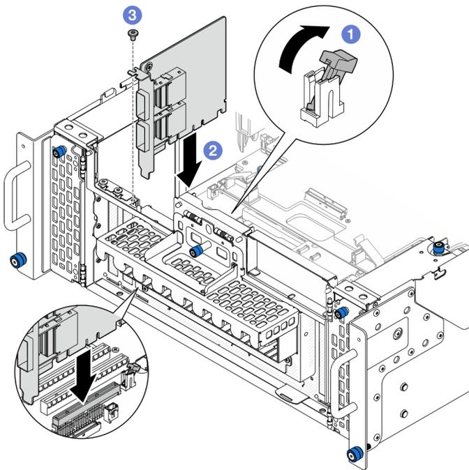
Figura 149. Installazione della scheda laterale
