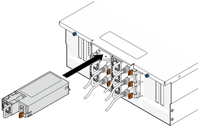
Figura 127. Installazione di un'unità di alimentazione
