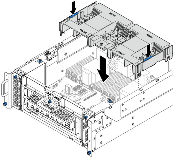
Figura 14. Installazione del deflettore d'aria della scheda del processore inferiore (MB)
