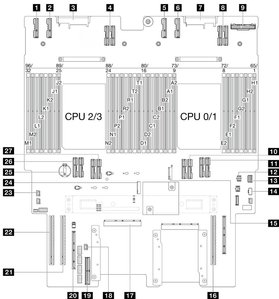
Figura 203. Connettori della scheda del processore inferiore (MB)
