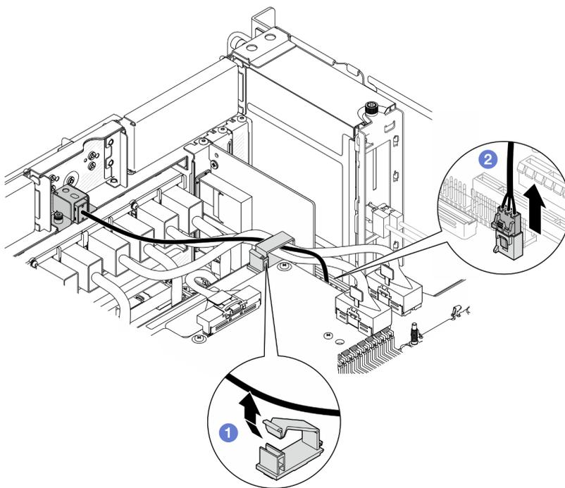
Figura 62. Scollegamento dello switch di intrusione
