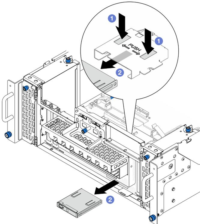
Figura 52. Rimozione del pannello anteriore dell'operatore
