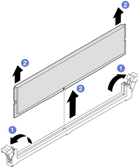
Figura 90. Rimozione del modulo di memoria
