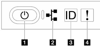
Figura 206. LED del pannello anteriore dell'operatore
