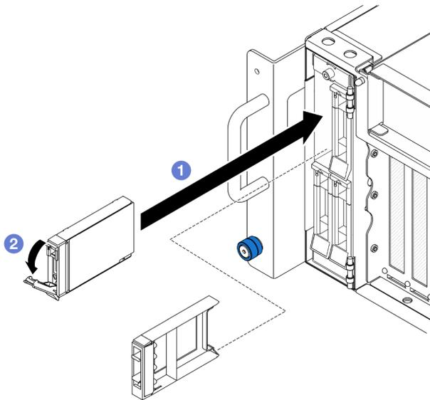
Figura 25. Installazione di un'unità da 2,5"
