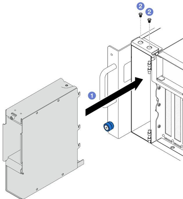
Figura 34. Installazione di un telaio unità E3.S
