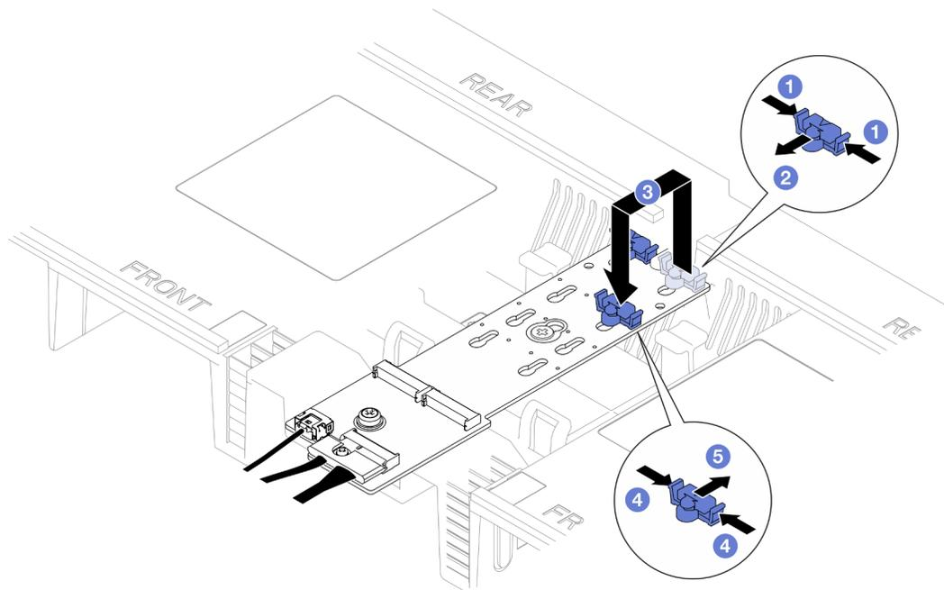
Figura 83. Regolazione del blocco M.2
