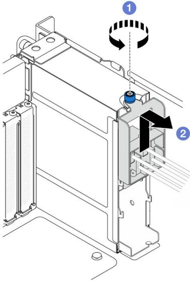
Figura 35. Rimozione dell'assieme del cavo E3.S
