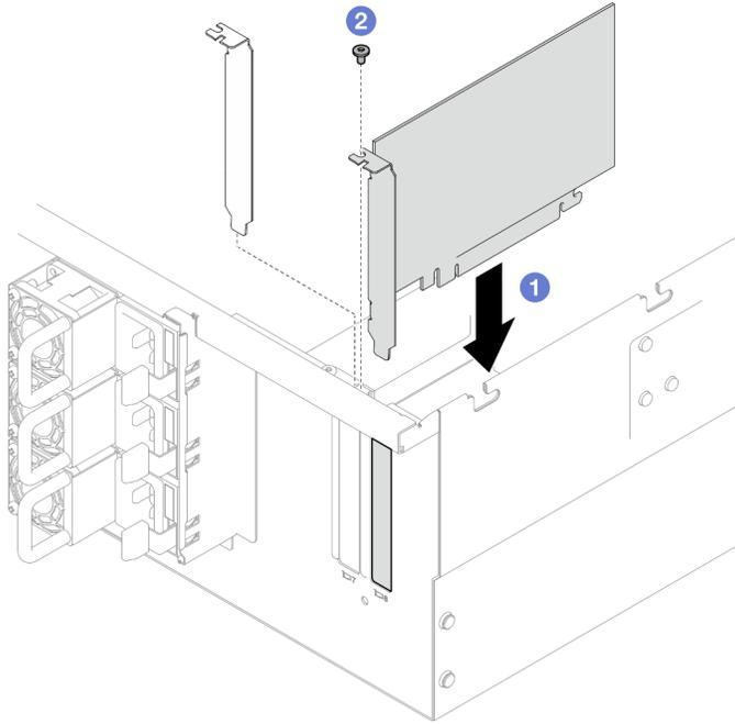
Figura 107. Installazione dell'adattatore PCIe
