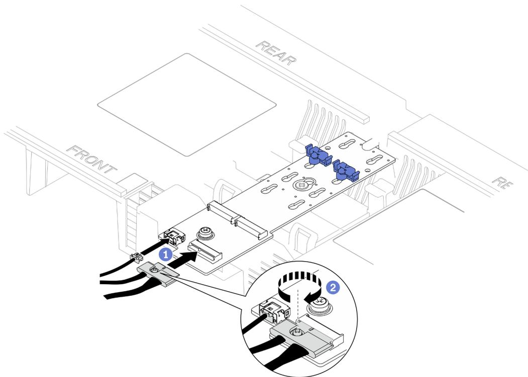
Figura 82. Collegamento del cavo all'adattatore di avvio M.2
