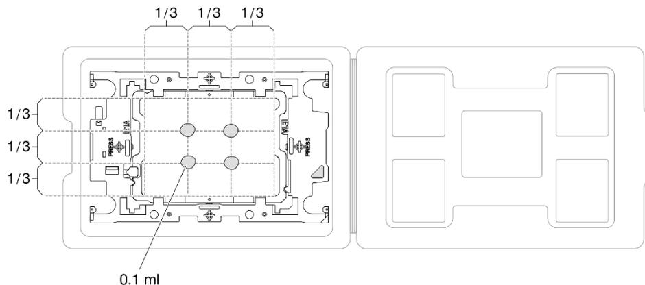
Figura 135. Applicazione del lubrificante termico con il processore nella confezione di spedizione
