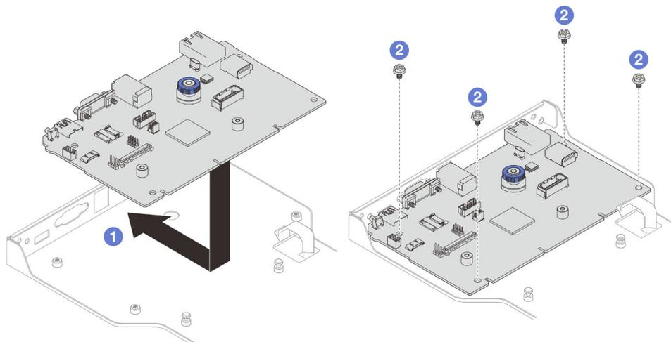
Figura 160. Installazione della scheda I/O di sistema sulla staffa
