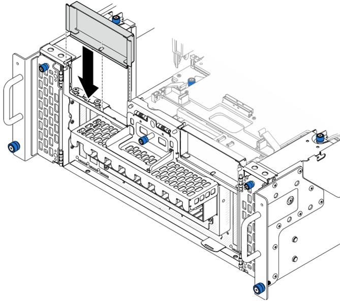
Figura 150. Installazione dell'elemento di riempimento PCIe sinistro
