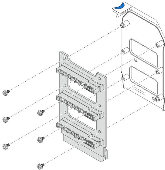
Figura 123. Smontaggio della scheda interposer dell'alimentazione
