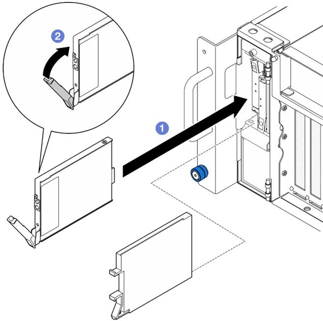
Figura 26. Installazione di un'unità E3.S
