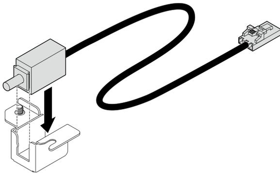
Figura 65. Installazione dello switch di intrusione
