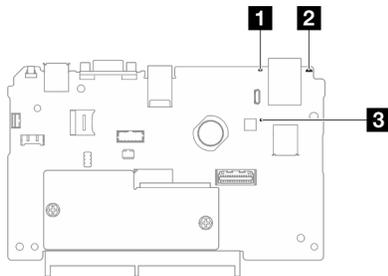
Figura 209. LED della scheda I/O di sistema
