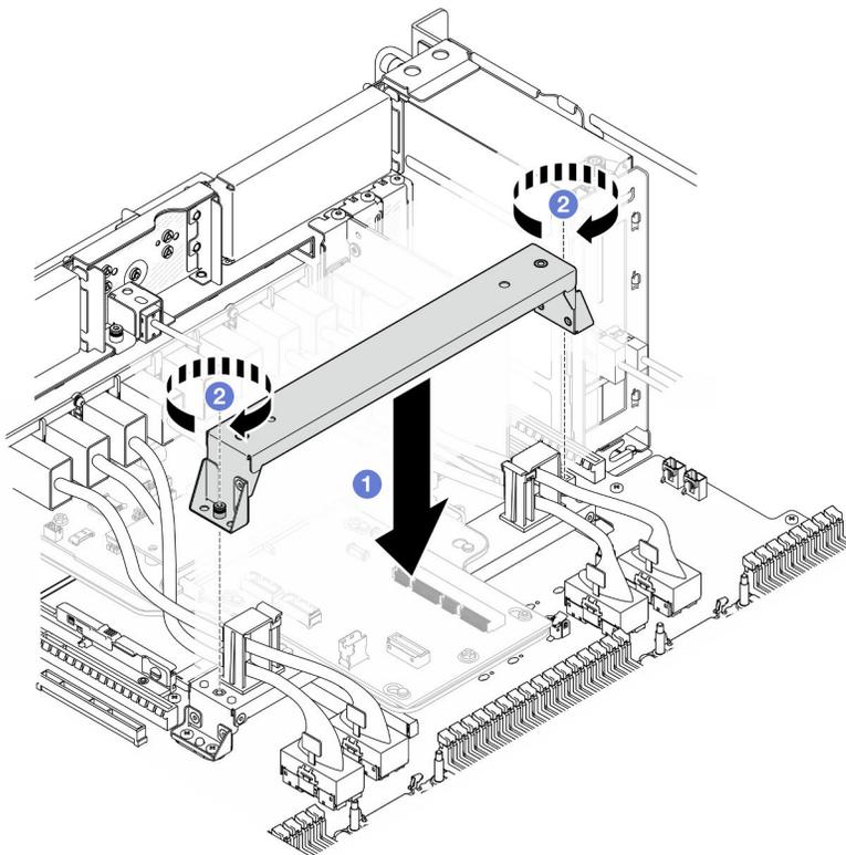
Figura 152. Installazione della staffa di supporto
