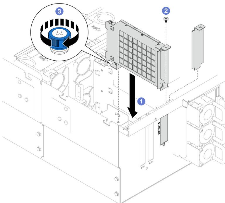
Figura 98. Installazione del telaio del modulo OCP
