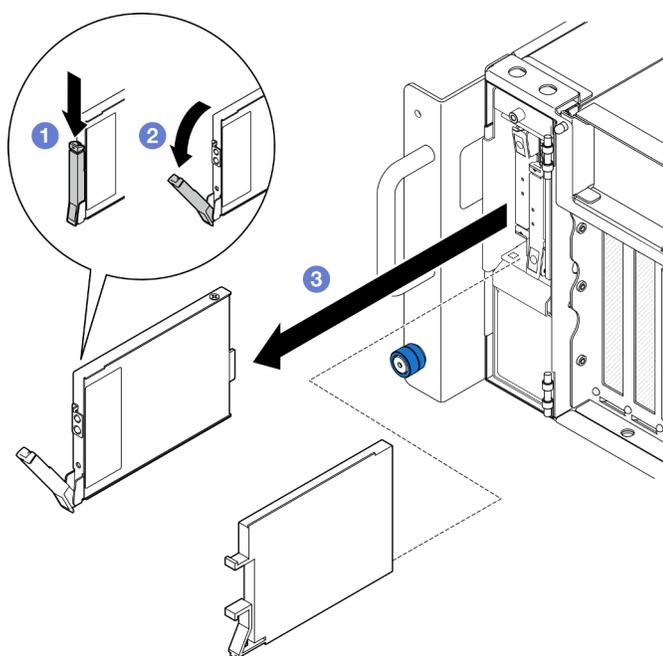
Figura 22. Rimozione di un'unità E3.S
