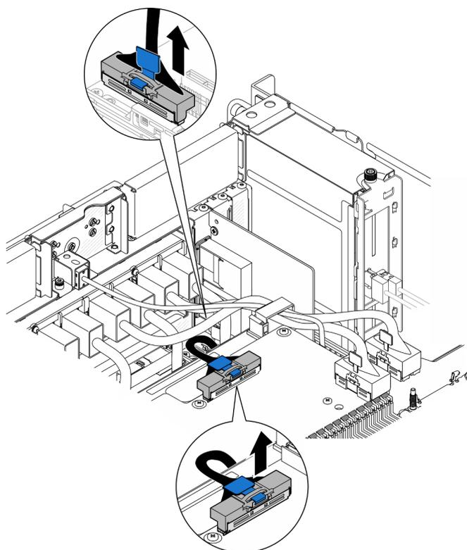
Figura 178. Scollegamento del cavo laterale interno
