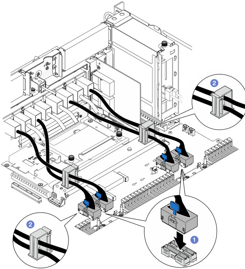
Figura 76. Collegamento dei cavi del modulo UPI
