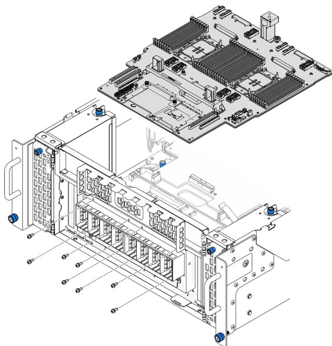
*Figura 175. Installazione delle viti del modulo UPI*
