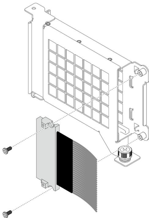
Figura 96. Rimozione del cavo OCP
