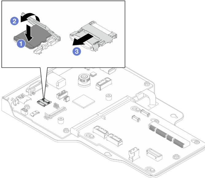
Figura 93. Installazione della scheda MicroSD
