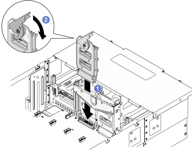
Figura 124. Installazione della scheda interposer dell'alimentazione
