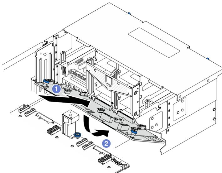
Figura 119. Installazione della scheda di distribuzione dell'alimentazione
