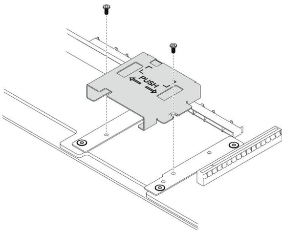
Figura 53. Rimozione del telaio del pannello anteriore dell'operatore
