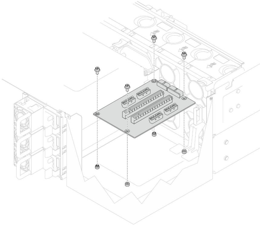
Figura 110. Rimozione della scheda verticale PCIe
