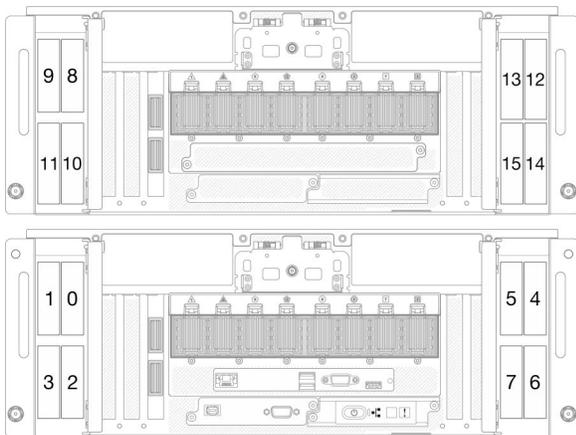
Figura 18. Numerazione del vano dell'unità da 2,5"
