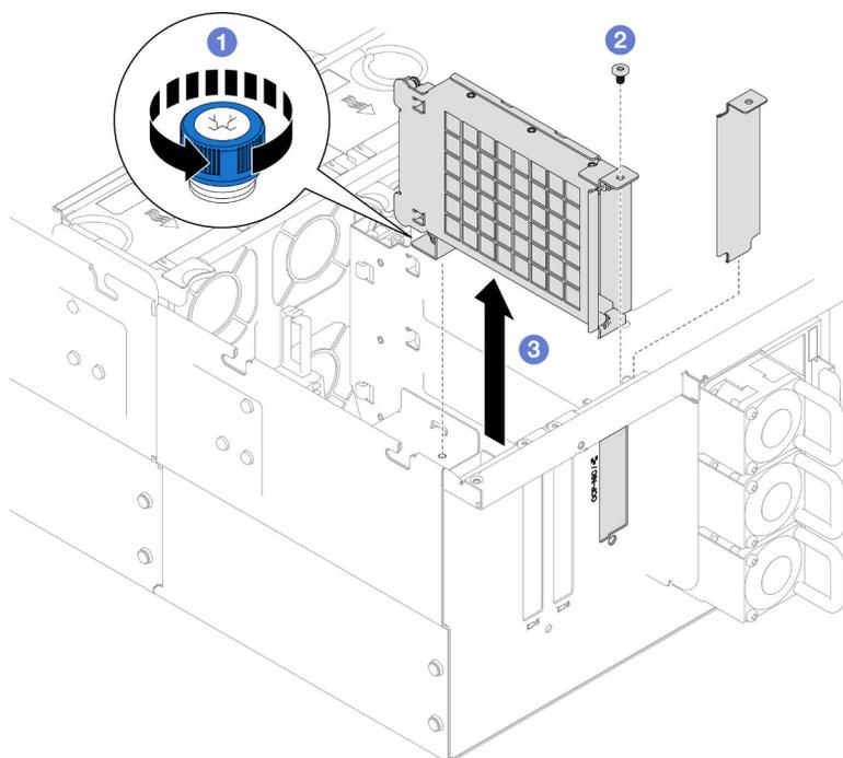
Figura 95. Rimozione del telaio del modulo OCP
