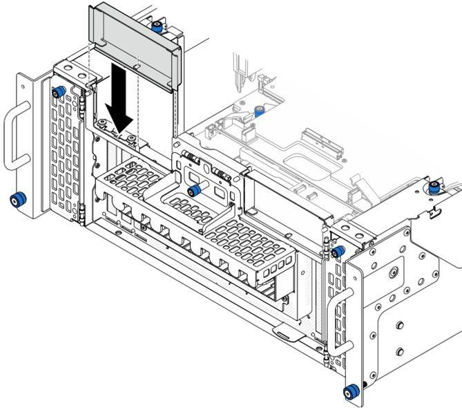
Figura 106. Installazione dell'elemento di riempimento PCIe sinistro
