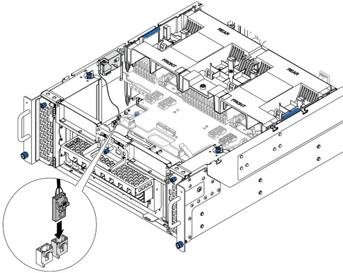
Figura 61. Collegamento dello switch di intrusione
