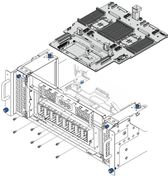
Figura 172. Rimozione delle viti del modulo UPI
