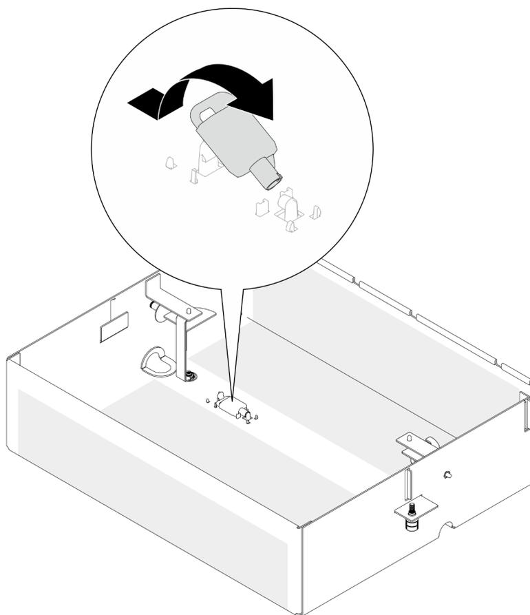
Figura 140. Rimozione della chiave
