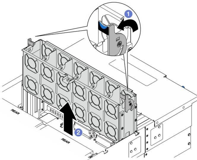
Figura 44. Rimozione dell'alloggiamento della ventola
