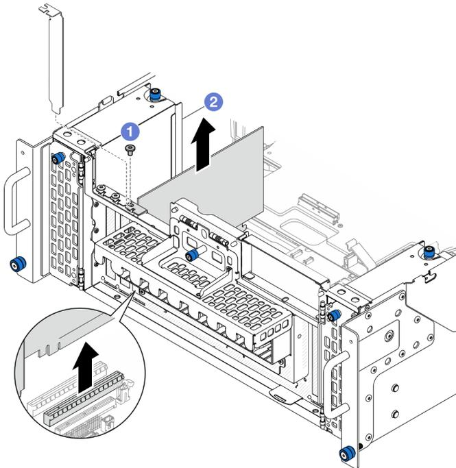
Figura 101. Rimozione dell'adattatore PCIe
