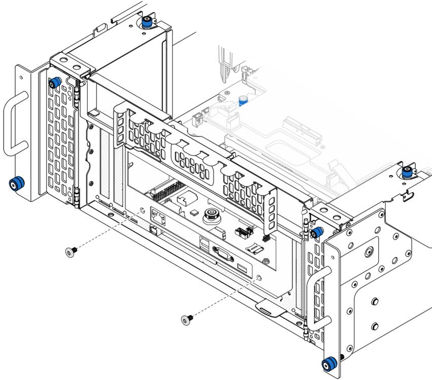
Figura 163. Fissaggio della scheda I/O di sistema e dell'assieme interposer
