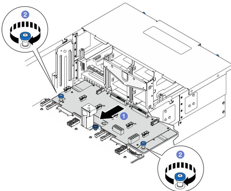
Figura 120. Fissare la scheda di distribuzione dell'alimentazione.
