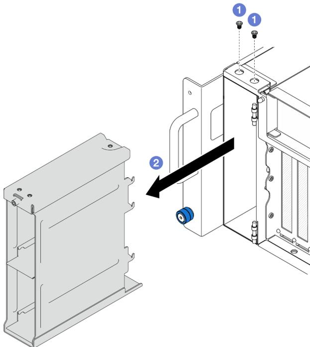
Figura 31. Rimozione di un telaio unità da 2,5"
