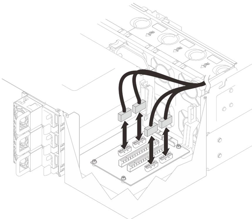
*Figura 109. Scollegamento dei cavi della scheda verticale PCIe*
