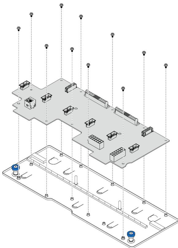
Figura 118. Smontaggio della scheda di distribuzione dell'alimentazione
