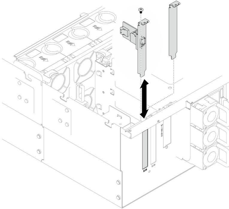
Figura 42. Installazione dell'assieme della porta Ethernet
