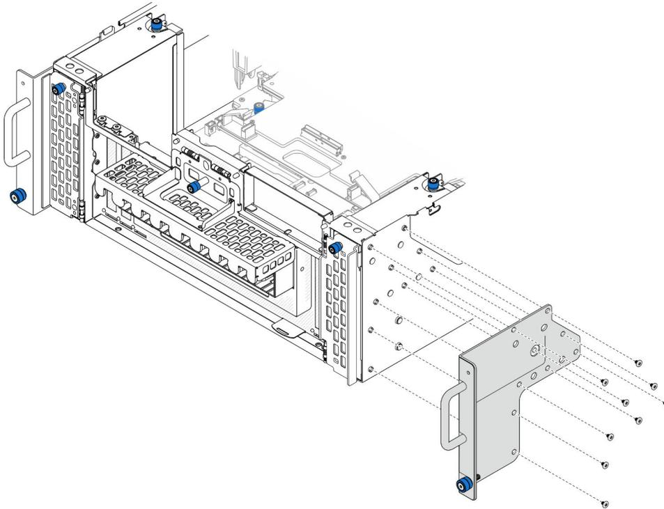
Figura 37. Rimozione della flangia EIA
