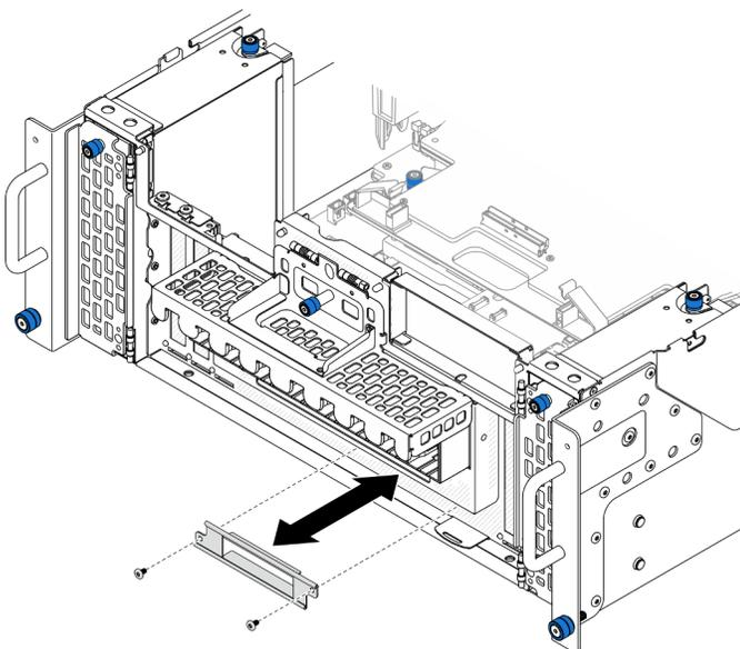
Figura 54. Rimozione della staffa del pannello anteriore dell'operatore
