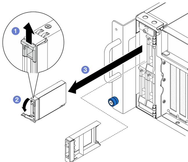
Figura 21. Rimozione di un'unità da 2,5"
