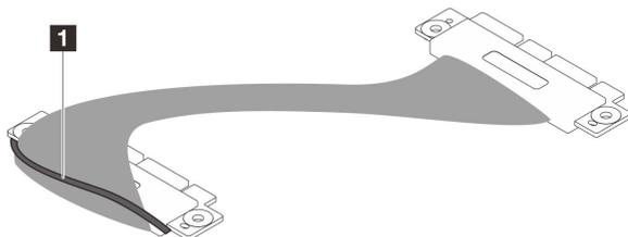
Figura 73. Rimozione dell'imballaggio del cavo SCM
