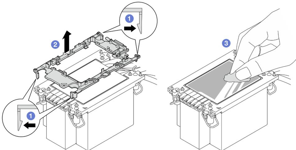
Figura 132. Separazione di una piastra del processore dal dissipatore di calore
