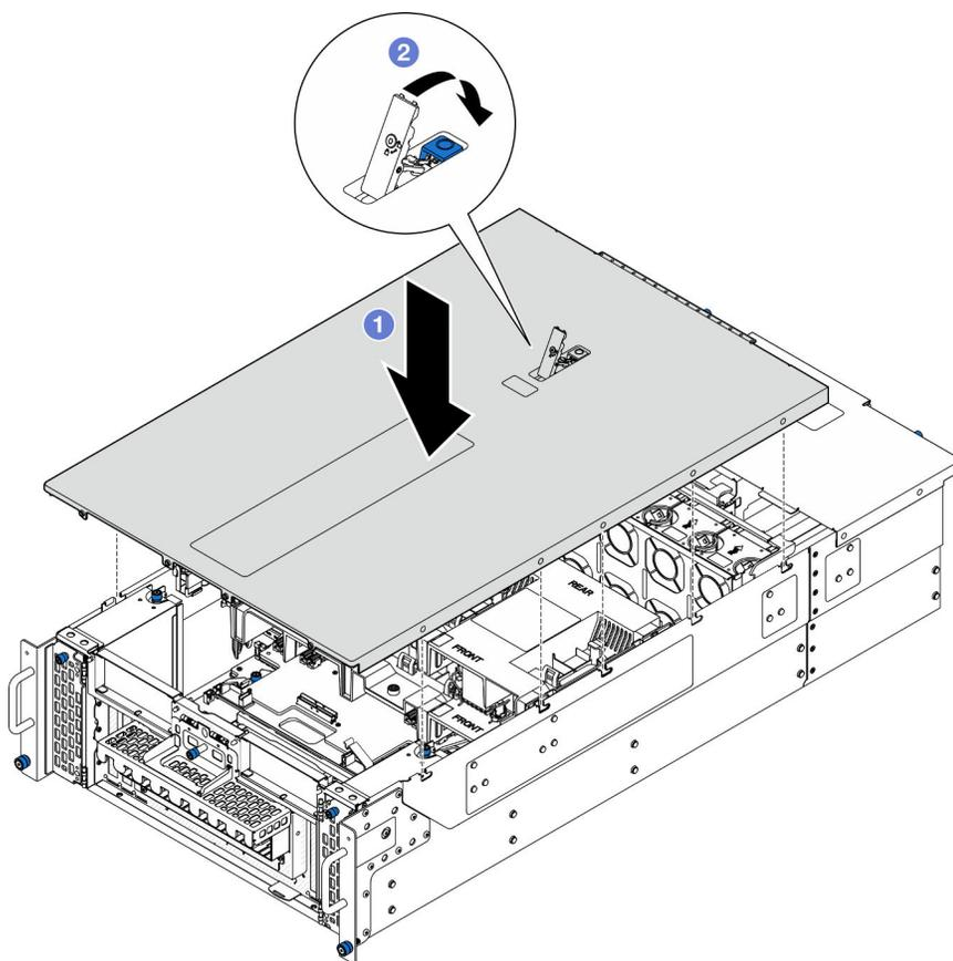
Figura 169. Installazione del coperchio superiore anteriore
