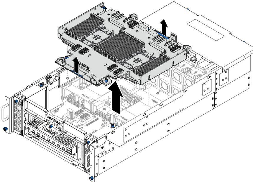
Figura 182. Rimozione della scheda del processore superiore (CPU BD)
