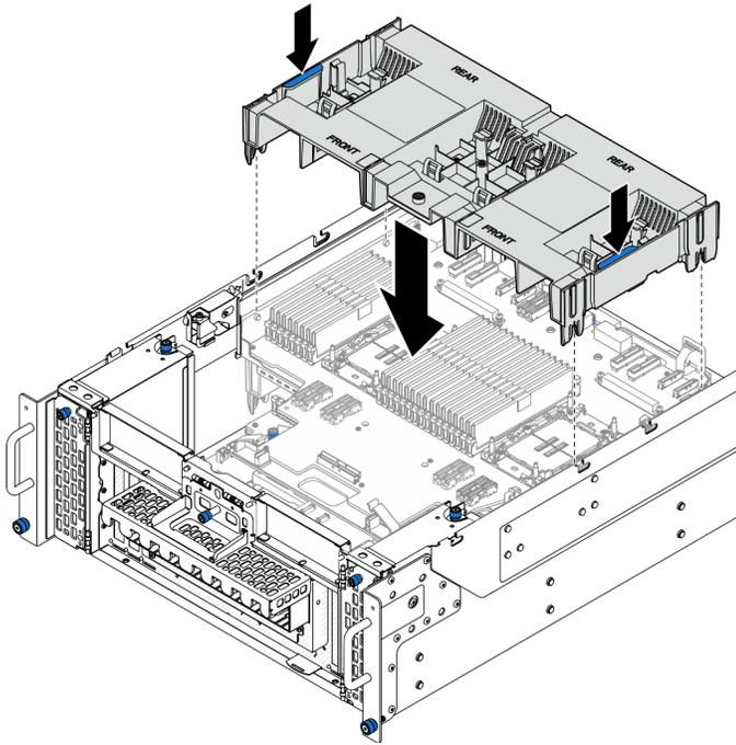
Figura 11. Installazione del deflettore d'aria della scheda del processore superiore (CPU BD)
