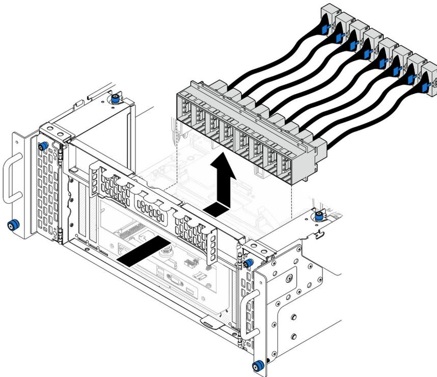
Figura 173. Rimozione del modulo UPI
