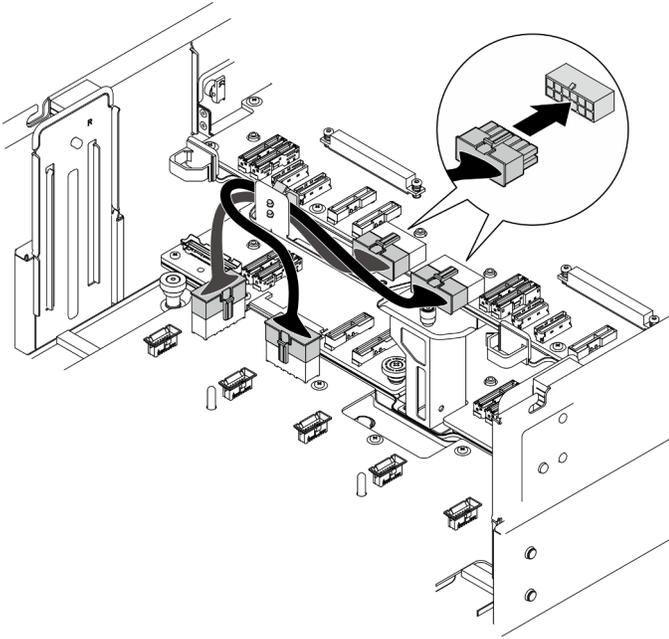
Figura 185. Collegamento dei cavi di alimentazione della scheda del processore superiore (CPU BD)
