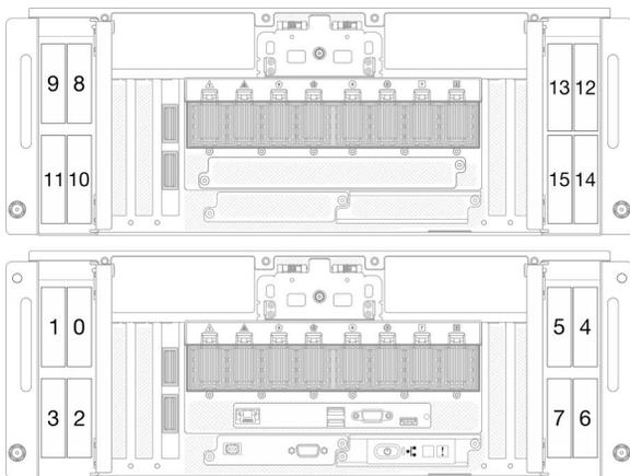
Figura 23. Numerazione del vano dell'unità da 2,5"
