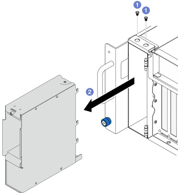
Figura 32. Rimozione del telaio unità E3.S
