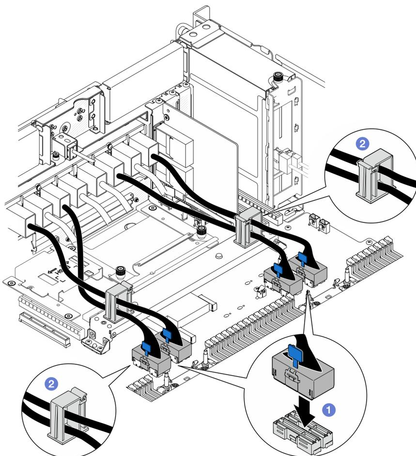
Figura 176. Collegamento dei cavi del modulo UPI
