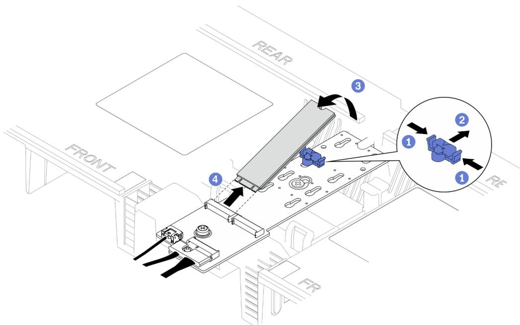
Figura 77. Rimozione dell'unità M.2
