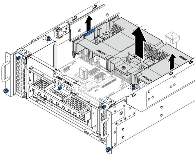
Figura 13. Rimozione del deflettore d'aria della scheda del processore inferiore (MB)
