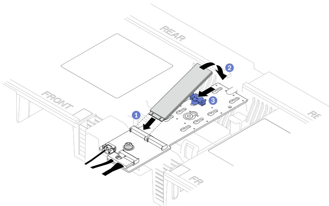
Figura 87. Installazione dell'unità M.2
