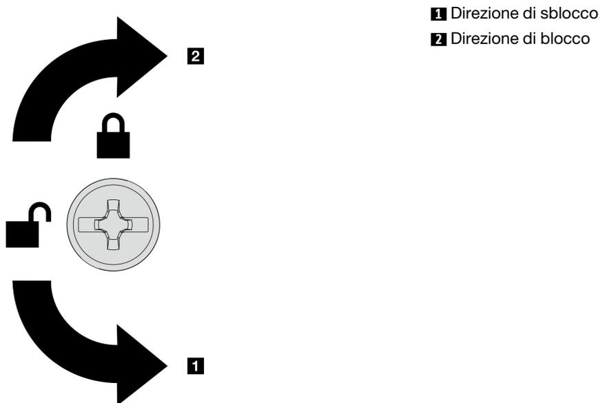
*Figura 165. Direzione di blocco/sblocco del coperchio superiore anteriore*
