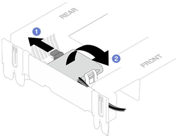
Figura 49. Rimozione del modulo di alimentazione flash
