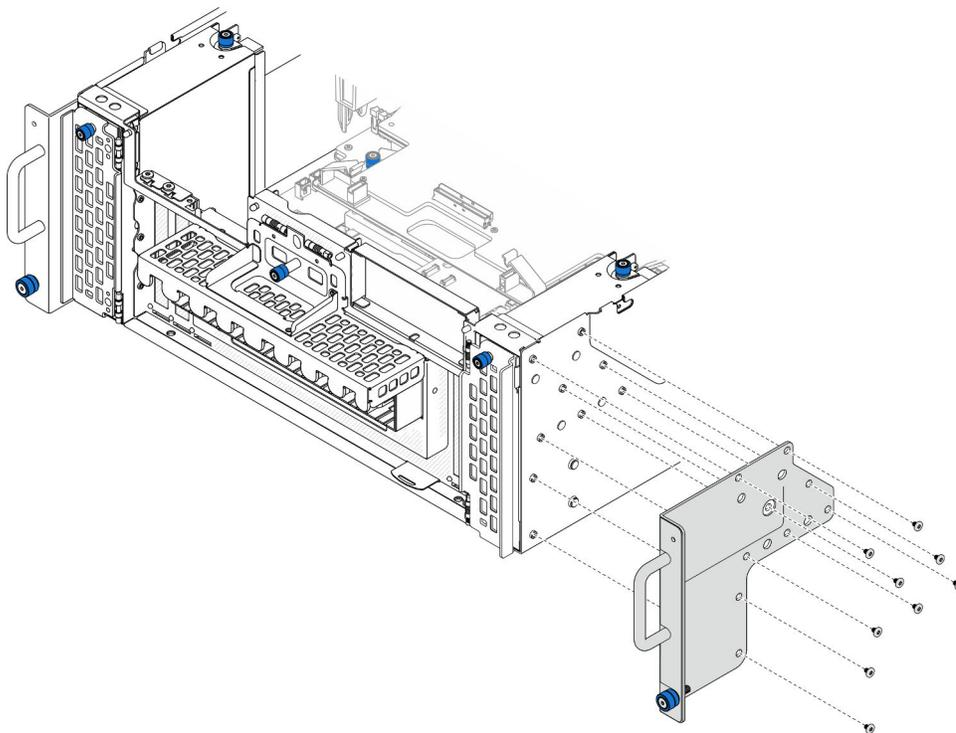
Figura 38. Installazione della flangia EIA
