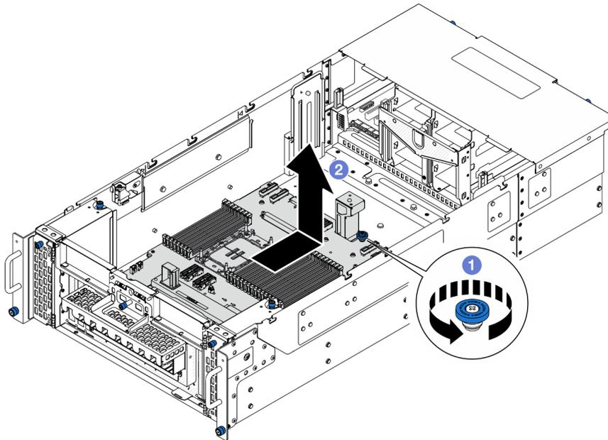
Figura 71. Rimozione della scheda del processore inferiore (MB)
