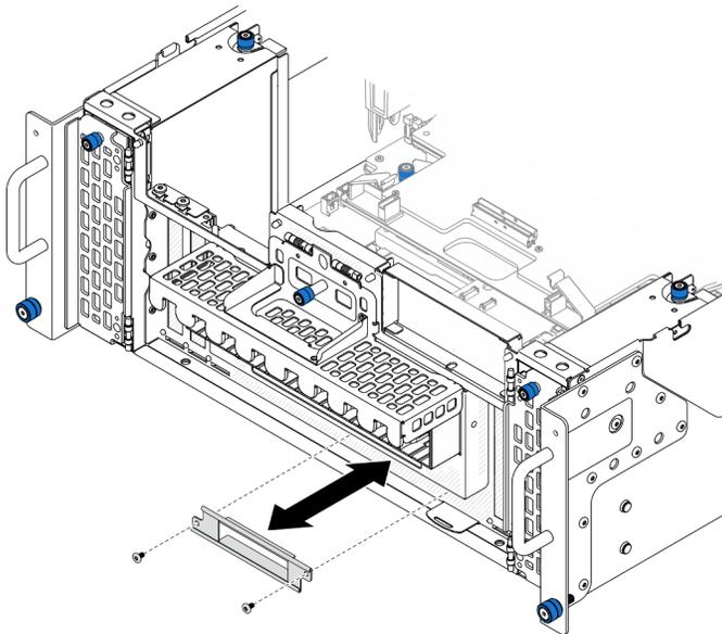
Figura 55. Installazione della staffa del pannello anteriore dell'operatore
