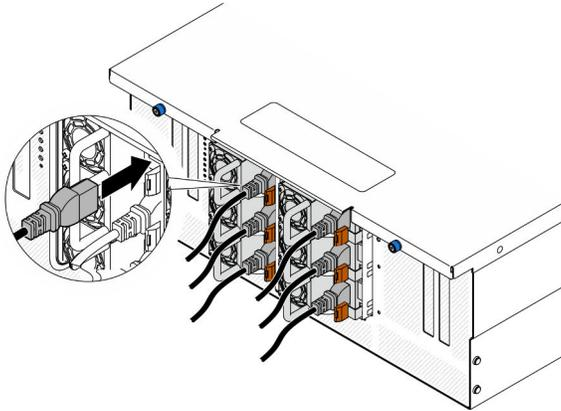
Figura 128. Collegamento del cavo di alimentazione
