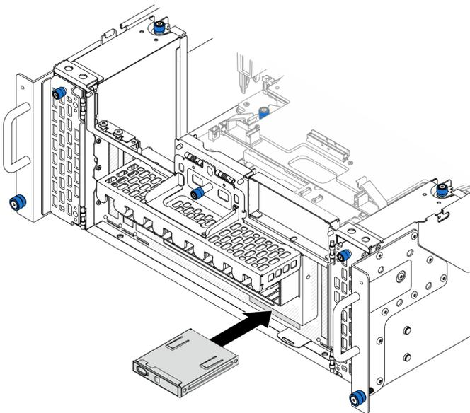
Figura 57. Installazione del pannello anteriore dell'operatore
