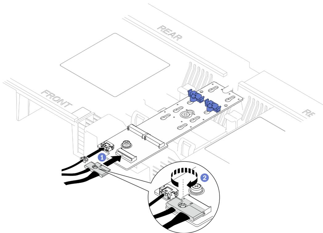
Figura 12. Collegamento del cavo all'adattatore di avvio M.2
