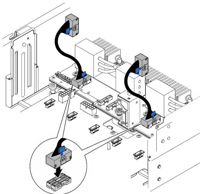
Figura 75. Collegamento dei cavi UPI interni
