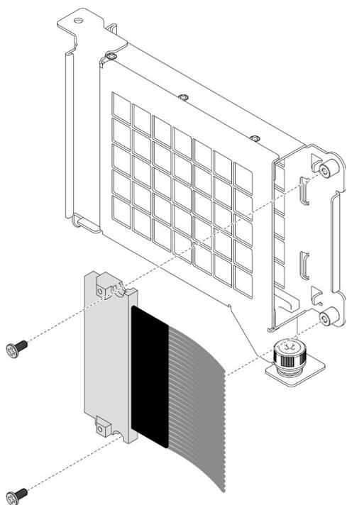
Figura 97. Installazione del cavo OCP
