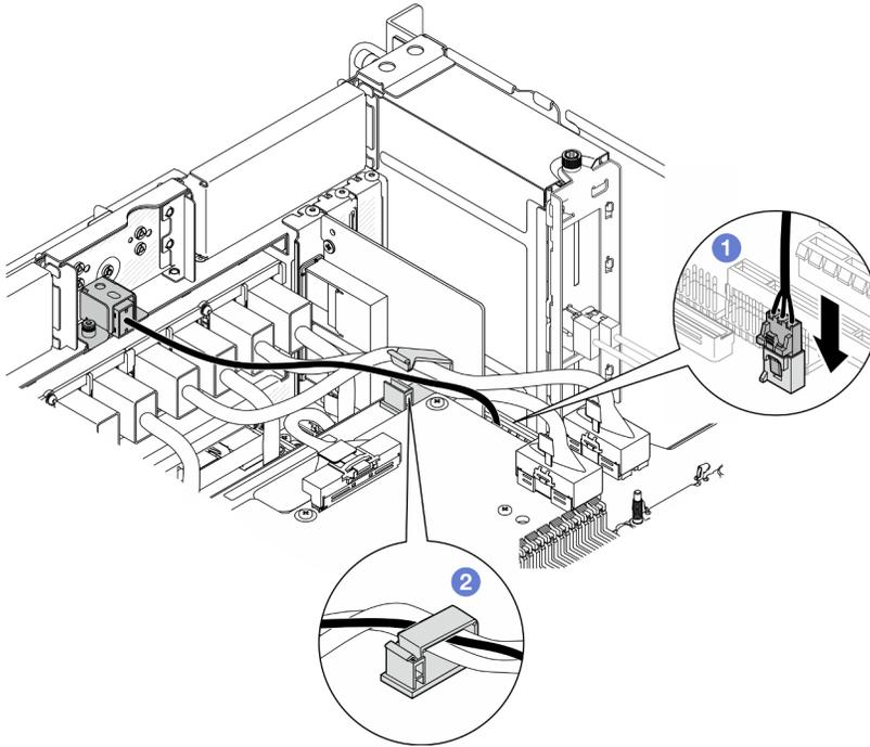
Figura 67. Collegamento dello switch di intrusione
