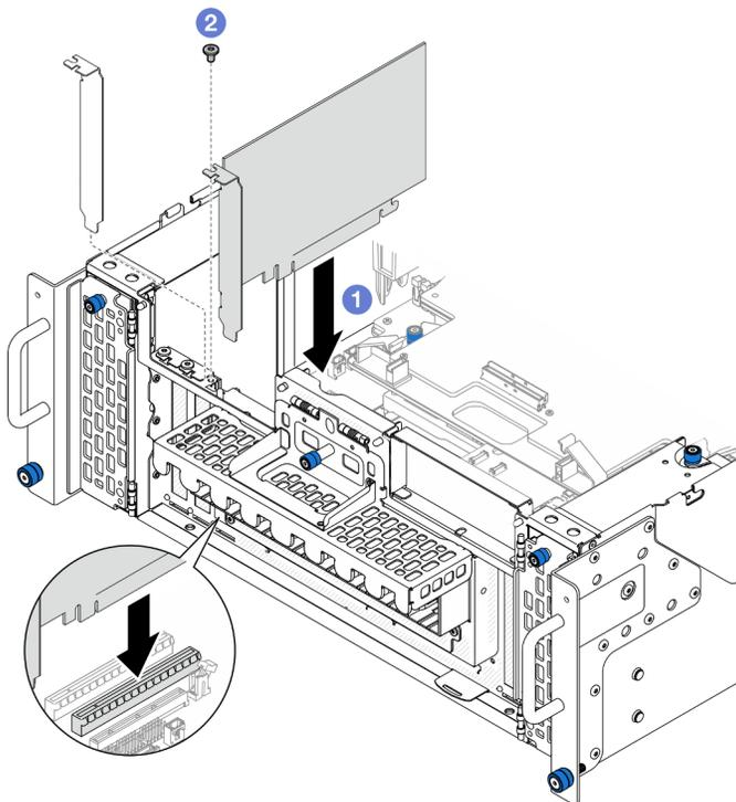
Figura 105. Installazione dell'adattatore PCIe
