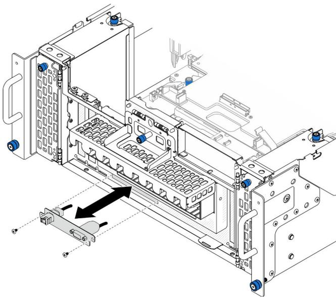
Figura 143. Rimozione dell'assieme della porta seriale
