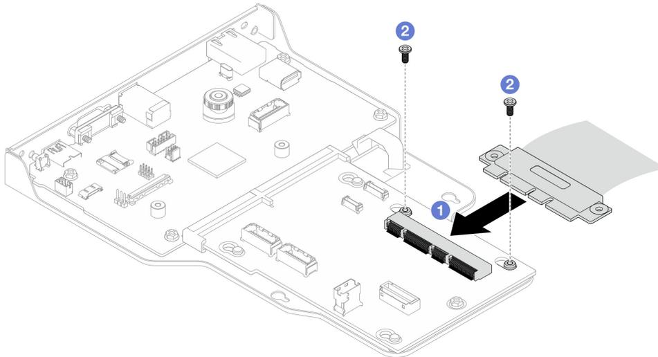
Figura 164. Collegamento del cavo SCM
