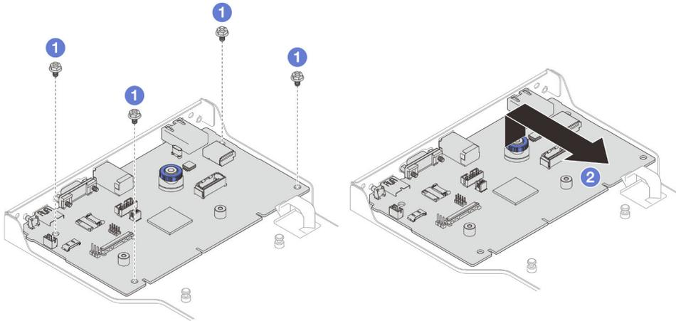
Figura 159. Rimozione della scheda I/O di sistema dalla staffa
