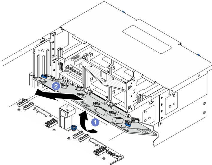
Figura 117. Rimozione della scheda di distribuzione dell'alimentazione
