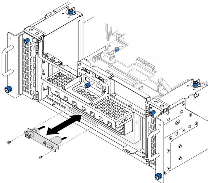
Figura 144. Installazione dell'assieme della porta seriale
