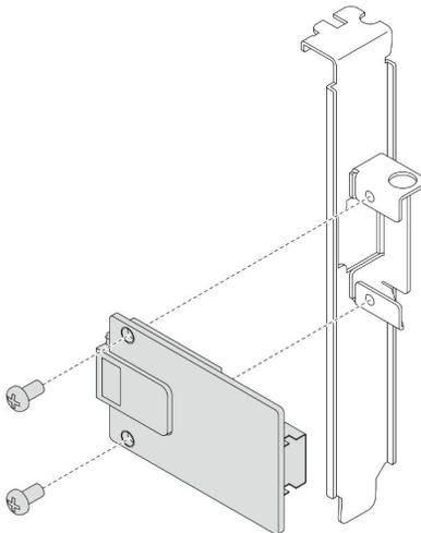
Figura 41. Installazione della scheda della porta Ethernet
