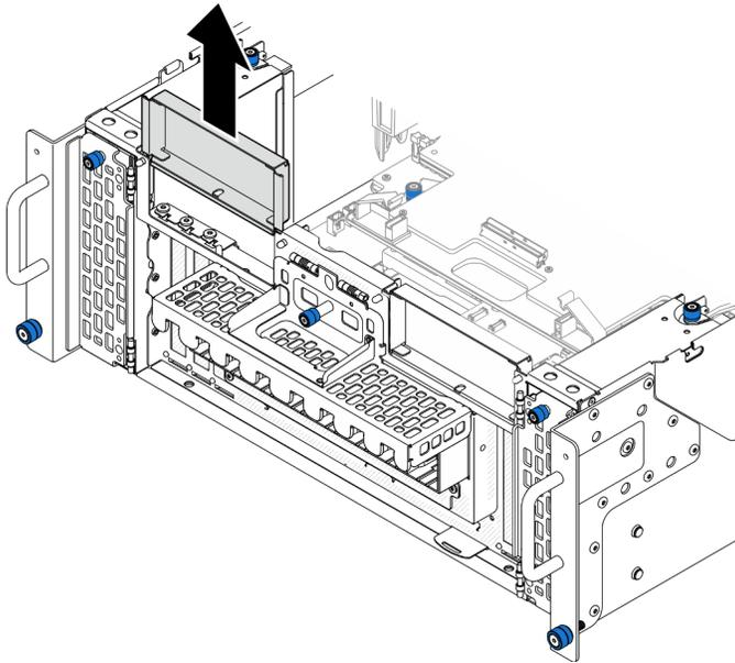
*Figura 145. Rimozione dell'elemento di riempimento PCIe sinistro*
