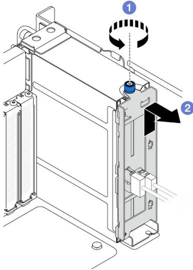
Figura 28. Rimozione del backplane dell'unità da 2,5"
