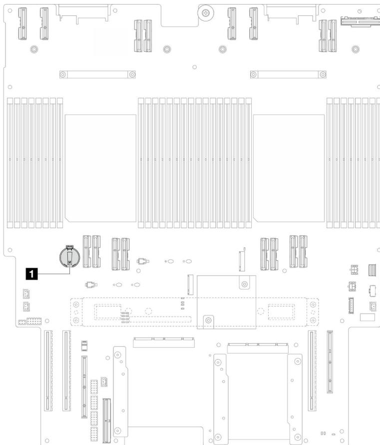
Figura 16. Posizione della batteria CMOS
