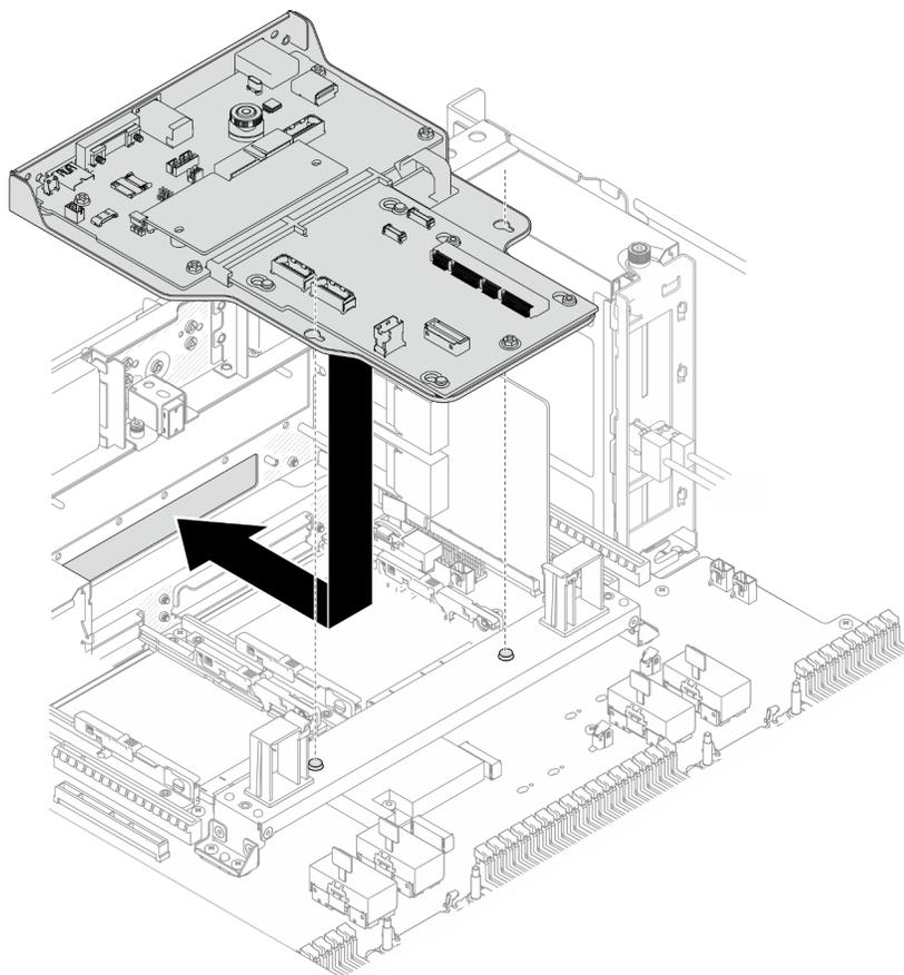
*Figura 162. Installazione della scheda I/O di sistema e dell'assieme interposer*
