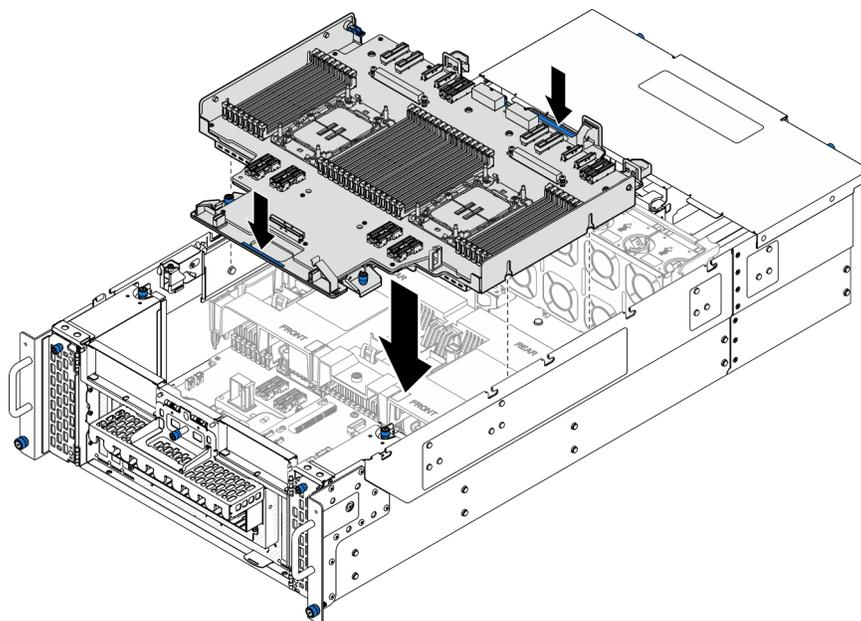
Figura 183. Installazione della scheda del processore superiore (CPU BD)
