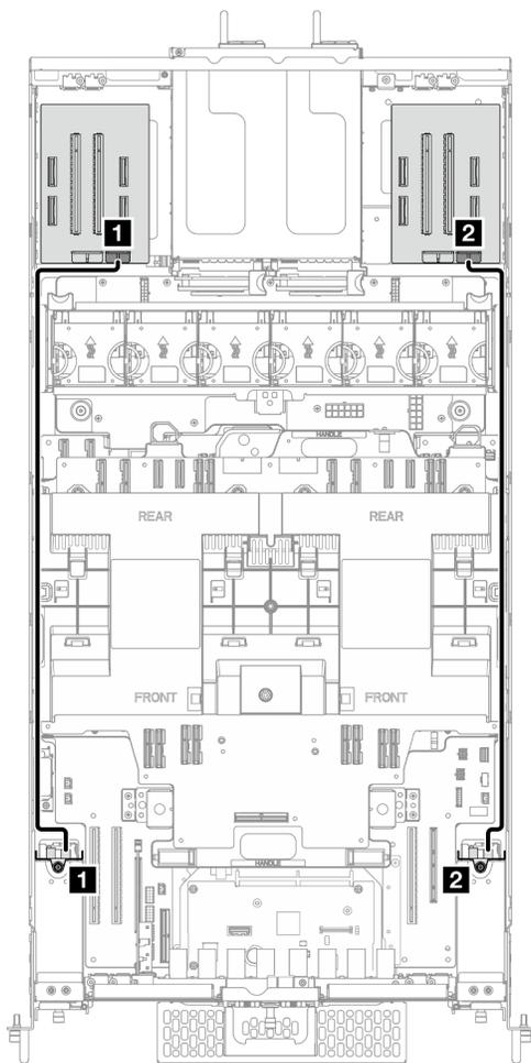
Figura 194. Instradamento dei cavi di alimentazione per i backplane dell'unità da 2,5"
