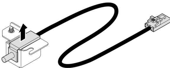
Figura 64. Rimozione dello switch di intrusione
