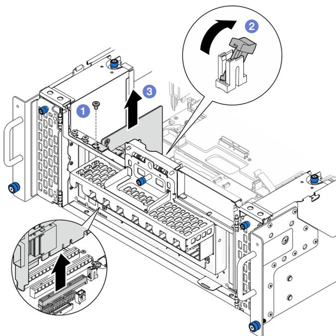
Figura 146. Rimozione della scheda laterale
