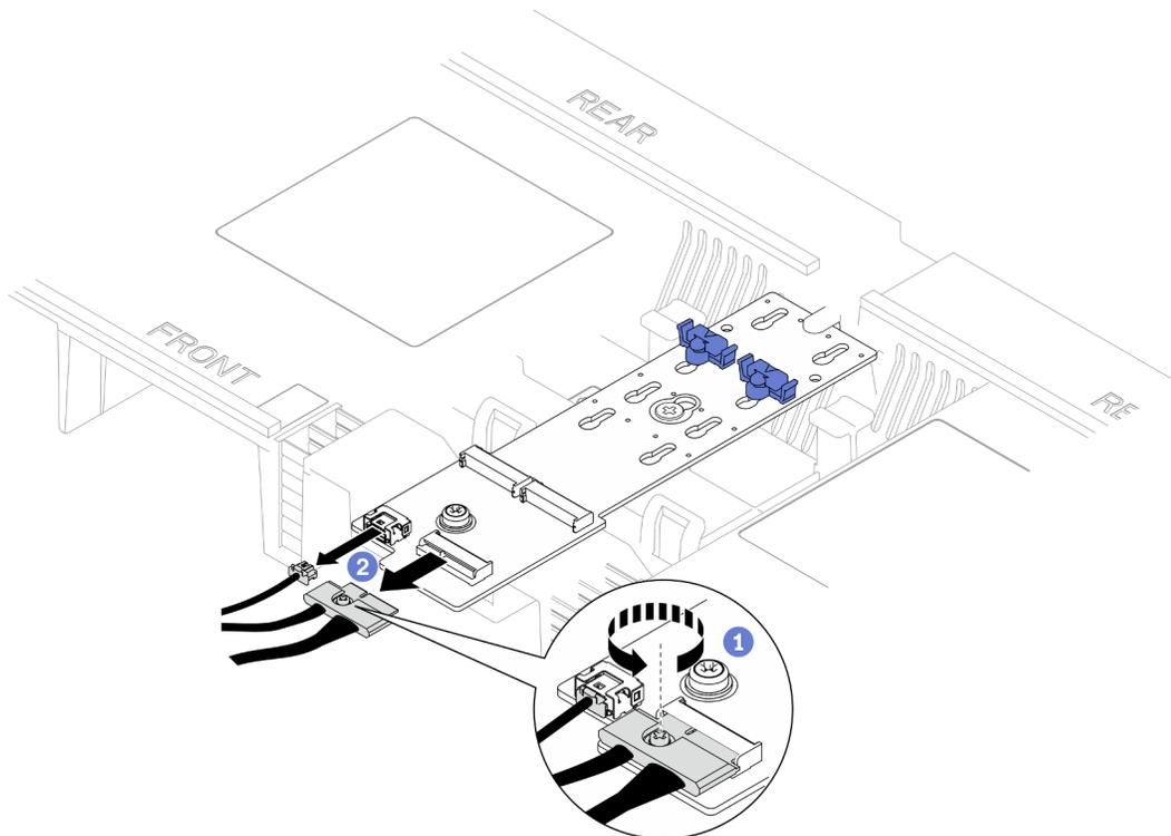
Figura 9. Scollegamento del cavo dall'adattatore di avvio M.2
