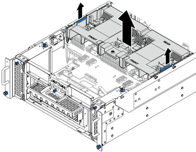
Figura 10. Rimozione del deflettore d'aria della scheda del processore superiore (CPU BD)
