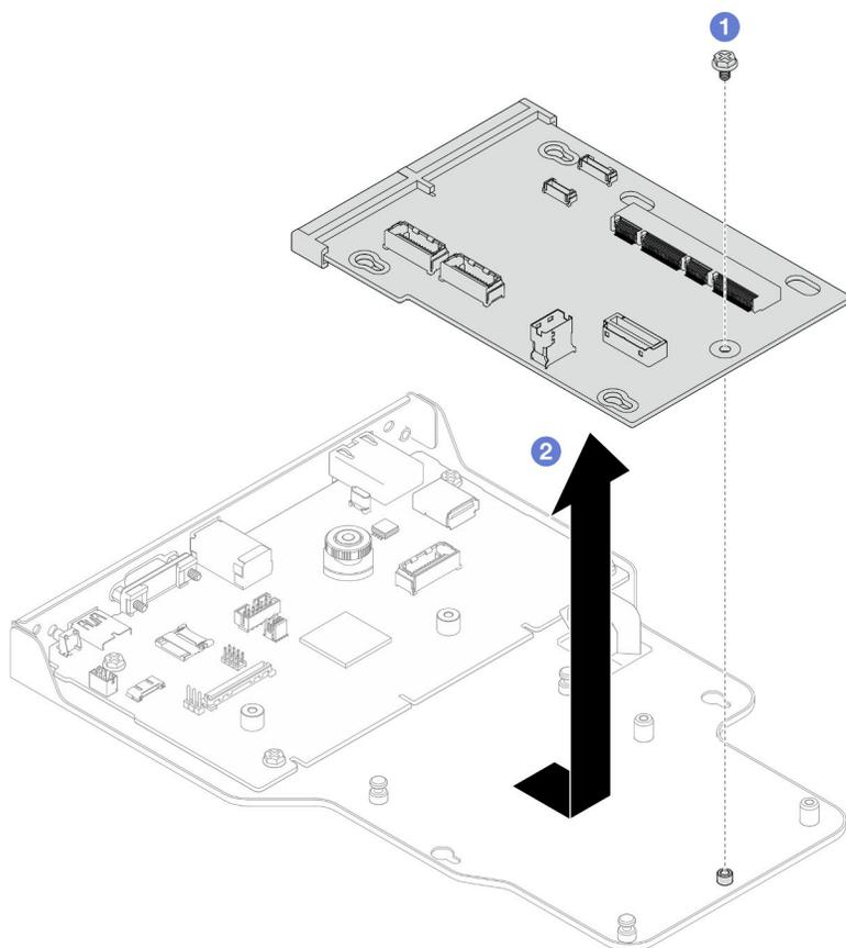
Figura 158. Rimozione della scheda interposer
