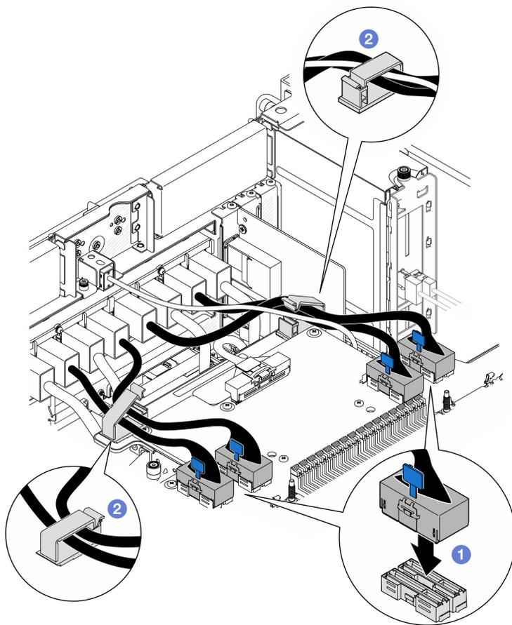
Figura 188. Collegamento dei cavi del modulo UPI
