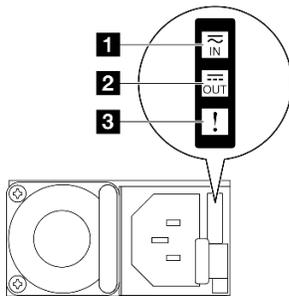
Figura 207. LED dell'alimentatore
