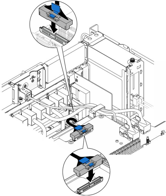
Figura 187. Collegamento del cavo laterale interno
