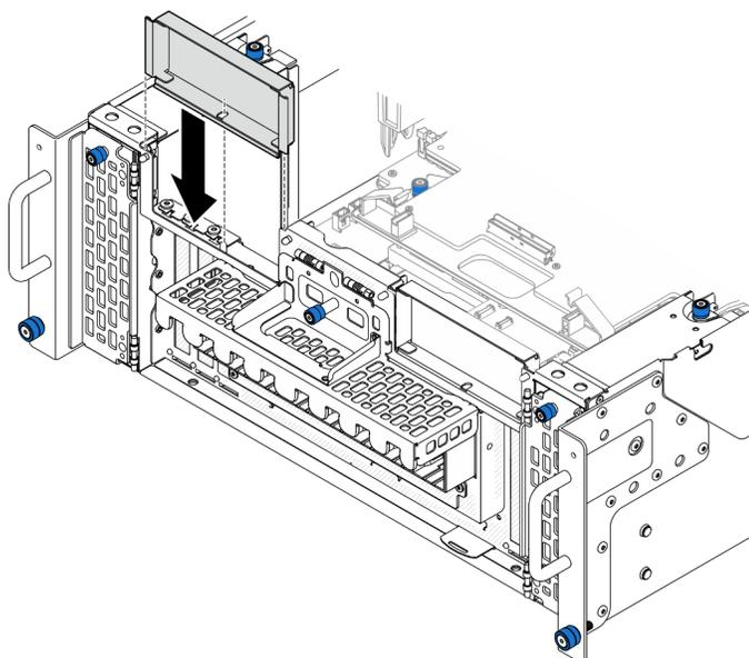
Figura 147. Installazione dell'elemento di riempimento PCIe sinistro
