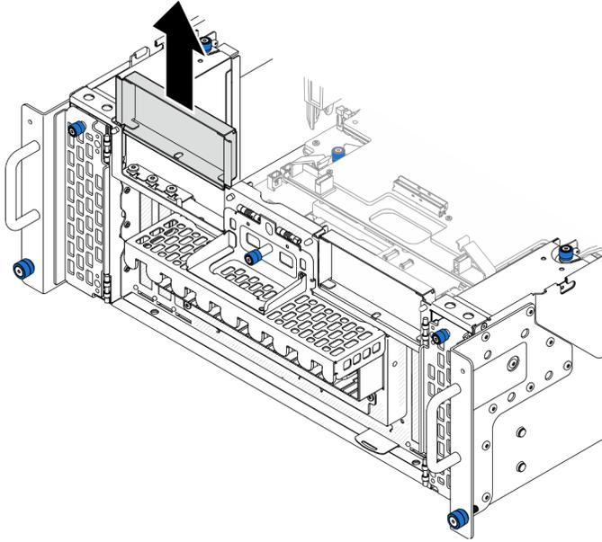
Figura 100. Rimozione dell'elemento di riempimento PCIe sinistro
