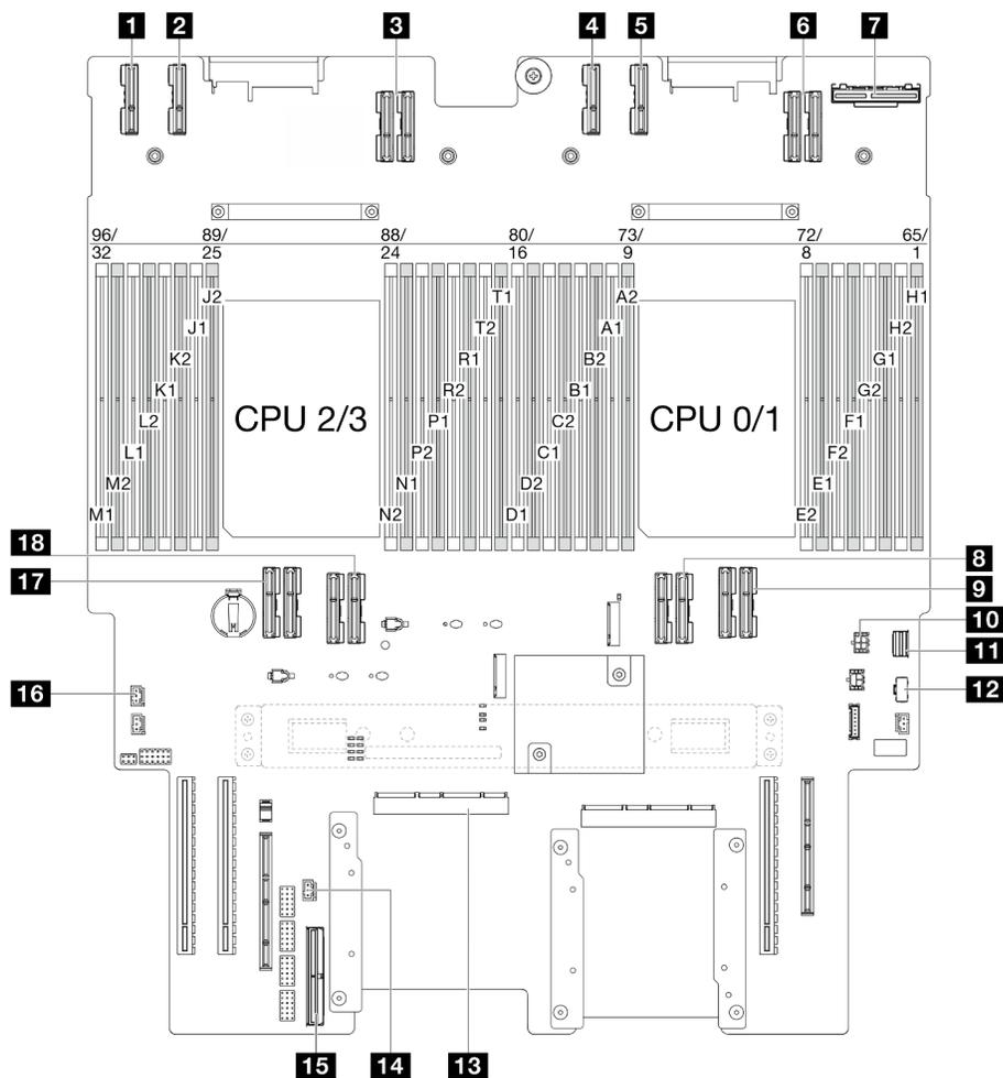
Figura 192. Connettori della scheda del processore inferiore (MB)
