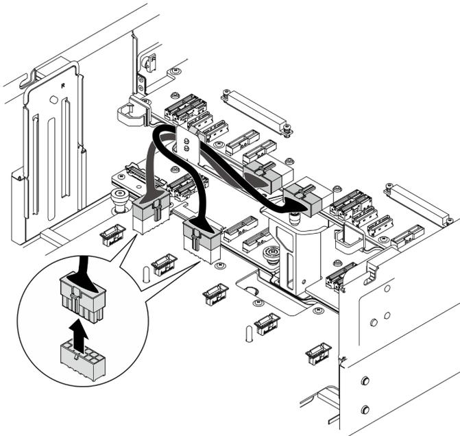
Figura 115. Scollegamento dei cavi della scheda di distribuzione dell'alimentazione
