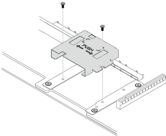
Figura 56. Installazione del telaio del pannello anteriore dell'operatore
