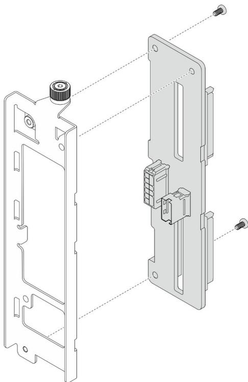
Figura 29. Smontaggio del backplane dell'unità
