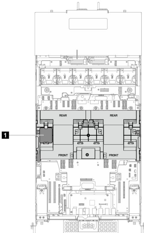
Figura 47. Posizione del modulo di alimentazione flash
