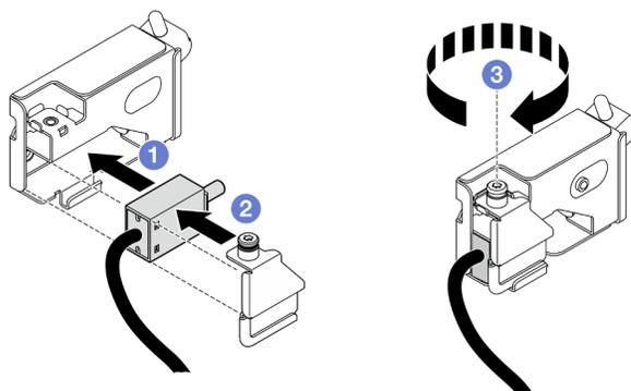
Figura 60. Installazione dello switch di intrusione del coperchio superiore
