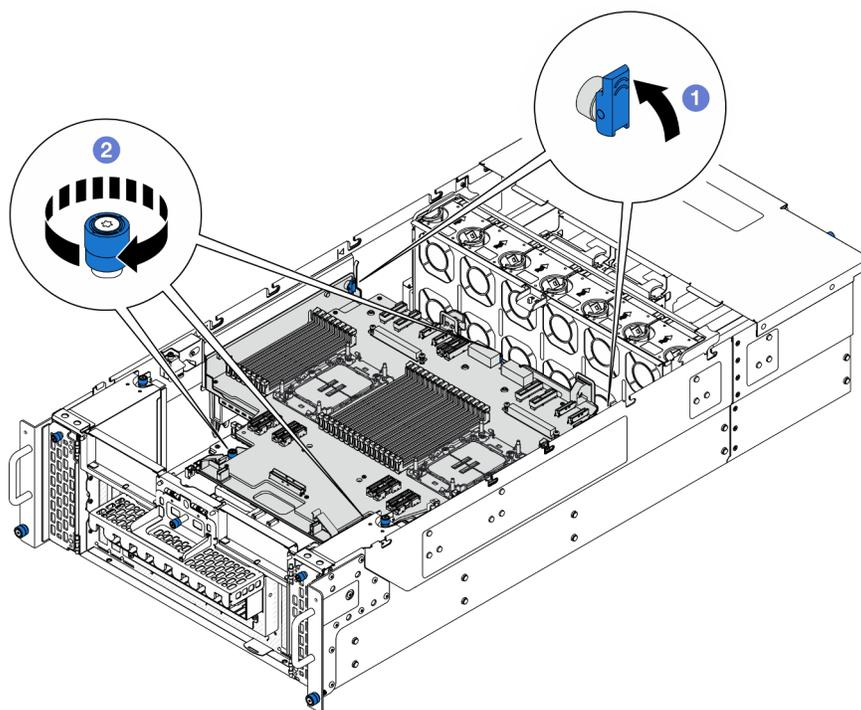
Figura 184. Fissaggio della scheda del processore superiore (CPU BD)
