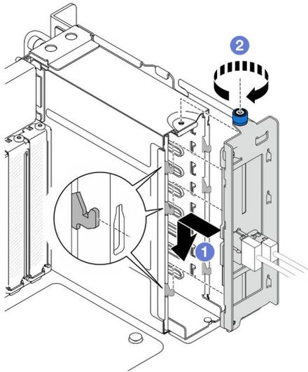
Figura 30. Installazione del backplane dell'unità da 2,5"
