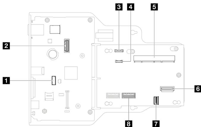
Figura 191. Connettori della scheda I/O di sistema e dell'assieme interposer
