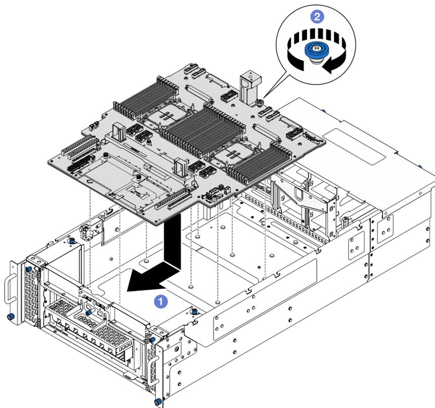
Figura 72. Installazione della scheda del processore inferiore (MB)
