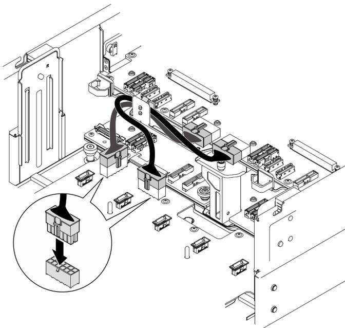
Figura 121. Collegamento dei cavi della scheda di distribuzione dell'alimentazione
