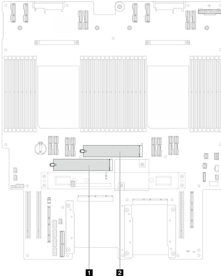
Figura 88. Slot dell'unità M.2
