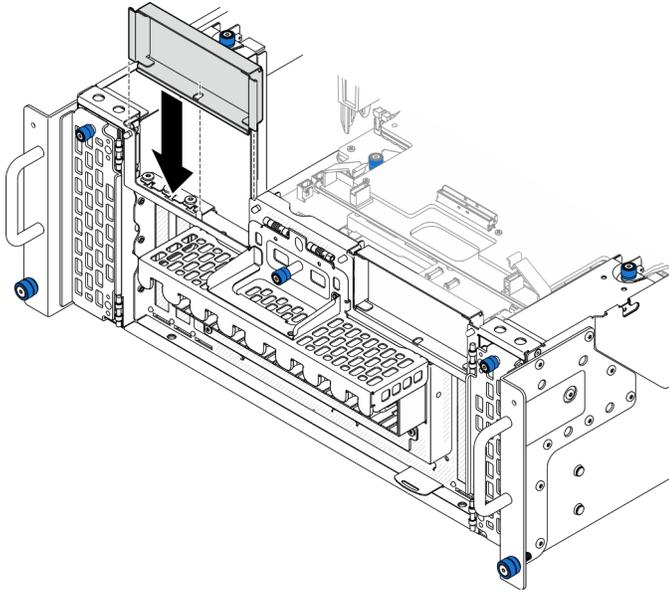
Figura 102. Installazione dell'elemento di riempimento PCIe sinistro
