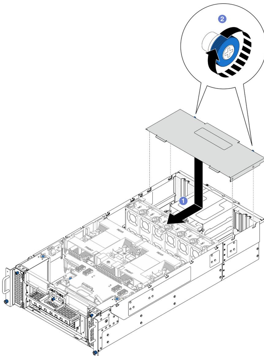
Figura 168. Installazione del coperchio superiore posteriore
