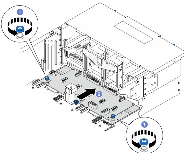
Figura 116. Sganciamento della scheda di distribuzione dell'alimentazione
