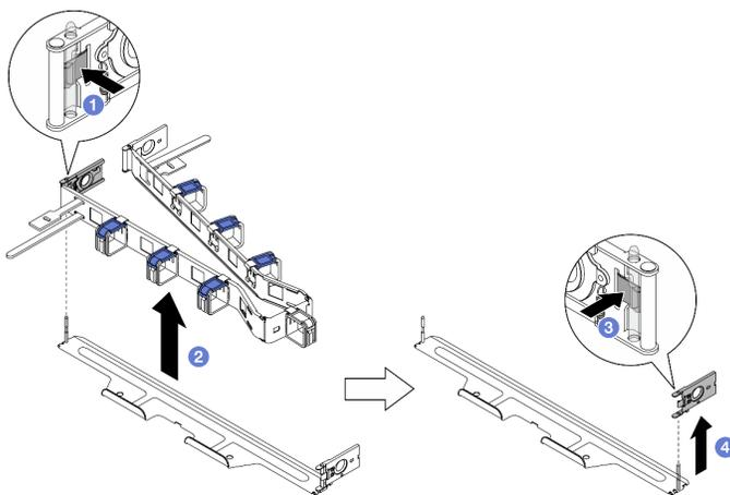
Passo 5. Allineare il foro del fermo di montaggio con il piedino del cardine, quindi spingere il fermo di montaggio per inserirlo.
