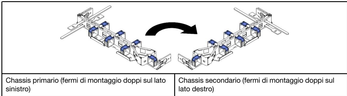
Passo 2. Allineare il fermo di montaggio interno alla linguetta interna sulla guida, quindi spingerlo finché non scatta in posizione.
