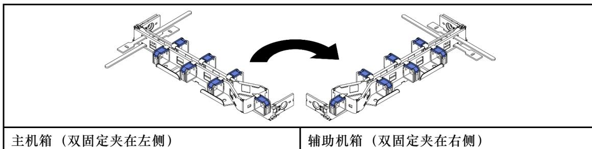
步骤 2. 将内侧的固定夹与滑块上的内侧卡扣对齐; 然后, 将其推入直至“咔哒”一声固定到位。
