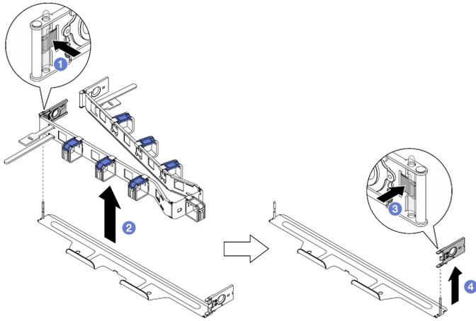
步骤 5. 将固定夹孔与铰链销对齐；然后推动固定夹以将其插入。
