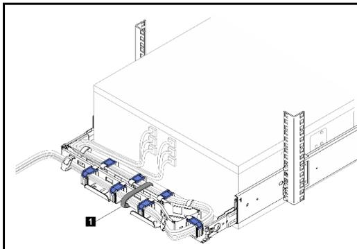
**注意:** 长线缆扎带用于在运输过程中固定 CMA 和线缆。如果 CMA 装在机架中发货, 请先松开长线缆扎带, 然后再拉出服务器。
