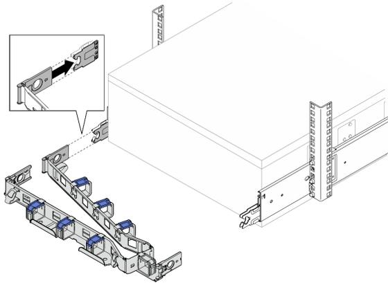
步骤 3. 将两个外侧固定夹与滑块上的外侧卡口对齐；然后，将其推入直至“咔哒”一声固定到位。
