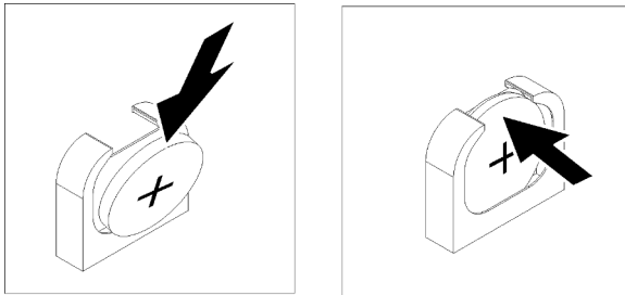
Figura 55. Installazione della batteria di sistema
