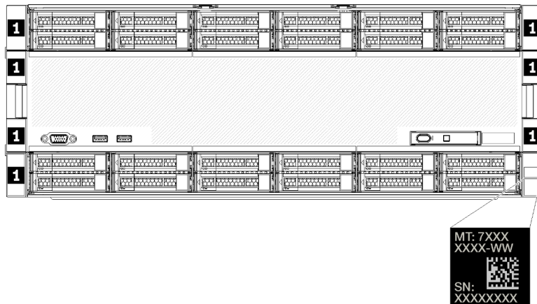
Figura 12. Posizione dell'etichetta ID per ThinkSystem SR950
