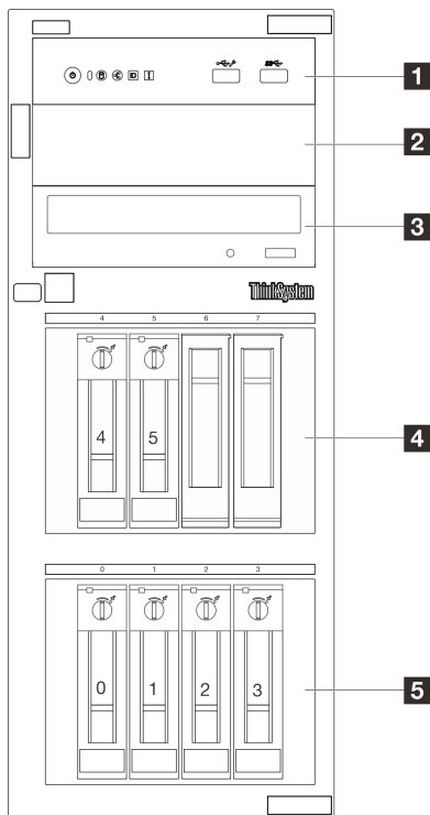
Figure 3. Vue avant des modèles de serveur équipés de six baies d'unités à remplacement standard 3,5 pouces
