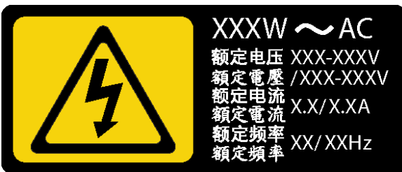
그림 65. 뒷면에 있는 고정 전원 공급 장치 레이블
