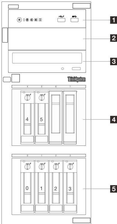
그림 3. 6개의 3.5인치 심플 스왑 드라이브 베이가 지원되는 서버 모델의 앞면 보기
