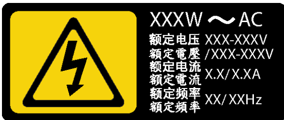
รูปภาพ 65. ป้ายแหล่งจ่ายไฟแบบถาวรบนฝาครอบ
