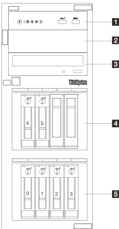
圖例 3. 配備六個 3.5 吋簡易抽換硬碟機槽的伺服器型號正面圖
