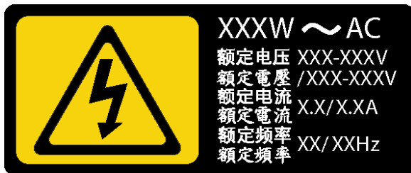
圖例 80. 蓋板上的固定式電源供應器標籤
