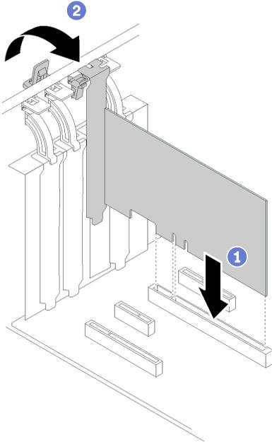
그림 58. PCIe 어댑터 설치
