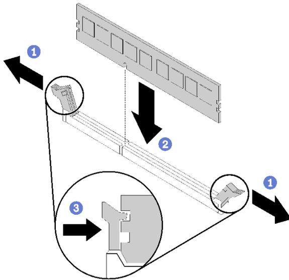
그림 45. DIMM 설치
