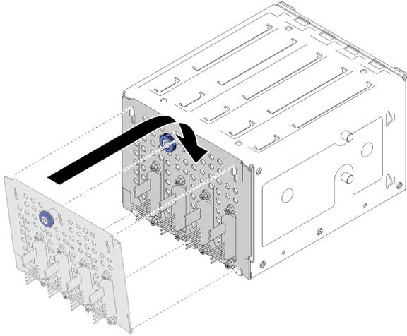
**그림 41. 심플 스왑 드라이브 백플레이트 설치**
