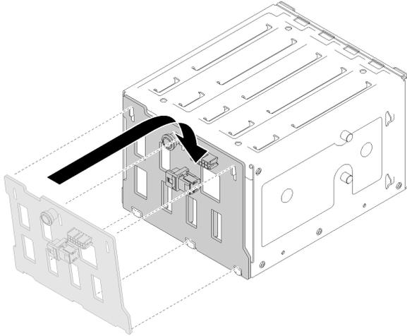
**그림 40. 핫 스왑 드라이브 백플레인 설치**
