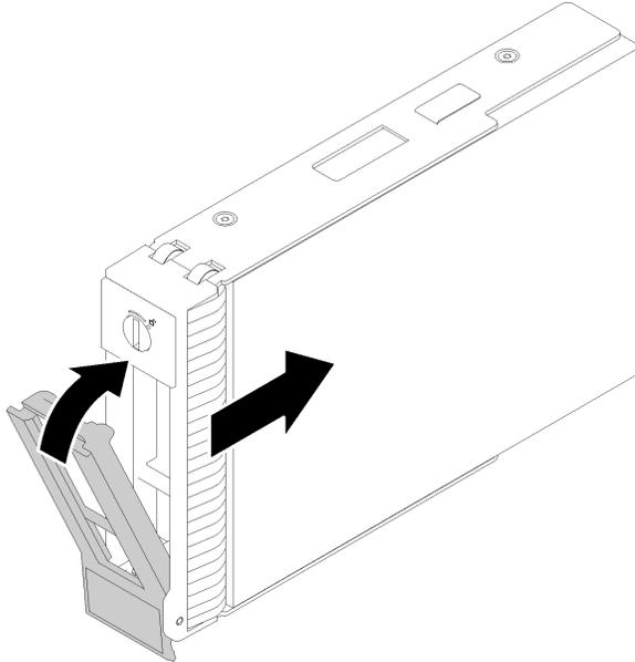
**그림 59. 드라이브 베이에 심플 스왑 드라이브 설치**
