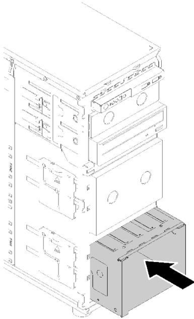
**그림 39. 드라이브 케이지 설치**
