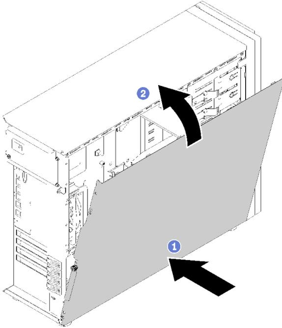
**그림 61. 서버 덮개 설치(1)**
