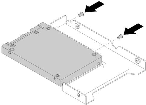
**그림 43. 드라이브 어댑터에 SSD를 고정하도록 나사 설치**
