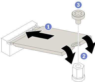
그림 54. M.2 드라이브 설치
