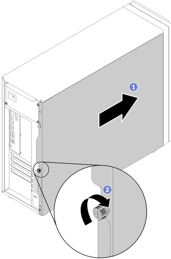
**그림 62. 서버 덮개 설치(2)**
