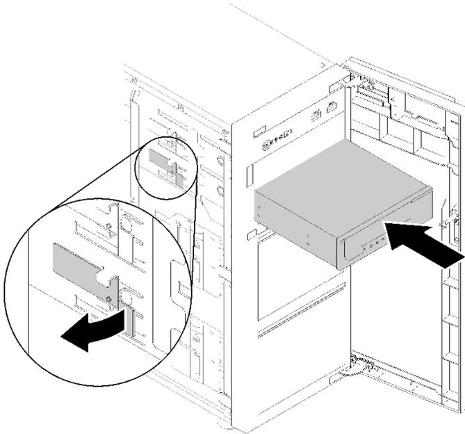
**그림 60. 테이프 드라이브 설치**
