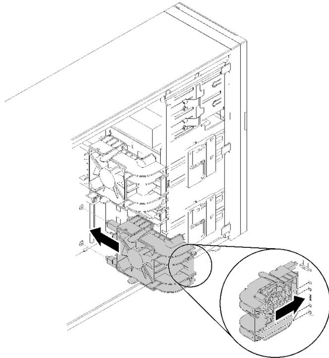
**그림 48. 앞면 시스템 팬 설치**
