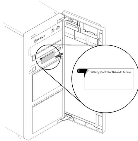
**그림 2. XClarity Controller 네트워크 액세스 레이블의 위치**
