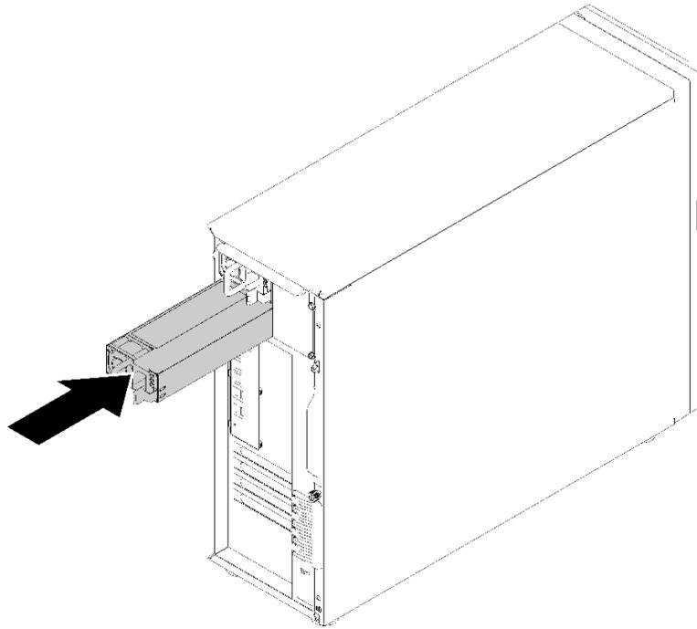
그림 52. 핫 스왑 전원 공급 장치 설치
