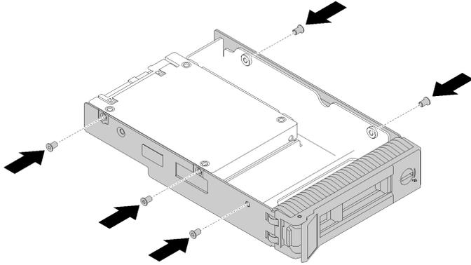
그림 44. 드라이브 어댑터와 SSD를 드라이브 트레이에 고정하도록 나사 설치
