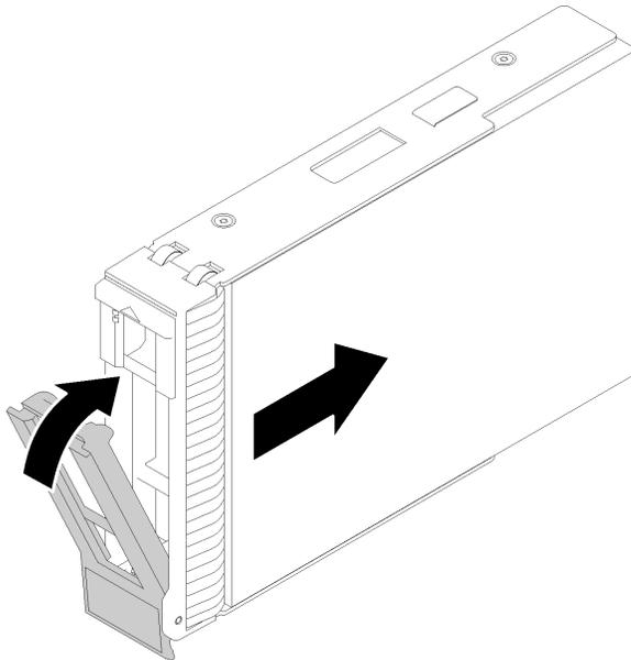
**그림 49. 핫 스왑 드라이브 설치**
