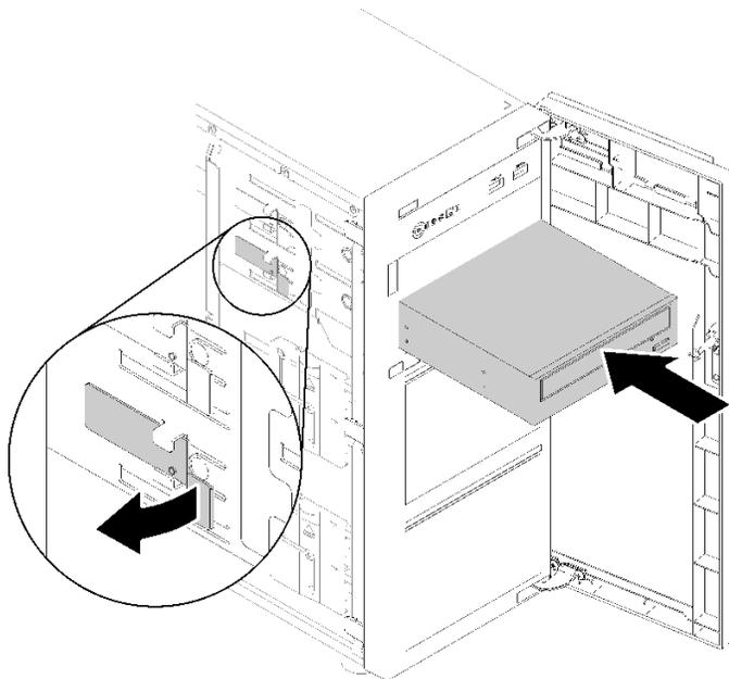
**그림 57. 광 드라이브 설치**
