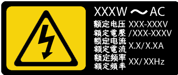
รูปภาพ 90. ป้ายแหล่งจ่ายไฟแบบถาวรบนฝาครอบ
