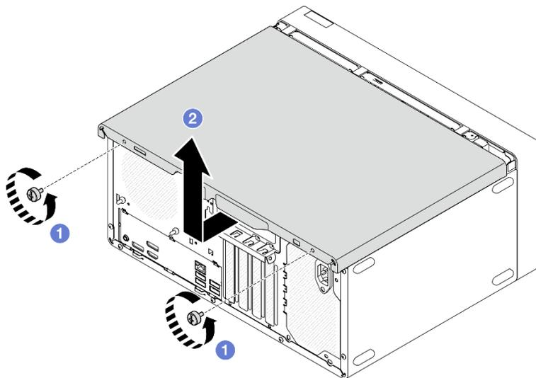
Figura 102. Rimozione del coperchio del server
