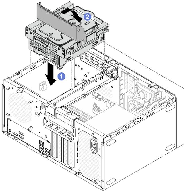
Figura 40. Installazione dell'assieme del telaio dell'unità del vano 2+vano 3
