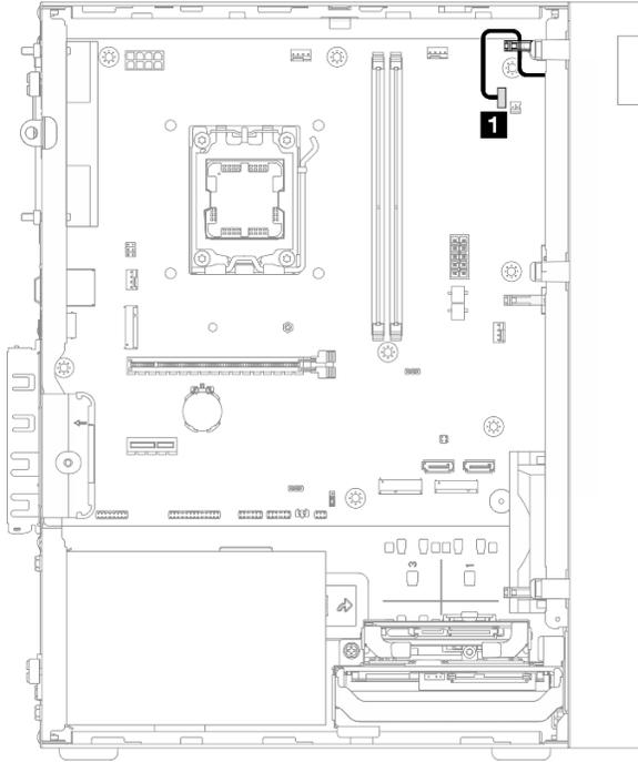
Figura 117. Instradamento dei cavi per il pulsante di alimentazione con LED
