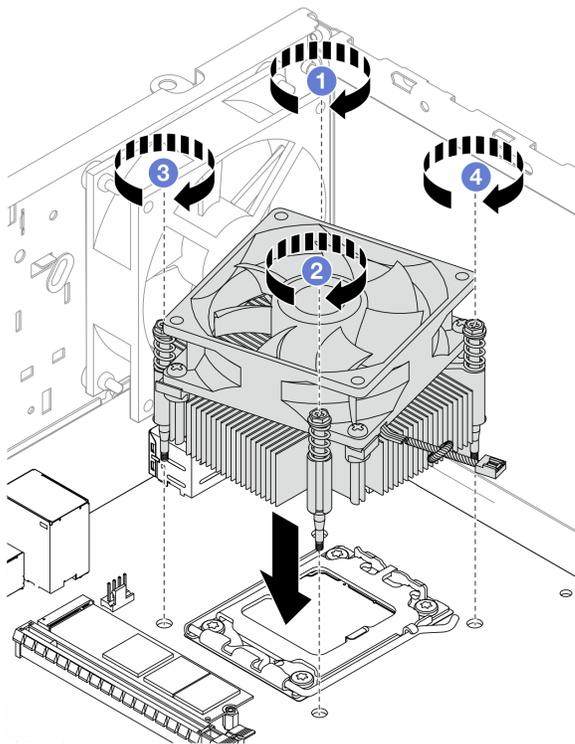
*Figura 61. Installazione del dissipatore di calore e del modulo della ventola*
