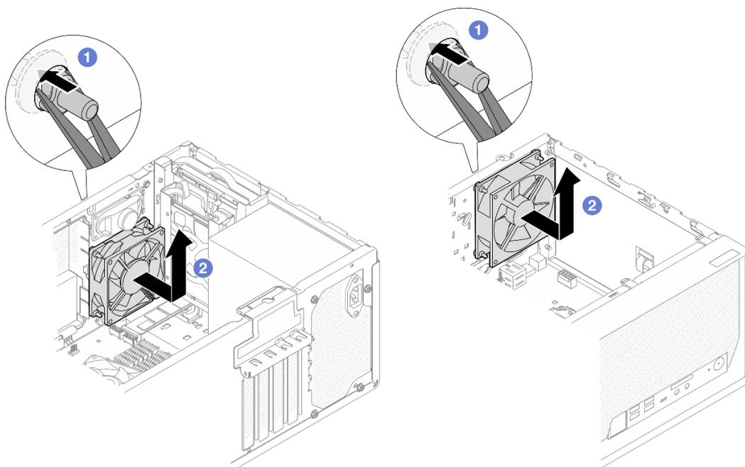
Figura 54. Rimozione della ventola mediante compressione dei gommini
