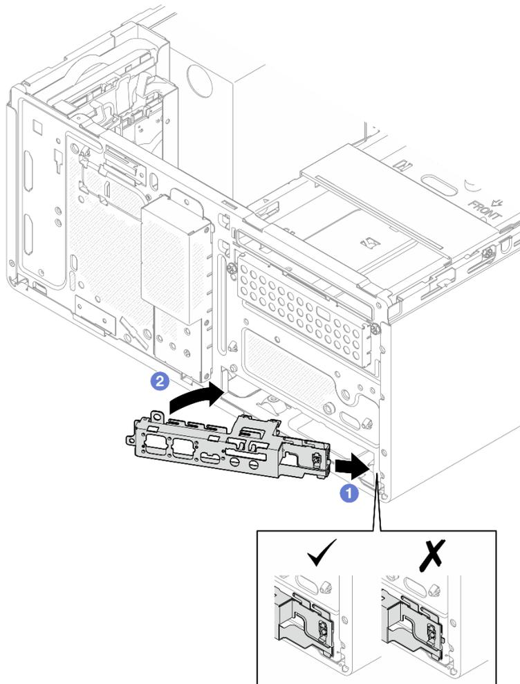
Figura 100. Installazione della staffa I/O anteriore nello chassis
