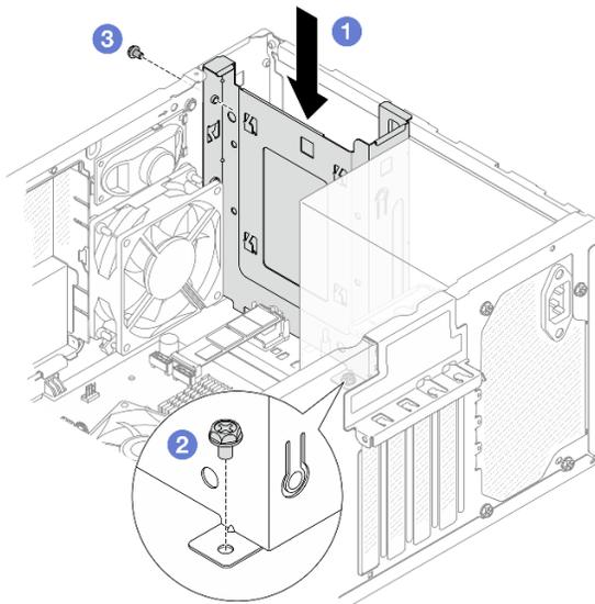
Figura 16. Installazione del telaio dell'unità del vano 0
