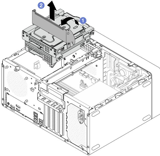
Figura 36. Rimozione dell'assieme del telaio dell'unità del vano 2+vano 3
