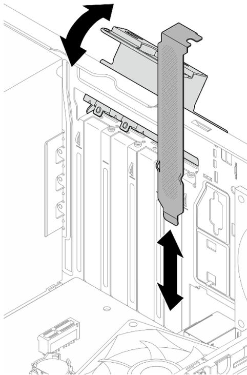
Figura 78. Rimozione della staffa di un adattatore PCIe
