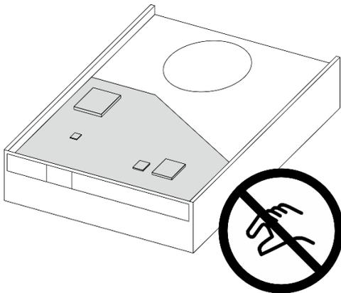
Figura 21. Scheda di circuito sull'unità
