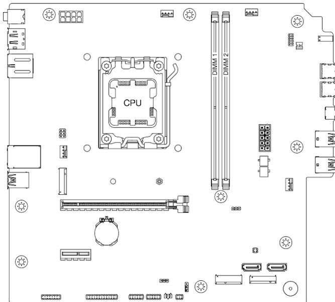
Figura 68. Layout dei moduli di memoria e del processore
