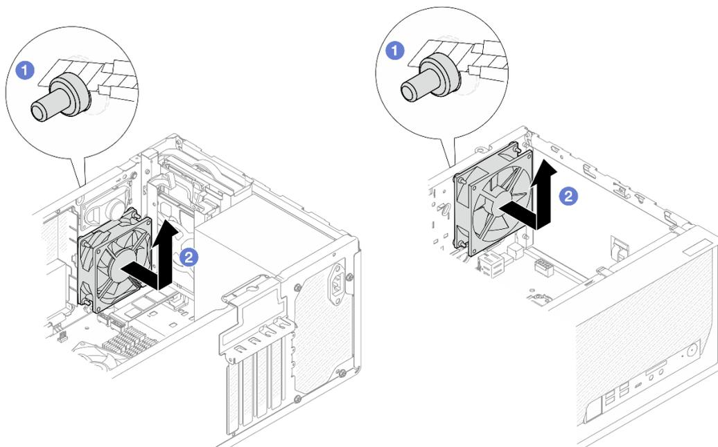
Figura 55. Rimozione della ventola mediante taglio dei gommini
