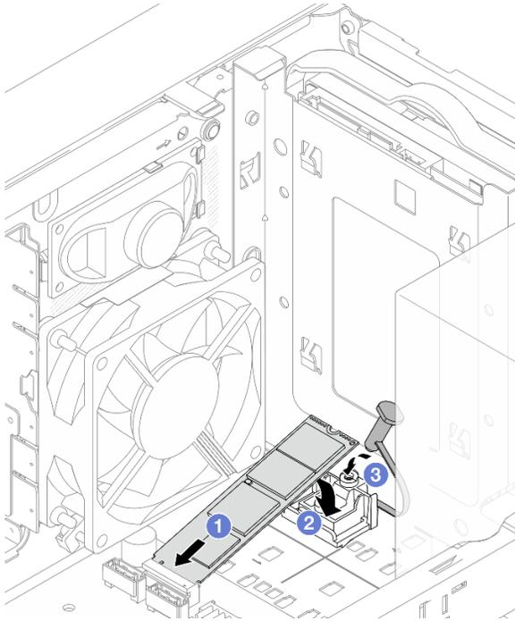
Figura 65. Installazione dell'unità M.2 2
