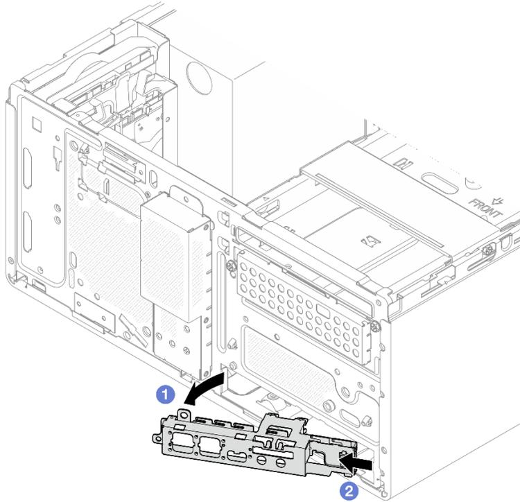
Figura 95. Rimozione della staffa I/O anteriore dallo chassis
