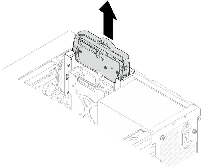
Figura 4. Rimozione di un assieme dell'unità dal vano 0 dell'unità
