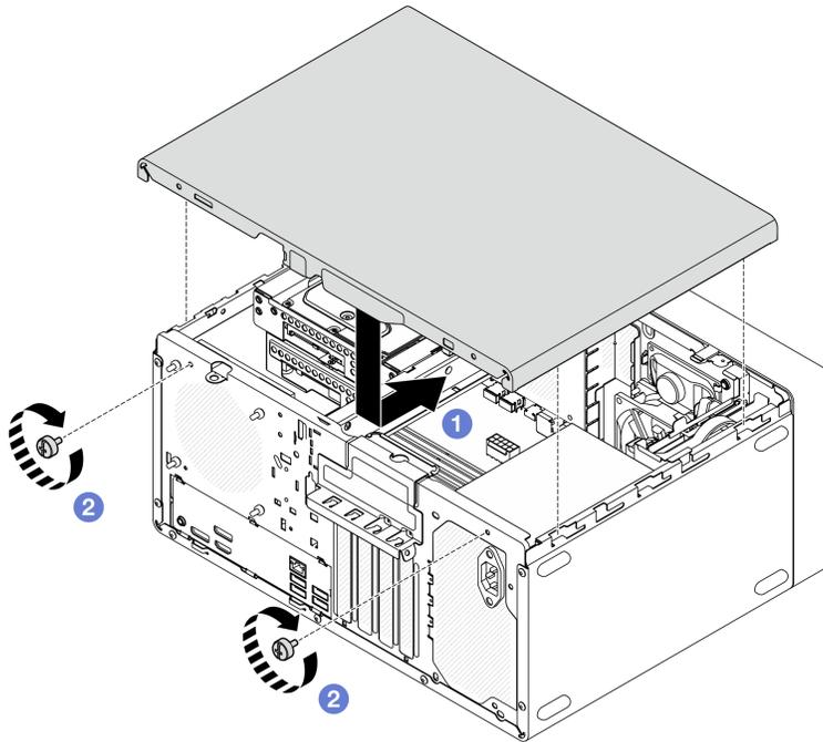
Figura 105. Installazione del coperchio del server
