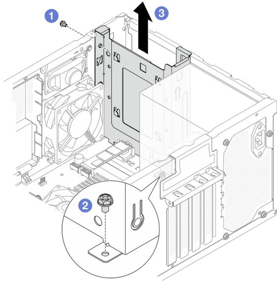
Figura 15. Rimozione del telaio dell'unità del vano 0
