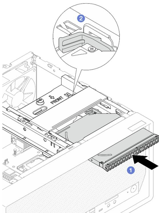
Figura 48. Installazione dell'unità ottica
