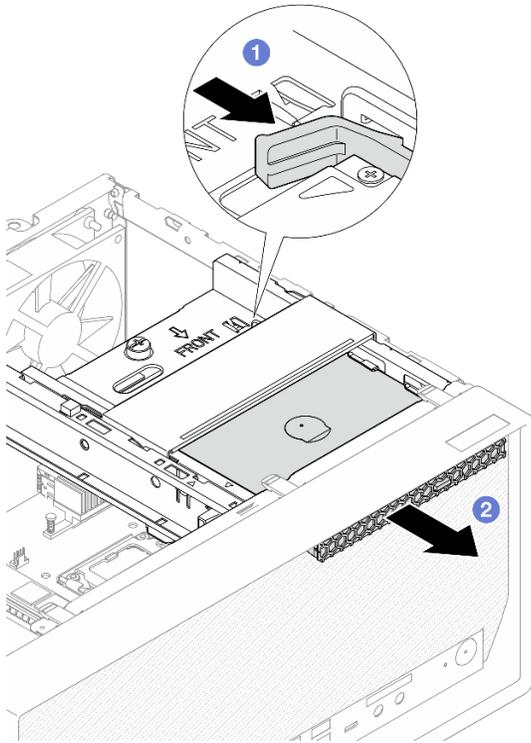
Figura 41. Rimozione dell'unità ottica
