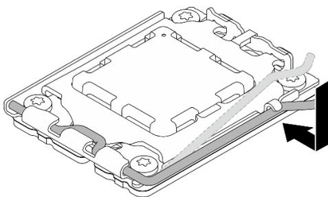
Figura 93. Chiusura del fermo del processore
