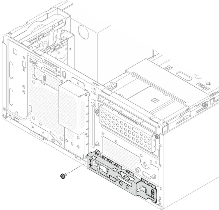
*Figura 80. Rimozione della vite che fissa la staffa I/O anteriore*
