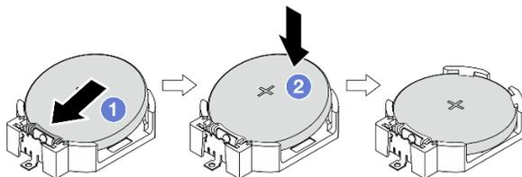
Figura 3. Installazione della batteria CMOS
