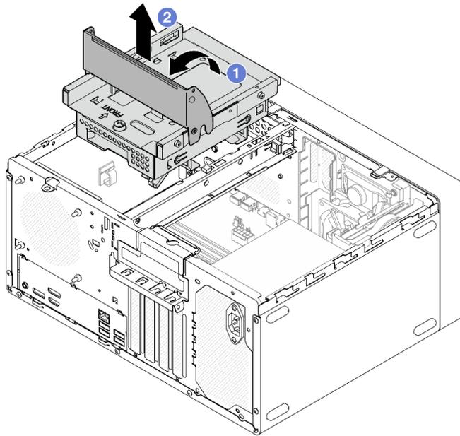
Figura 49. Rimozione dell'assieme del telaio dell'unità disco ottica+vano 2
