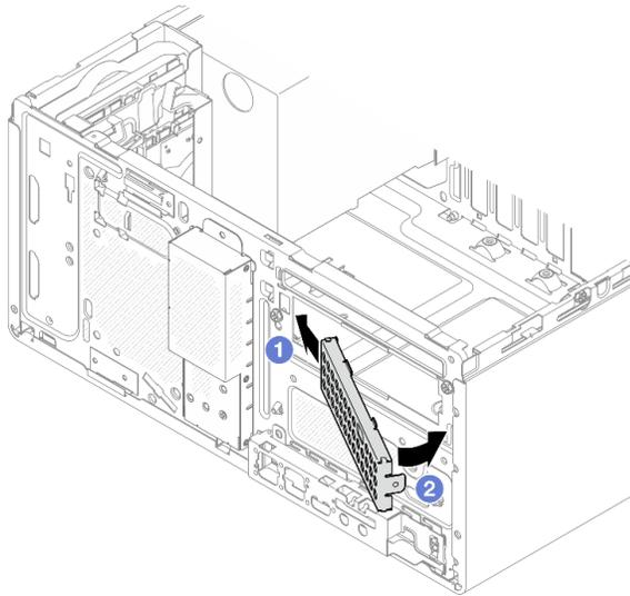
Figura 27. Installazione della schermatura EMI
