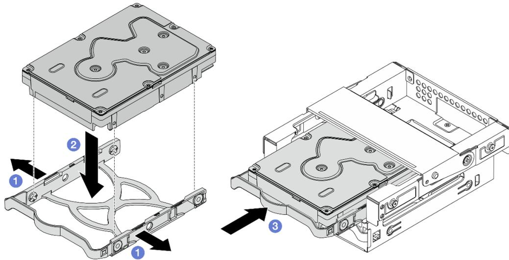
Figura 33. Installazione di un'unità da 3,5" nel telaio dell'unità del vano 3
