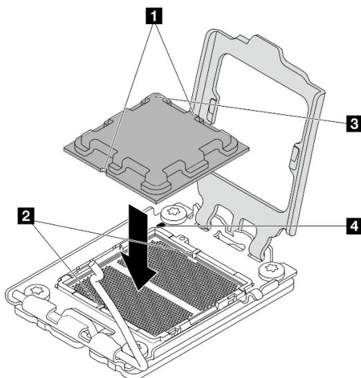
Figura 92. Installazione del processore
