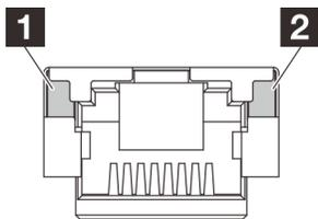
Figura 119. LED della porta Ethernet (RJ-45 da 10/100/1.000 Mbps)
