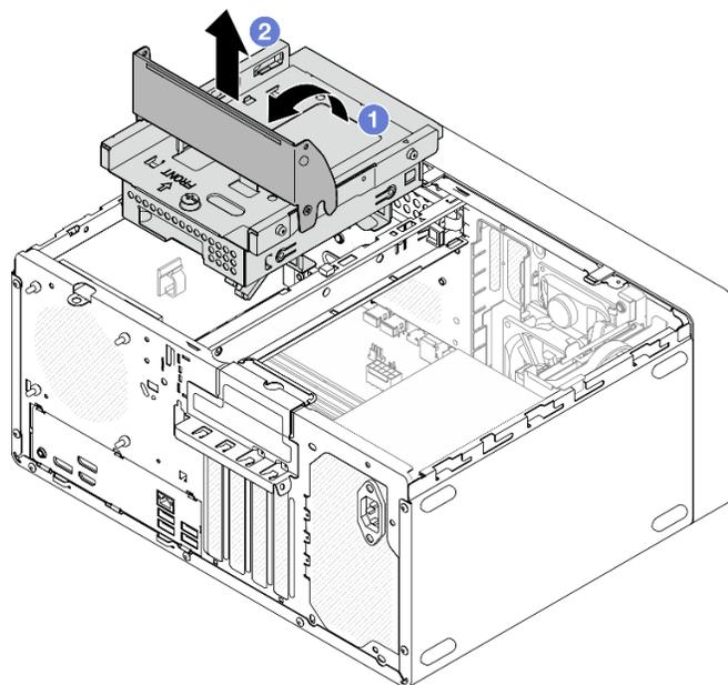
Figura 19. Rimozione dell'assieme del telaio dell'unità disco ottica+vano 2
