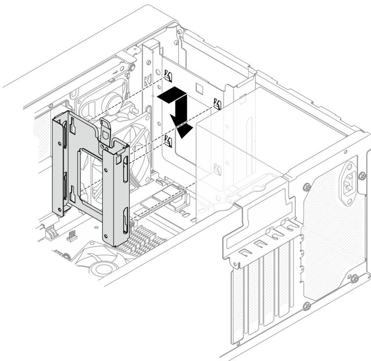
Figura 18. Installazione del telaio dell'unità del vano 1
