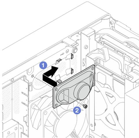
Figura 75. Installazione dell'amplificatore mono
