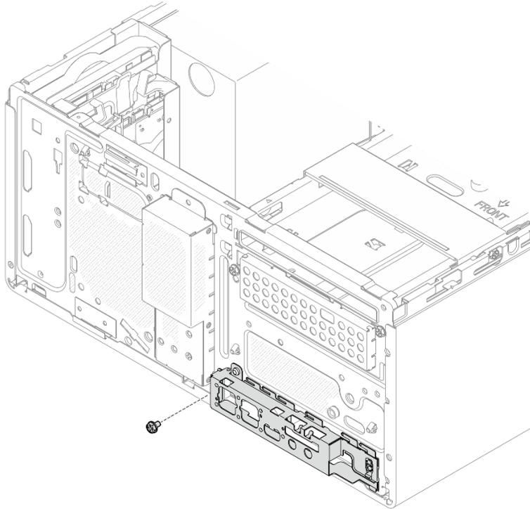
*Figura 94. Rimozione della vite che fissa la staffa I/O anteriore*
