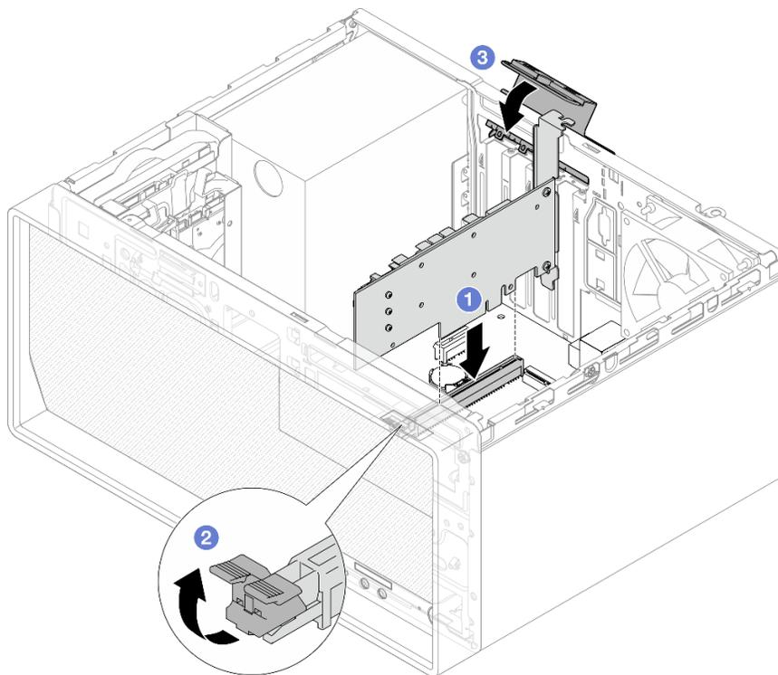
Figura 79. Installazione di un adattatore PCIe
