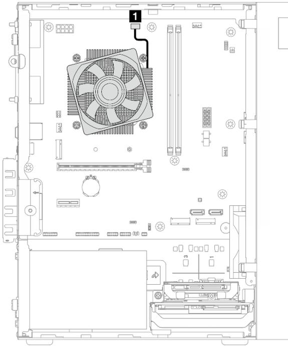
Figura 114. Instradamento dei cavi per il dissipatore di calore e il modulo della ventola
