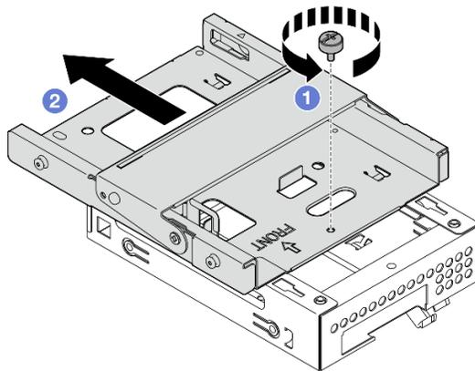
Figura 50. Rimozione del telaio dell'unità ottica dal telaio dell'unità del vano 2
