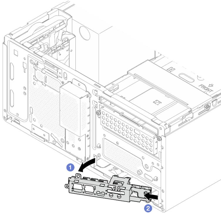
Figura 81. Rimozione della staffa I/O anteriore dallo chassis
