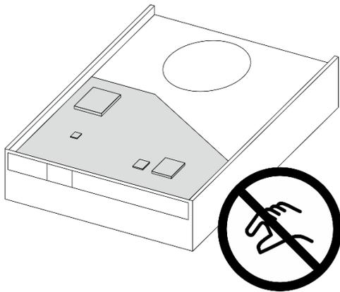
Figura 32. Scheda di circuito sull'unità
