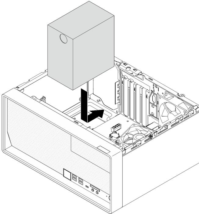
*Figura 88. Installazione dell'unità di alimentazione nello chassis*
