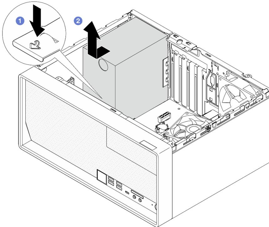
Figura 87. Rimozione dell'unità di alimentazione
