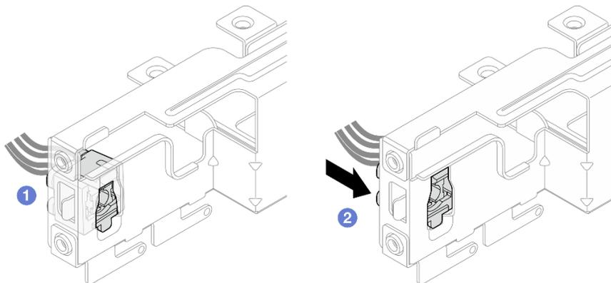
Figura 83. Installazione del pulsante di alimentazione con LED
