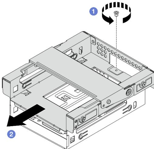
Figura 37. Rimozione del telaio dell'unità del vano 3
