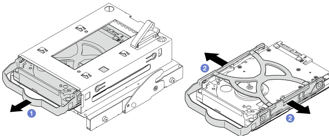
Figura 20. Rimozione dell'unità da 3,5"
