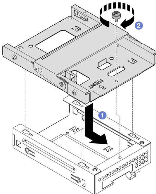
Figura 28. Installazione del telaio dell'unità ottica nel telaio dell'unità del vano 2
