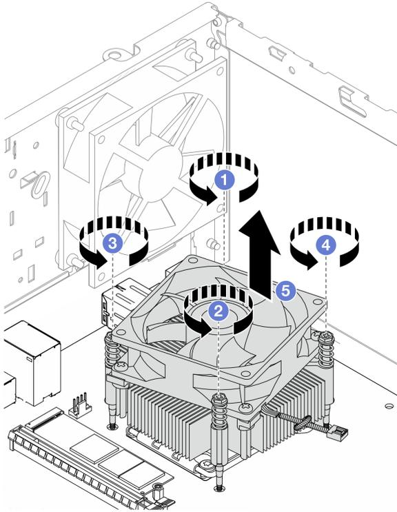
Figura 60. Rimozione del dissipatore di calore e del modulo della ventola
