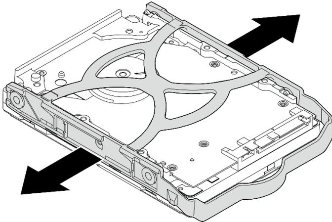
Figura 6. Rimozione di un'unità da 3,5" dal fermo
