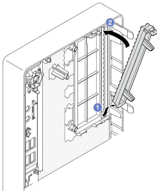
Figura 44. Installazione della schermatura del vano dell'unità ottica
