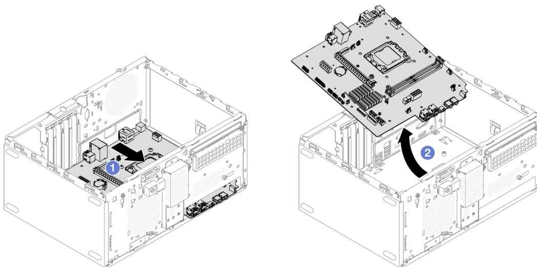
Figura 97. Rimozione della scheda di sistema dallo chassis
