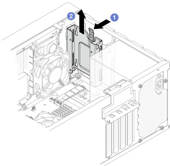
Figura 13. Rimozione del telaio dell'unità del vano 1
