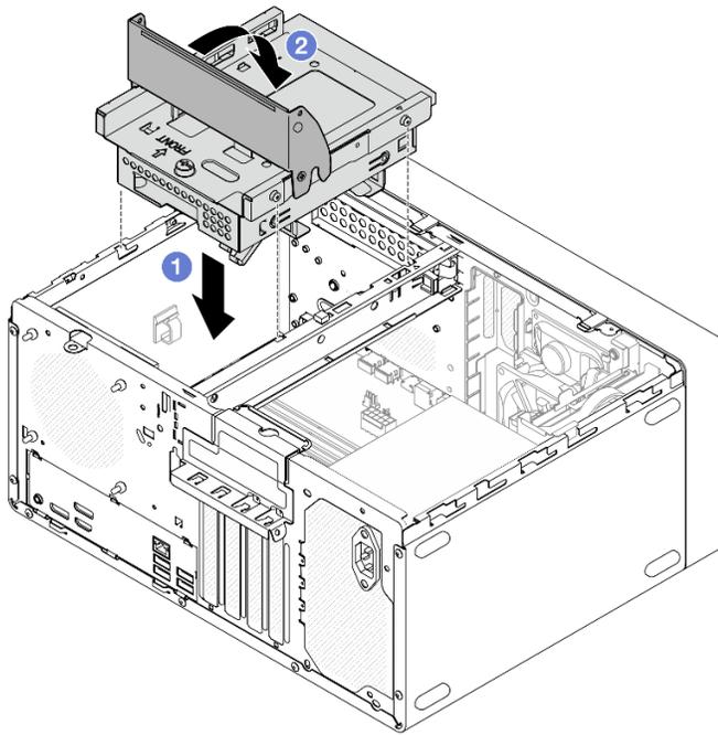
Figura 29. Installazione dell'assieme del telaio dell'unità disco ottica+vano 2
