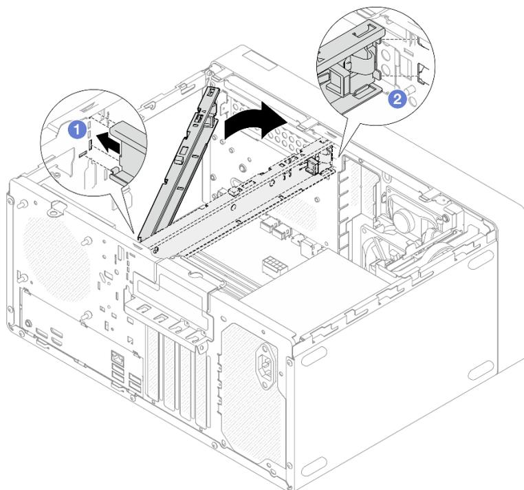
Figura 104. Installazione della barra del telaio
