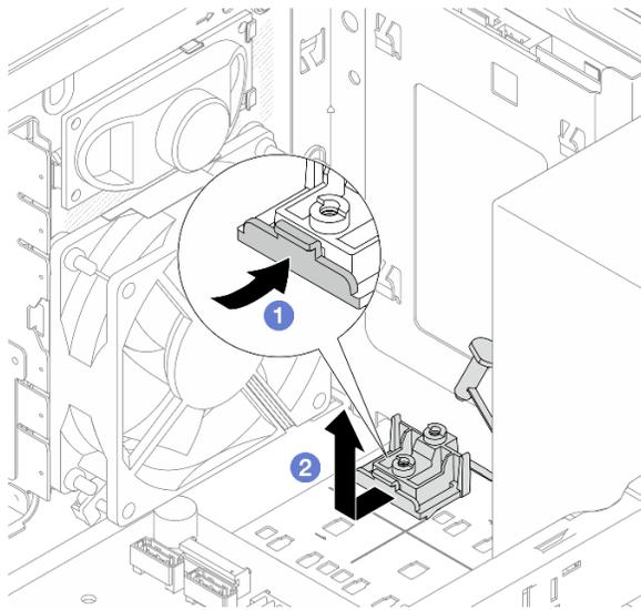
Figura 66. Rimozione del fermo dell'unità M.2
