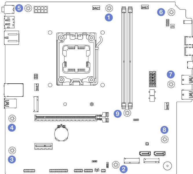
Figura 99. Sequenza di installazione delle viti della scheda di sistema
