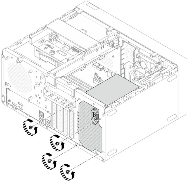
Figura 86. Rimozione delle viti che fissano l'unità di alimentazione
