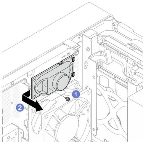
Figura 74. Rimozione dell'amplificatore mono
