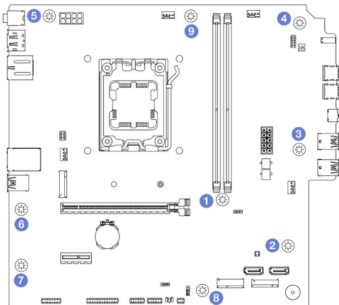
Figura 96. Sequenza della rimozione delle viti dalla scheda di sistema
