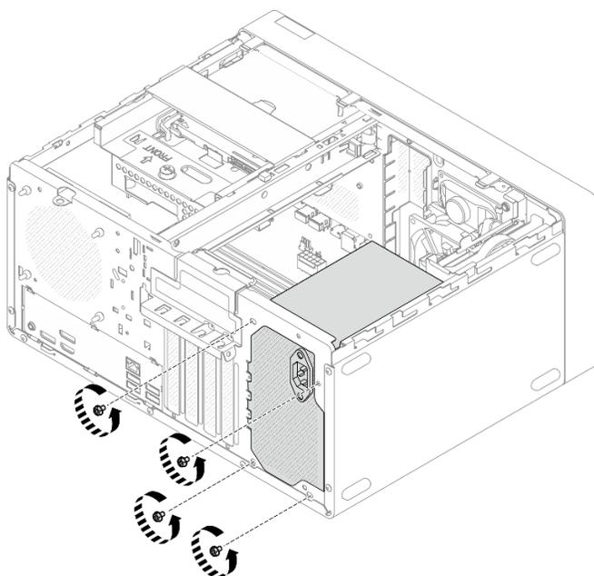
Figura 89. Fissaggio dell'unità di alimentazione allo chassis
