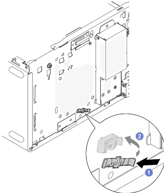
Figura 106. Rimozione del sensore termico
