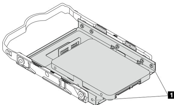
Figura 34. Posizionamento del foro della vite dell'unità sul fermo
