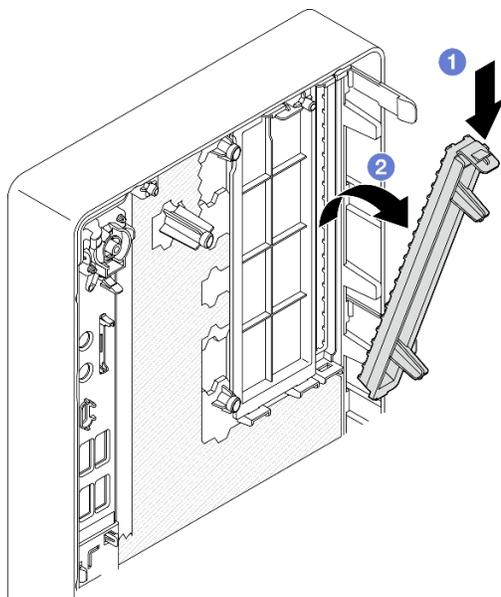
Figura 45. Rimozione della schermatura del vano dell'unità ottica
