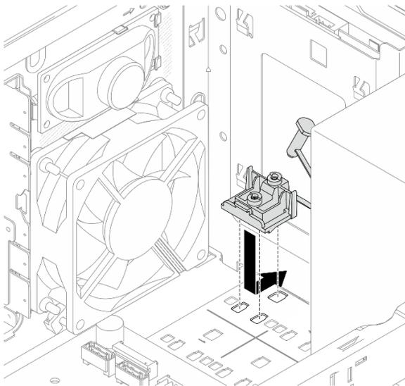
Figura 67. Installazione del fermo dell'unità M.2
