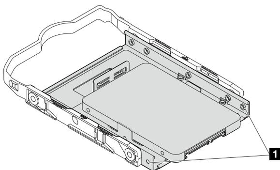
Figura 23. Posizionamento del foro della vite dell'unità sul fermo
