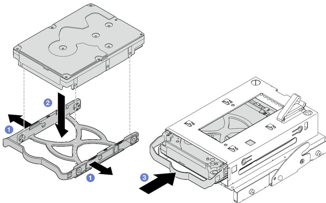
Figura 22. Installazione di un'unità da 3,5" nel telaio dell'unità
