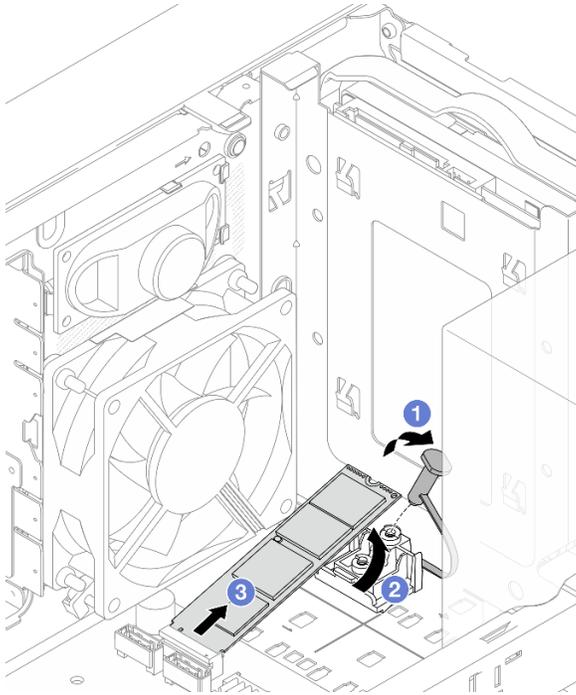
Figura 63. Rimozione dell'unità M.2 2
