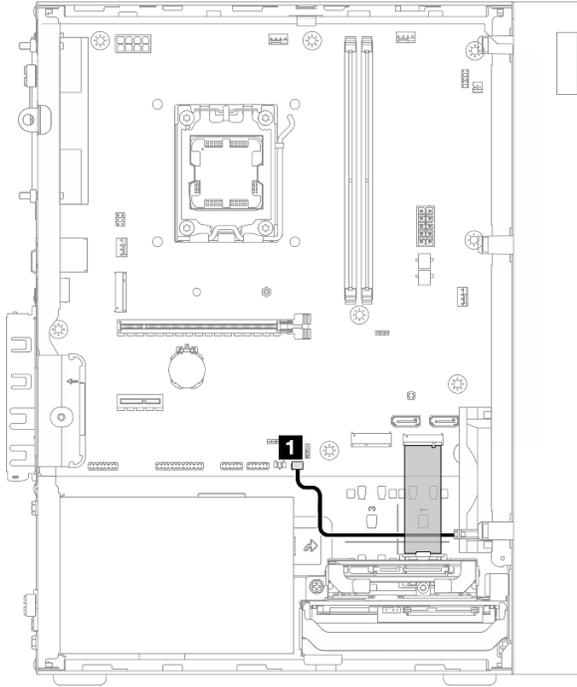
Figura 115. Instradamento dei cavi per il sensore termico
