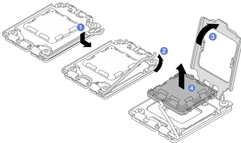
Figura 90. Rimozione del processore
