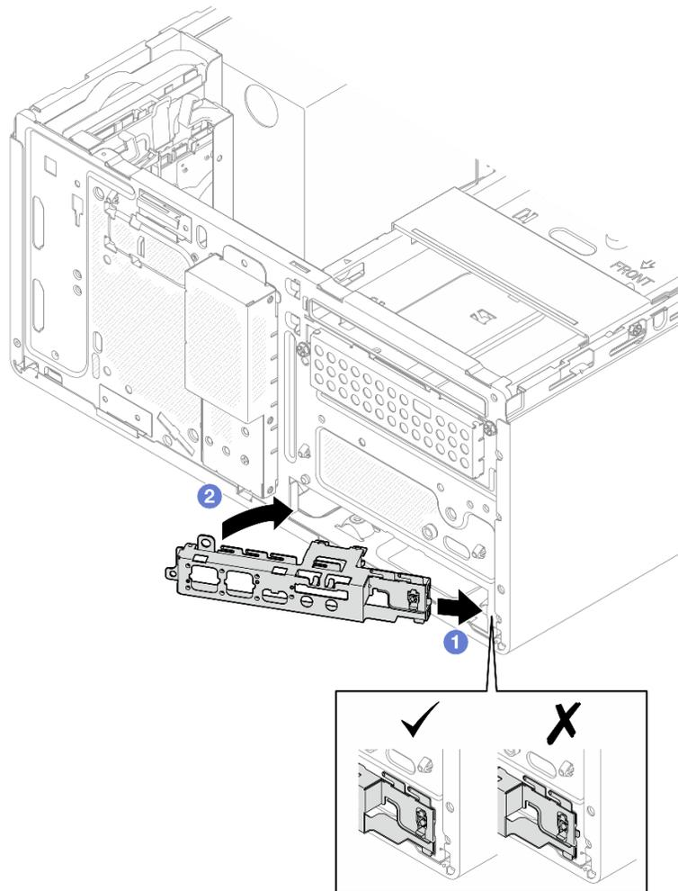
Figura 84. Installazione della staffa I/O anteriore nello chassis
