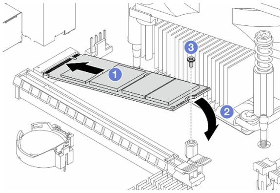
Figura 64. Installazione dell'unità M.2 1
