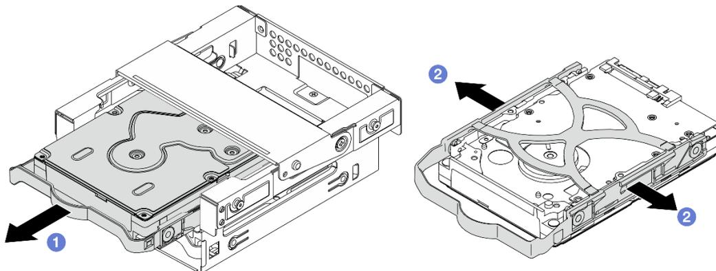
Figura 31. Rimozione dell'unità da 3,5"
