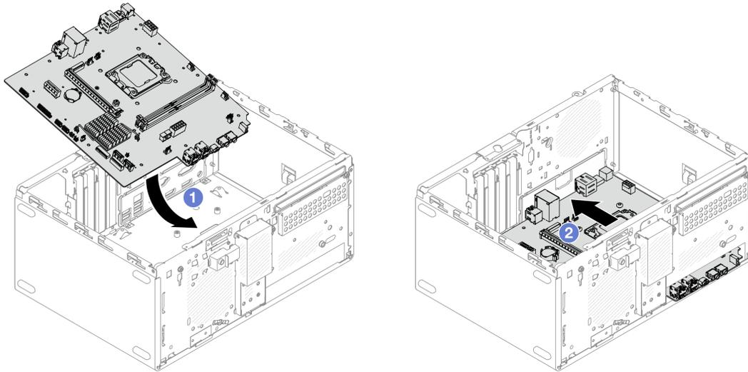
Figura 98. Installazione della scheda di sistema nello chassis
