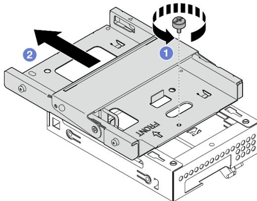
Figura 26. Rimozione del telaio dell'unità ottica dal telaio dell'unità del vano 2
