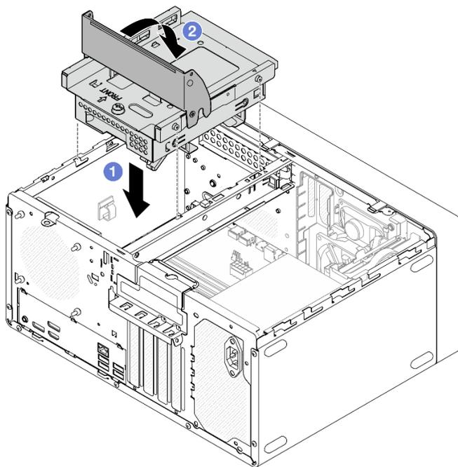
Figura 24. Installazione dell'assieme del telaio dell'unità disco ottica+vano 2
