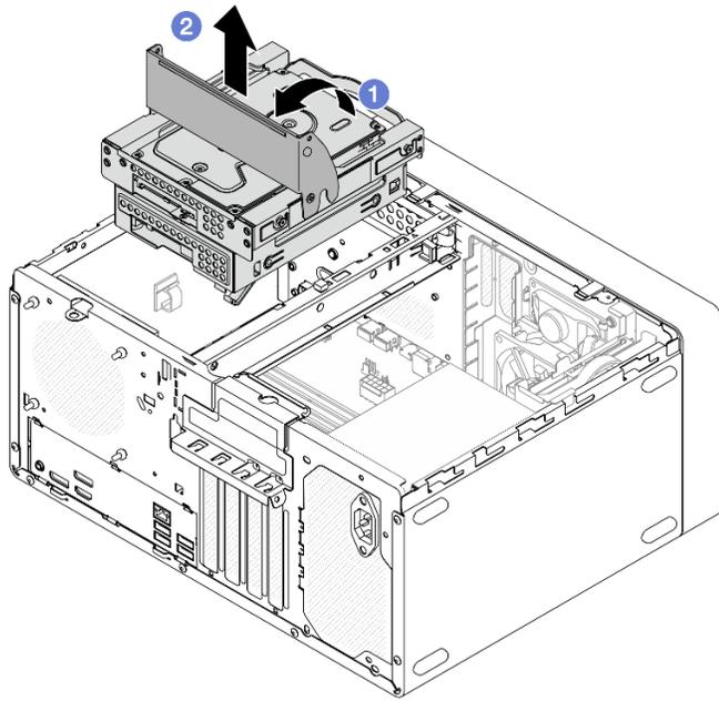
Figura 30. Rimozione dell'assieme del telaio dell'unità del vano 2+vano 3
