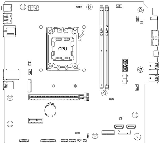
Figura 71. Layout dei moduli di memoria e del processore
