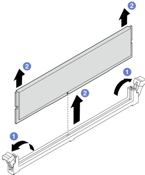
Figura 70. Rimozione del modulo di memoria
