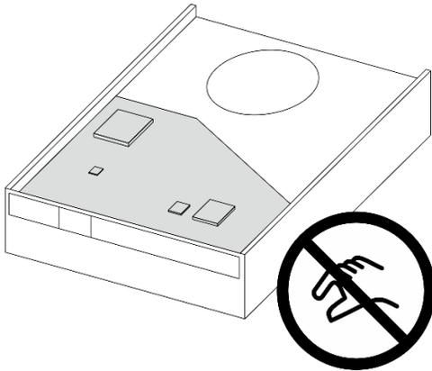
Figura 8. Scheda di circuito sull'unità
