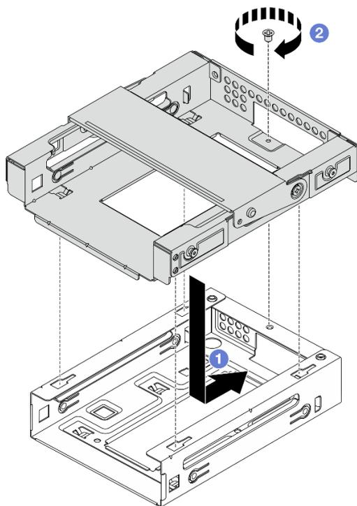
Figura 39. Installazione del telaio dell'unità del vano 3 nel telaio dell'unità del vano 2
