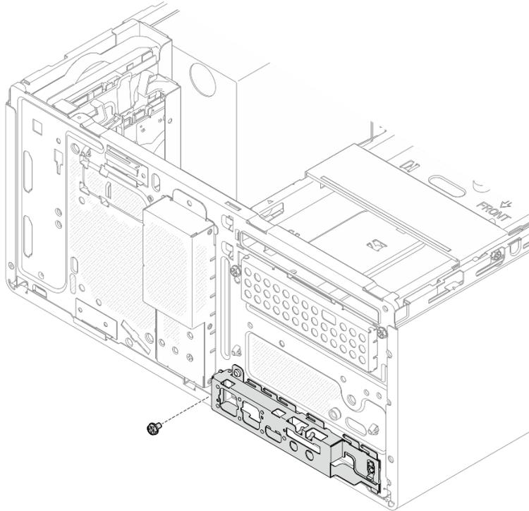
Figura 85. Fissaggio della staffa I/O anteriore allo chassis
