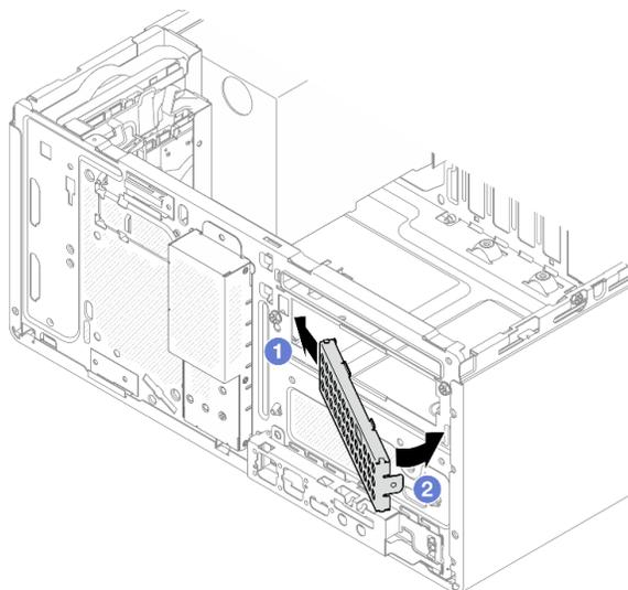
Figura 38. Installazione della schermatura EMI
