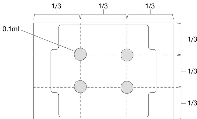
Figura 91. Forma corretta del lubrificante termico
