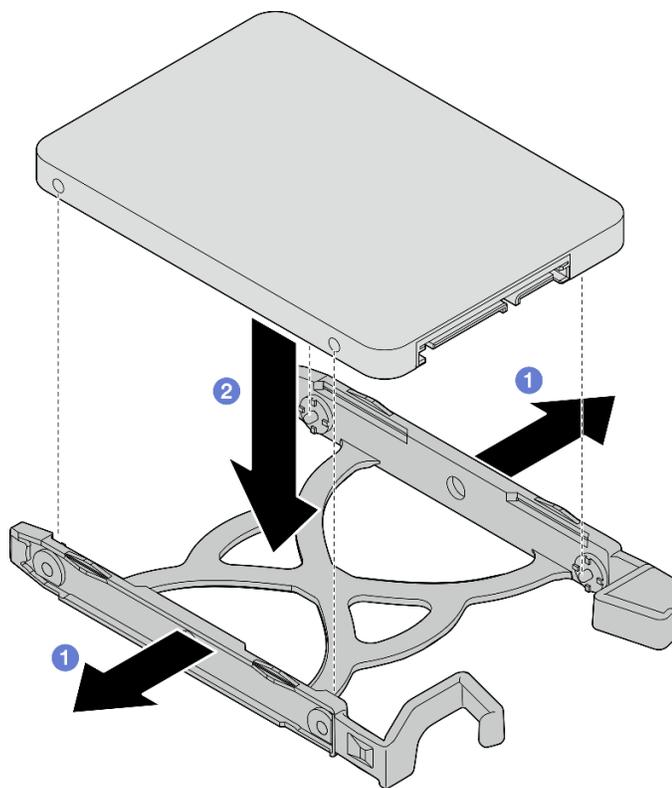
*Figura 10. Installazione di un'unità da 2,5" nel supporto*
