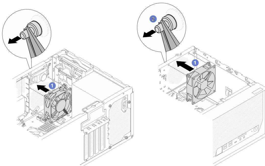
Figura 56. Installazione della ventola anteriore o posteriore
