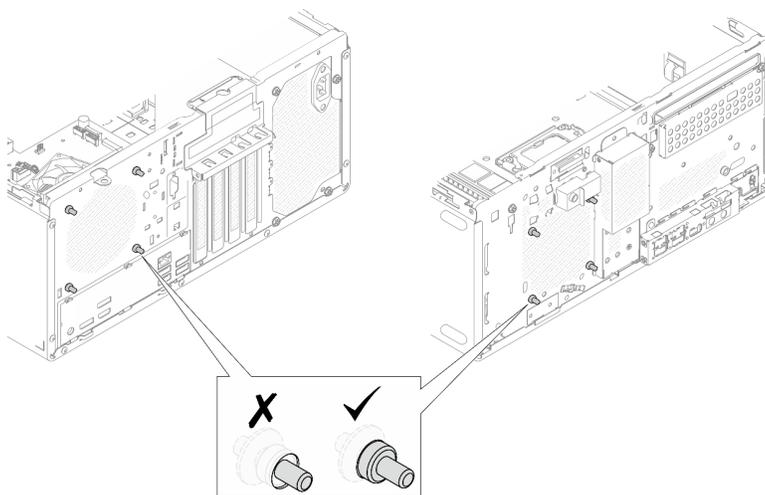
Figura 57. Installazione dei gommini delle ventole anteriore e posteriore
