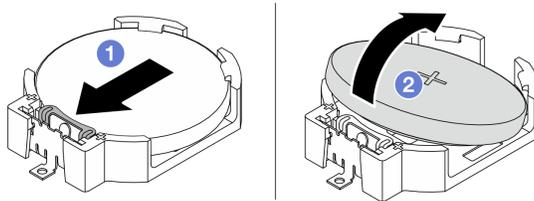
Figura 2. Rimozione della batteria CMOS
