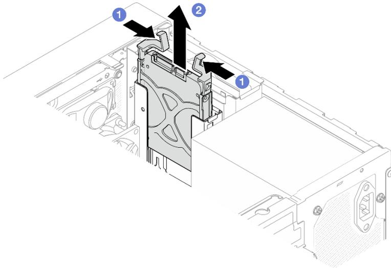
Figura 5. Rimozione di un assieme dell'unità dal vano 1 dell'unità
