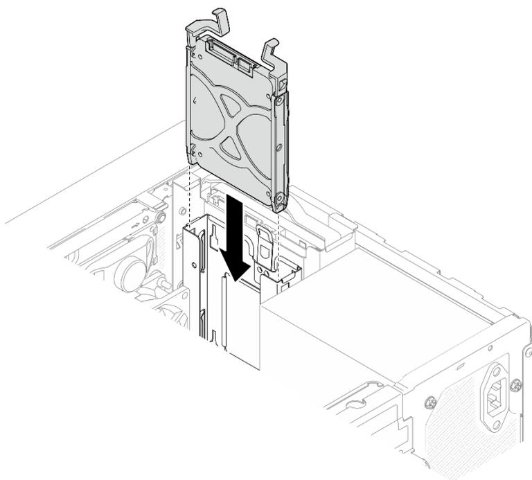
*Figura 12. Installazione dell'assieme dell'unità da 2,5" nel vano 1 dell'unità*
