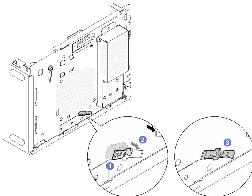
Figura 107. Installazione del sensore termico
