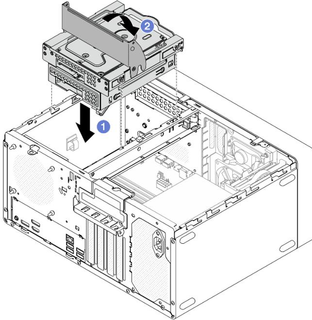
Figura 35. Installazione dell'assieme del telaio dell'unità del vano 2+vano 3
