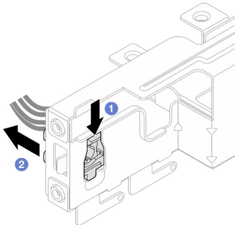
Figura 82. Rimozione del pulsante di alimentazione con LED
