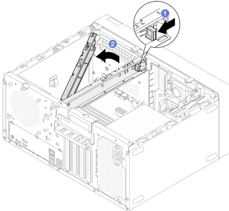
Figura 103. Rimozione della barra del telaio
