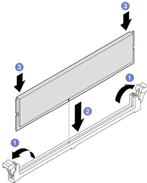
Figura 73. Installazione del modulo di memoria
