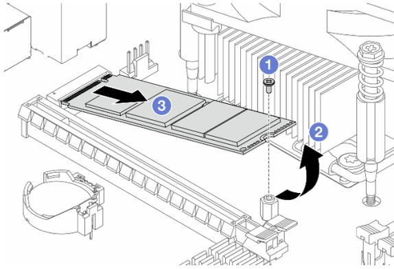
Figura 62. Rimozione dell'unità M.2 1
