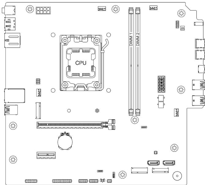
Figura 1. Layout dei moduli di memoria e del processore
