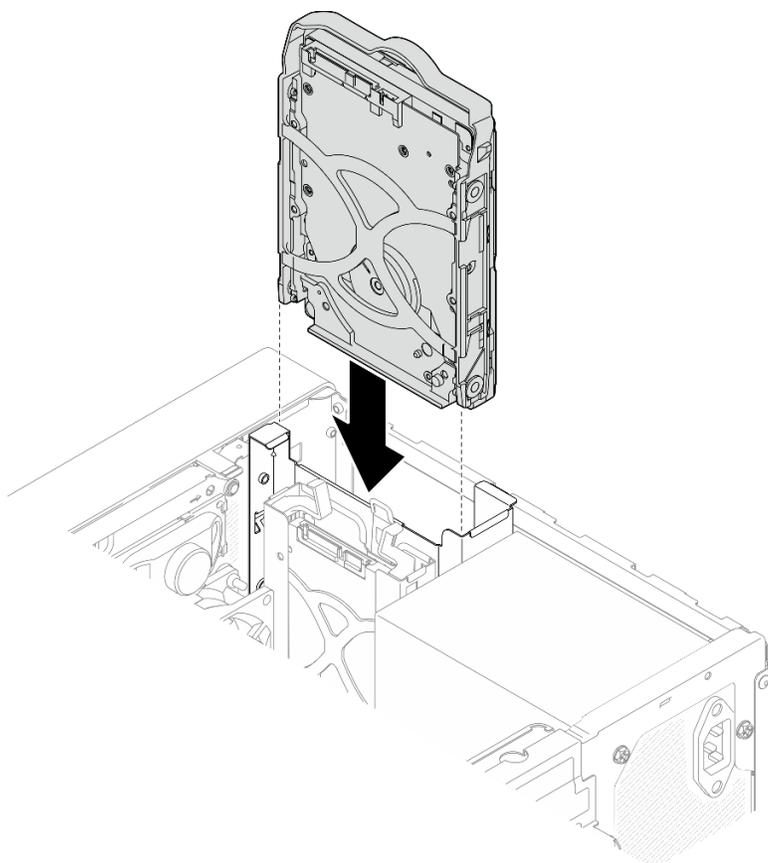
*Figura 11. Installazione dell'assieme dell'unità da 3,5" nel vano 0 dell'unità*
