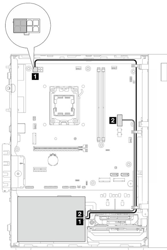
図 112. PSU のケーブル配線
