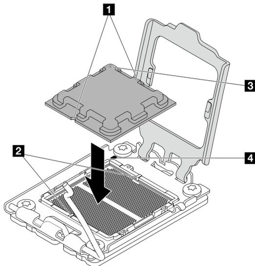
図92. プロセッサの取り付け
