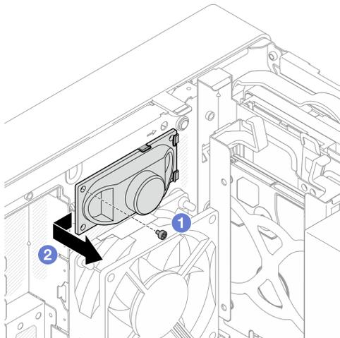
図 74. Mono 増幅器の取り外し
