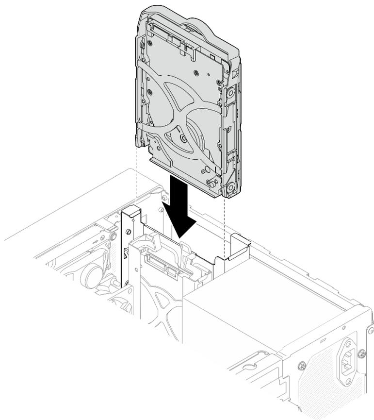
図11. ドライブ・ベイ0への3.5型ドライブ・アセンブリーの取り付け
