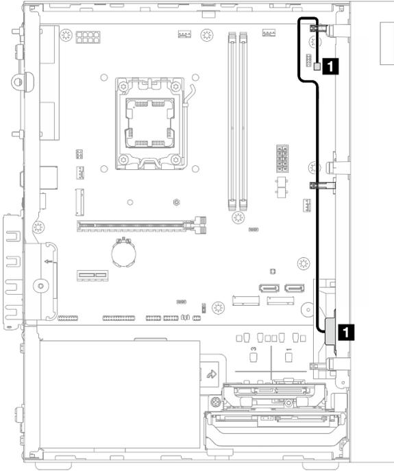
図 116. Mono 増幅器のケーブル配線
