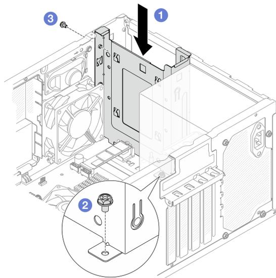
図16. ベイ0ドライブ・ケージの取り付け
