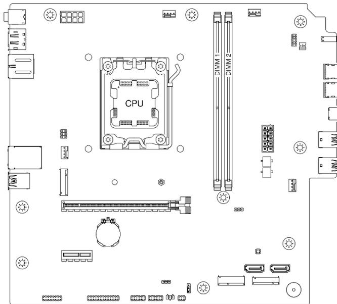
図 71. メモリー・モジュールおよびプロセッサのレイアウト
