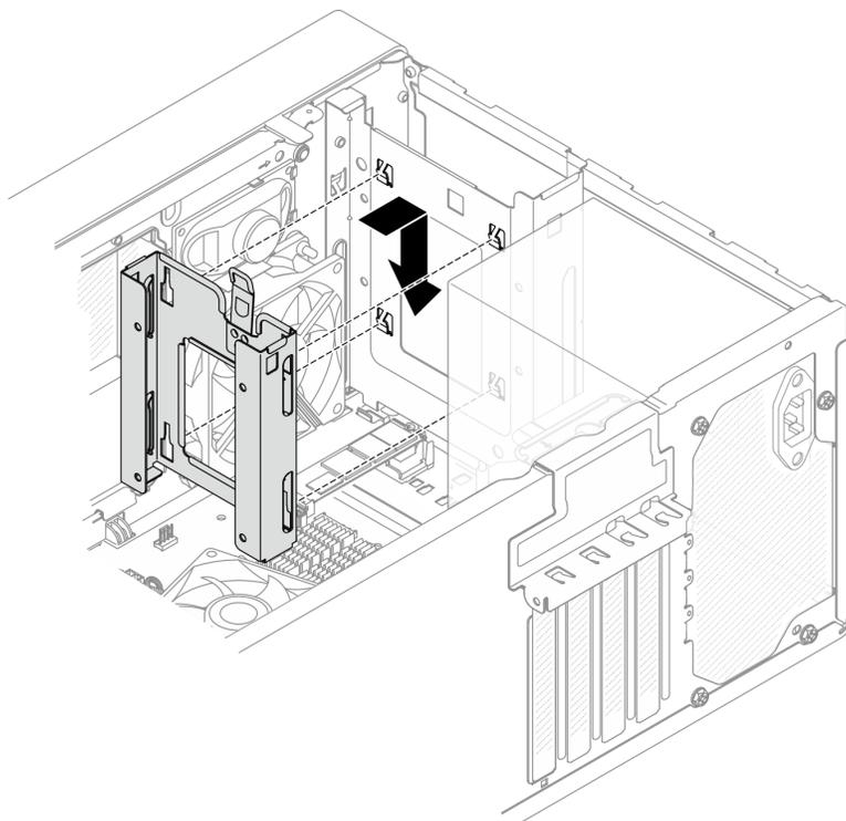
図18. ベイ1ドライブ・ケージの取り付け
