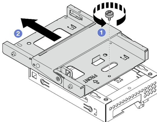
図 26. ベイ 2 ドライブ・ケージからの光学式ドライブ・ケージの取り外し
