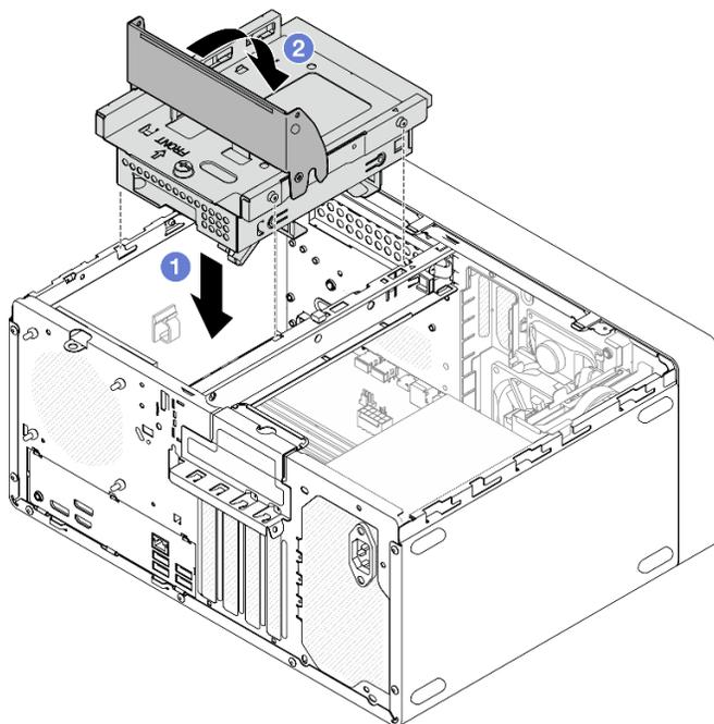
図 24. ODD + ベイ 2 ドライブ・ケージ・アセンブリーの取り付け
