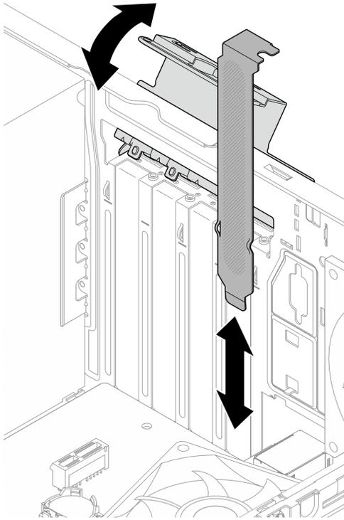
図 77. PCIe アダプター・ブラケットの取り付け
