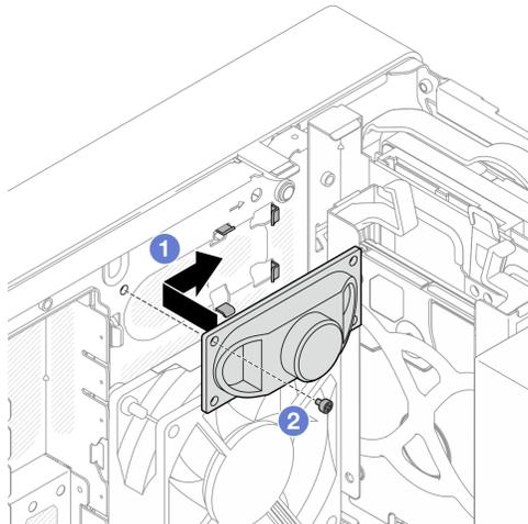
図 75. Mono 増幅器の取り付け
