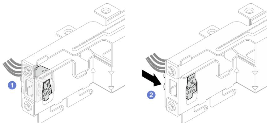
図 83. LED 付き電源ボタンの取り付け
