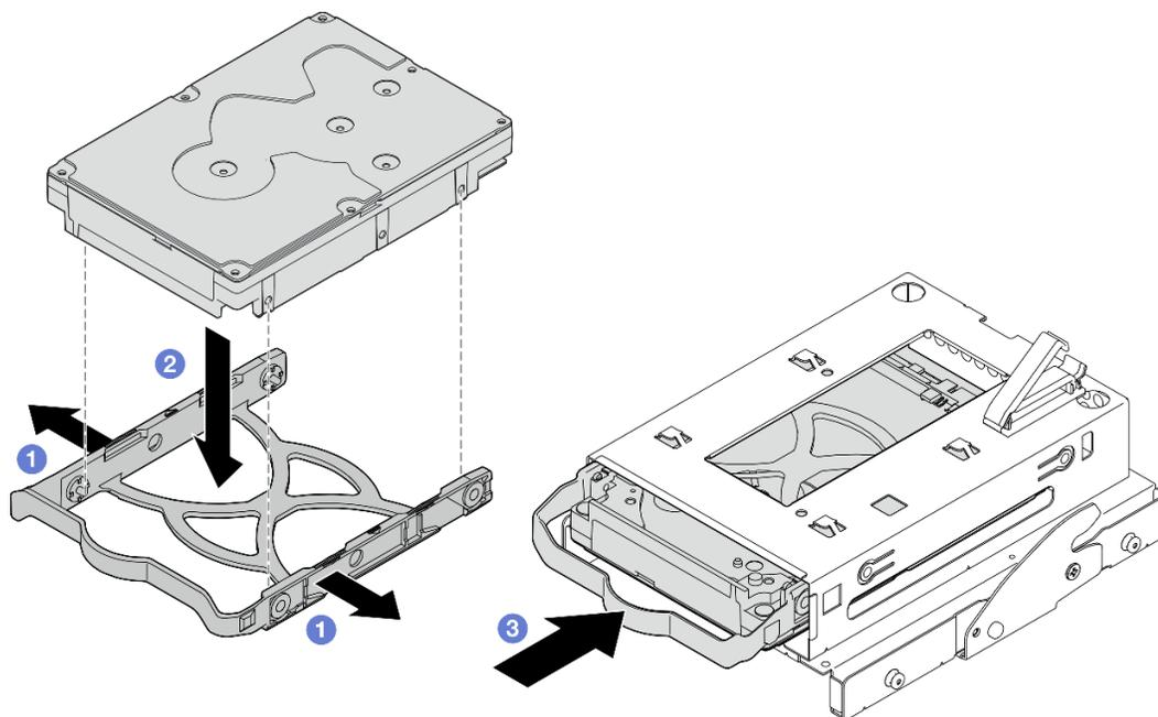
図22. 3.5型ドライブのドライブ・ケージへの取り付け
