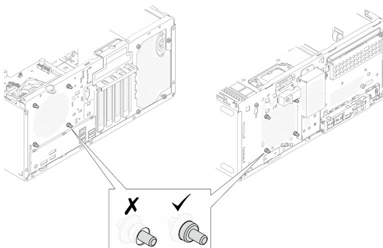
図 57. 前面ファンおよび背面ファンのゴム製マウントの取り付け
