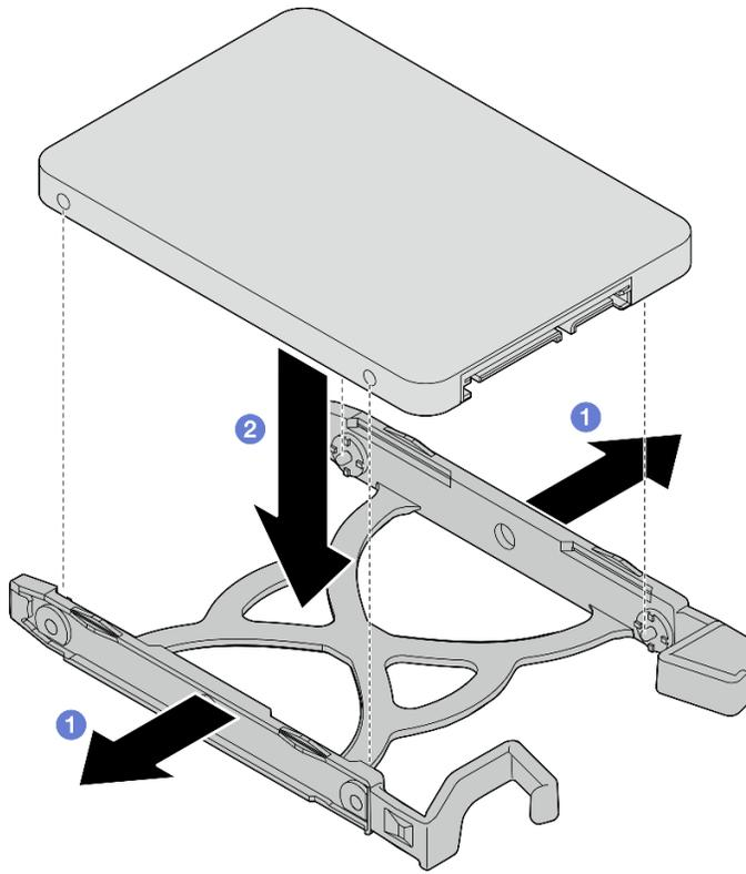
図 10. 2.5 型ドライブを保持器具に取り付ける
