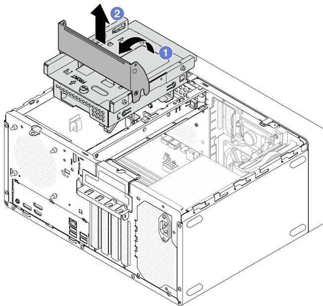
図49. ODD + ベイ2 ドライブ・ケージ・アセンブリーの取り外し
