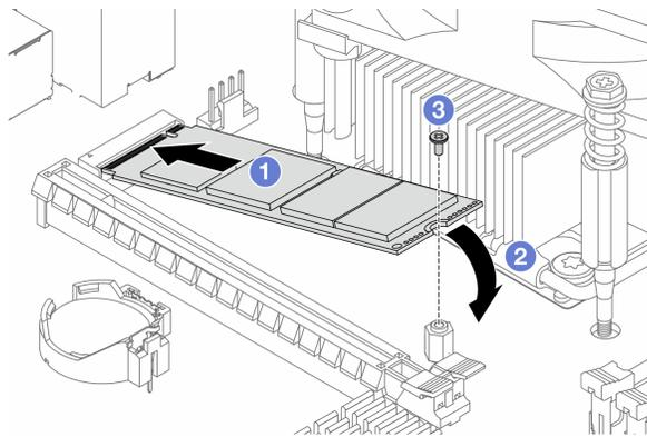
図 64. M.2 ドライブ 1 の取り付け
