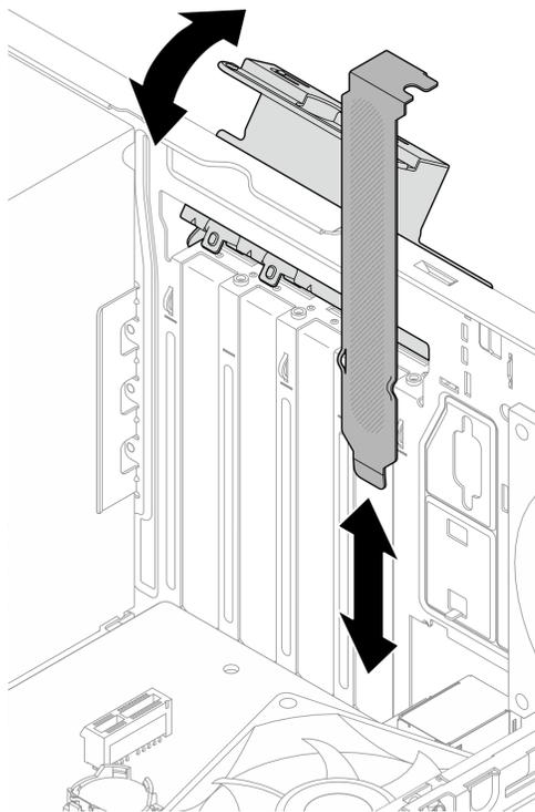
図 78. PCIe アダプター・ブラケットを取り外す
