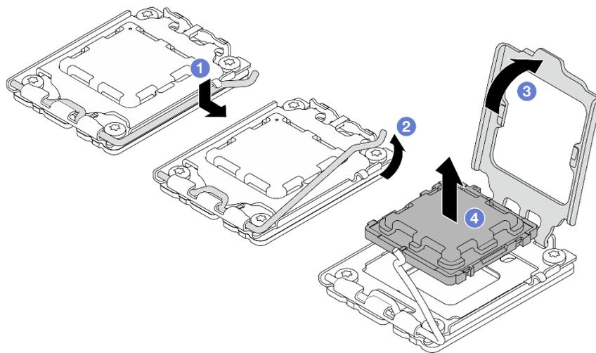
図 90. プロセッサの取り外し
