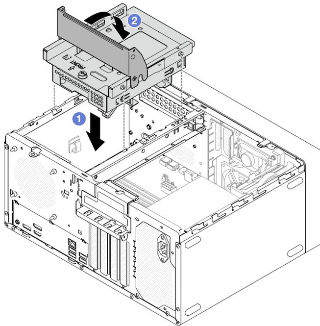
図 53. ODD + ベイ 2 ドライブ・ケージ・アセンブリーの取り付け
