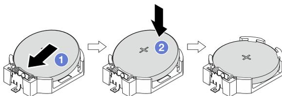
図 3. CMOS バッテリーの取り付け
