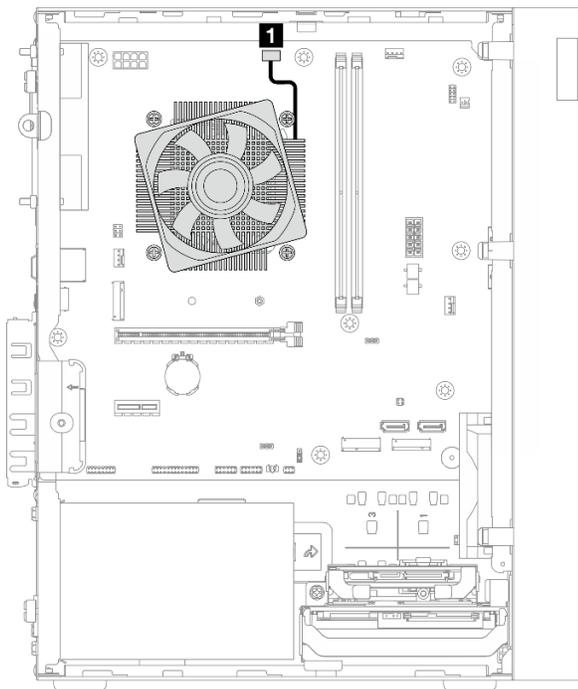
図 114. ヒートシンクおよびファン・モジュールのケーブル配線
