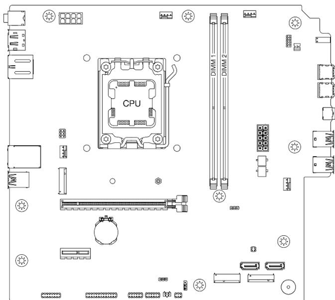
図 1. メモリー・モジュールおよびプロセッサのレイアウト
