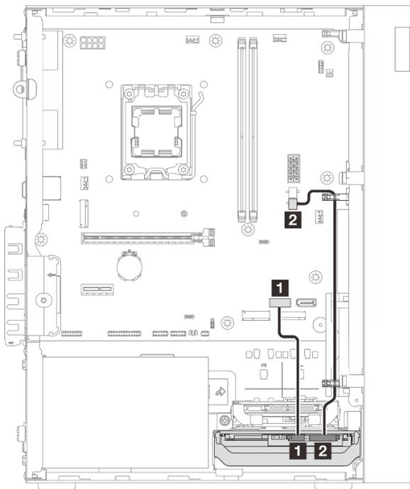
図 108. ベイ 0 ドライブのケーブル配線
