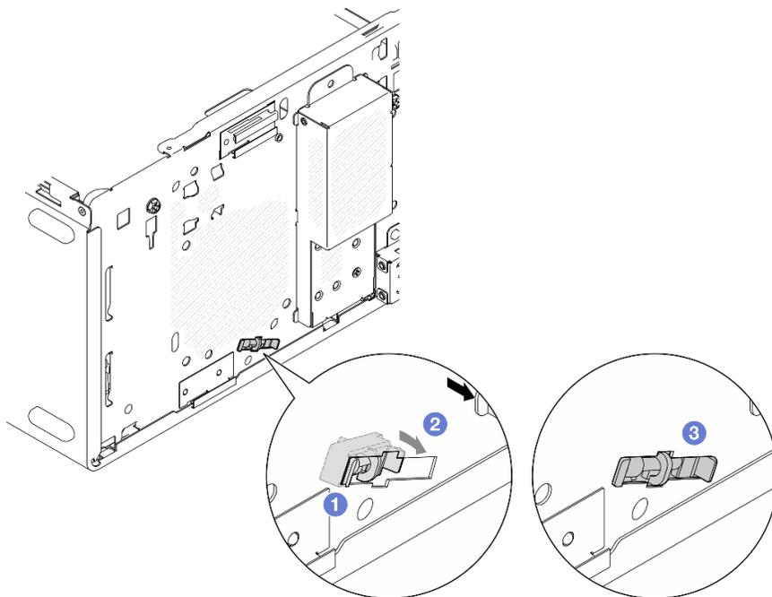
図 107. 温度センサーの取り付け
