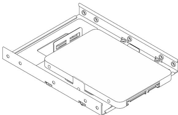
ドライブ・コネクタに近い方のねじ穴がドライブ保持具の外側になるようにしてください。
