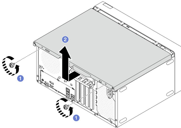
図102. サーバー・カバーの取り外し
