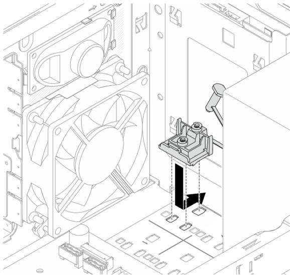
図 67. M.2 ドライブ保持具の取り付け
