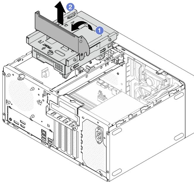
図 25. ODD + ベイ 2 ドライブ・ケージ・アセンブリーの取り外し
