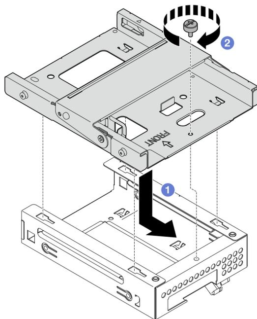
図 52. 光学式ドライブ・ケージのベイ 2 ドライブ・ケージへの取り付け
