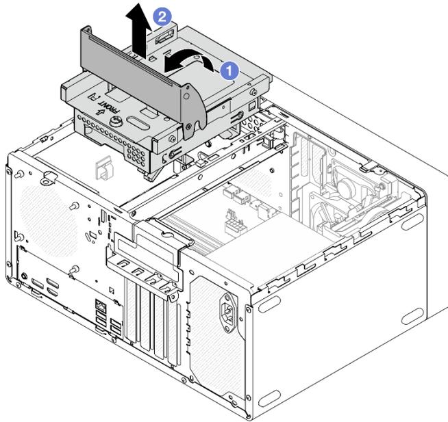
図19. ODD + ベイ2ドライブ・ケージ・アセンブリーの取り外し
