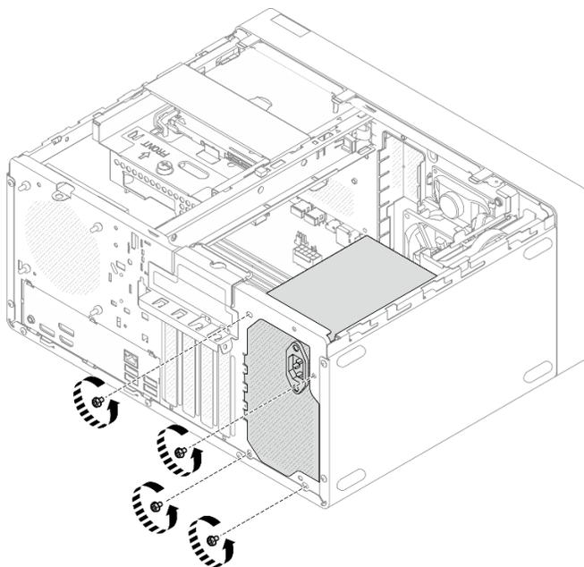
図 86. パワー・サプライ・ユニットを固定しているねじの取り外し
