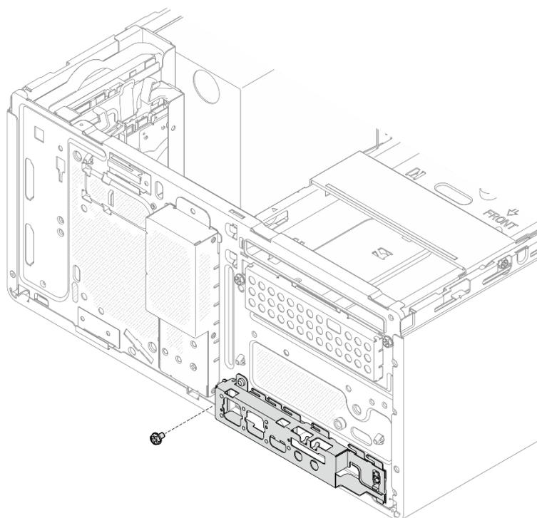
図 85. 前面 I/O ブラケットのシャーシへの固定
