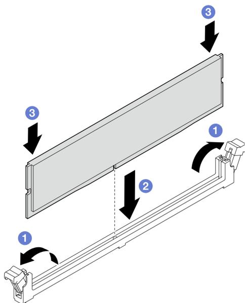
図 73. メモリー・モジュールの取り付け
