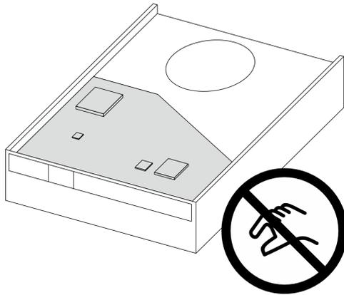
図21. ドライブの回路ボード
