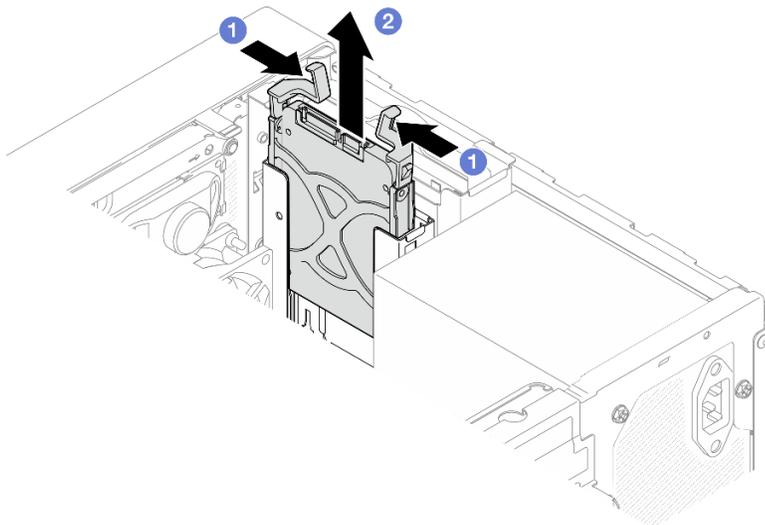
図5. ドライブ・ベイ1からのドライブ・アセンブリーの取り外し
