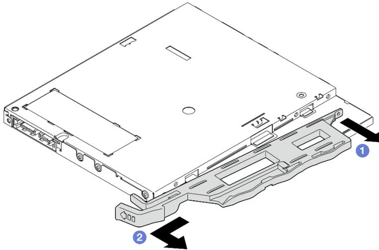
図42. 光学式ドライブ保持具の取り外し
