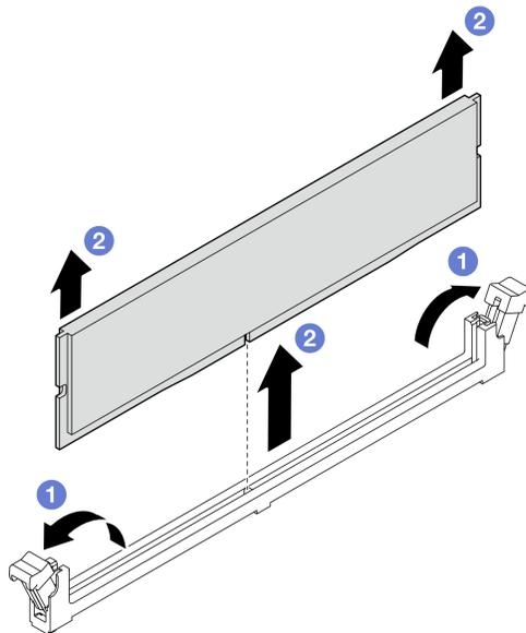
図 70. メモリー・モジュールの取り外し
