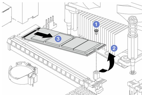
図 62. M.2 ドライブ 1 の取り外し
