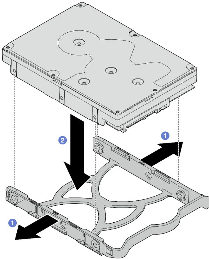
図9. 3.5 型ドライブを保持器具に取り付ける
