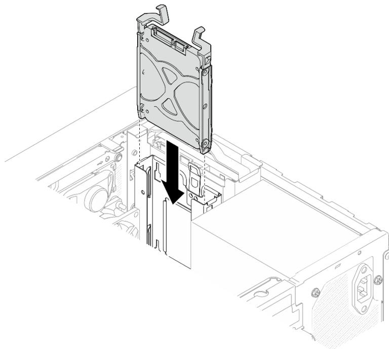
図12. ドライブ・ベイ1への2.5型ドライブ・アセンブリーの取り付け
