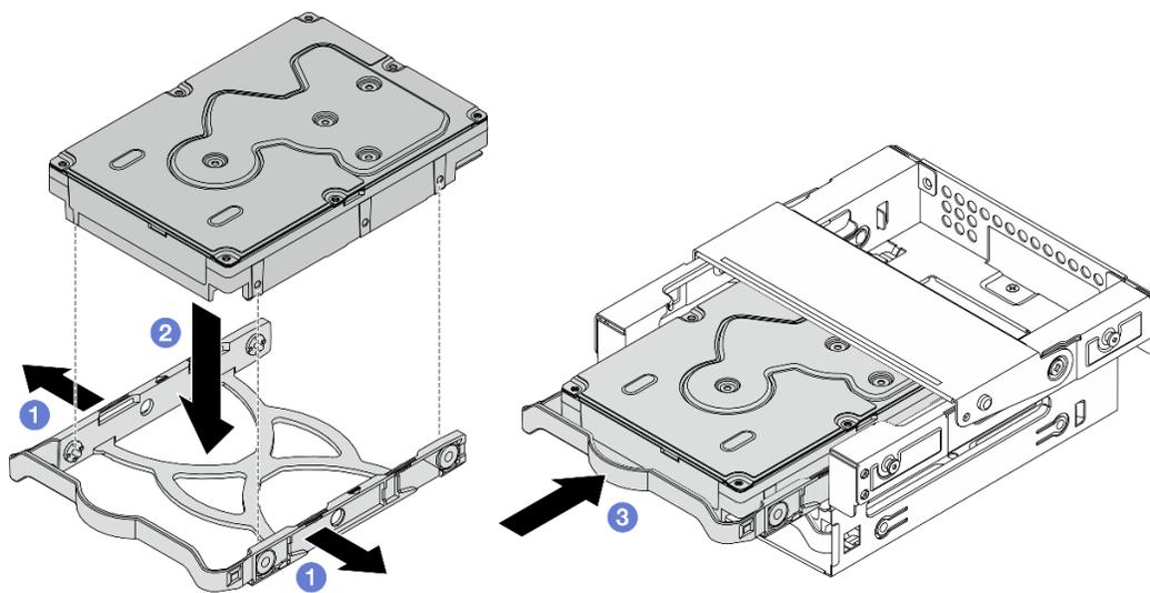
図33. ベイ3ドライブ・ケージへの3.5型ドライブの取り付け
