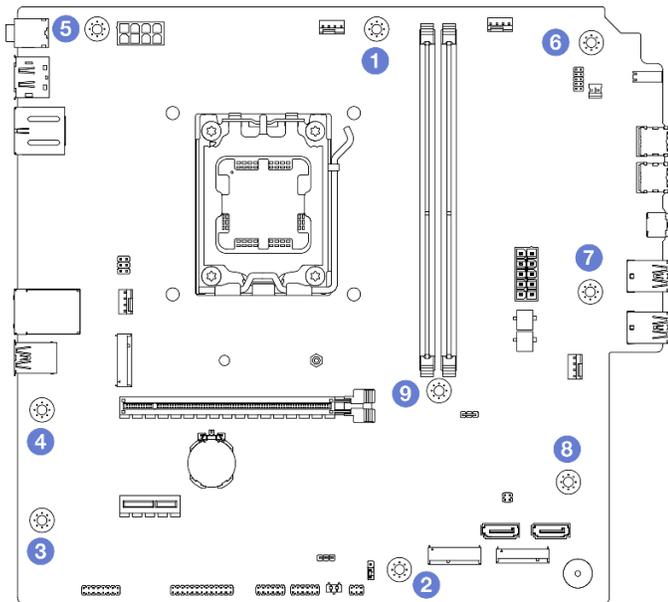
図99. システム・ボードのねじの取り付け順序
