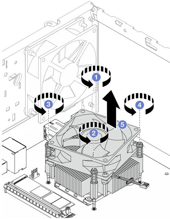
図 60. ヒートシンクおよびファン・モジュールの取り外し
