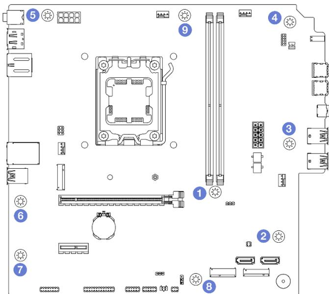
図96. システム・ボードのねじの取り外し順序
