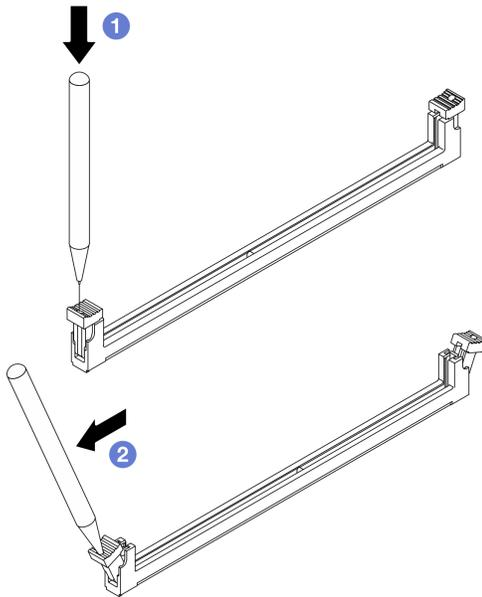
ステップ 3. メモリー・モジュールをスロットに取り付けます。
