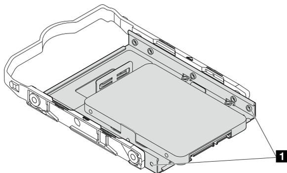
図34. ドライブ保持具のねじ穴の配置
