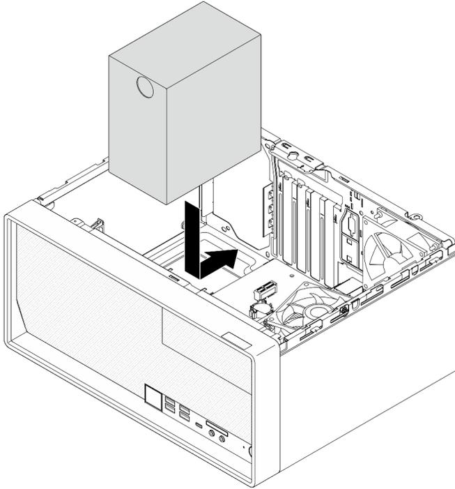
図 88. パワー・サプライ・ユニットのシャーシへの取り付け
