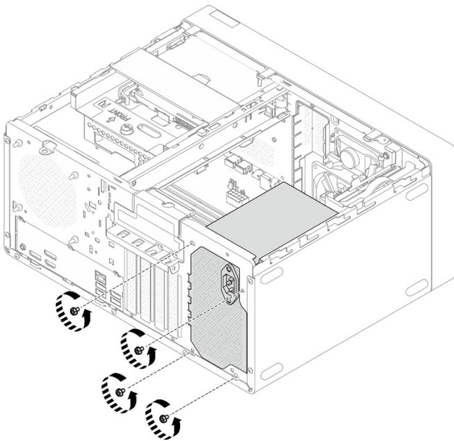
図 89. パワー・サプライ・ユニットのシャーシへの固定
