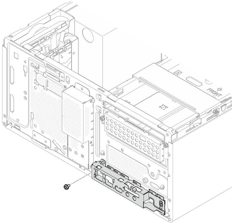
図 101. 前面 I/O ブラケットのシャーシへの固定
