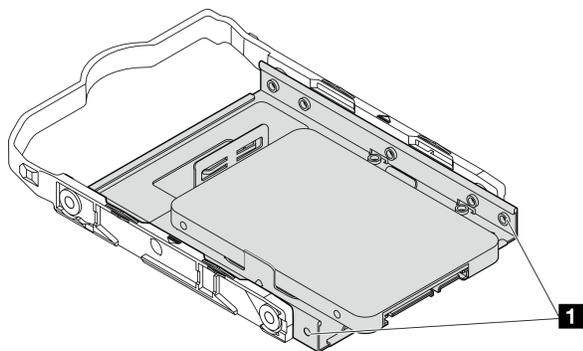
図 23. ドライブ保持具のねじ穴の配置
