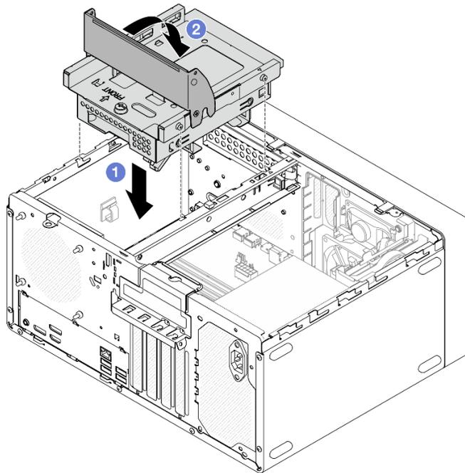
図29. ODD + ベイ2ドライブ・ケージ・アセンブリーの取り付け
