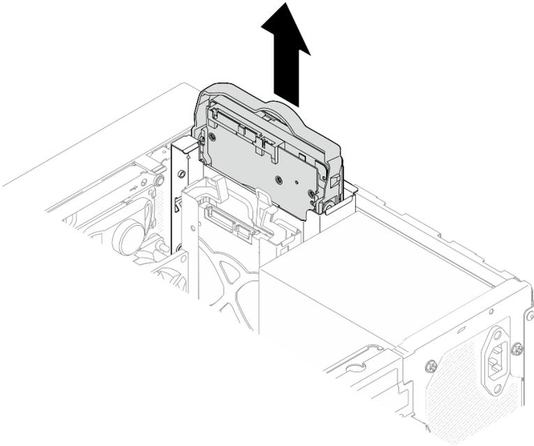
図4. ドライブ・アセンブリーのドライブ・ベイ0からの取り外し
