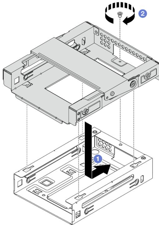
図 39. ベイ 3 ドライブ・ケージのベイ 2 ドライブ・ケージへの取り付け
