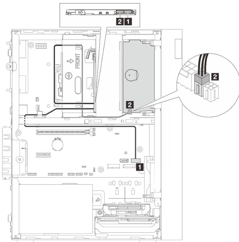
図 110. 光学式ディスク・ドライブのケーブル配線
