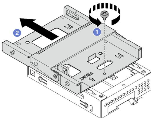
図 50. ベイ 2 ドライブ・ケージからの光学式ドライブ・ケージの取り外し
