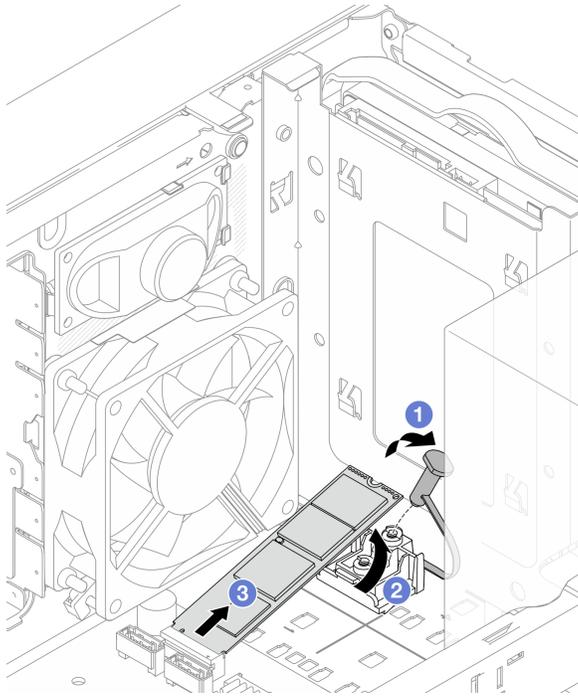
図 63. M.2 ドライブ 2 の取り外し
