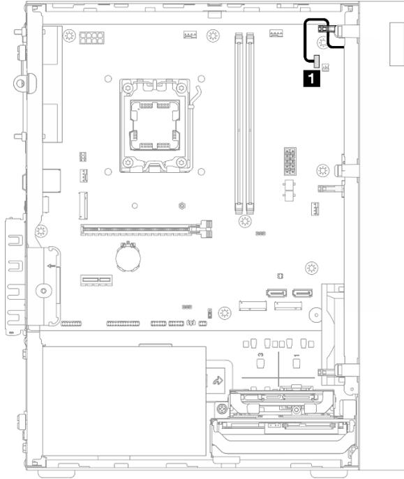
図 117. LED 付き電源ボタンのケーブル配線
