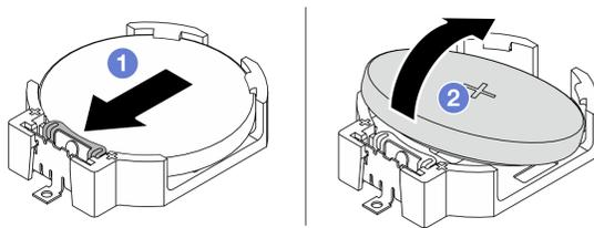
図 2. CMOS バッテリーの取り外し
