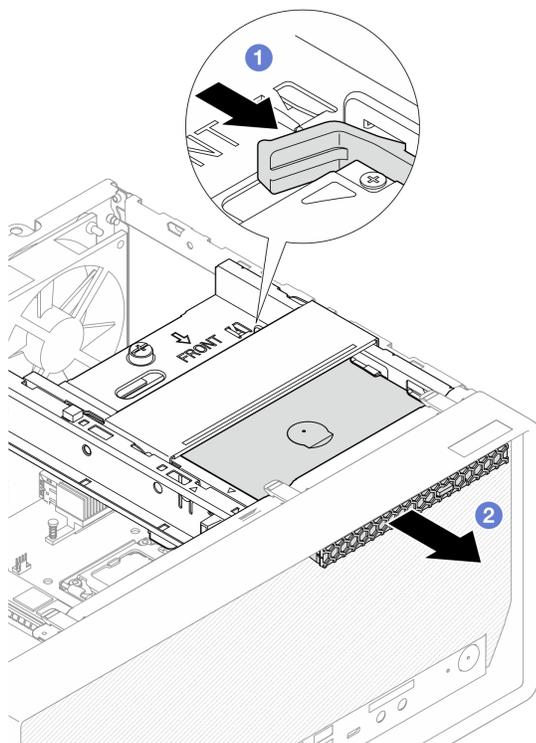
図 41. 光学式ドライブの取り外し
