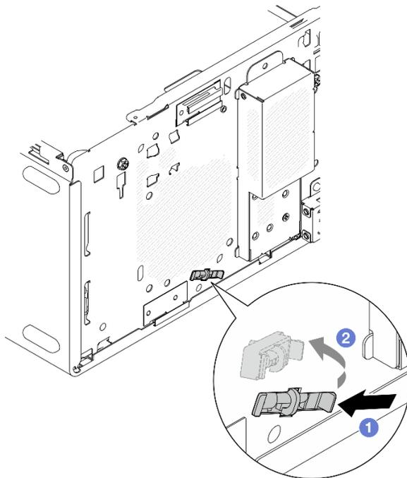
図 106. 温度センサーの取り外し
