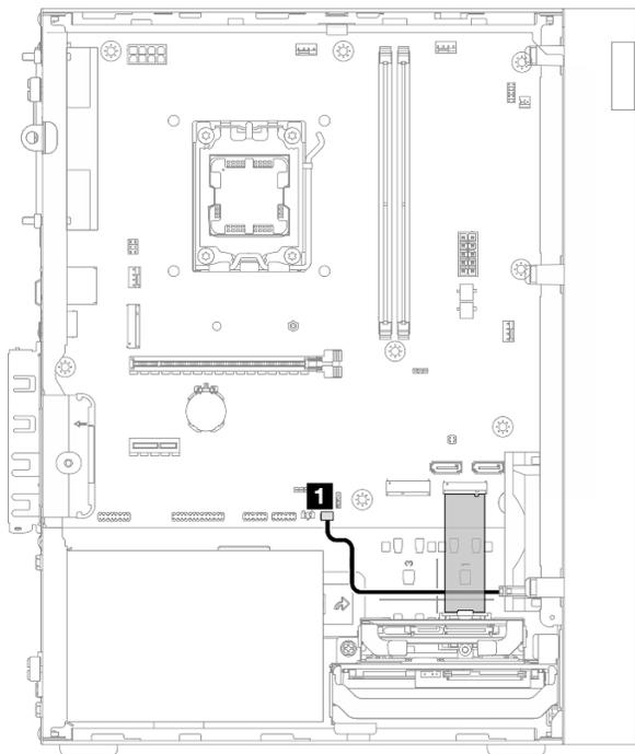
図 115. 温度センサーのケーブル配線
