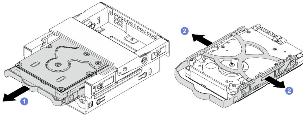
図31. 3.5型ドライブの取り外し
