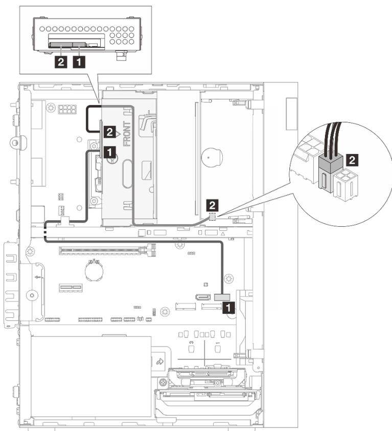
図 109. ベイ 2 ドライブのケーブル配線
