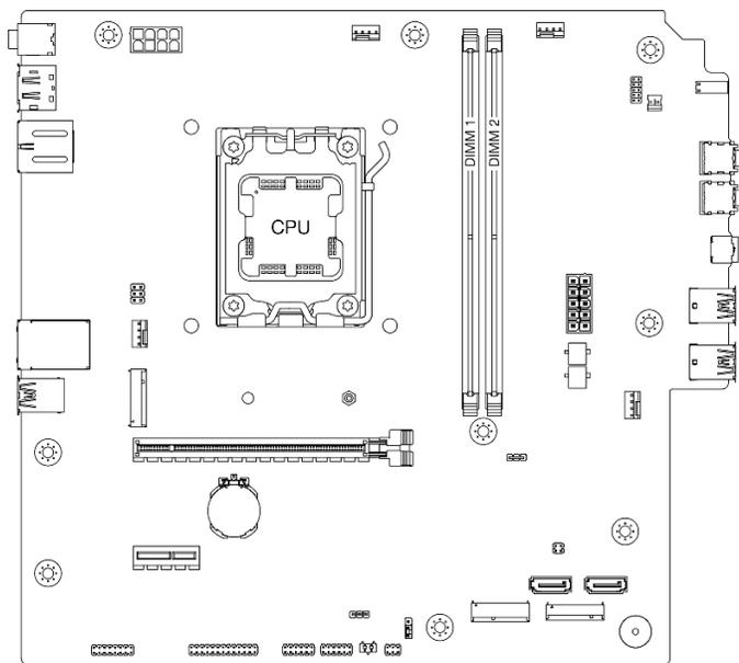
図 68. メモリー・モジュールおよびプロセッサのレイアウト
