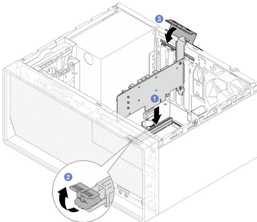
図 79. PCIe アダプターの取り付け
