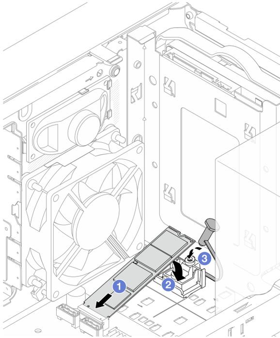
図 65. M.2 ドライブ 2 の取り付け
