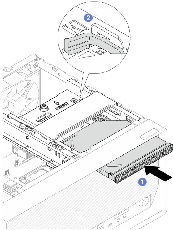
図48. 光学式ドライブの取り付け
