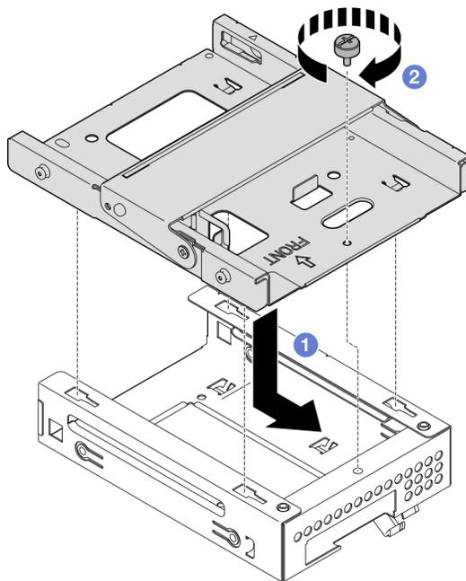
図28. 光学式ドライブ・ケージのベイ 2 ドライブ・ケージへの取り付け
