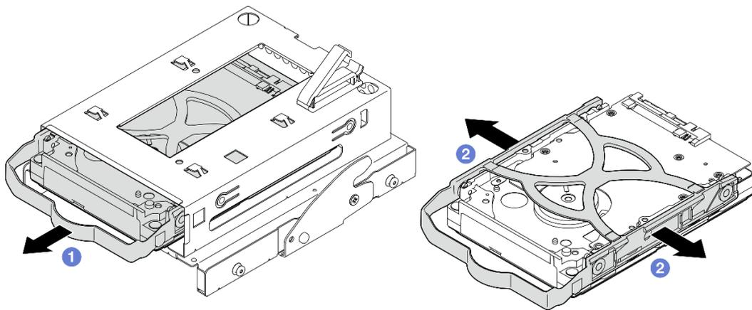
図20. 3.5型ドライブの取り外し
