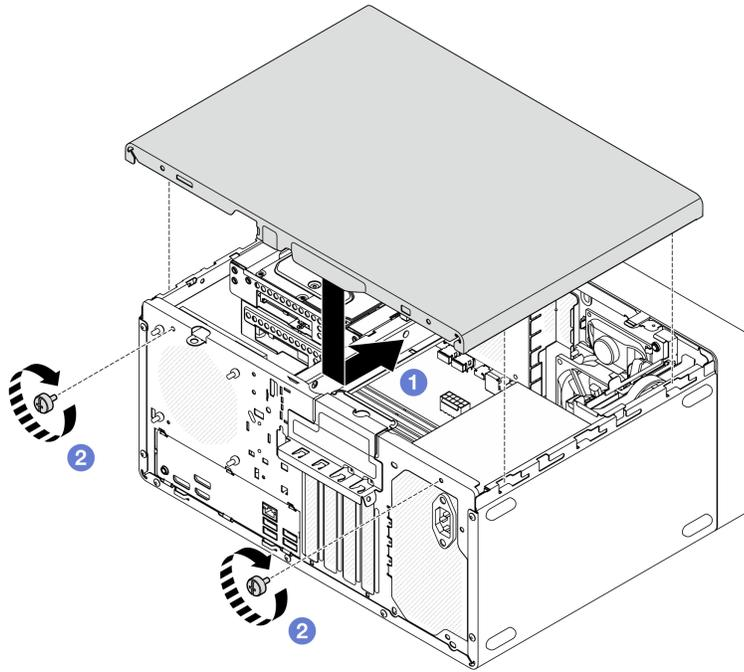
図 105. サーバー・カバーの取り付け
