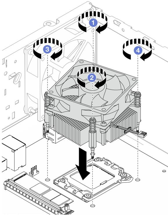
図61. ヒートシンクおよびファン・モジュールの取り付け
