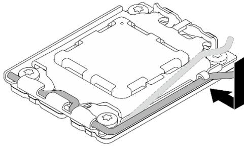
図93. プロセッサ保持器具を閉じる
