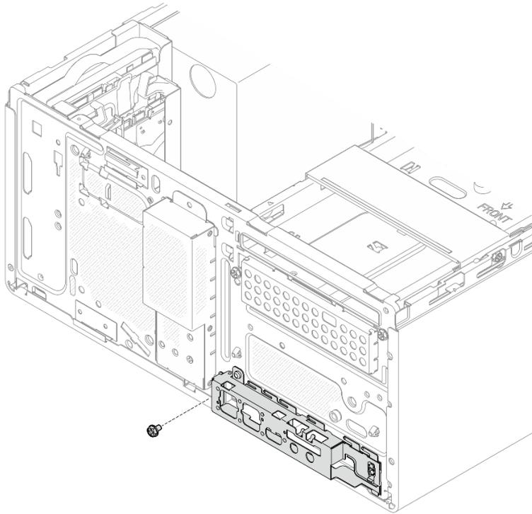
図 94. 前面 I/O ブラケットを固定しているねじの取り外し
