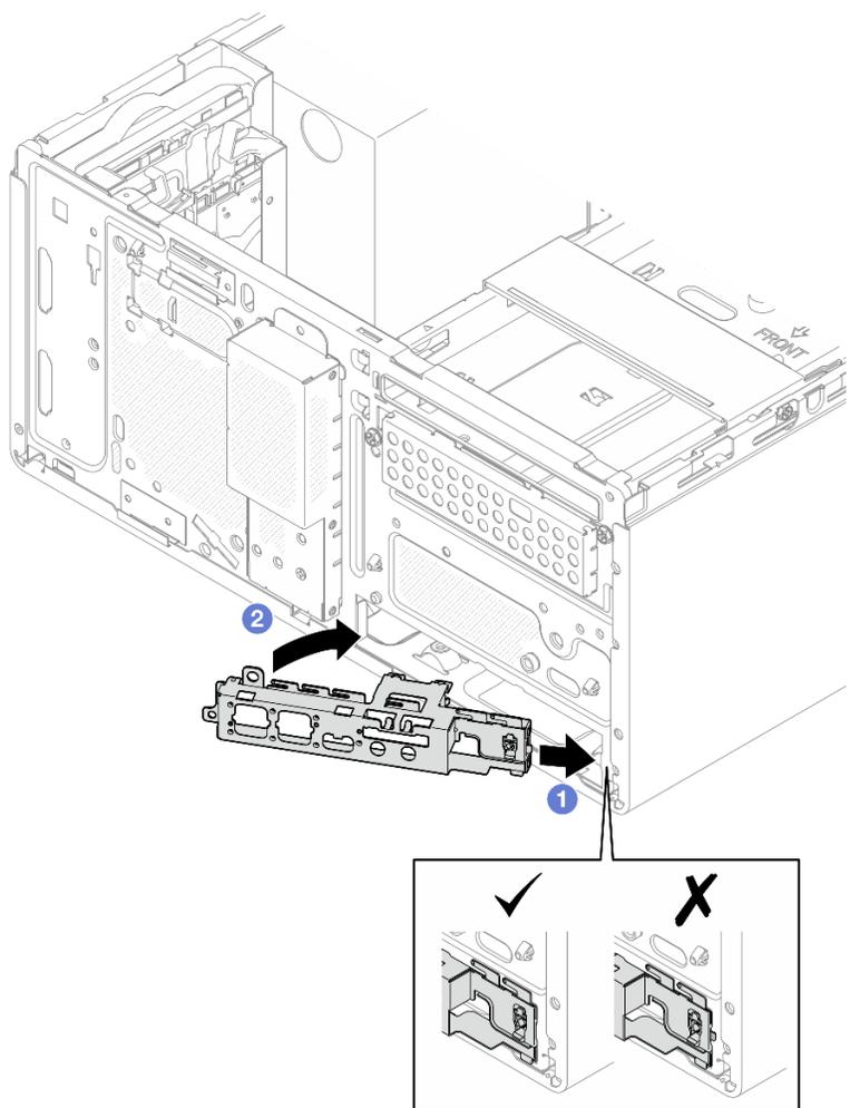
図 84. 前面 I/O ブラケットのシャーシへの取り付け
