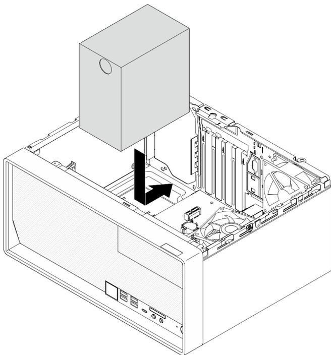
Рис. 88. Установка модуля блока питания в раму
