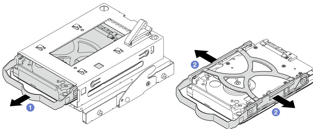
Рис. 20. Снятие 3,5-дюймового диска
