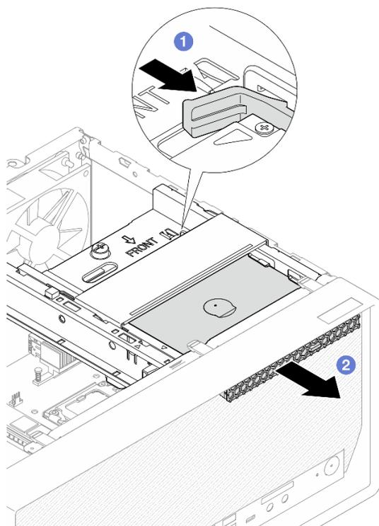
Рис. 41. Снятие дисководов для оптических дисков
