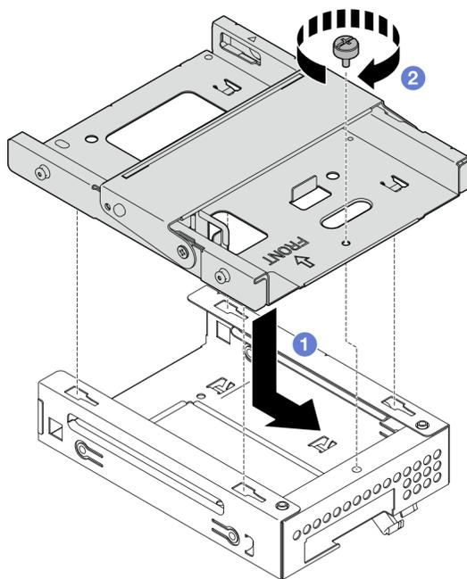
Рис. 52. Установка отсека дисководов для оптических дисков в отсек для диска отсека 2
