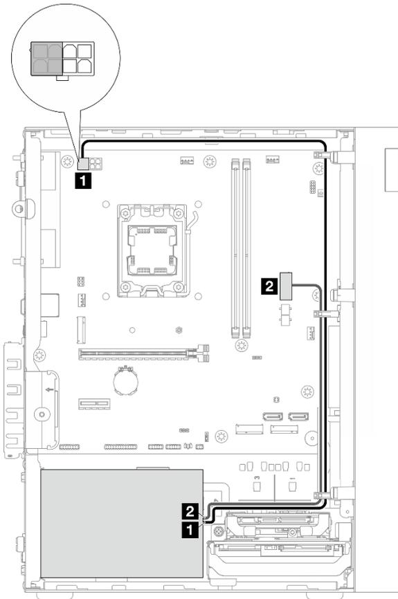
Рис. 112. Прокладка кабелей для модуля блока питания
