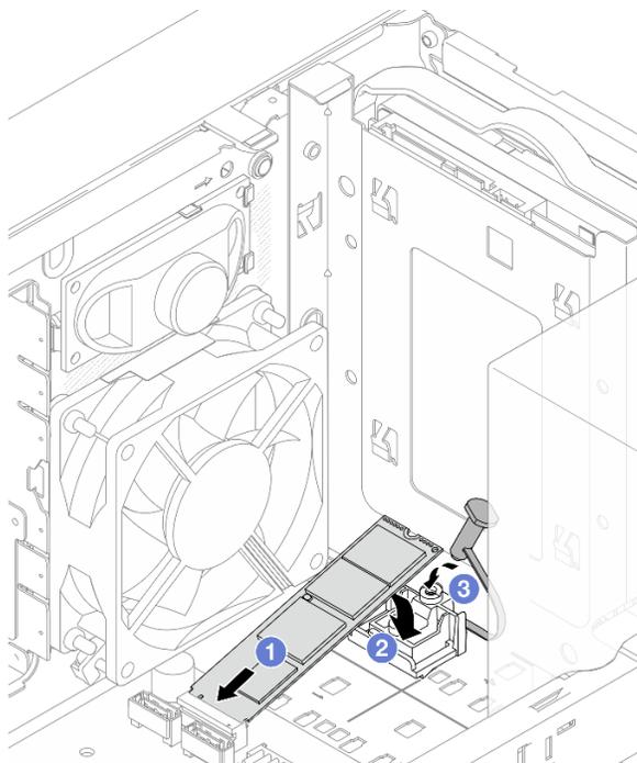
Рис. 65. Установка диска M.2 2
