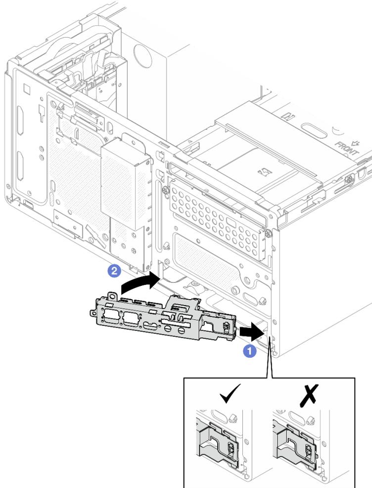
Рис. 84. Установка передней скобы ввода-вывода на раму
