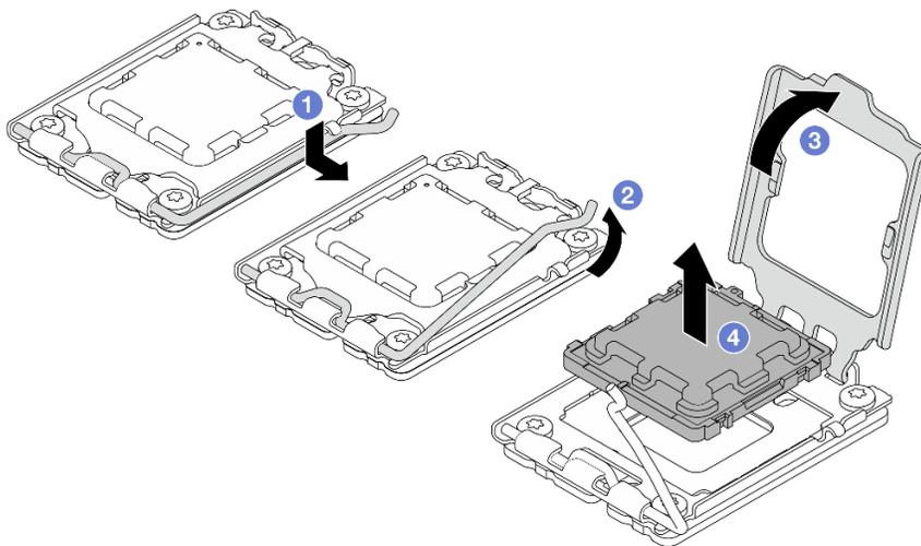
Рис. 90. Снятие процессора
