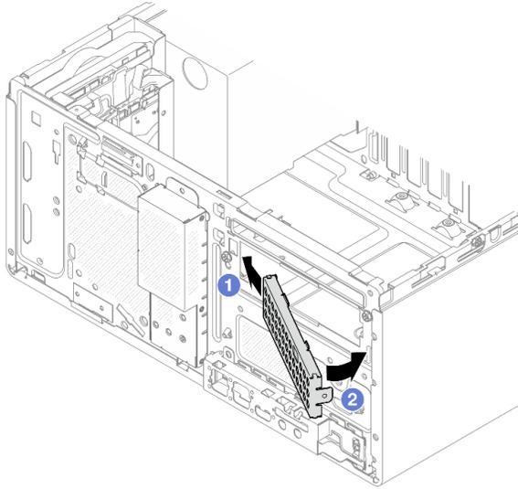
Рис. 51. Установка экрана защиты от электромагнитных помех
