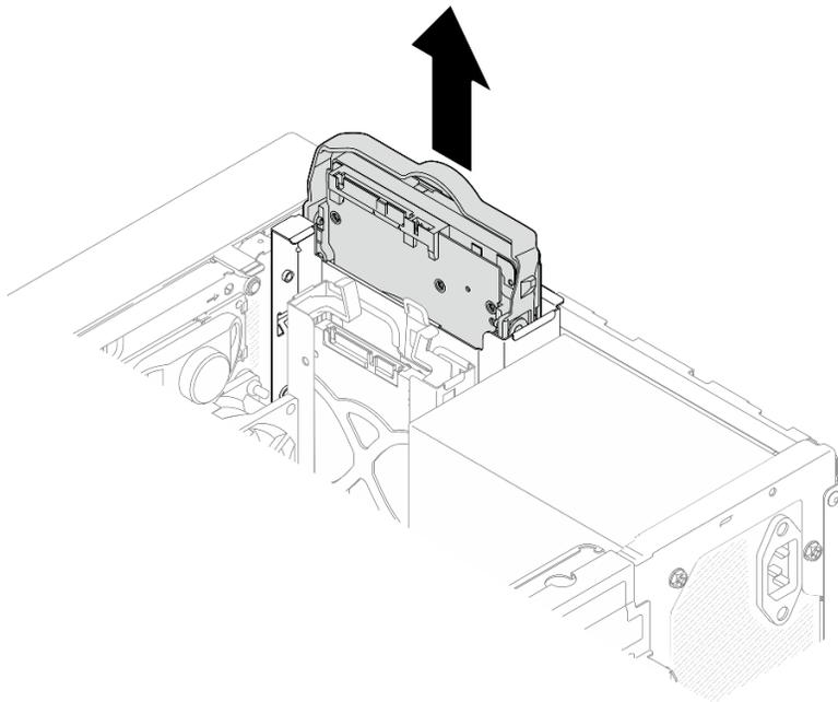
Рис. 4. Снятие блока диска с отсека для диска 0
