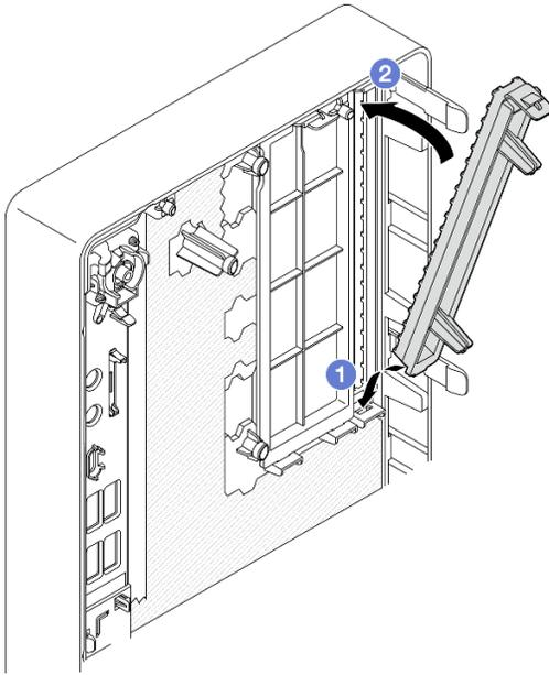
Рис. 44. Установка защитного экрана отсека дисководов для оптических дисков
