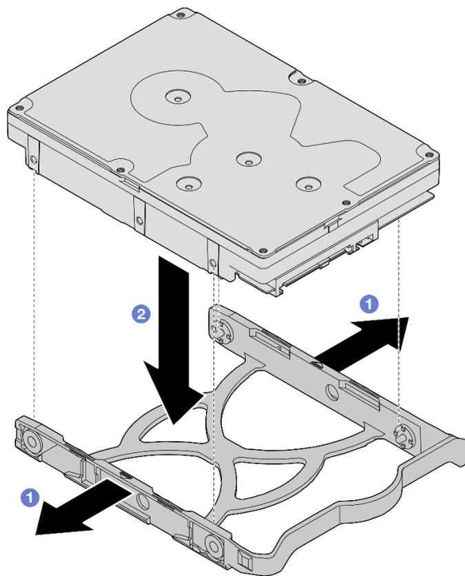
Рис. 9. Установка 3,5-дюймового диска в фиксатор
