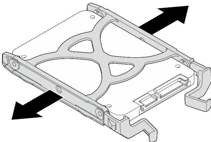
Рис. 7. Снятие 2,5-дюймового диска с фиксатора
