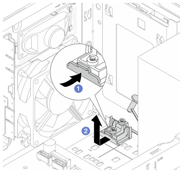
Рис. 66. Снятие фиксатора дисководов M.2
