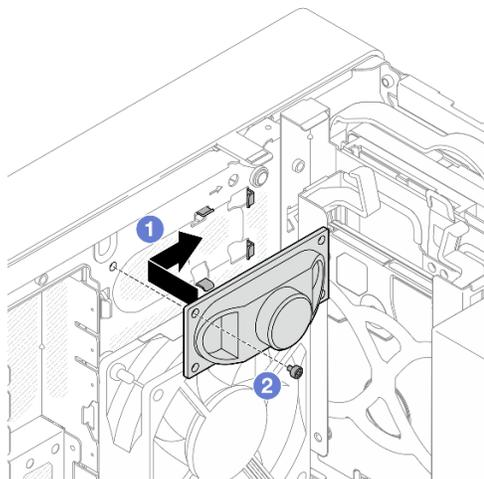
Рис. 75. Установка моноусилителя
