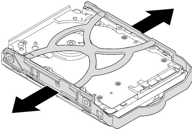
Рис. 6. Извлечение 3,5-дюймового диска из фиксатора
