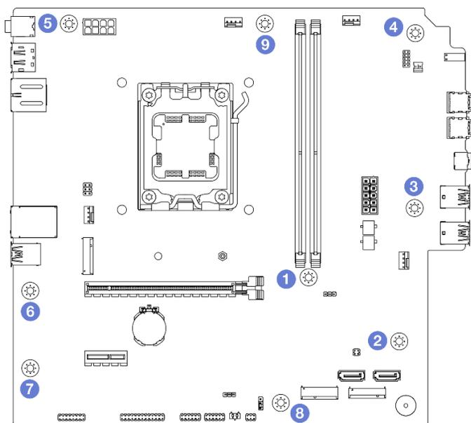
Рис. 96. Последовательность снятия винтов с материнской платы
