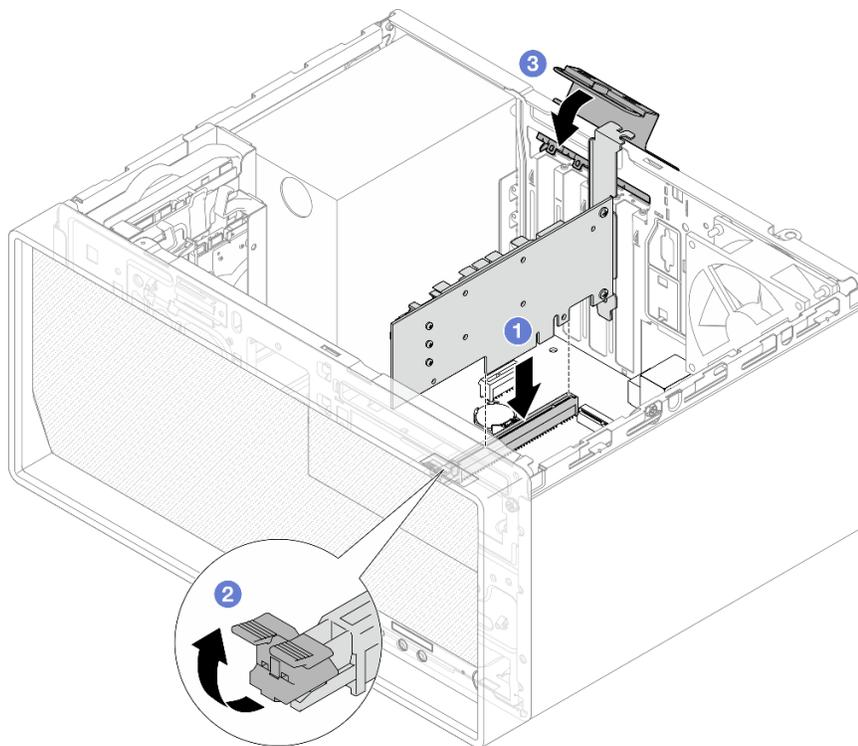
Рис. 79. Установка адаптера PCIe
