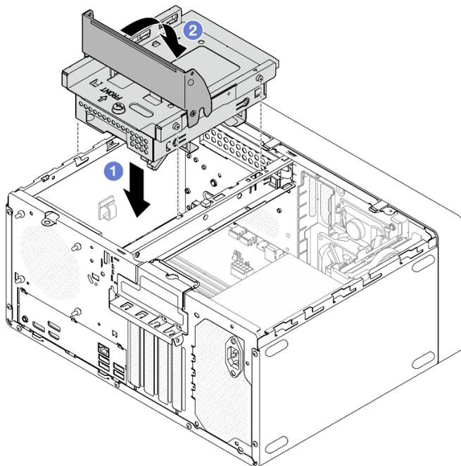
Рис. 29. Установка блока отсека для диска дисковода оптических дисков и отсека 2
