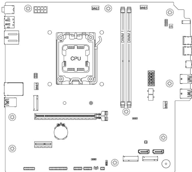
Рис. 1. Расположение модулей памяти и процессора
