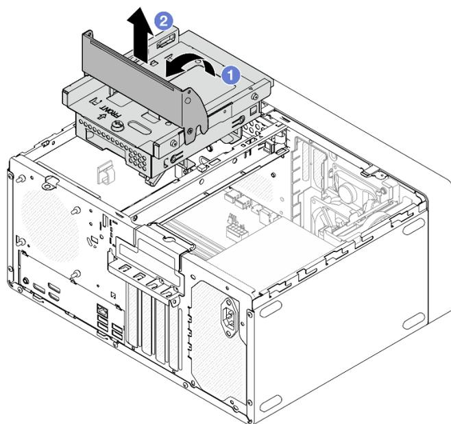
Рис. 19. Снятие блока отсека для диска дисководов оптических дисков и отсека 2
