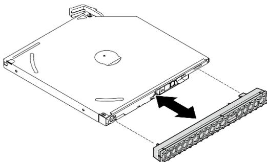
Рис. 47. Установка панели дисковод для оптических дисков
