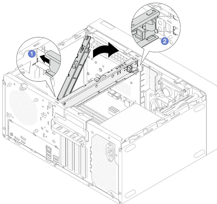
Рис. 104. Установка планки для отсека
