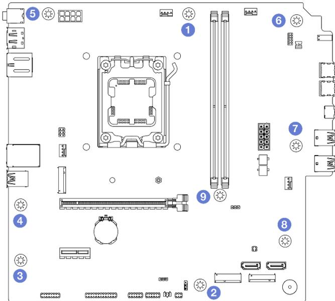
Рис. 99. Последовательность установки винтов материнской платы
