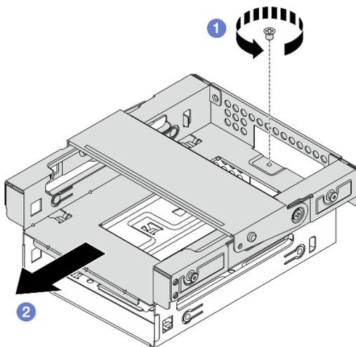
Рис. 37. Снятие отсека для диска отсека 3
