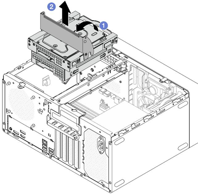
Рис. 36. Снятие блока отсека для диска отсеков 2 и 3
