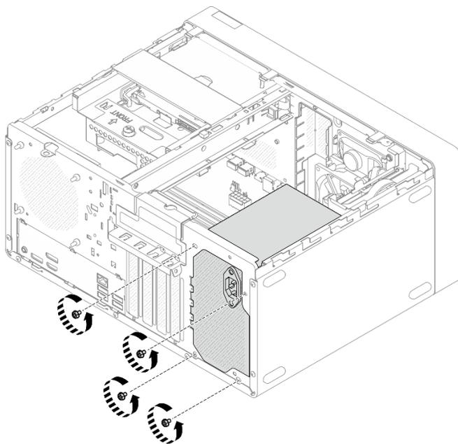
Рис. 89. Фиксация модуля блока питания на раме
