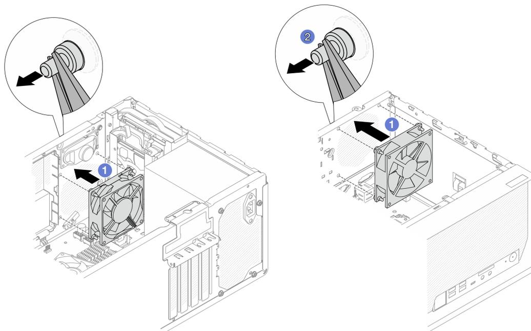
Рис. 56. Установка переднего или заднего вентилятора
