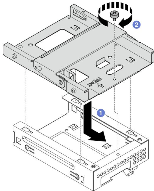
Рис. 28. Установка отсека дисководов для оптических дисков в отсек для диска отсека 2
