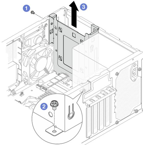
Рис. 15. Снятие отсека для диска отсека 0
