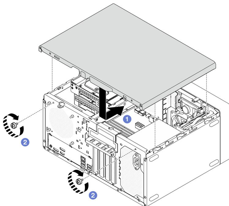
Рис. 105. Установка кожуха сервера
