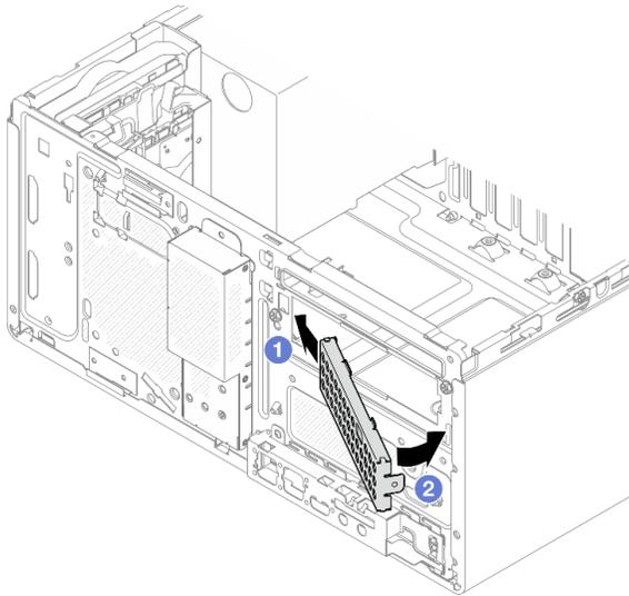
Рис. 38. Установка экрана защиты от электромагнитных помех
