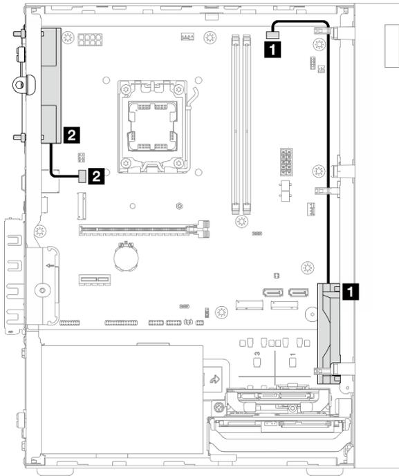
Рис. 113. Прокладка кабелей для переднего и заднего вентиляторов
