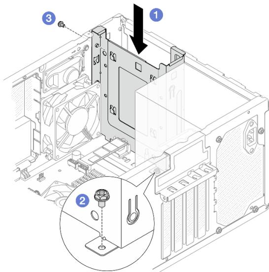
Рис. 16. Установка отсека для диска в отсек 0
