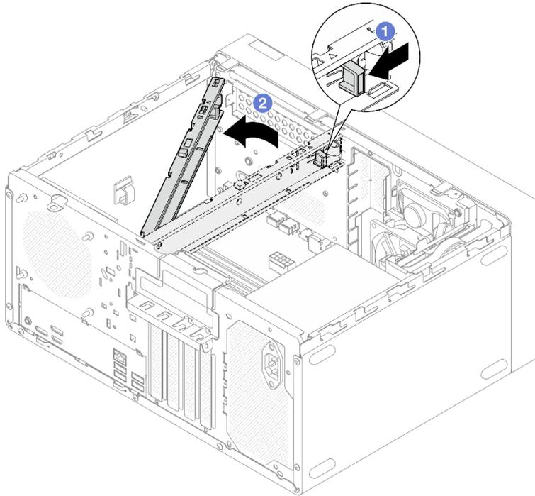
Рис. 103. Снятие планки для отсека
