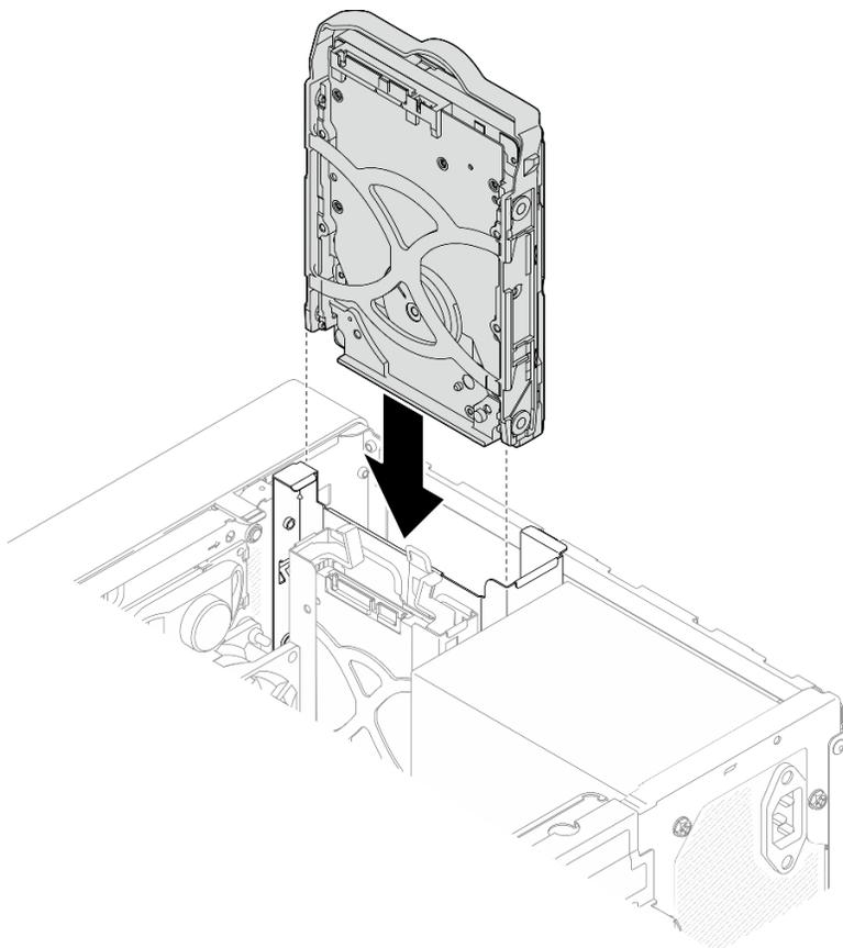
Рис. 11. Установка блока 3,5-дюймового диска в отсек для диска 0
