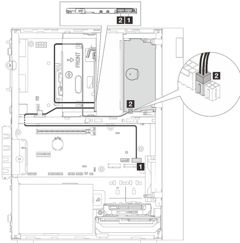
Рис. 110. Прокладка кабелей для дисководов для оптических дисков
