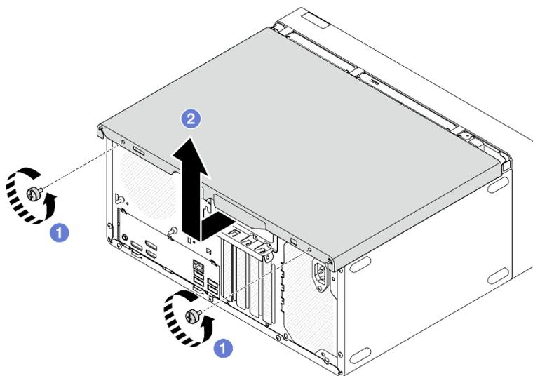
Рис. 102. Снятие кожуха сервера
