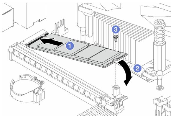
Рис. 64. Установка диска M.2 1
