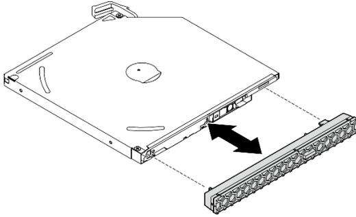
Рис. 43. Снятие панели дисководов для оптических дисков
