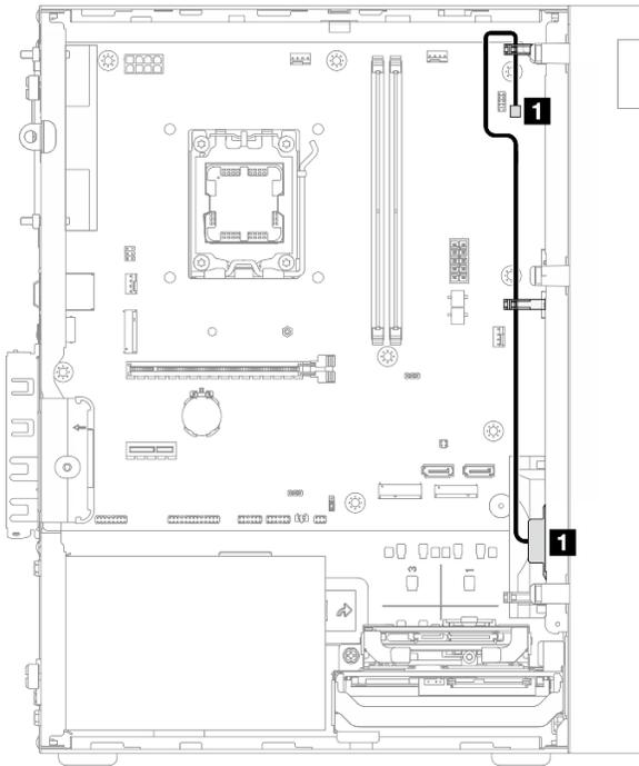
Рис. 116. Прокладка кабеля для моноусилителя
