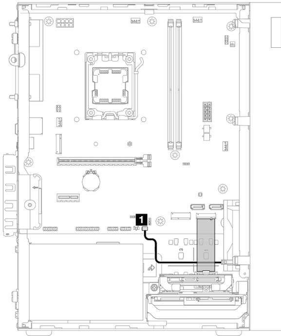
Рис. 115. Прокладка кабеля для датчика температуры
