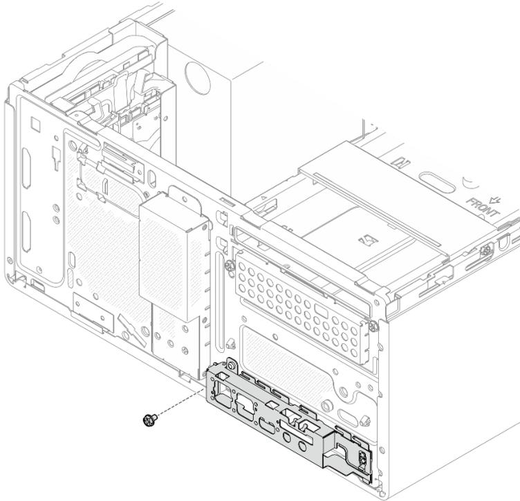
Рис. 94. Снятие винта, фиксирующего переднюю скобу ввода-вывода
