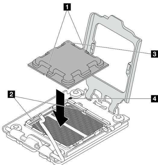
Рис. 92. Установка процессора
