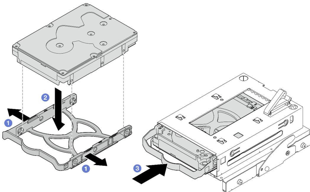
Рис. 22. Установка 3,5-дюймового диска в отсек для диска
