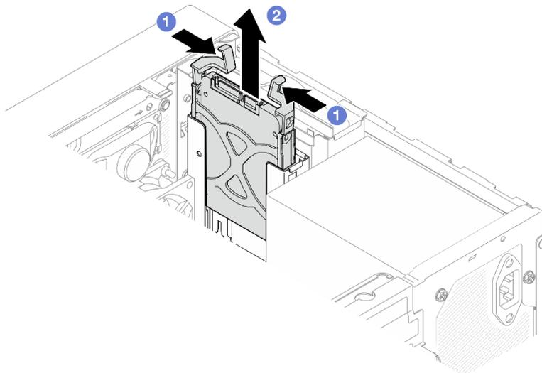
Рис. 5. Извлечение блока диска из отсека для диска 1
