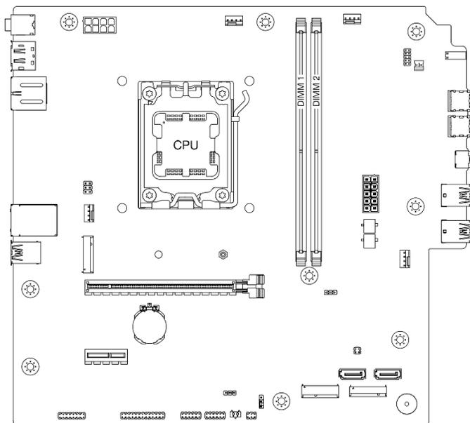
Рис. 71. Расположение модулей памяти и процессора
