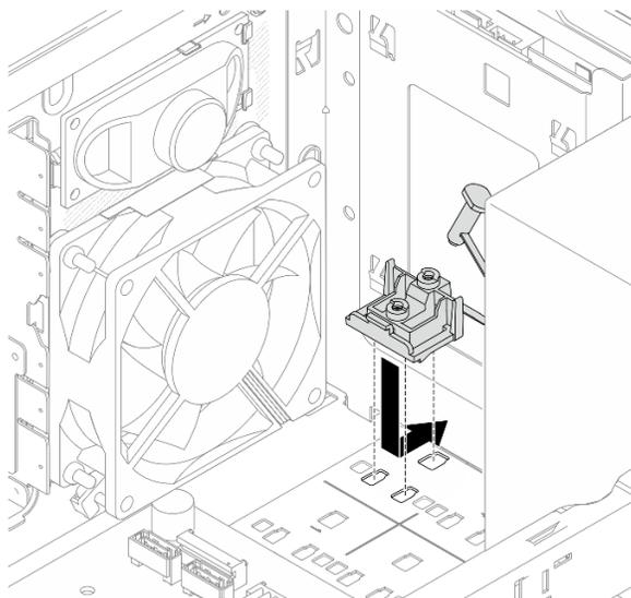
Рис. 67. Установка фиксатора дисководов M.2
