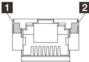
Рис. 119. Светодиодные индикаторы порта Ethernet (RJ-45 10/100/1000 Мбит/с)
