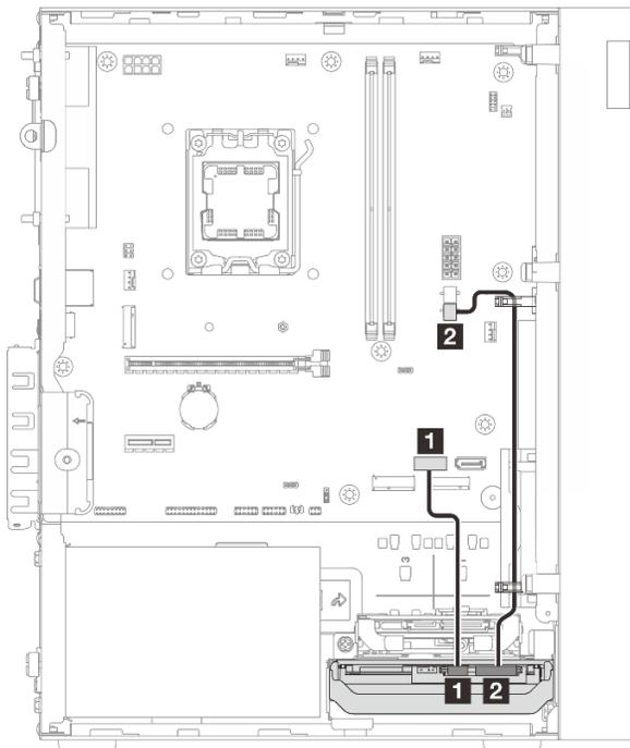
Рис. 108. Прокладка кабелей для диска в отсеке 0
