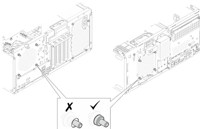
Рис. 57. Установка резиновых креплений переднего и заднего вентиляторов
