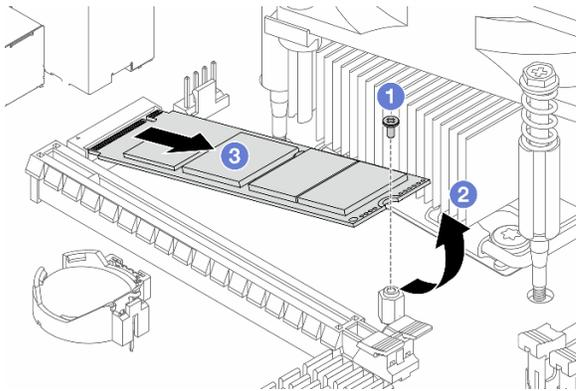
Рис. 62. Снятие диска M.2 1
