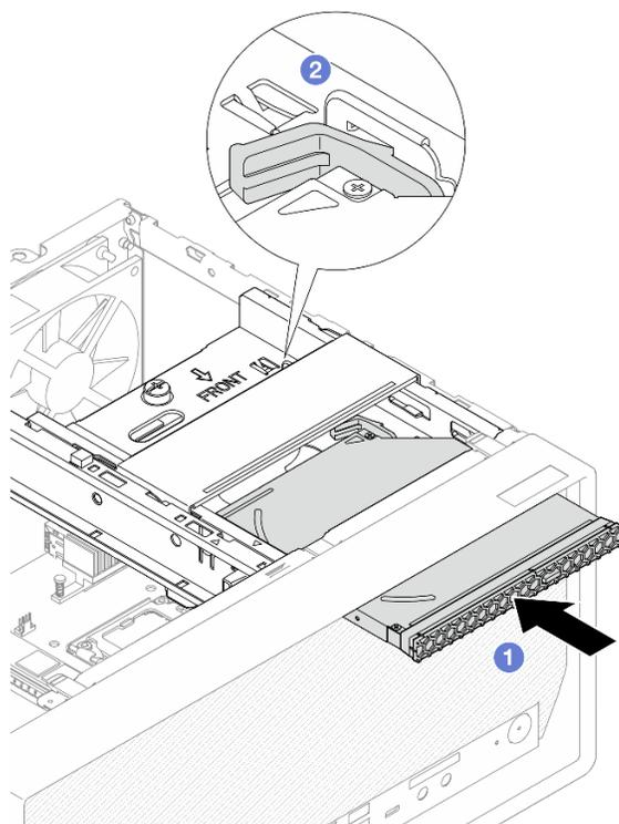
Рис. 48. Установка дисковод для оптических дисков
