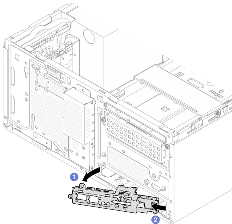
Рис. 95. Снятие передней скобы ввода-вывода с рамы
