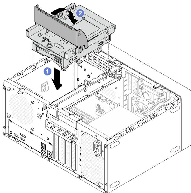
Рис. 24. Установка блока отсека для диска дисководов оптических дисков и отсека 2
