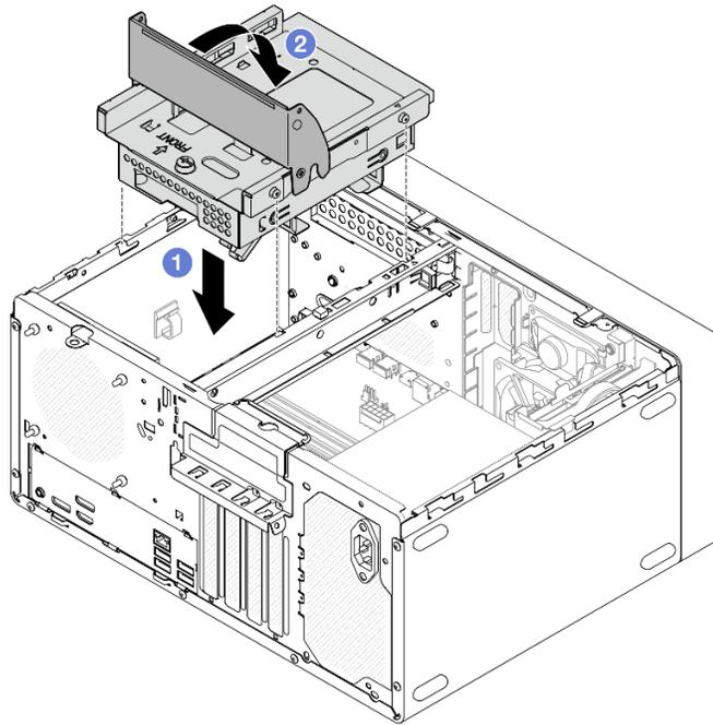
Рис. 53. Установка блока отсека для диска дисководов оптических дисков и отсека 2
