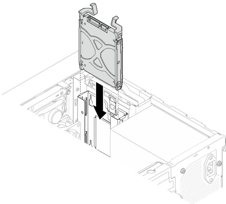
Рис. 12. Установка блока 2,5-дюймового диска в отсек для диска 1
