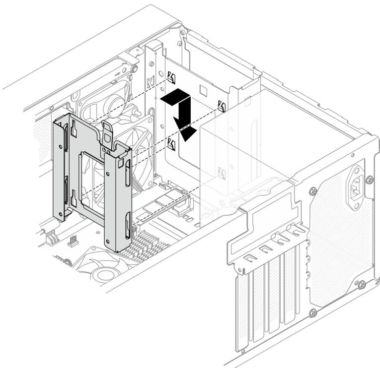
Рис. 18. Установка отсека для диска в отсек 1
