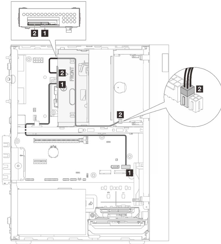
Рис. 109. Прокладка кабелей для диска в отсеке 2
