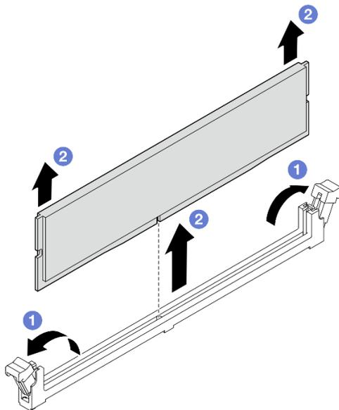
Рис. 70. Снятие модуля памяти
