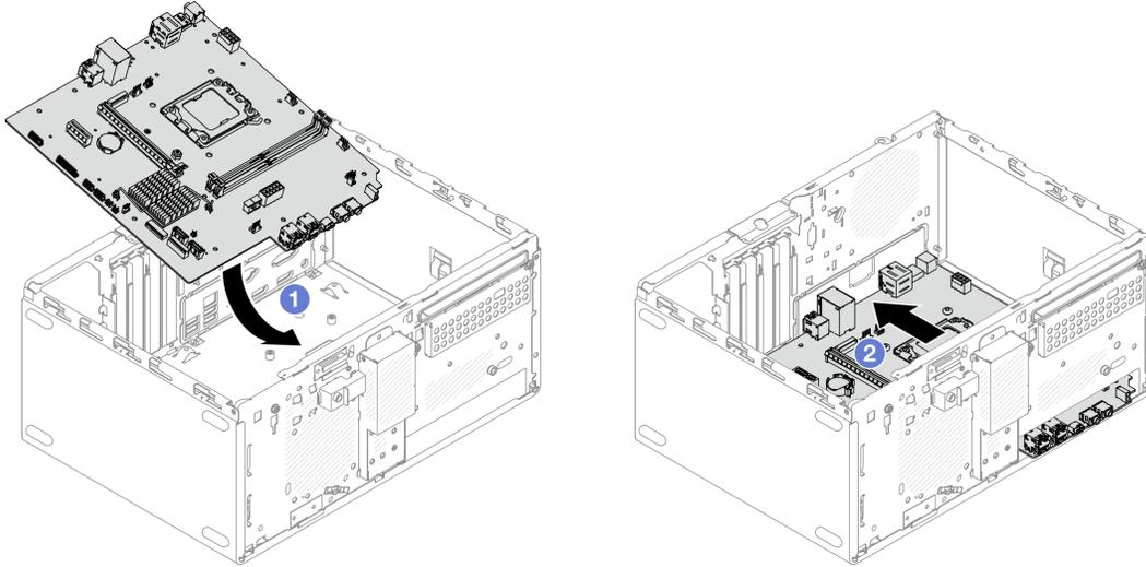
Рис. 98. Установка материнской платы в раму
