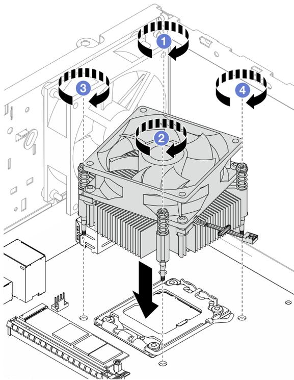
Рис. 61. Установка модуля радиатора и вентилятора
