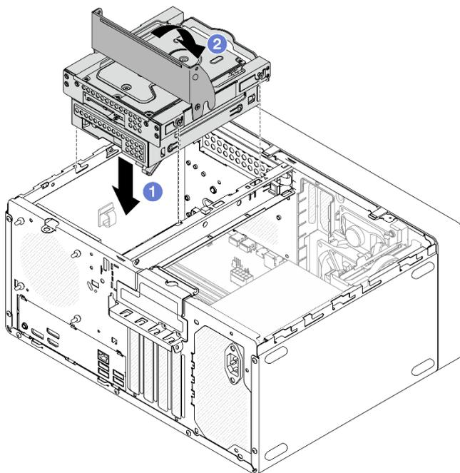
Рис. 35. Установка блока отсека для диска отсеков 2 и 3
