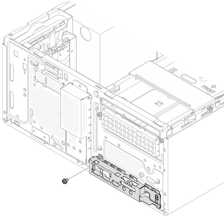
Рис. 85. Фиксация передней скобы ввода-вывода на раме
