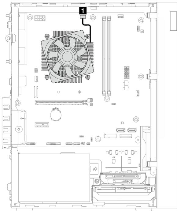
Рис. 114. Прокладка кабеля для модуля радиатора и вентилятора
