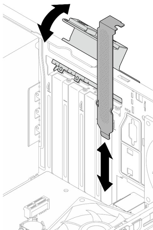
Рис. 78. Снятие скобы адаптера PCIe
