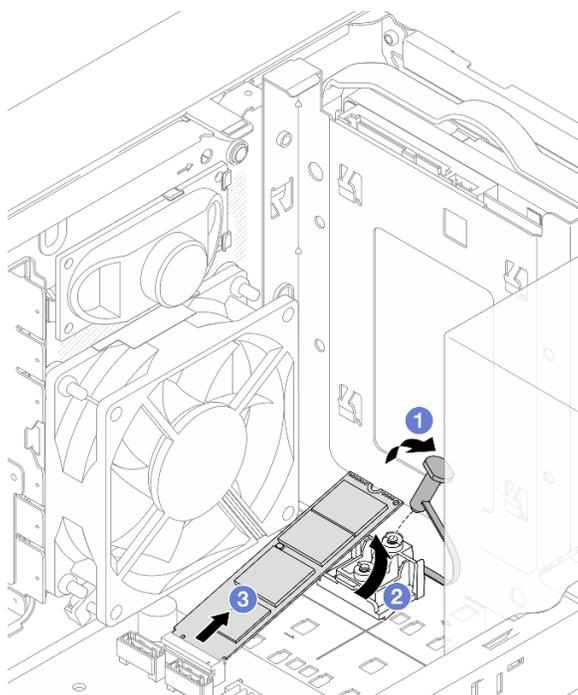
Рис. 63. Снятие диска M.2 2
