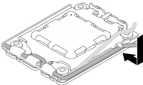
Рис. 93. Закрытие фиксатора процессора
