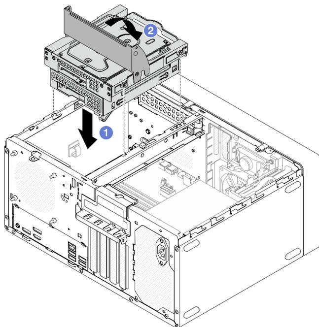
Рис. 40. Установка блока отсека для диска отсеков 2 и 3
