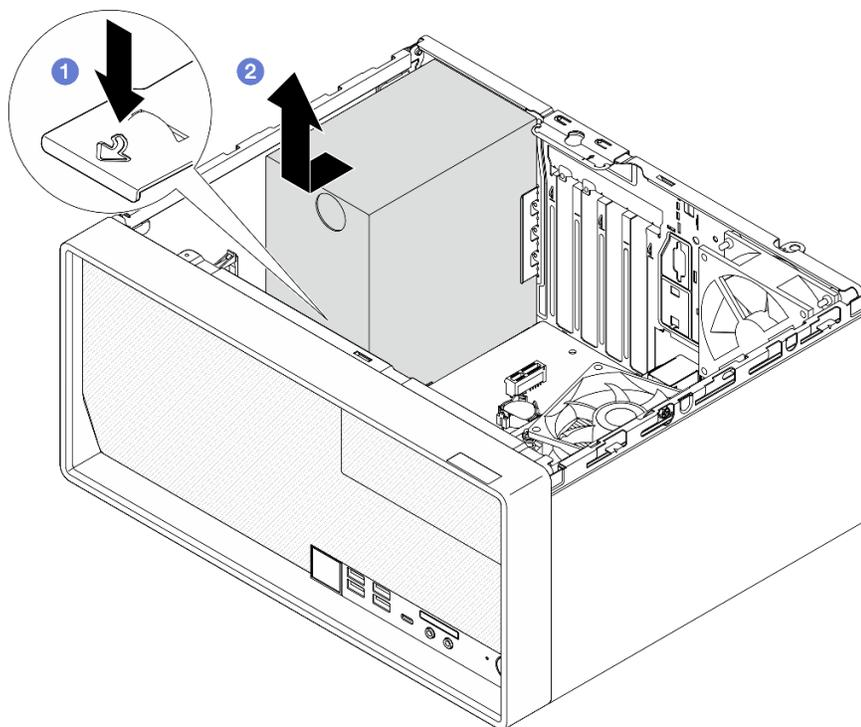
Рис. 87. Снятие блока питания
