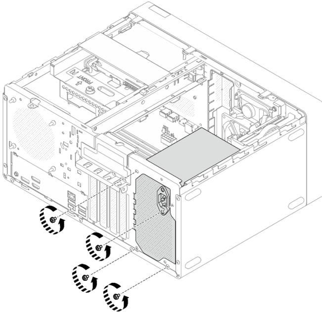
Рис. 86. Снятие винтов, фиксирующих модуль блока питания
