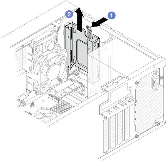
Рис. 13. Снятие отсека для диска отсека 1
