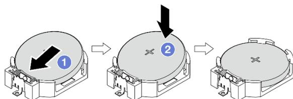
Рис. 3. Установка батарейки CMOS
