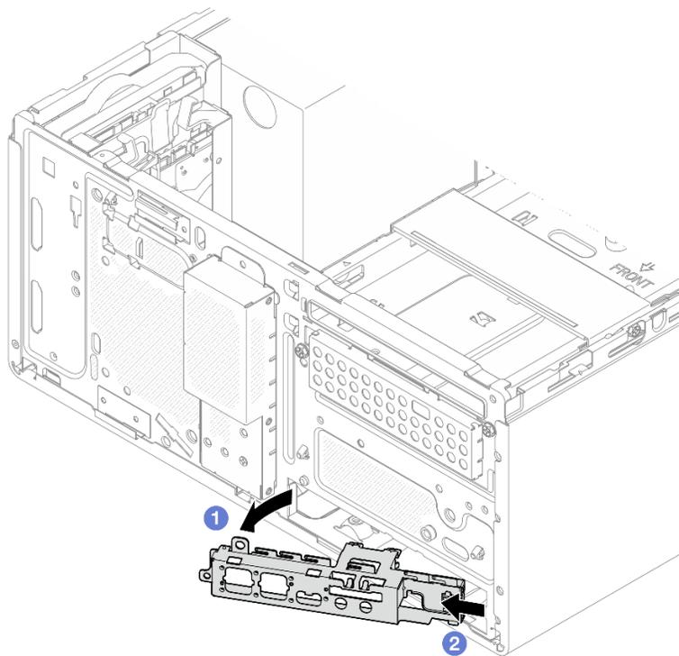
Рис. 81. Снятие передней скобы ввода-вывода с рамы
