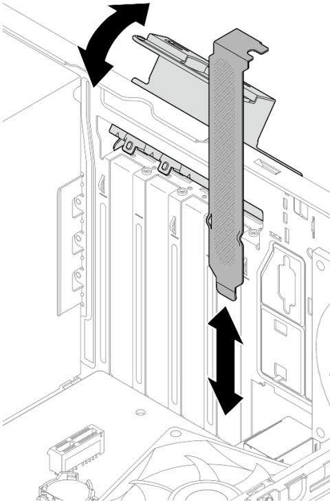
Рис. 77. Установка скобы адаптера PCIe
