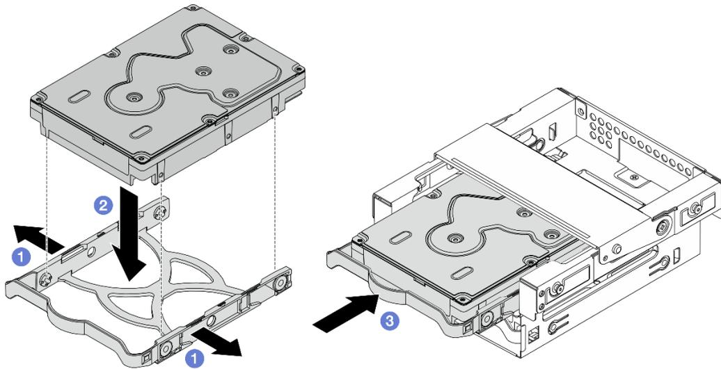
Рис. 33. Установка 3,5-дюймового диска в отсек для диска отсека 3
