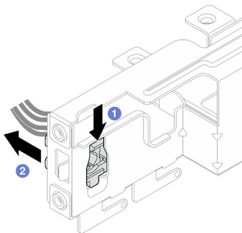
Рис. 82. Снятие кнопки питания со светодиодным индикатором
