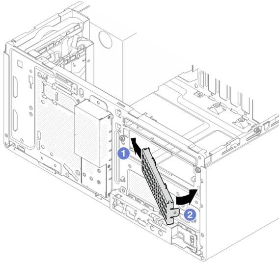
Рис. 27. Установка экрана защиты от электромагнитных помех
