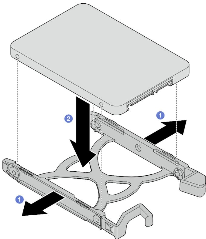
Рис. 10. Установка 2,5-дюймового диска в фиксатор
