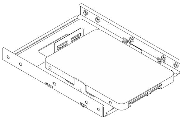
Обеспечьте, чтобы отверстия для винтов, ближайšie к разъему диска, находились **за пределами** фиксатора дисководов.
