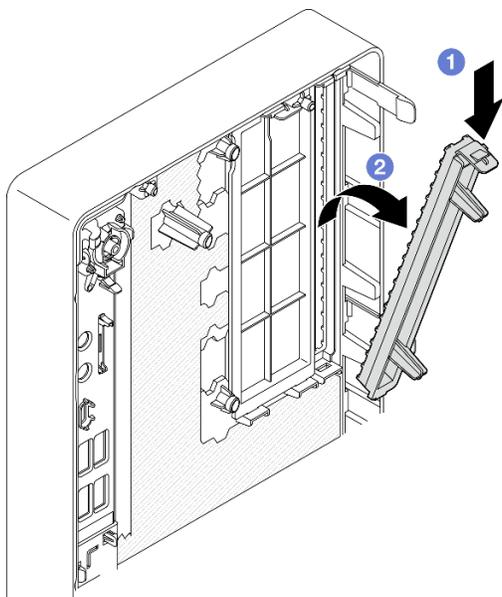
Рис. 45. Снятие защитного экрана отсека дисковод для оптических дисков
