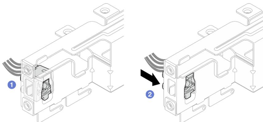
Рис. 83. Установка кнопки питания со светодиодным индикатором
