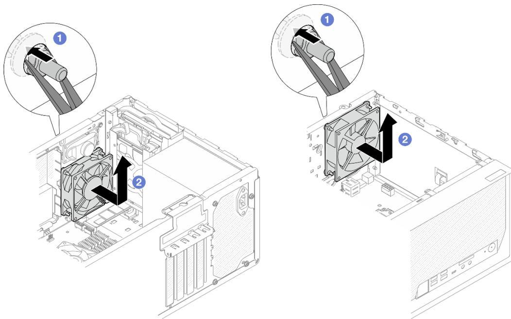
Рис. 54. Снятие вентилятора путем сжатия резиновых креплений
