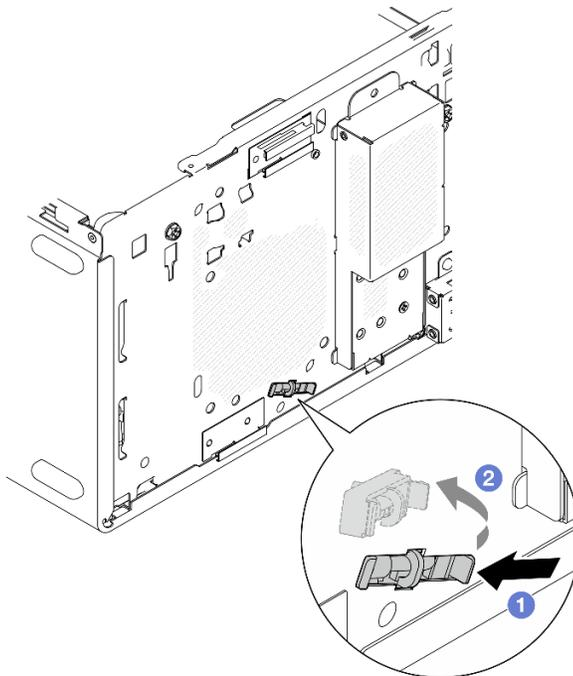
Рис. 106. Снятие датчика температуры
