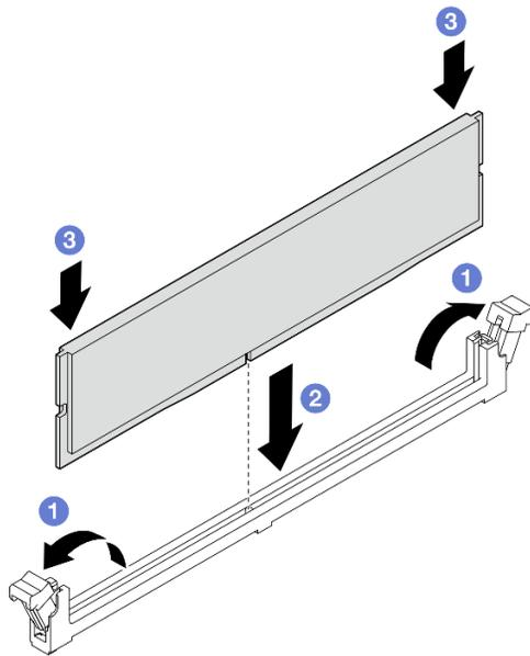
Рис. 73. Установка модуля памяти
