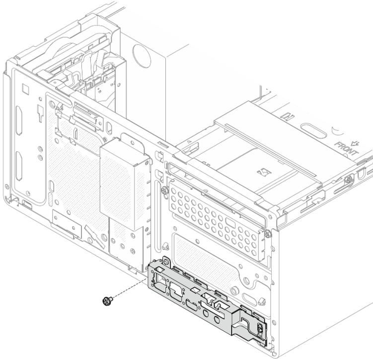
Рис. 101. Фиксация передней скобы ввода-вывода на раме
