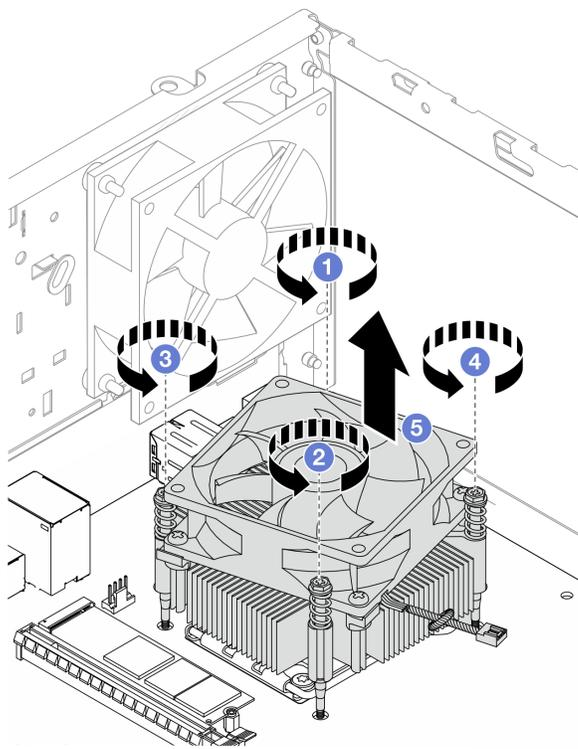
Рис. 60. Снятие модуля радиатора и вентилятора
