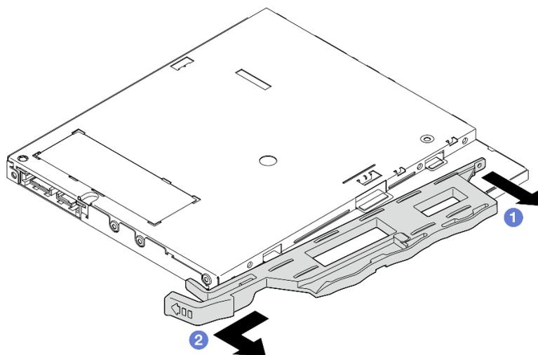
Рис. 42. Снятие фиксатора дисководов для оптических дисков
