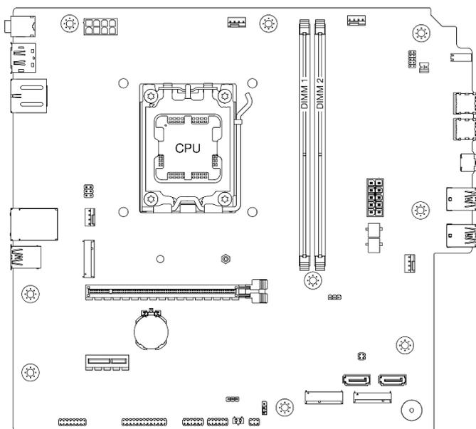
Рис. 68. Расположение модулей памяти и процессора
