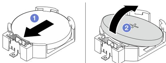
Рис. 2. Извлечение батарейки CMOS
