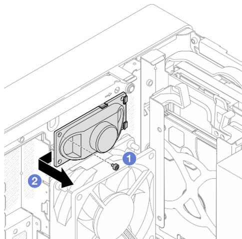
Рис. 74. Снятие моноусилителя
