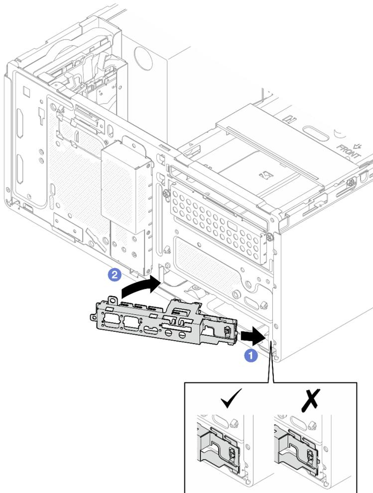
Рис. 100. Установка передней скобы ввода-вывода на раму
