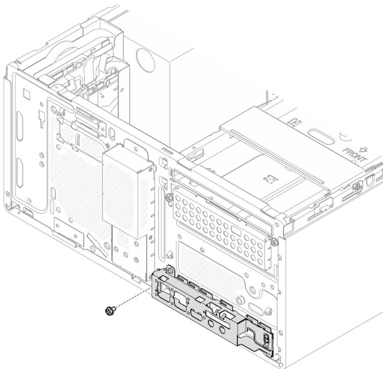
*Рис. 80. Снятие винта, фиксирующего переднюю скобу ввода-вывода*
