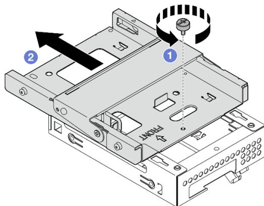
Рис. 26. Снятие отсека дисководов для оптических дисков с отсека для диска отсека 2
