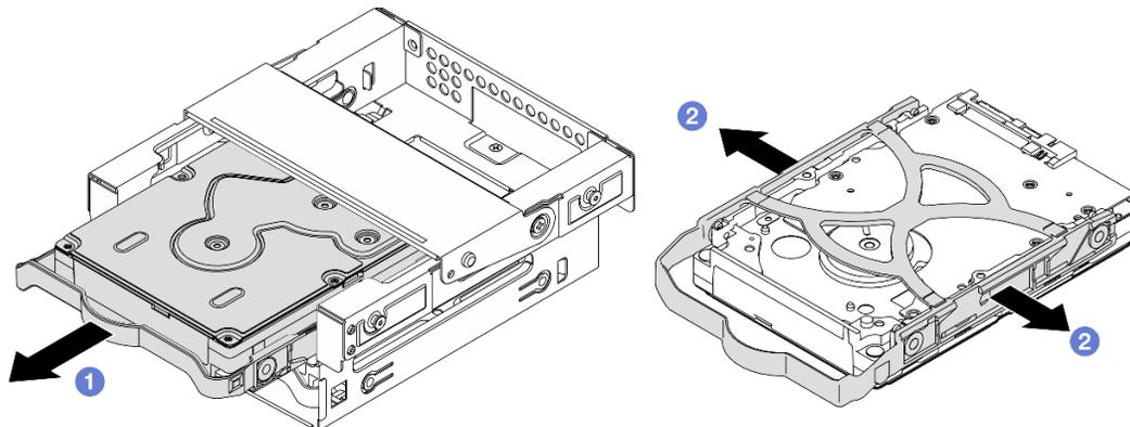
Рис. 31. Снятие 3,5-дюймового диска
