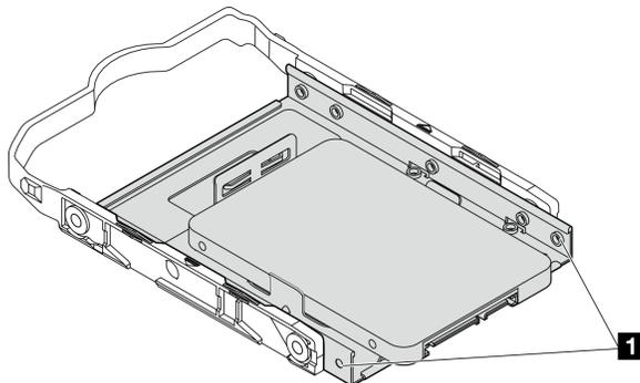
Рис. 34. Размещение отверстий для винтов диска на фиксаторе
