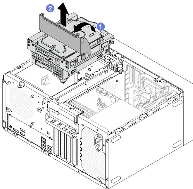
Рис. 30. Снятие блока отсека для диска отсеков 2 и 3
