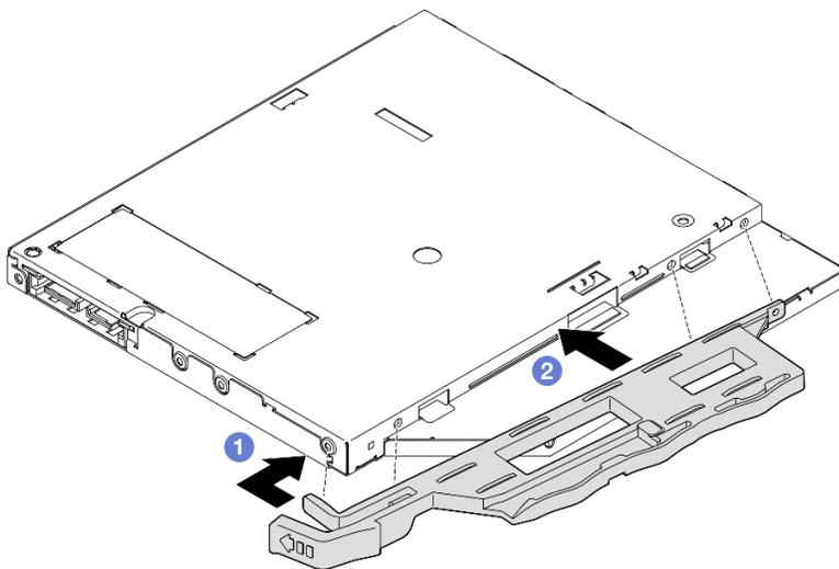
Рис. 46. Установка фиксатора на дисковод для оптических дисков
