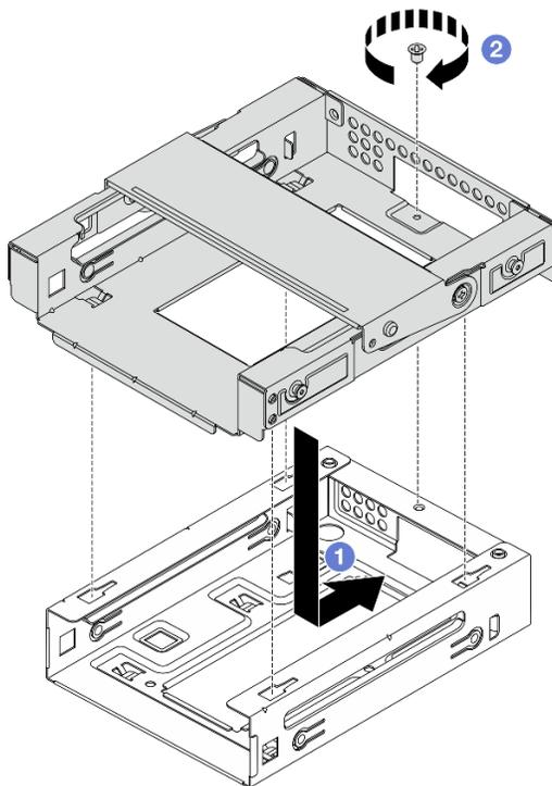
Рис. 39. Установка отсека для диска отсека 3 в отсек для диска отсека 2
