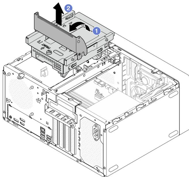
Рис. 25. Снятие блока отсека для диска дисководов оптических дисков и отсека 2
