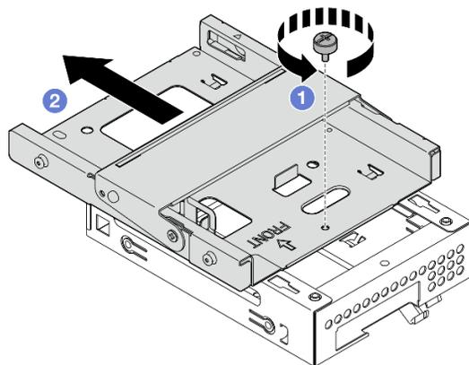
Рис. 50. Снятие отсека дисководов для оптических дисков с отсека для диска отсека 2
