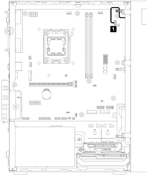
Рис. 117. Прокладка кабеля для кнопки питания со светодиодным индикатором
