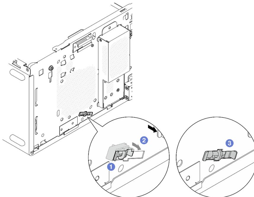
Рис. 107. Установка датчика температуры
