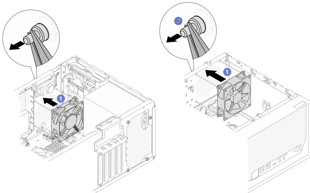
Figure 56. Installing the front fan or the rear fan
