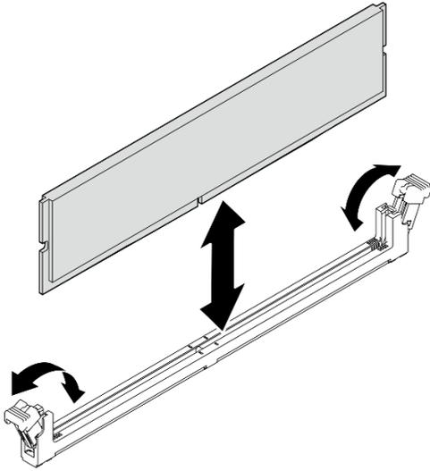
Figura 68. Instalación de un módulo de memoria
