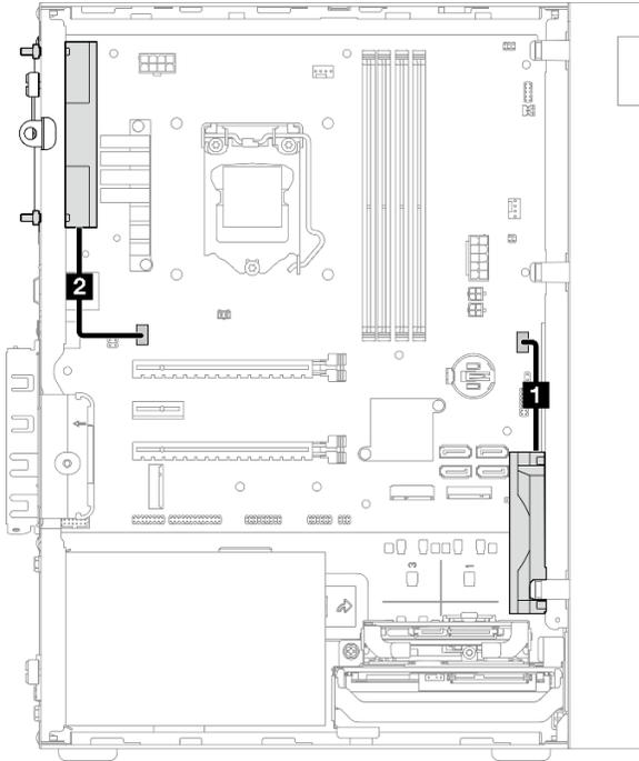
Figura 21. Direccionamiento de los cables del ventilador frontal y del ventilador posterior
