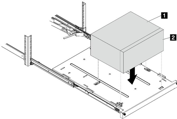
Figura 79. Instalación del servidor en la bandeja
