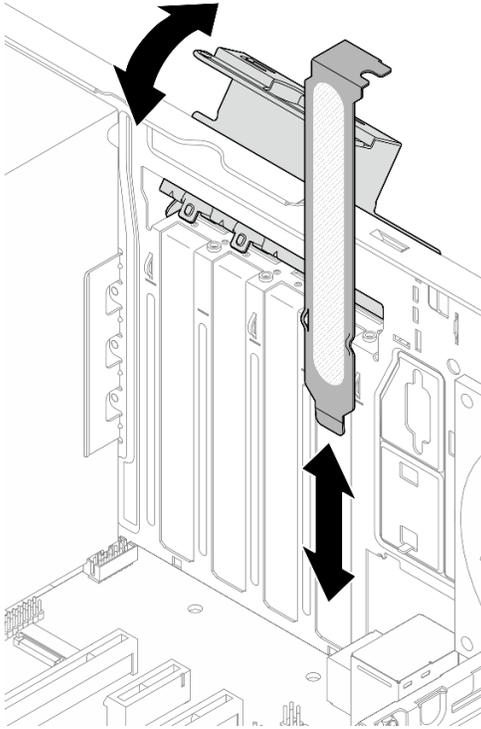
Figura 71. Extracción de un soporte de adaptador PCIe
