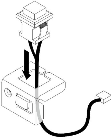
*Figura 63. Ensamblaje del conmutador de intrusión*
