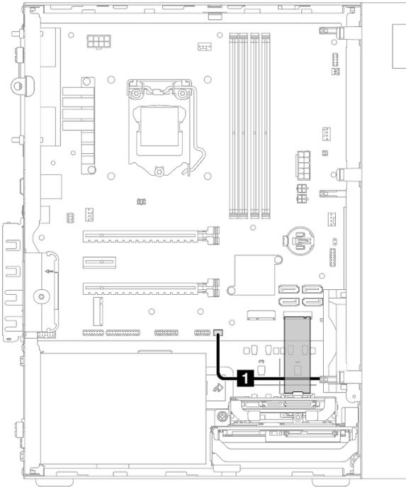
Figura 25. Disposición de los cables para el sensor térmico
