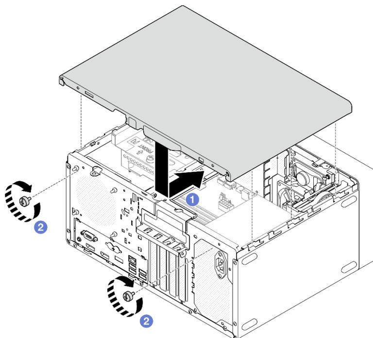
Figura 76. Instalación de la cubierta del servidor
