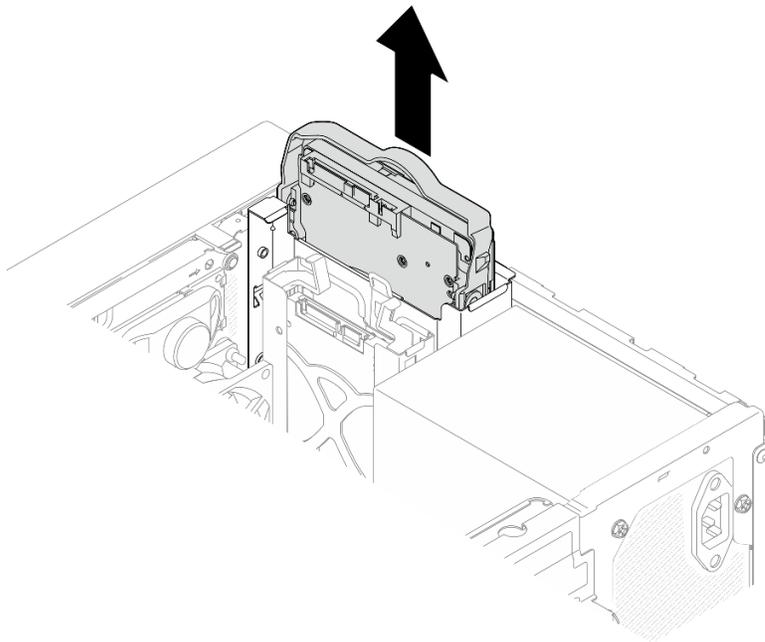
Figura 37. Extracción de un conjunto de la unidad desde la bahía de la unidad 1
