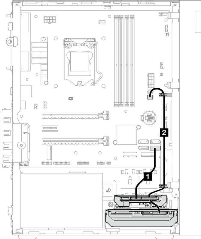
Figura 14. Disposición de los cables para la bahía de unidad 2
