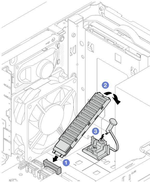
Figura 69. Instalación de la unidad M.2
