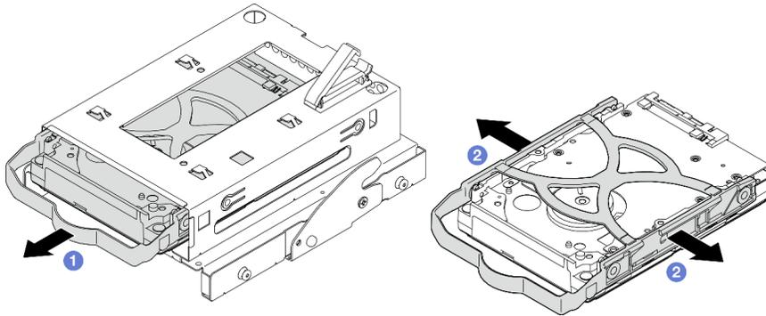
Figura 48. Extracción de la unidad de 3,5 pulgadas
