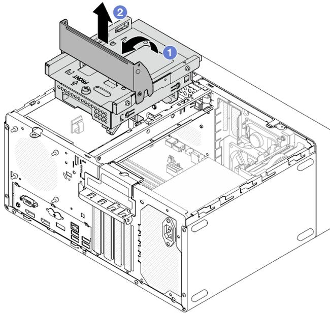
Figura 61. Extracción del compartimiento de la unidad óptica
