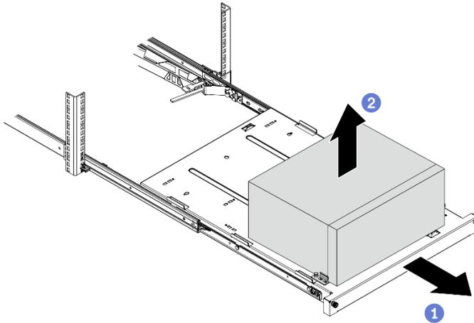
Figura 32. Extracción del servidor de los rieles
