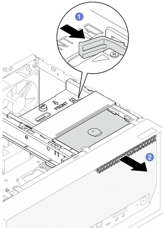
Figura 54. Extracción de la unidad óptica
