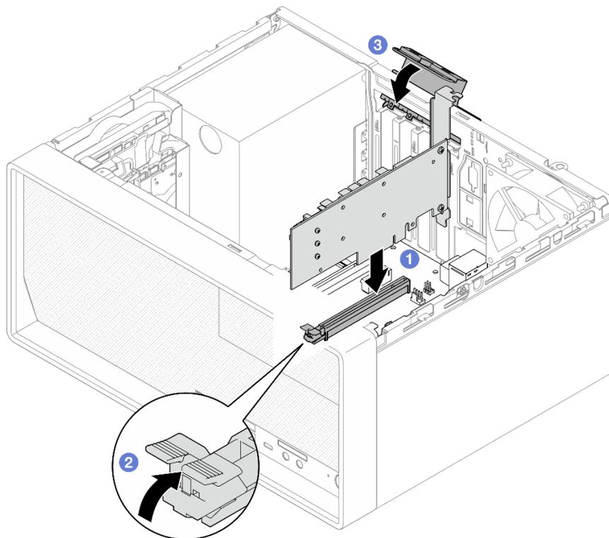
Figura 72. Instalación de un adaptador PCIe
