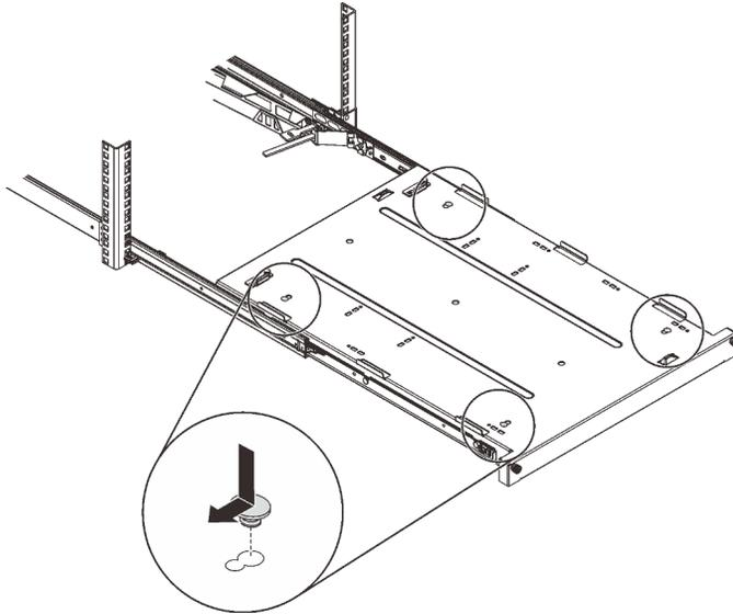
Figura 78. Instalación de las almohadillas de seguridad de goma en la bandeja
