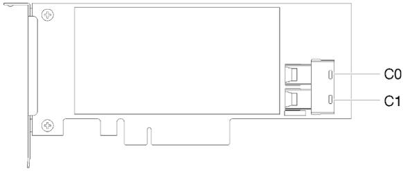
Figura 10. Conectores en el adaptador RAID SATA/SAS (8i)
