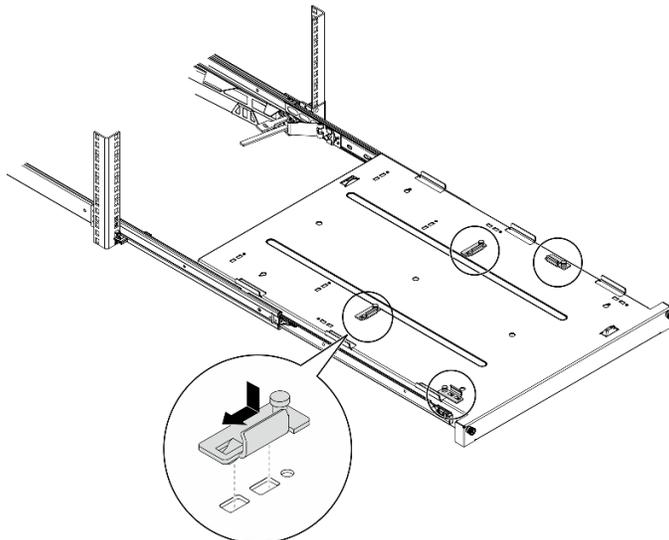
Figura 77. Instalación de los soportes en la bandeja
