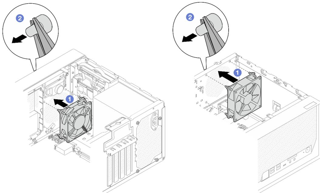
Figura 65. Instalación del ventilador frontal o posterior
