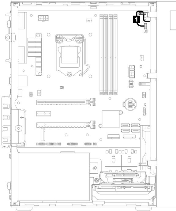
Figura 27. Disposición de los cables para el botón de encendido/apagado con LED
