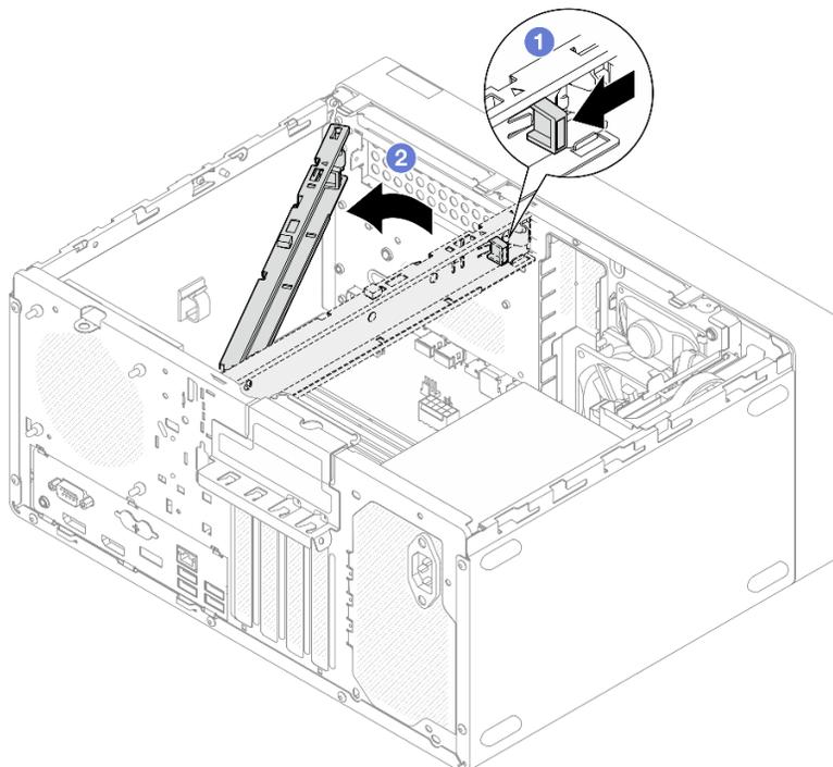
Figura 34. Extracción de la barra del compartimiento
