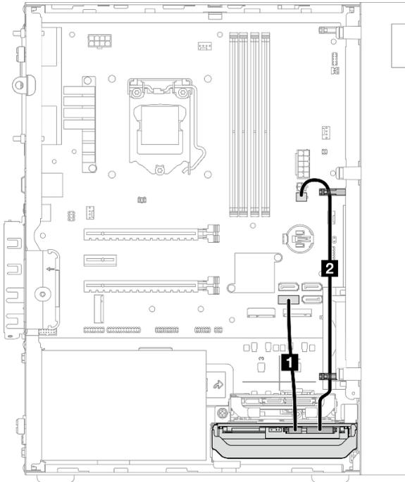
Figura 13. Disposición de los cables para la bahía de unidad 1
