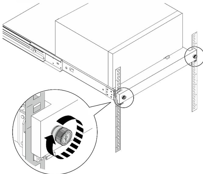
Figura 81. Fijación de la bandeja con tornillos
