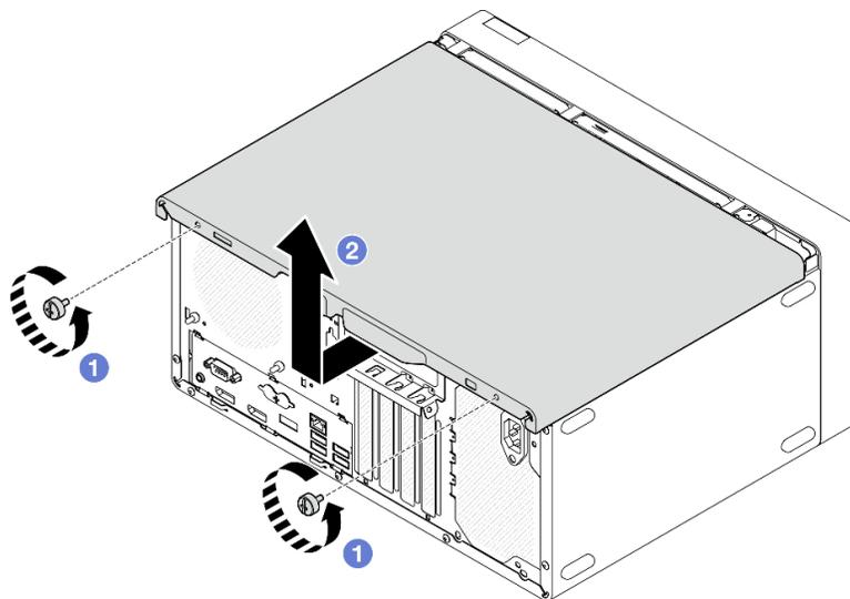
Figura 33. Extracción de la cubierta del servidor
