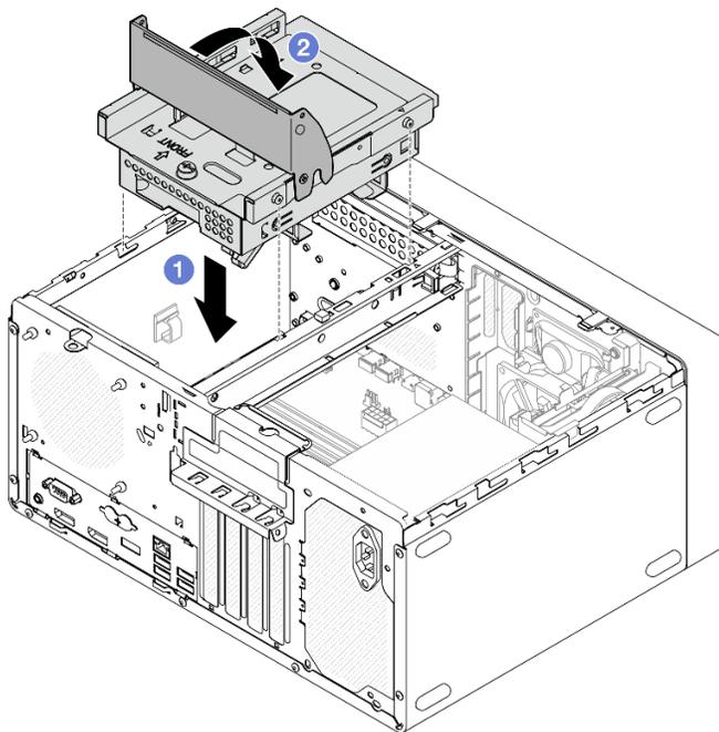
Figura 62. Instalación del compartimiento de la unidad óptica
