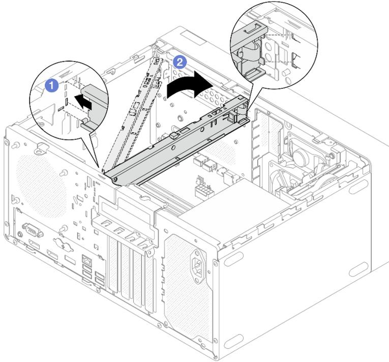
Figura 75. Instalación de la barra del compartimento
