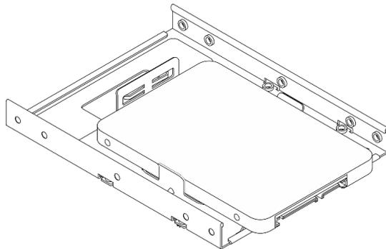
Asegúrese de que los orificios de tornillos más cercanos al conector de la unidad estén **fuera** del elemento de sujeción de la unidad.
