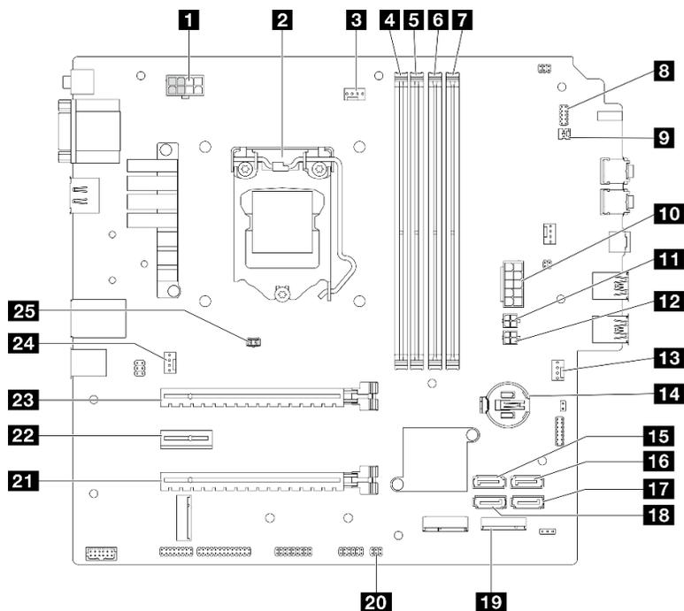
Figura 9. Componentes de la placa del sistema
