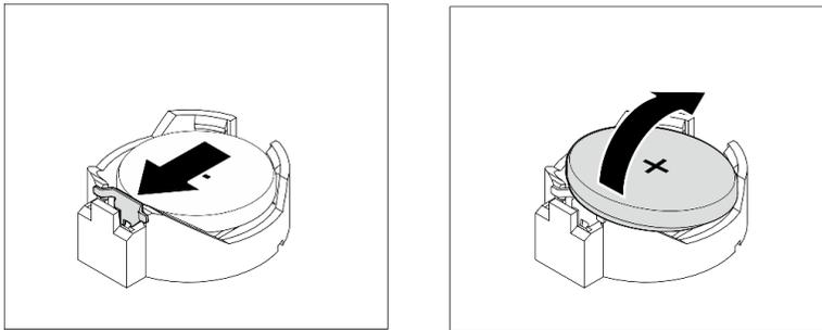
Figura 36. Extracción de la batería CMOS (CR2032)
