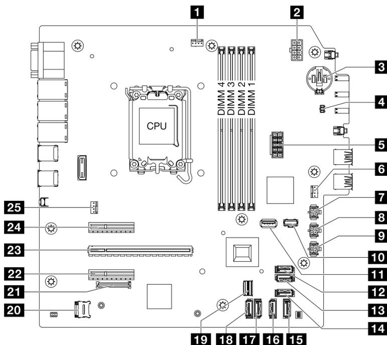
Figura 7. Conectores de la placa del sistema
