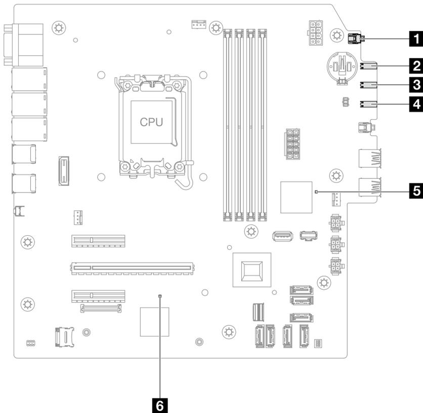
Figura 10. LED de la placa del sistema
