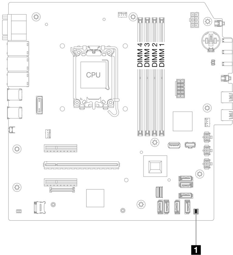
Figura 8. Conmutadores de la placa del sistema
