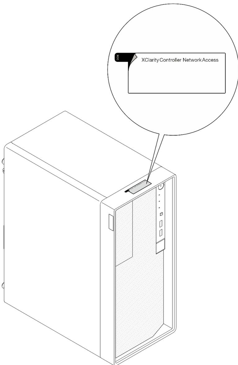
Figura 14. Ubicación de la etiqueta de acceso de red de XClarity Controller
