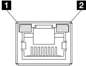
Figura 11. Puerto de gestión del sistema XCC (10/100/1000 Mbps RJ-45) LED
