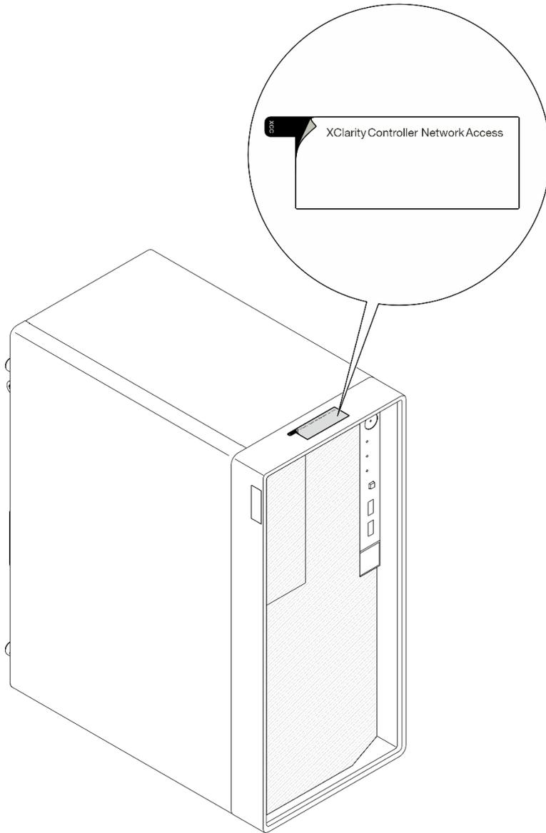
**그림 14. XClarity Controller 네트워크 액세스 레이블의 위치**
