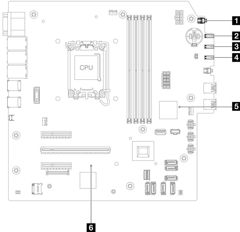
그림 10. 시스템 보드 LED
