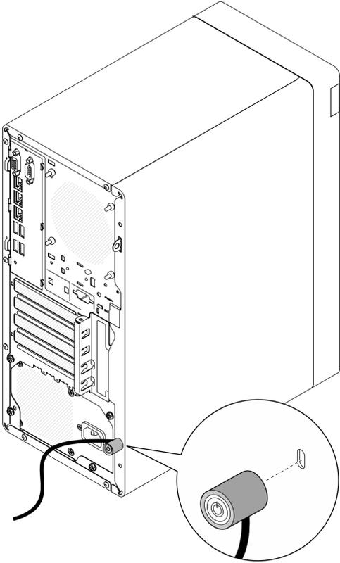
그림 6. Kensington 스타일 케이블 잠금 장치
