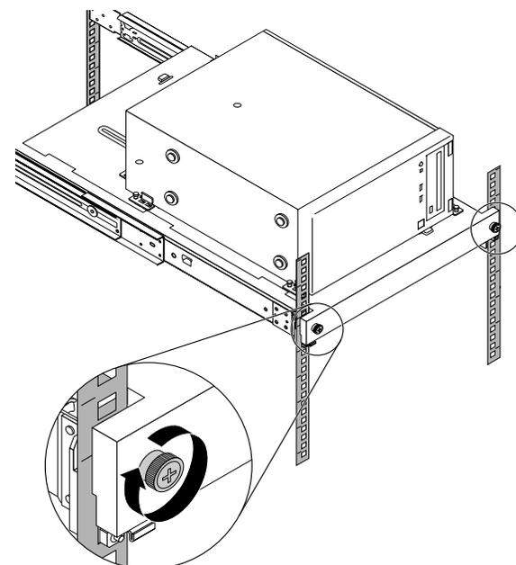
**20** Fissare il vassoio con due viti M6 x 16 sulla parte anteriore del cabinet rack.
