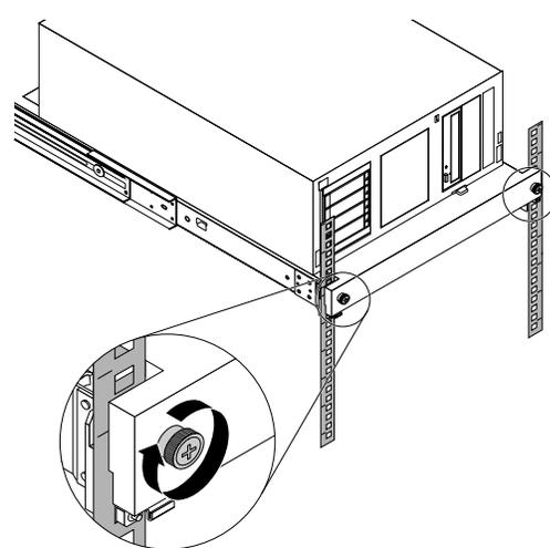
**24** Fissare il vassoio con due viti M6 x 16 sulla parte anteriore del cabinet rack.
