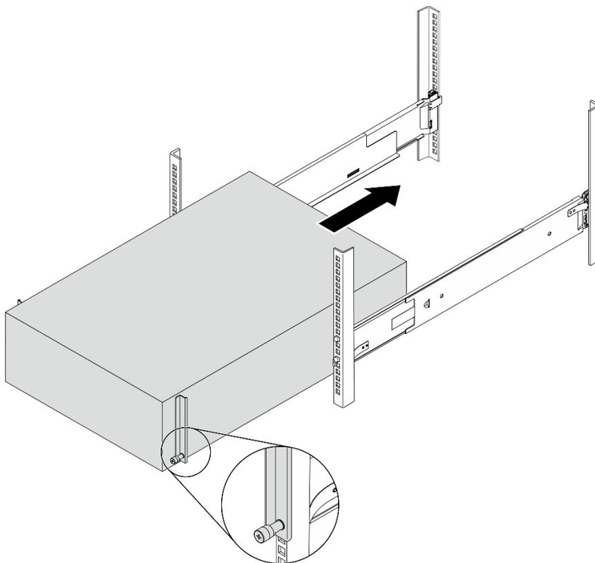
Figura 8. Installazione del server tower nelle guide
