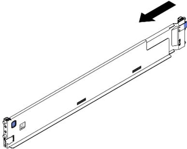
Figura 1. Compressione della guida
