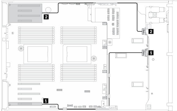
그림 231. 상단 PCIe 영역에 대한 SAS/SATA 케이블 배선
