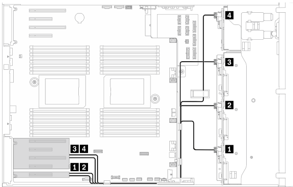
Figura 20. Roteamento de cabos SAS/SATA para a zona PCIe inferior
