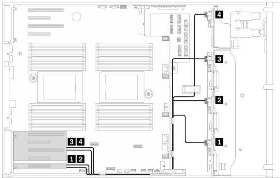
Figura 116. Roteamento de cabos SAS/SATA para a zona PCIe inferior
