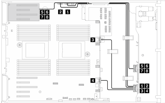
Рис. 166. Прокладка кабелей NVMe к материнской плате и зоне верхнего PCIe
