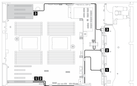
Рис. 97. Прокладка кабелей SAS/SATA к зоне верхнего PCIe
