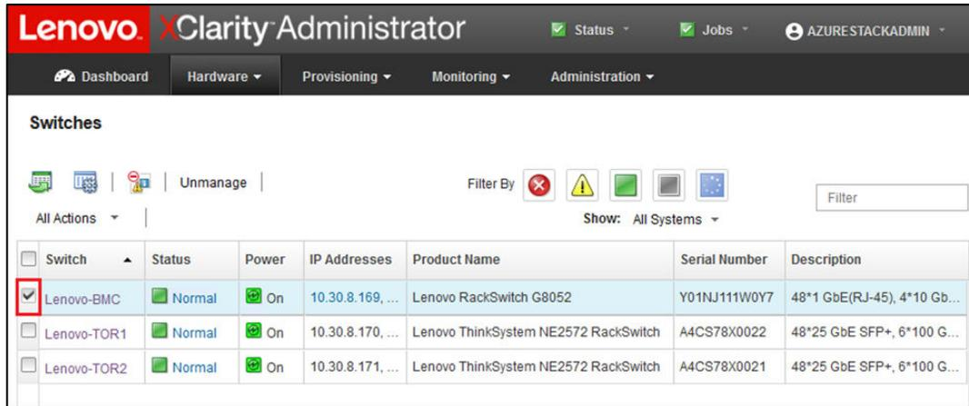
Figura 43. Selección del conmutador de BMC para crear una copia de seguridad de la configuración
