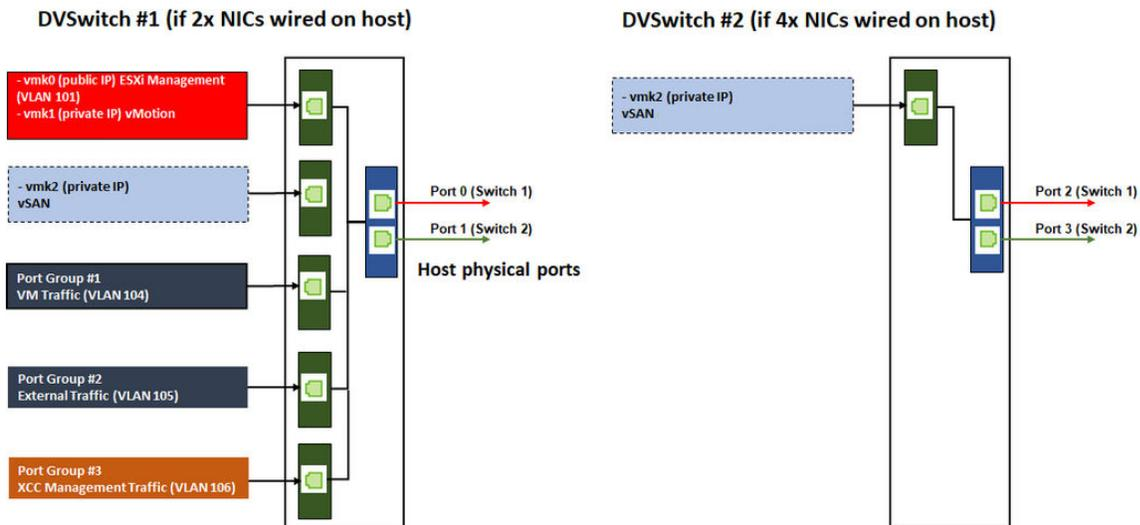
Figura 4. Configurazione degli vSwitch distribuiti della vSAN
